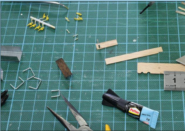
Die kleine Ablagebank für die Hemmschuhe entstand auf einfachste Weise – die Beine wurden aus Tackerklammern passend zu-rechtgebogen, die Ablage besteht aus einem gebeizten dünnen Furnierstreifen.
