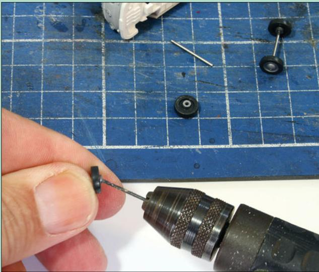
Felgen mit senkrechtem Achsloch müssen mit einem passenden Bohrer schräg aufgebohrt werden. Vorsicht ist geboten, nicht dass der Bohrer dabei vorne wieder rauskommt. Gegebenenfalls die Bohrgate etwas aufreiben, dann verkleben.
