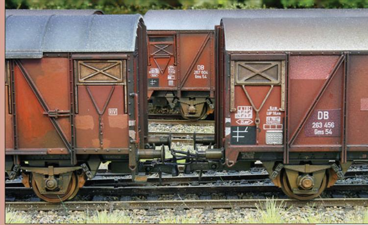
An den Achslagern finden sich vor allem Ablagerungen von Bremsstaub, hochgewirbeltem Schmutz und Schmierfett, die eine verbackene Masse bilden. Die Bremsbacken und Federn zeigen meist hellere Rosttöne.
