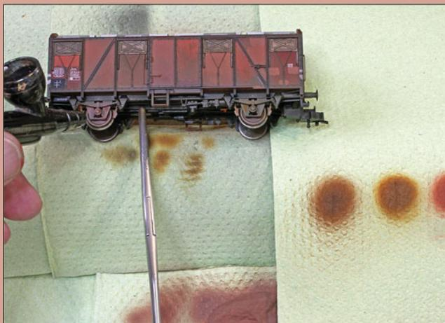
Im Fahrwerkbereich gilt es vor allem, die hell glänzenden Räder, aber auch Achslager und Bremsbacken mit Rosttönen zu behandeln. Dies gelingt sehr gut mit der Airbrush, die Farbe kann hier aber auch mit einem Pinsel aufgetragen werden.
