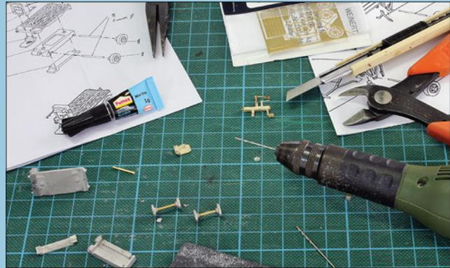
Immer wieder müssen Löcher nachgebohrt werden. Passende Bohrer, teils mit feinsten Abmessungen, muss man hierfür vorhalten. Für das Abtrennen vom Gussbaum reicht nicht immer ein Seitenschneider, oft ist eine Diamanttrennscheibe die bessere Wahl.
