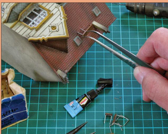
Ein wichtiges Detail, das gerne bei Hausbausätzen vergessen wird, ist der Dachsteg, auf dem der Schornsteinfeger steht, wenn er den Kamin putzt. Meist befindet er sich zwischen Dachfenster und Kamin. Er entsteht aus Tackerklammern und Furnierholzstücken.
