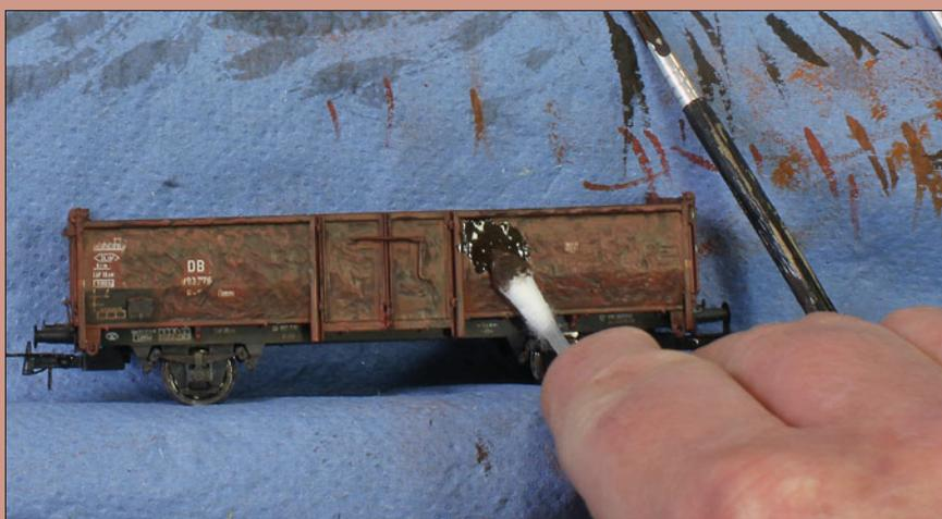
Dem Rundfräser eine unregelmäßige Oberfläche, in die Ecken gelangt man mit einem Kegelfräser. Wichtig ist, dass keine isoliert aussehenden „Inseln“ geschaffen werden; der Abtrag sollte stattdessen möglichst kontinuierlich und in Form von größeren Flecken erfolgen. Die Beschriftungsfelder sollte man aussparen, sofern der Wagen keine neue Beschriftung erhalten soll.
