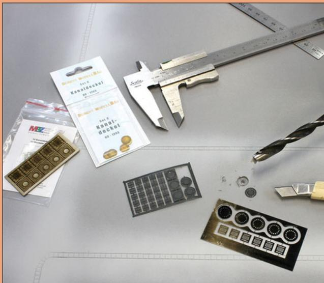
Gullydeckel (Mannlochabdeckungen) gibt es von einigen Herstellern. Die Messingätzeile von Weinert (kleiner) und Faller (größer) kann man direkt in ein vorgebohrtes Loch einkleben. Ein Holzbohrer leistet wegen der scharfen Ränder gute Dienste.
