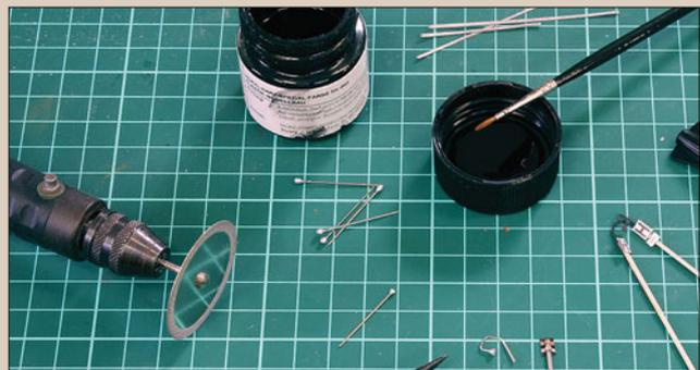
Anstrahlampen für Schilder entstehen aus den Billigstecknadeln für Hemden. Der am oberen Ende sitzende Tropfen Lötzinn wird flach geschliffen, die Nadel in Form gebogen, angemalt und mit Sekundenkleber angeklebt.
