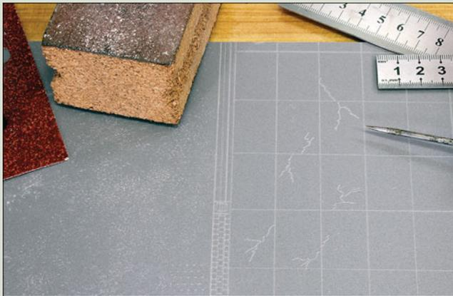
Die Beanspruchung durch Fahrzeuge und Witterung verursacht auf Betriebsflächen oft mechanische Beschädigungen, Risse und Löcher, die sich mit Gravuren leicht nachstellen lassen. Grobes Schmirgelpapier wird für eine Struktur auf die Oberfläche gehämmert.
