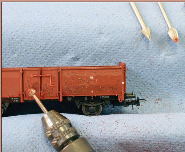
Mit diversen Fräsern und einer Kleinbohrmaschine bringt man die Dellen an. Sie sollten nicht zu tief sein und auch nicht zu isoliert voneinander entfernt sitzen. Die Kegelfräser sind in den Eckbereichen anzuwenden; auch die Holme sollten zerbeult aussehen.
