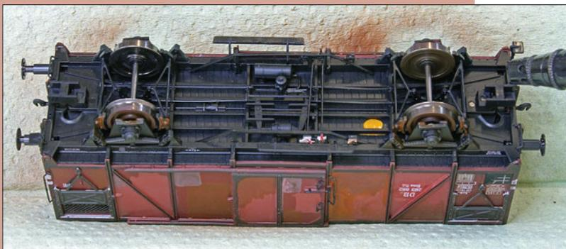
Gerne werden die Innenseiten der Räder bei diesem Vorgang vergessen. Die Druckluft aus der Spritzpistole treibt dabei sogar die Räder an, sodass sie nicht ausgebaut werden müssen und trotzdem einen gleichmäßigen Farbauftrag erhalten.
