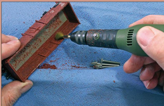
Die Bearbeitung mit dem Fräser wirkt zunächst noch sehr grob und kantig. Mit einer eingespannten Drahtbürste lassen sich Grate und abstehende Überreste jedoch weiter glätten. Restspäne kehrt man mit einem weichen Pinsel zusätzlich ab.
