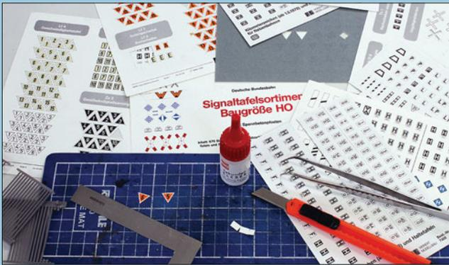
Aus den diversen Sortimenten schneidet man sich die gewünschten Signaltafeln und Schilder trennscharf mit Bastelmesser und Stahllineal auf einer Schneidematte aus. Die beim Vorbild herumliegenden Verkehrsschilder stammen aus einem Set von Busch. Passende Pfosten liegen den Sets meist schon bei; sie mussten hier allerdings noch etwas gekürzt werden. Nach dem Aufkleben der Tafeln erhielten die Rückseiten und die Pfosten einen grauen Anstrich.
