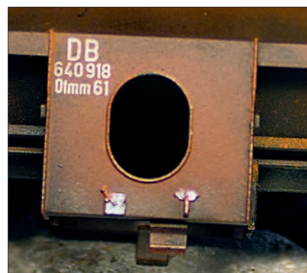
Nach dem Bearbeiten mit einer Microbrush haben auch die Bremsumsteller die richtige Farbgebung.
