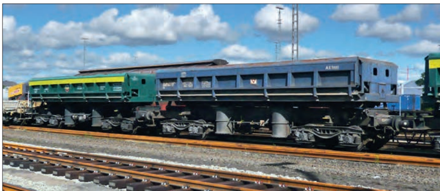
Zwei Wagen derselben Bauart, aber unterschiedlich bezeichnet: links der in der Slowakei registrierte Ua 999 0044 der Firma Axbenet, rechts der unter PKP Cargo eingestellte Fas 673 8628, im September 2010 im Rbf Hamburg Süd. Foto Benno Wiesmüller
