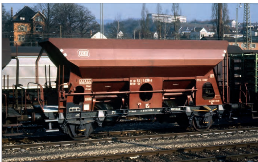
Den Ed 089 541 1 438 hatte das AW Kaiserslautern am 13.1.75 für den Einbau der AK vorbereitet. Das Foto zeigt den einen Monat alten Wagen im Rbf Untertürkheim. Anders als üblich waren die Konsolen für die Seilhaken am bühnenabgewandten Ende.
