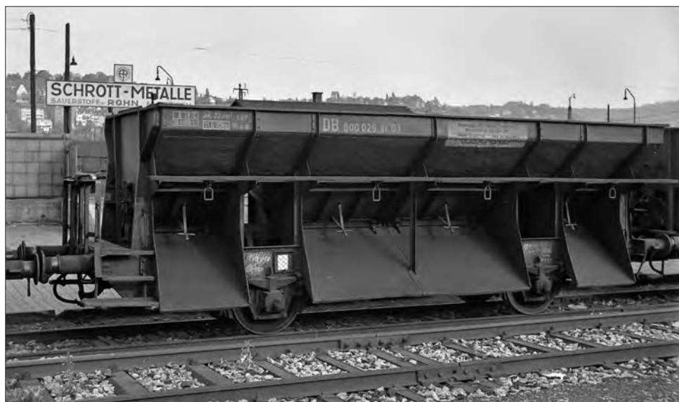
Der nach Zeichnung Ce 166 gebaute und in den 50er-Jahren als Dienstkohlenpendel zwischen der Zeche Westerholt und dem Bww Fernheizwerk Stuttgart eingesetzte Ot 03 600 029 im Herbst 1959 in Stuttgart Hgbf. Foto Fritz Willke
