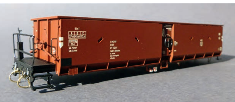
Der für den Anbau von Federpuffern vorbereitete Wagenkasten; zwei der drei Bremsschläuche sind bereits montiert. Fotos (2) Christoph von Neumann
