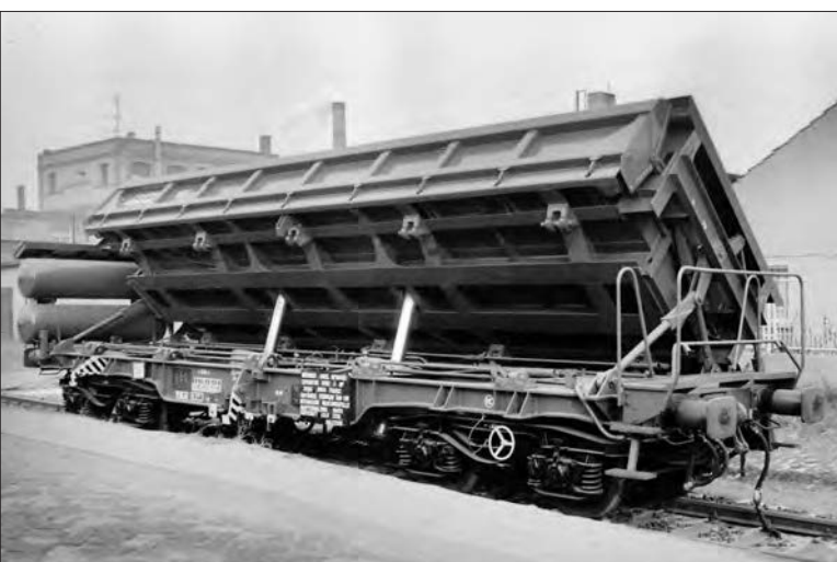
Der Fakks [6781] 678 1001, aufgenommen kurz nach Ablieferung im Jahr 1982 in Delitzsch, war der zweite Baumusterwagen. Sein Übergangssteg wich noch von der Serienausführung ab. Foto DR, Slg. SC
