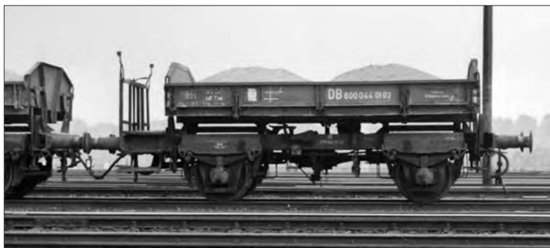
Obwohl es von dem von der Waggonfabrik Gotha entwickelten und von O&K nachgebauten Seitenkipper nur 40 Exemplare gab, waren einige bis Ende der 50er-Jahre im Einsatz. Oben der Ot Mainz 1075 auf einem Werkfoto vom Mai 1927, unten der Ot 03 600 044 im Jahr 1957 in Warburg. Werkfotos Slg. SC, Foto R. Todt, Slg. Eisenbahnstiftung
