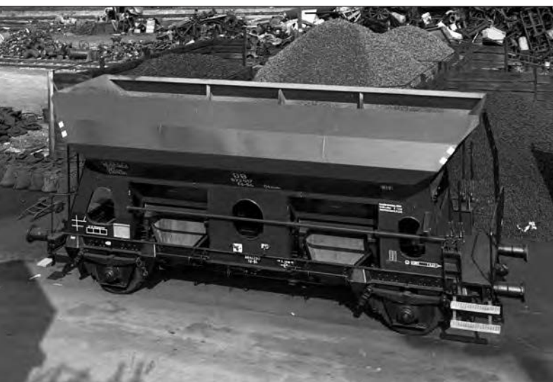
An dem hellen Innenanstrich ist der Neubauwagen zu erkennen: der am 14.6.61 von DWM mit Hochleistungspuffern gelieferte Fd-64 Otm 622 517 im Gbf Bad Cannstatt.
