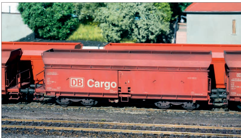
Der Fals-zz 164 mit Federpuffern und Schraubenkupplungen von Günter Weimann, Luftschläuchen von Weinert und UIC-Seilhaken von Kuswa.
