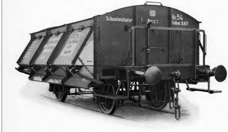
Der Wagen 54 der Stahlwerke Völklingen besaß ebenfalls einen flachen Boden, der sich beim Entladen aufstellte – auch dieses System hatte sich Talbot patentieren lassen.
