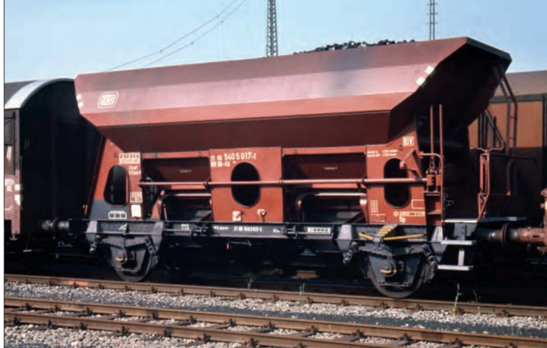
Der Ed 087 540 5 017 im Mai 1975 in Untertürkheim: Am 3.4.75 hatte ihn das AW Kaiserslautern für den Einbau der AK vorbereitet. Bis auf Spuren von Kohlenstaub auf der Oberseite des Trichters war auch er noch sehr sauber.
