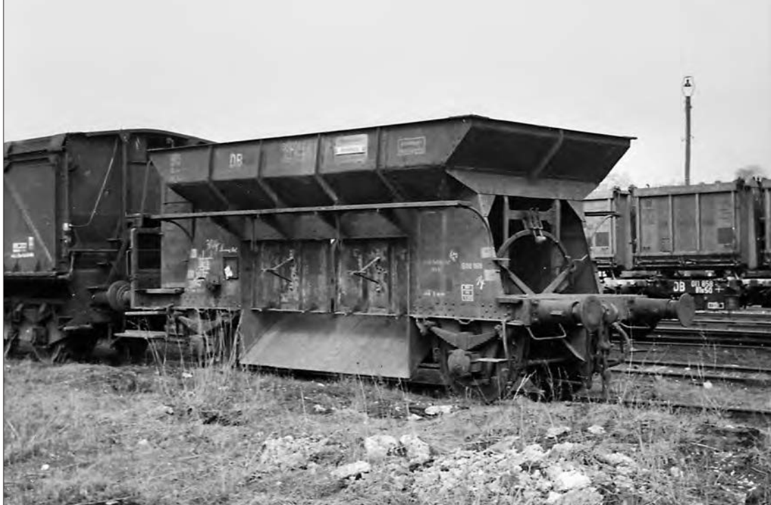
Der im März 1958 in Sennelager aufgenommene Otm 07 600 168 hatte seine letzte Zwischenbremsuntersuchung am 28.1.57 erhalten. Es ist fraglich, ob das AW Paderborn den 1911 von Talbot nach der Zeichnung Ce 150 gebauten Wagen damals noch einmal untersucht hat. Foto Reinhard Todt, Slg. Eisenbahnstiftung
