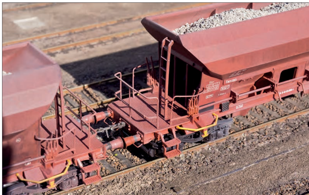
Die beim Vorbild braun lackierten Überstoßpuffer werden im Einfederungsbereich mit Abklebeband maskiert, anschließend grundiert und in RAL 8012 lackiert.
