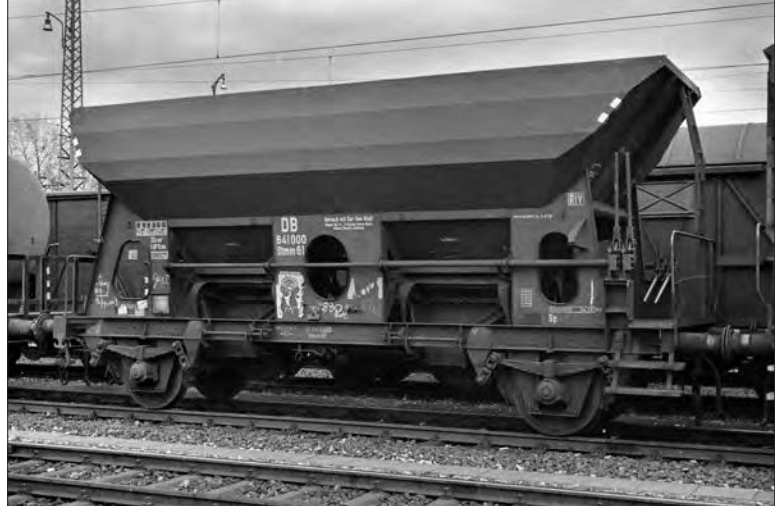
Der am 14.3.61 in Kaiserslautern fertiggestellte Otm 61 wich von der üblichen Ausführung ab. Er bestand z. T. aus Cor-Ten-Stahl, einem Werkstoff, der unter einer oberen Rostschicht eine Sperrschicht ausbildet, die eine weitere Korrosion verhindert.
