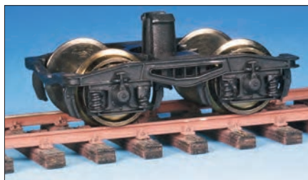
Y25-Drehgestelle im H0-Maßstab: links von Piko, rechts das Gützold-Drehgestell des Fas 126. Allein diese Drehgestelle haben große, wenn auch nicht korrekt wiedergegebene Bremsklötze.
