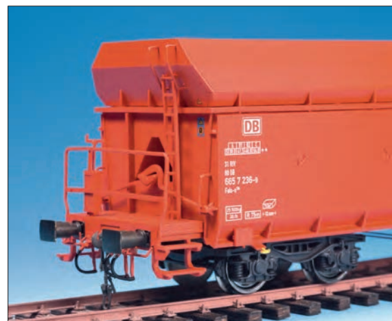
Der Fals-zz 164 mit Federpuffern und Schraubenkupplungen von Günter Weimann, Luftschläuchen von Weinert und UIC-Seilhaken von Kuswa.
