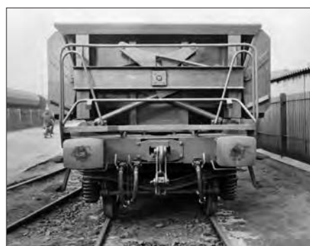
Die Stirnansicht beim Vorbild als Vorlage für die Montage von Luftschläuchen – die Kupplung für die Hauptluftbehälterleitung lag auf beiden Seiten links neben der Kupplung. Foto DR, Slg. SC
