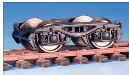
Y25-Drehgestelle im H0-Maßstab: links von Piko, rechts das Gützold-Drehgestell des Fas 126. Allein diese Drehgestelle haben große, wenn auch nicht korrekt wiedergegebene Bremsklötze.
