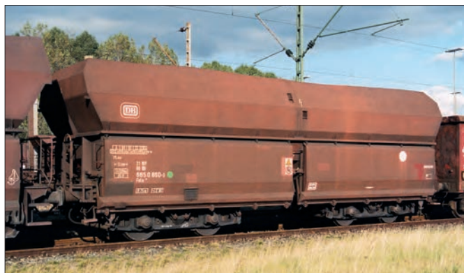
Der Fals 175 665 0 860, ein Weißpunktswagen, aufgenommen im Oktober 1997 im Hansaport. Der Wagen hatte im Zuge der Instandhaltung neue, im unteren Bereich abgekantete Klappen erhalten. Foto SC
