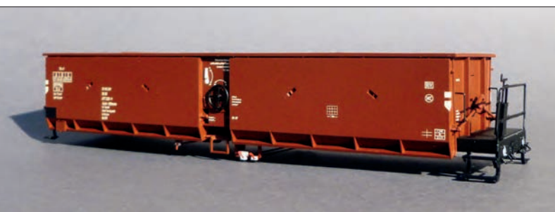
Der Wagenkasten des OOhhmtu nach der Demontage der Drehgestelle und Puffer.
