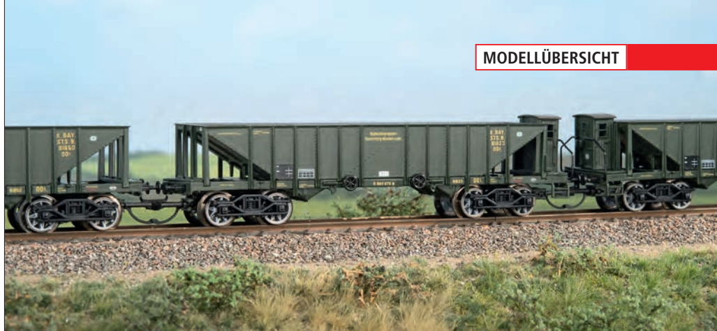
Von Minitrix stammen die schönen Nachbildungen der bayerischen „Regiekohlenwagen“ in amerikanischer Bauart mit Diamond-Drehgestellen und Speichenradsätzen.
