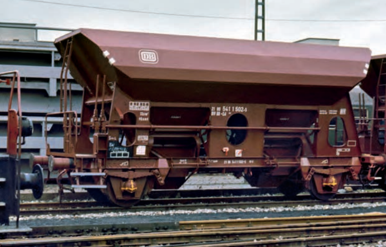
Im Januar 1976 hatte das AW Kaiserslautern den Ed 089 541 1 502, aufgenommen in Stuttgart Hgbf, nach 16 Einsatzjahren aufgearbeitet. Hierzu gehörten die Ausrüstung mit Hochleistungspuffern und ein komplett rotbrauner Anstrich.
