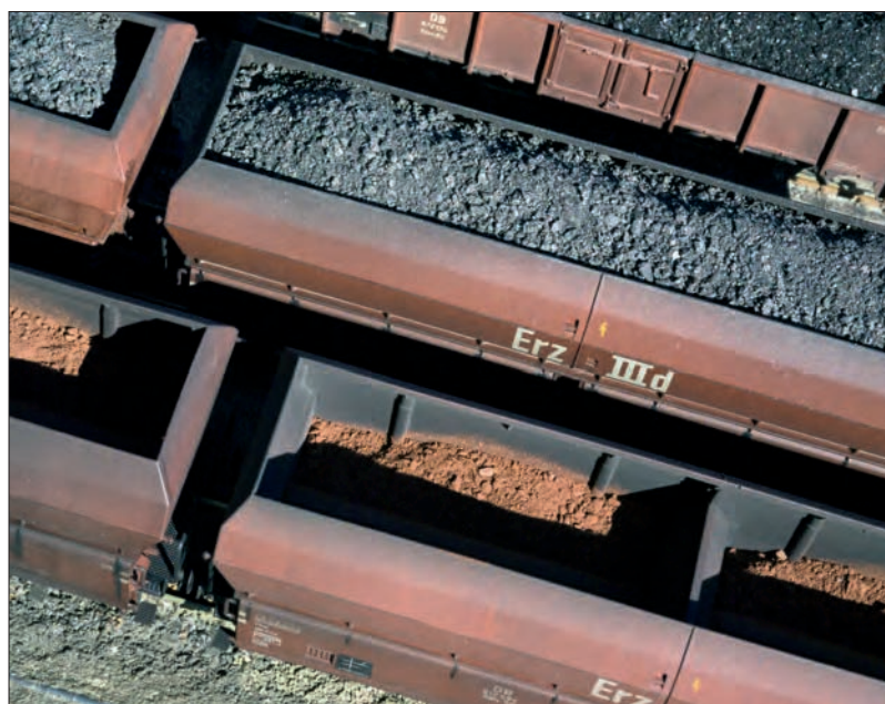
Der Blick von oben in die Wagen zeigt das unterschiedliche Volumen von Erz- und Koksladungen. Er macht aber auch deutlich, dass man mit kleinen Kompromissen leben muss: Die Aussteifungen der Bordwände gibt es beim Vorbild nicht.
