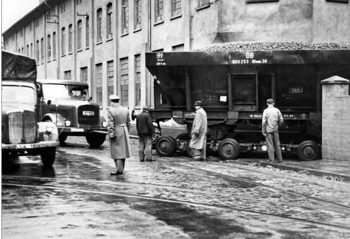
Am 11. Dezember 1958 unternahm die Plettenberger Kleinbahn Probefahrten zur Bedienung der Anschlüsse mit einem Culemeyer-Straßenroller. Eine Kaelble-Zugmaschine der DB bugsierte eine solche Fuhre mit dem für Siepmann bestimmten Otm 36 600 253 auf einen besonders engen Gleisanschluss in der Bahnhofstraße in Plettenberg. Foto: Slg. Wolf Grootte
