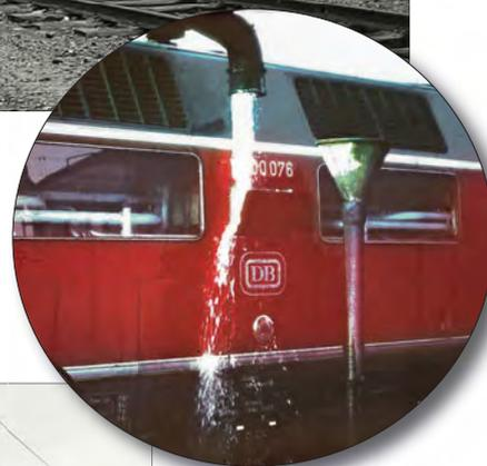
Bei Langläufen konnte der Wasservorrat für die Dampfzugheizung über seitliche Klappen ergänzt werden. Nach dem Wegfall der Langläufe wurden diese rostanfälligen Öffnungen verschlossen.
