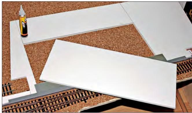
Die wechselbare Grundplatte besteht aus einer Hartschaumplatte. In gleicher Höhe entstand eine Einfassung, auf der die Anlagengestaltung vorgenommen wird. Die Hartschaumplatten sollten mit senkrechten Kanten versehen werden.
