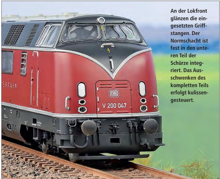
An der Lokfront glänzen die eingesetzten Griffstangen. Der Normschacht ist fest in den unteren Teil der Schürze integriert. Das Aus-schwenken des kompletten Teils erfolgt kulissen-gesteuert.
