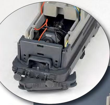
Das Lokgehäuse lässt sich nach Lösen von zwei, an der Unterseite gut zugänglichen Schrauben leicht abheben. Im Dach der Maschine liegt die Hauptplatine, die über eine PluX-Schnittstelle verfügt.
