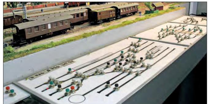
digital gesteuert. Weichen und Signale werden über ein Gleisbildstellpult analog bedient. Hier gibt es Drucktaster für Weichen, Signale und Entkuppler. Auch die Drehscheiben-Steuerung ist darin eingegliedert.
