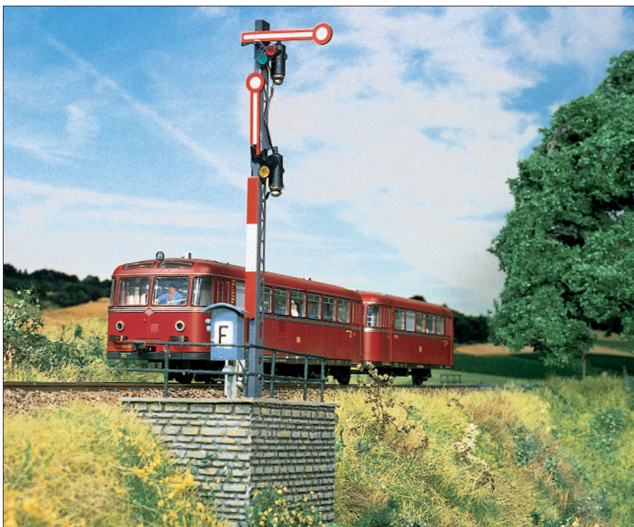
Ein Schienenbus passiert ein zweiflügliges Einfahrtsignal ohne Ausfahrtsignal. Wegen der auf einem Damm verlaufenden Strecke musste das Signal – wie übrigens sehr oft – auf einem gesonderten gemauerten Sockel aufgestellt werden. Das Geländer dient der Sicherheit, der Signalfernsprecher ist ein unentbehrliches Attribut jener Zeit.
