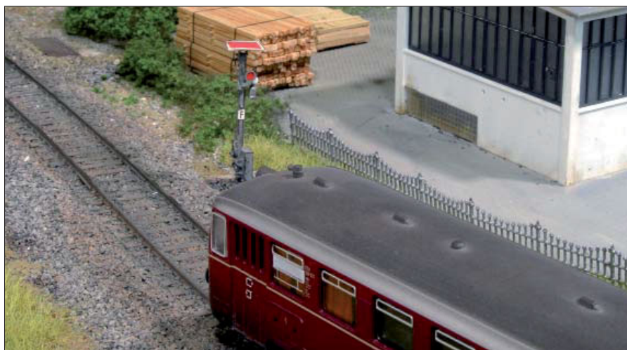
Im Modell selten anzutreffen: klappbare Sh 2-Scheibe als Ersatz fürs Einfahrtsignal.
