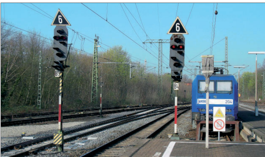
Alte Grundsignale (Hauptsperrsignale) mit moderner RAG-Lok – wie auf der Modellbahn. Die 6 oben an den Signalschirmen bedeutet, dass jede Ausfahrt, immer nur mit Hp 2, den anschließenden Weichenbereich mit 60 km/h befahren kann.
