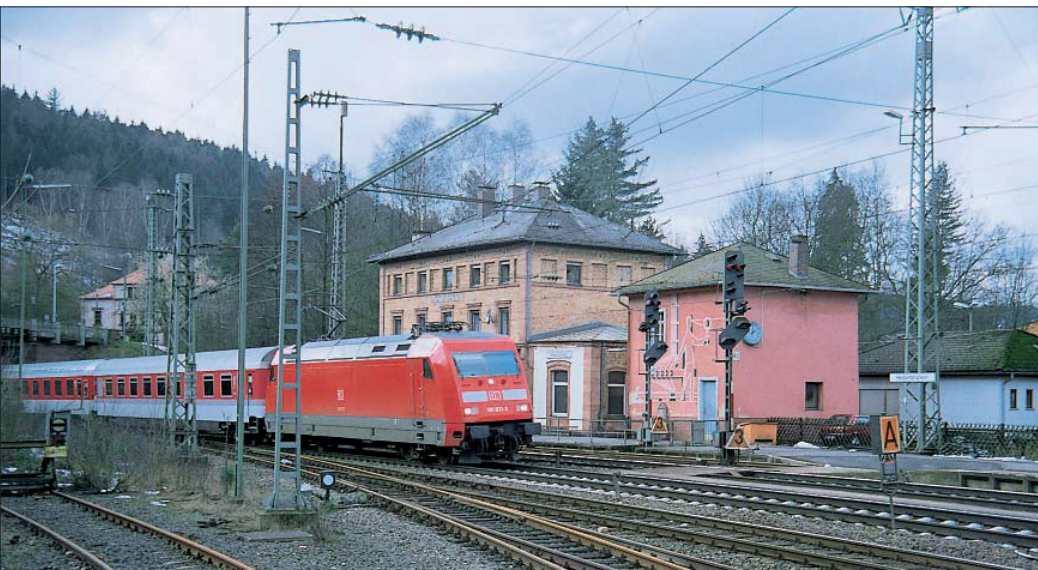
Auf der Spessarttrampe bei Heigenbrücken sind sowohl eine beleuchtete Anfangstafel als auch einzelne Langsamfahrsscheiben eingerichtet.
