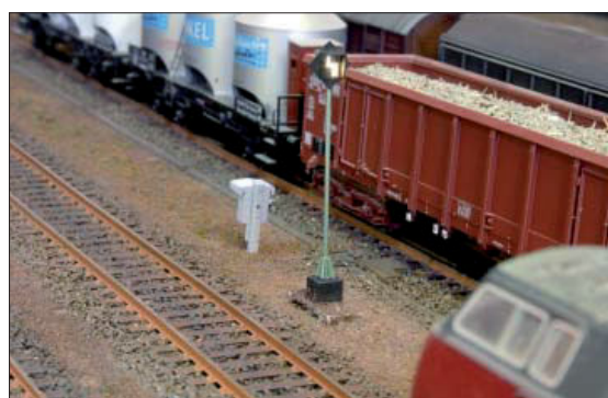
Der leuchtende Gleiswechselanzeiger signalisiert der ausfahrenden S-Bahn, dass die Weiterfahrt in das Gegengleis führt.
