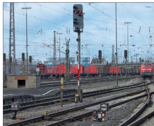
Eine Gleissperre mit zwei Gs-Laternen und einem niedrigen Licht-Sperrsignal. Der sogenannte Schotterzweig besitzt ein kleines, weiß-rot-weißes Mastschild.
