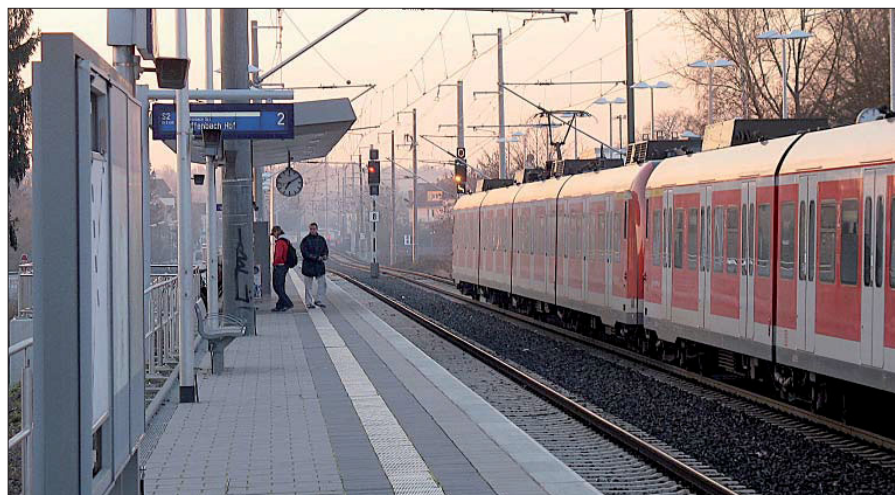
Der leuchtende Gleiswechselanzeiger signalisiert der ausfahrenden S-Bahn, dass die Weiterfahrt in das Gegengleis führt.
