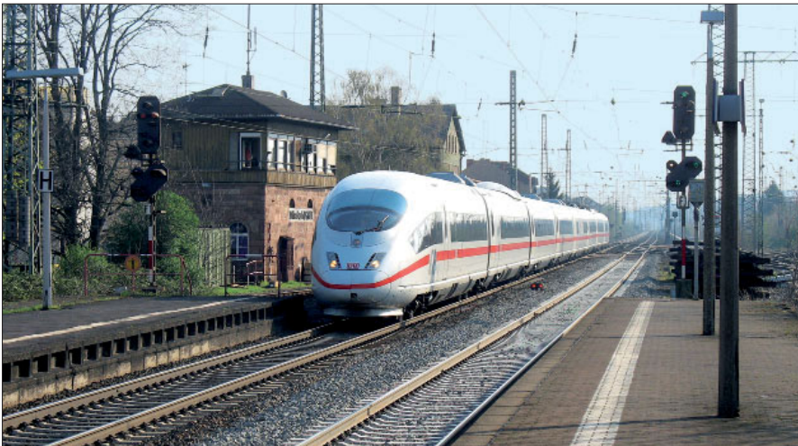
Zwei Hauptsperrsignale als Ausfahrtsignale mit jeweils einem Vorsignal am Mast. Die kleine Signaloptik – seitwärts am Vorsignalschirm – kann mit einem weißen Licht anzeigen, dass ein folgendes Hauptsignal im verkürzten Bremswegabstand steht.
