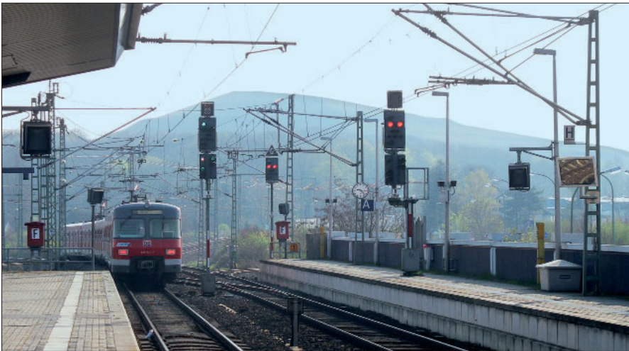
Hohe Bahnsteige, Kompakt-Ausfahrtsignale und ein ausfahrender „alter“ ET 420 in neuen Farben – Epoche V eben. Das rechte Signal besitzt einen sogenannten Auslegermast.
