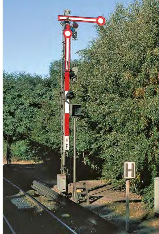
An dem Ausfahrtsignal des Bahnhofs Sülldorf, im Oktober 1983 fotografiert, darf auf mündlichen Auftrag des Fahrdienstleiters oder Aufsichtsbeamten vorbeigefahren werden, da es mit M-Tafel gekennzeichnet ist. Zusätzlich besitzt es ein Ersatzsignal, dessen Aufleuchten ebenfalls die Vorbeifahrt am Halt zeigenden Signal erlaubt.
