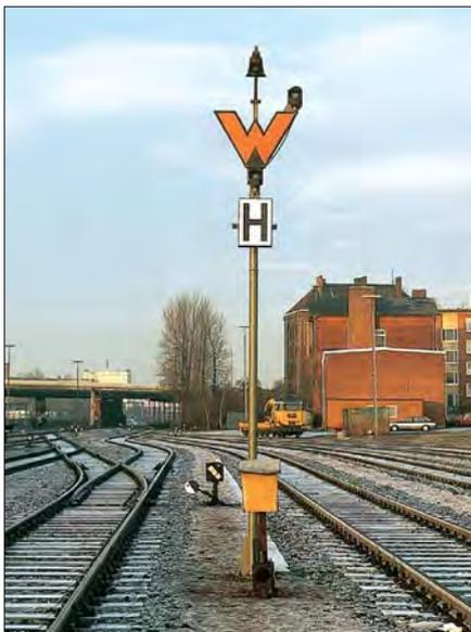
Wartezeichen mit Haltetafel an einem Einfahrgleis des Rbf Hmb-Rothenburgsort im Dezember 1984. Die Haltetafel begrenzt den Einfahrweg für Zugfahrten. Über das Signal hinaus sind nur Rangierfahrten zulässig, für die der Auftrag mit dem Sh 1-Signal erteilt wird.
