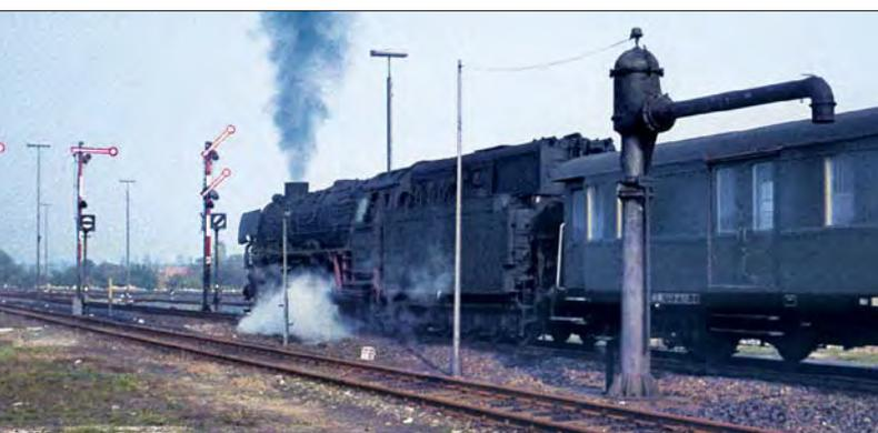
012 064-2 verlässt am 10. Oktober 1970 mit einem Eilzug nach Norddeich-Mole den Bahnhof Emden-West. Der am durchgehenden Hauptgleis stehende Wasserkran müsste mit einem Wasserkransignal ausgerüstet sein.
