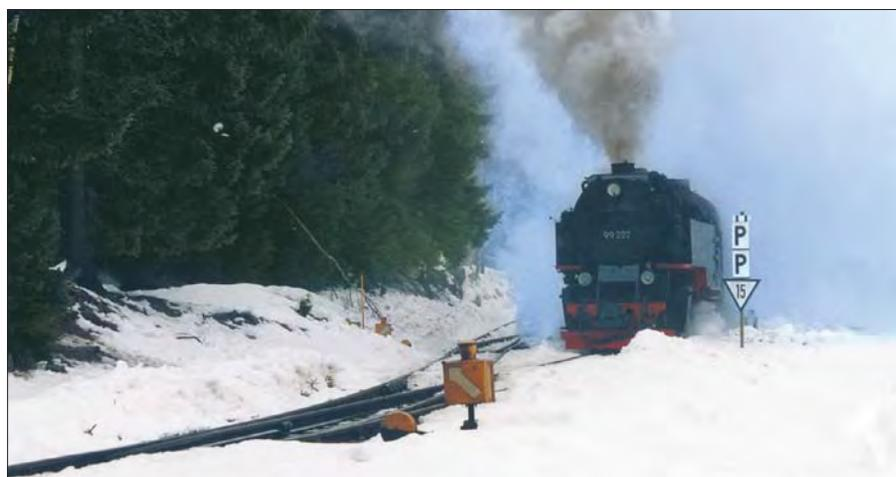
99 222 der HSB verlässt im Februar 2004 den Bahnhof Schierke mit einem Zug zum Brocken. Im Vordergrund das Signal einer Rückfallweiche, die der ausfahrende Zug gleich aufschneiden wird. Neben der Lok Pfeif- und Geschwindigkeitstafeln für einen Wegübergang am anderen Bahnhofsende.
