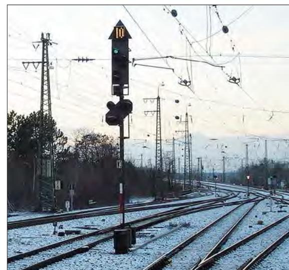
Geschwindigkeitsanzeiger der Einheitsbauform für 100 km/h an einem Hauptsignal bei München-Pasing im Dezember 2003, im Hintergrund leuchtet ein Richtungsanzeiger auf.
