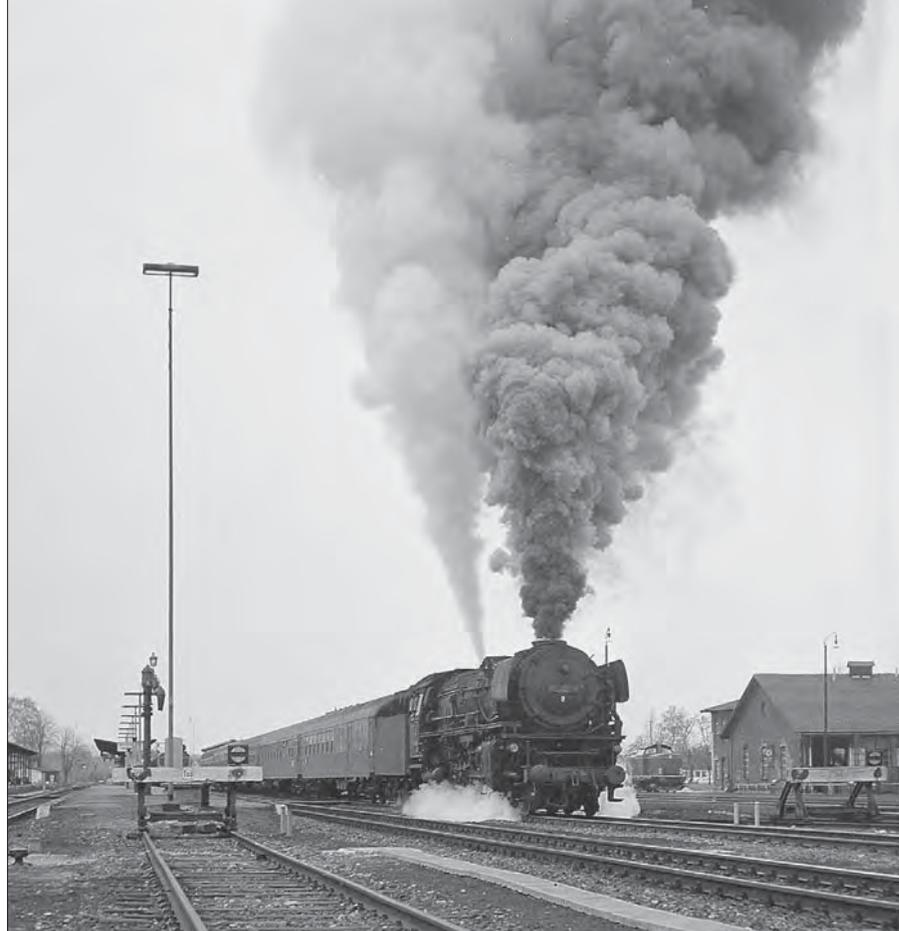
Für die bevorstehende Fahrt mit dem E 659 Bamberg–Hof über die Schiefe Ebene hatte der Heizer der 001 180-2 am 21. März 1973 Spitzendruck erzeugt. Da das Ladegeschäft an diesem Tag länger dauerte, verzögerte sich die Abfahrt um zwei Minuten, was die Lok mit dem Abblasen der Sicherheitsventile quittierte. Rechts und links zwei Prellböcke mit Sh 0-Scheiben.
