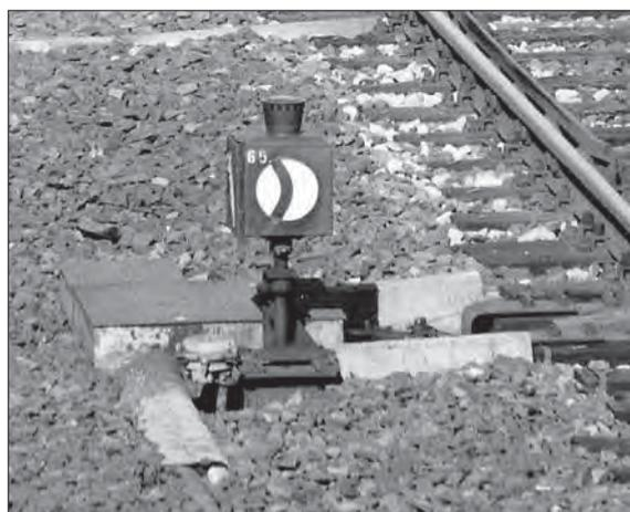
Bei Innenbogenweichen zeigt das Signal den Fahrweg durch den stärker gekrümmten Zweig an, bei Außenbogenweichen wird das Signalbild, zur Vermeidung von Missverständnissen, stets für beide Richtungen verwendet.
