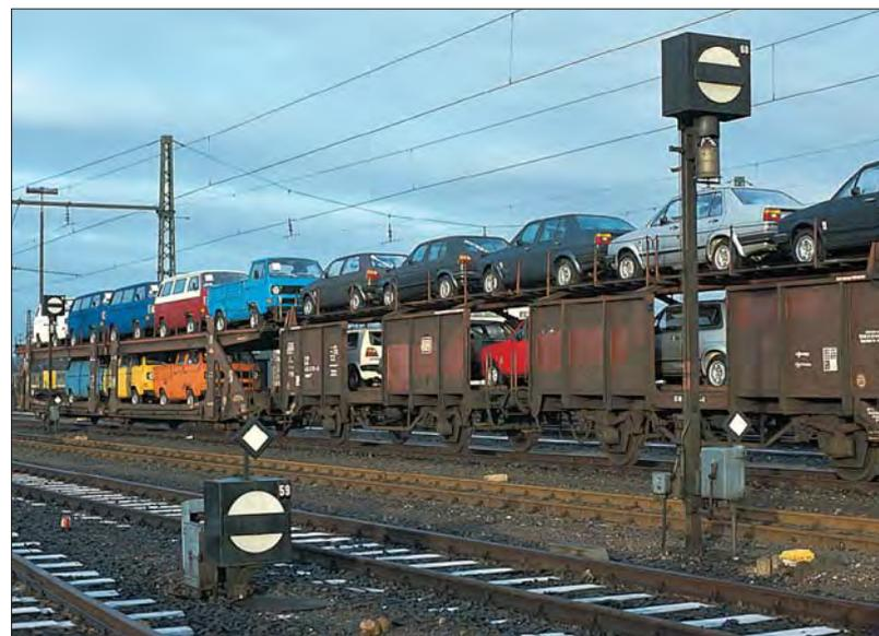
unter 4,50 m ein Form-Sperrsignal erforderlich ist und der Gleisabstand nur mit verhältnismäßig hohen Kosten vergrößert werden kann. Daneben werden sie aber auch verwendet, wenn vor Zwerghauptsignalen ein Gleissperrsignal aufgestellt werden muss und ein hohes Sperrsignal das Signalbild des Hauptsignals verdecken würde.
