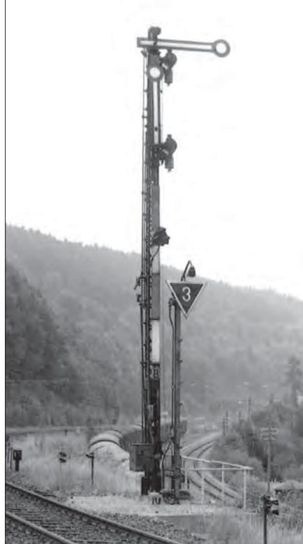
Da aus Stuttgart häufig in ein Stumpfgleis eingefahren wurde, wurde hier der Geschwindigkeitsanzeiger in der Regel gezeigt.
