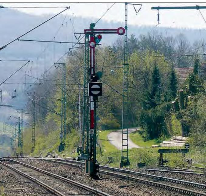
Links: Da in Goldshöfe an einer Umfahungsstrecke für Lü-Sendung liegt, wird an dem durchgehenden Hauptgleis der erweiterte Regellichtraum freigehalten. Aus dem Grund steht vor dem linken Ausfahrtsignal im Mai 2005 ein (750 mm höheres) Sperrsignal mit Flanschfuß.
