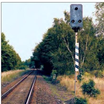
Rechts: Blinklicht-Überwachungssignale der am 31.10.1968 bei der DR eingeführten Bauform in etwa 1,5-facher H0-Größe. Links: Das Signalbild So 16a, rechts: So 16b.
