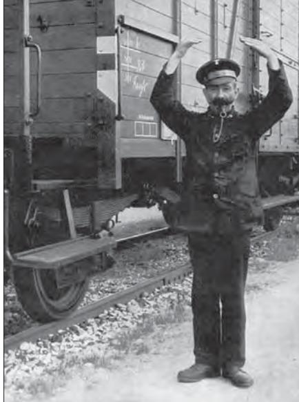
Während der Fahrt an den Radreifen schleifende Bremsklötze könnten zu Heißläufern und somit im Extremfall zu Entgleisungen führen. Deshalb muss der Mitarbeiter, der die Bremsprobe durchführt, nach dem Lösen der Bremse den ganzen Zug abgehen und überprüfen, ob sich die Bremsklötze von den Radreifen gelöst haben.
