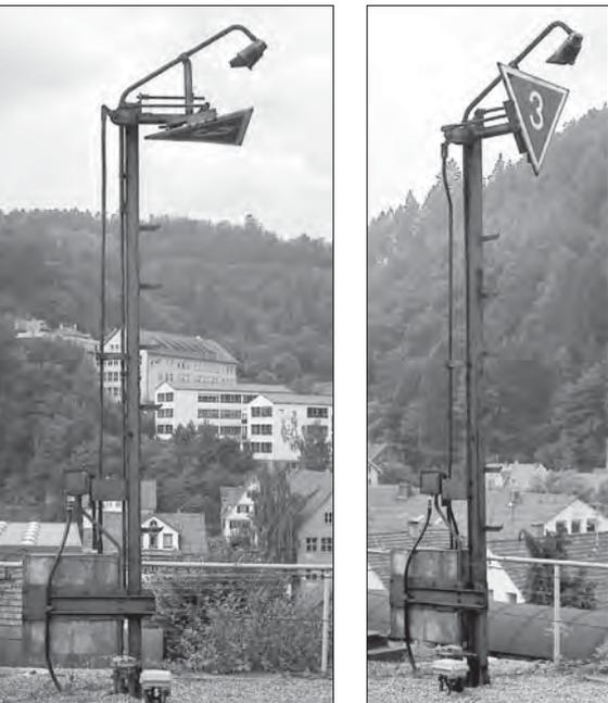
Verstellbarer Geschwindigkeitsanzeiger (vor dem Einfahrsignal aus Richtung Stuttgart) im Bahnhof Calw im August 1981
