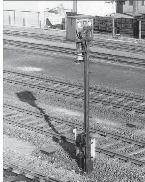
Rückansicht eines Gleissperrsignals im Bahnhof Mölln im Juli 1979. Auf dem Bild ist zu erkennen, dass rückseitig die untere Blende bei diesem Signal, obwohl nicht mehr erforderlich, nicht demontiert wurde.
