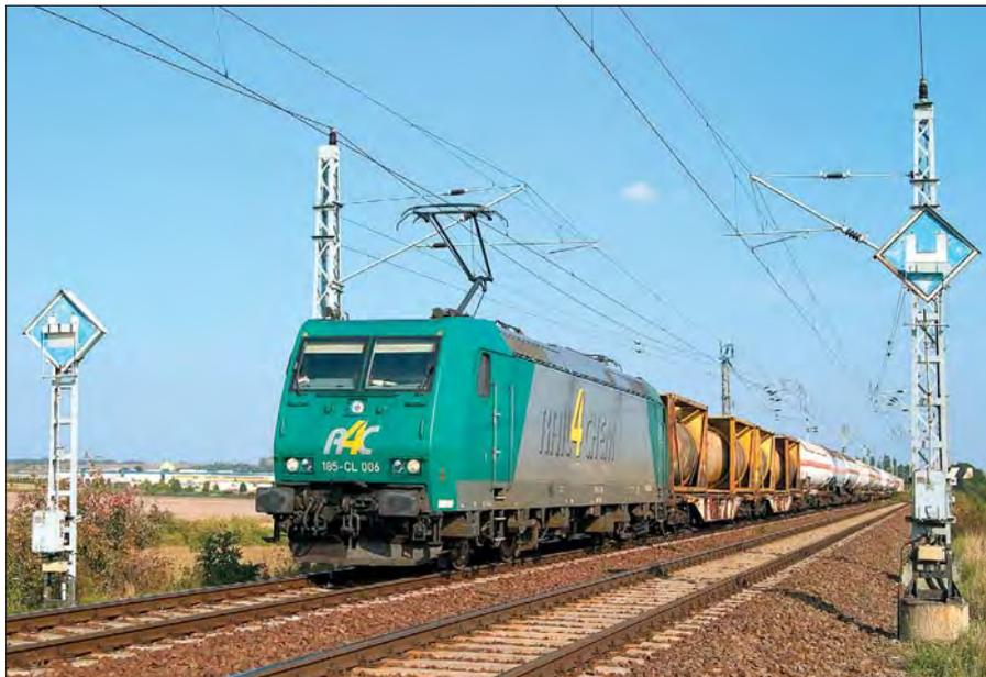
185 CL 006 rail4chem passiert am 9. September 2005 die verstellbaren Aus-/Einschaltsignale der Regelschutzstrecke Teutschenthal. Foto Uwe Böhme
