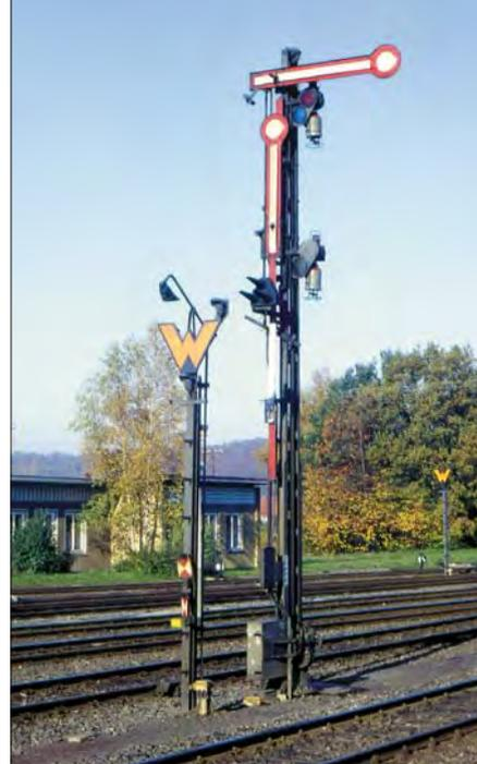
Hingegen stehen im Oktober 1984 im Bahnhof Herzberg die mit Anstrahlleuchten ausgerüsteten Wartezeichen an separaten Masten vor den Hauptsignalen. Foto Horst Müller-Kuntzer
