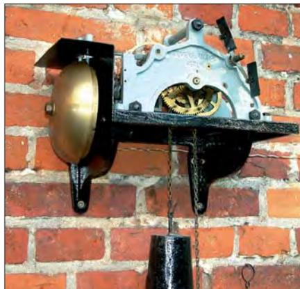
Bahnsteigläutewerke waren meist am Empfangsgebäude der Landbahnhöfe zu finden. Bei dem zweiglockigen Typ von Siemens & Halske (S&H) ist der Schutzkasten abgenommen.
