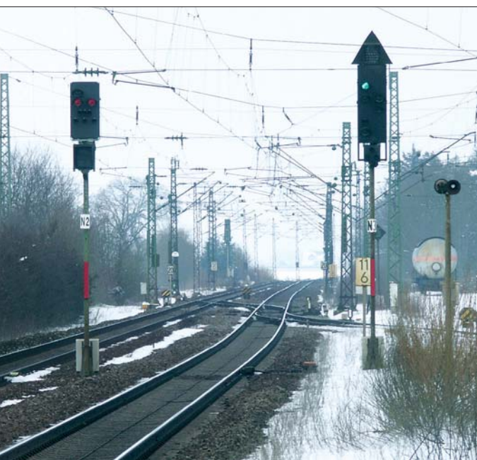
Links: Ausfahrsignale des Bahnhofs Gablingen im Februar 2005. Am Gleis der Gegenrichtung ist ein Kompaktsignal aufgestellt. Im Hintergrund sind die Geschwindigkeitssignale mit der Kennziffer 20 aufgestellt, die für die Fahrt aus dem Überholungs-gleis von Bedeutung sind.
