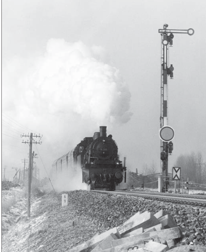
078 246-6 verlässt am 28. Februar 1974 mit dem P 3906 Villingen–Rottweil den Bahnhof Deißlingen. Daneben das 10 m hohe Einfahr-signal und das Ausfahrsvorsignal der Gegenrichtung.
