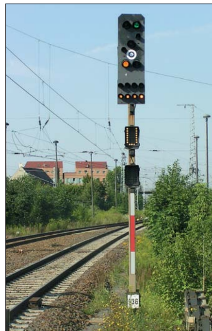
Links: In Berlin-Ostbahnhof standen Lichtsignale, die vmtl. ursprünglich als Haltauftrag das Signal Hsp „Halt für Züge und Rangierabteilungen“ zeigten, bei Aufhebung des Fahrverbots für Rangierfahrten als HI 100 ein rotes Licht und darunter die beiden Lichter des Signals Ra 12. Das Foto zeigt eines dieser Signale, das am 16. November 1991 für einen D-Zug nach Hamburg das Signal HI 3a „Fahrt mit 40 km/h im Weichenbereich, dann mit Höchstgeschwindigkeit“ zeigt (wobei die Höchstgeschwindigkeit auf der Berliner Stadtbahn begrenzt war).
