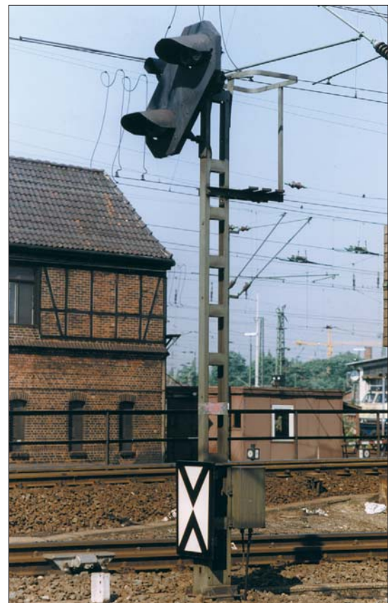
Ein Vorsignalwiederholer der Ursprungsbaumform im Bf Parsberg im Oktober 2004. Foto Alexander Lindner
