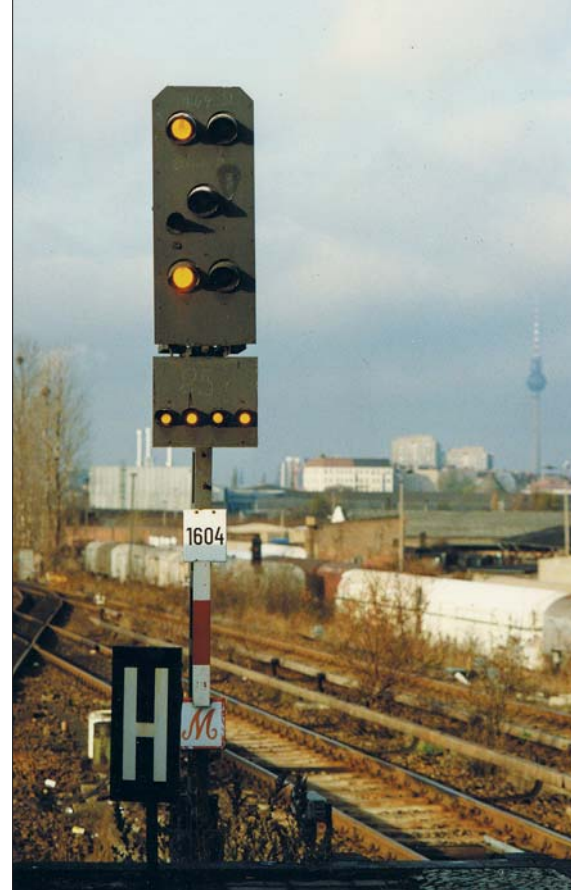
HI 9b – das obere Licht blinkt – „Fahrt mit 60 km/h“ an dem Ausfahrsignal des S-Bahnhofs Ostkreuz in Richtung Berlin-Ostbahnhof im November 1991
