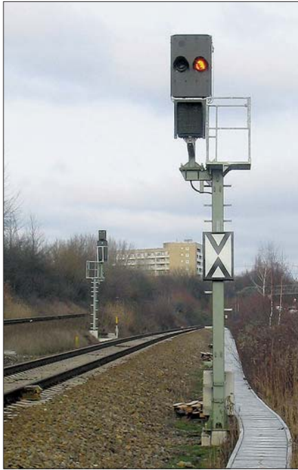
Einfahrtssignal des Bahnhofs Lübeck Hbf mit Geschwindigkeitsvoranzeiger als Lichtsignal im Januar 2004. Im Hintergrund ein Mehrabschnittssignal für die Gegenrichtung.
