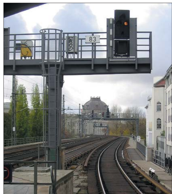
Ein Ks-Hauptsignal mit Leuchtdioden-Signalschirm im S-Bahnhof (Hamburg-) Bergedorf im August 2005
