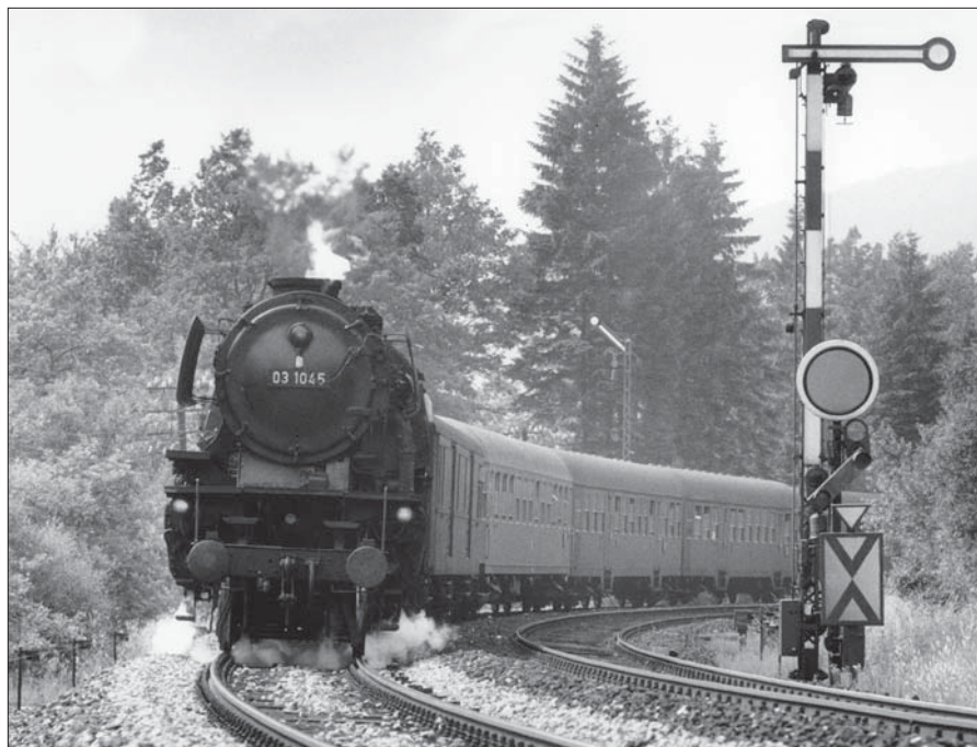
03 1045 mit dem D397 Köln–Kassel auf der Steigung bei Elleringhausen im Juni 1966. Vor dem Blocksignal der Gegenrichtung steht ein Vorsignal mit Lichtlenkkasten. Die Vorsignaltafel besitzt ein Aufsatzdreieck, um anzuzeigen, dass das Vorsignal im verkürzten Bremswegabstand zum nächsten Hauptsignal steht. Foto Ludwig Rotthowe
