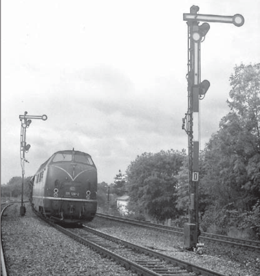
Ausfahrtsignale des Bahnhofs Reinfeld im Sommer 1983. Neben 221 128-2 ein Schalmast-Signal, rechts ein Gittermastsignal.
