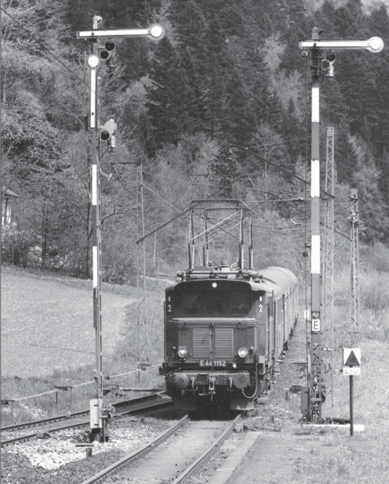
E 44 1152 mit einem Personenzug nach Freiburg am 12. Mai 1967 im Bahnhof Posthalde. Die beiden 10 m hohen Signale stehen unmittelbar vor dem Zusammenlauf der Gleise, vor dem rechten Signal ein von der DB eingeführter Neigungswechselanzeiger. Foto Ludwig Rotthowe
