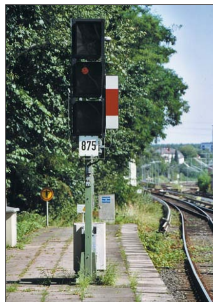
Ein Ks-Hauptsignal mit Leuchtdioden-Signalschirm im S-Bahnhof (Hamburg-) Bergedorf im August 2005
