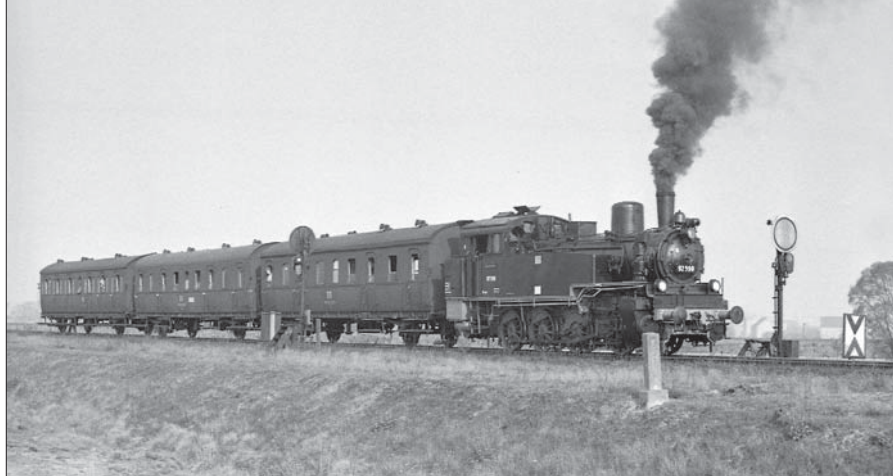
92 598 mit einem DMV-Sonderzug am 7. Oktober 1973 zwischen Guben und Forst. Vor dem ersten Wagen und rechts neben der Lok stehen Vorsignale mit jeweils nur einer Laterne. Slg. SC
