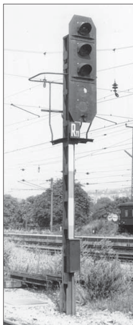
Links und oben Mitte das der Bauform 1943 entsprechende Einfahrtsignal des Bahnhofs Niklasdorf. Foto Pfeiffer, Slg. Heless. Oben rechts ein Ausfahrtsignal des Bahnhofs Wien-Hütteldorf im August 1964. Foto Hermann Heless
