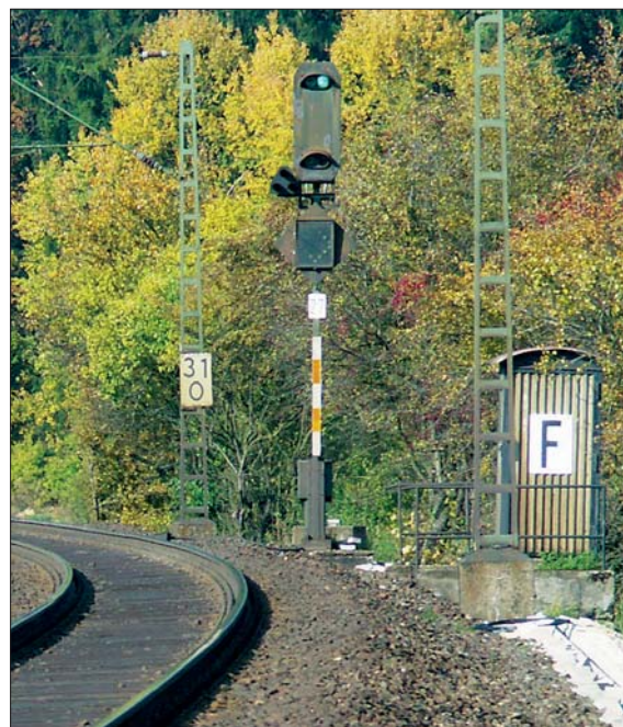
Ein Selbstblocksignal mit Beschleunigungs-/Verzögerungsanzeiger im Oktober 2004 in Mausheim. Das Mastschild erlaubt bei Störungen die Vorbeifahrt auf Sicht. Foto Lindner
