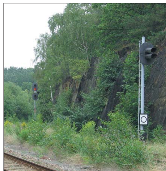
Links: EZMG-Ausfahrtsignale des Bahnhofs Loitsch-Hohenleuben im August 2004. Das linke Signal kann Hp 0, HI 3 sowie Hp 0 zusammen mit dem Rangierfahrtsignal anzeigen, das rechte Hp 0, HI 1 und Rangierfahrtsignal.
