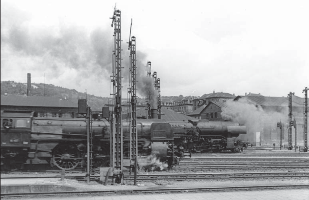
Nicht immer lassen sich Ausfahrtsignale in einer Reihe aufstellen. Das Bild aus Horb zeigt den von 038 553-4 geführten P 4135 nach Freudenstadt, der am 14. Juli 1971 den Bahnhof in Richtung Eutingen verlässt. Links ein Ausfahrtsignal an der Strecke nach Tübingen.
