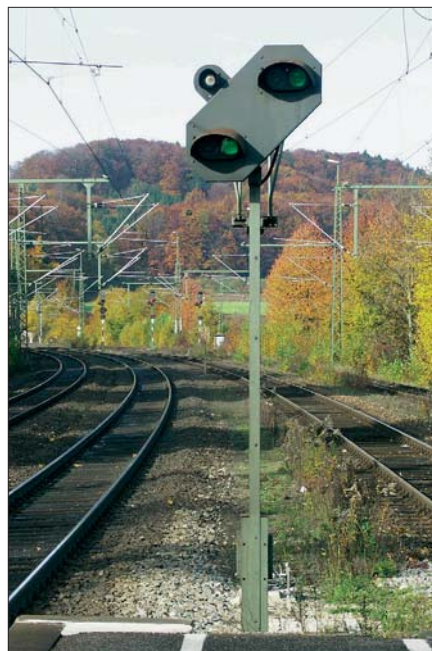
Ein Vorsignalwiederholer der Ursprungsbaumform im Bf Parsberg im Oktober 2004. Foto Alexander Lindner
