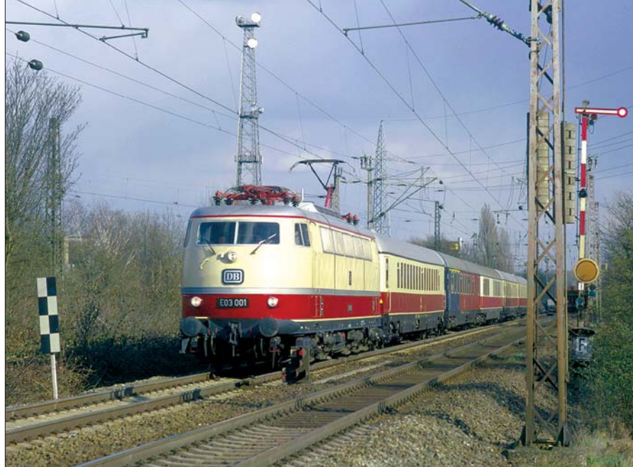
Die DB-Museumslok verlässt mit einem Sonderzug 2003 den Bf Hannover-Ahlem. Vor der Lok das SFB-Einfahrsignal, dessen Standort mit einer Schachbretttafel gekennzeichnet ist, da das Signal für die Fahrt auf dem falschen Gleis nicht links steht. Foto DB AG, Müller
