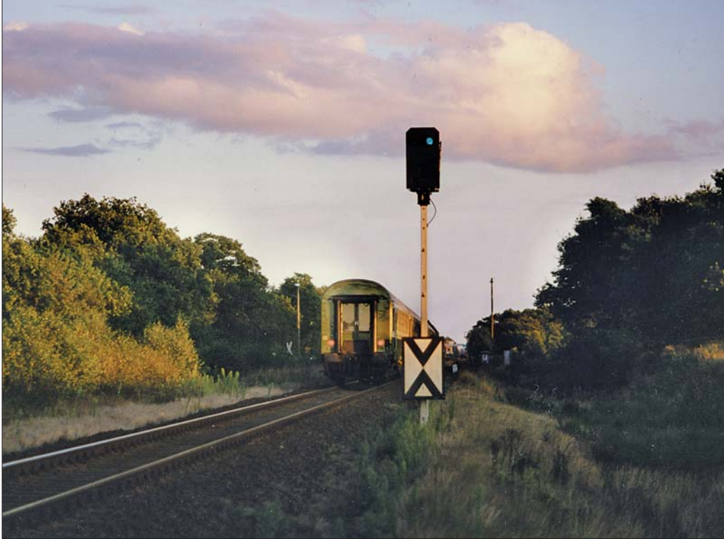
HL 1 „Fahrt mit Höchstgeschwindigkeit“ für den E 2837 Hamburg Hbf–Schwerin am Einfahrsvorsignal des Bahnhofs Schwanheide am Abend des 12. September 1991.
