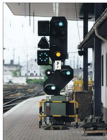
Beschränkte Platzverhältnisse erfordern besondere Lösungen für die Anordnung von Signalen und Zusatzanzeigern: Hp 2, Vr 1 und Zp 9 in Koblenz Hbf. Foto Gerhard Scholtis
