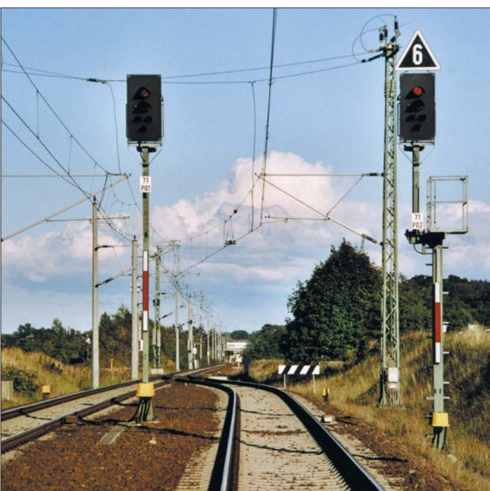
Links: Ausfahrtsignale mit Vorsichtsignalen in einem Kreuzungsbahnhof an der Fernsteuerstrecke Velgast-Stralsund kurz vor Stralsund im September 2005. Das Hauptsignal am Überholungsgleis besitzt einen Geschwindigkeitsanzeiger für 60 km/h.
