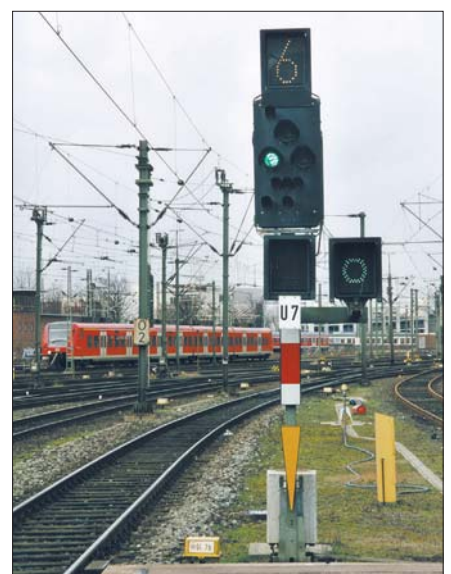
Ks-Mehrabschnittssignal als Ausfahrtsignal in Hannover Hbf im Februar 2004. Das Signal ist mit Geschwindigkeits- und Voranzeiger sowie einem Abfahrtauftragsignal ausgerüstet.
