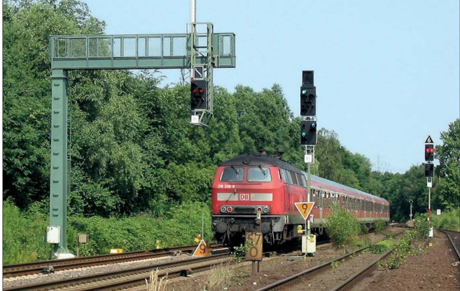
Ausfahrtsignale des Bahnhofs Hamburg-Wandsbek im Juli 2004 mit einer Richtung Ahrensburg ausfahrenden Regionalbahn. Um die Linksaufstellung zu vermeiden, musste das links stehende Ausfahrtsignal an einem Ausleger montiert werden.
