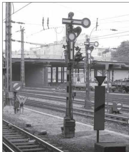
Niedrige Schalmast-Ausfahrtsignale mit Stummelflügeln und Gleissperrsignale im Bahnhof Hamburg Hbf in den 70er Jahren fotografiert. Foto Benno Wiesmüller
