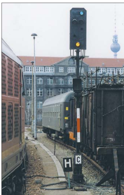
Links: In Berlin-Ostbahnhof standen Lichtsignale, die vmtl. ursprünglich als Haltauftrag das Signal Hsp „Halt für Züge und Rangierabteilungen“ zeigten, bei Aufhebung des Fahrverbots für Rangierfahrten als HI 100 ein rotes Licht und darunter die beiden Lichter des Signals Ra 12. Das Foto zeigt eines dieser Signale, das am 16. November 1991 für einen D-Zug nach Hamburg das Signal HI 3a „Fahrt mit 40 km/h im Weichenbereich, dann mit Höchstgeschwindigkeit“ zeigt (wobei die Höchstgeschwindigkeit auf der Berliner Stadtbahn begrenzt war).
