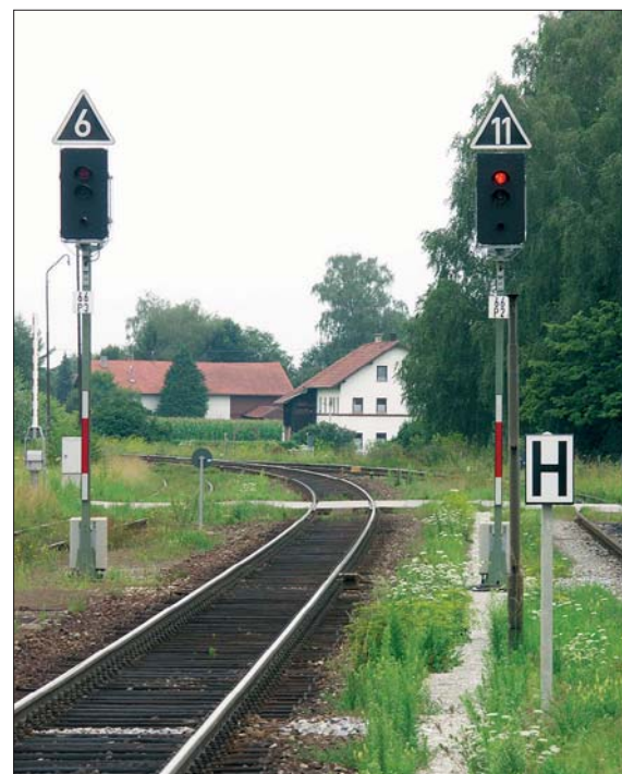
Rechts: Ausfahrtsignale mit Ersatzsignalen im Bahnhof Dorfen im Juli 2005. Die Geschwindigkeitsanzeiger zeigen am durchgehenden Hauptgleis 110 km/h, für das Überholungsgleis 60 km/h, wobei die unterschiedlichen Ausführungen der „6“ Beachtung verdienen.
