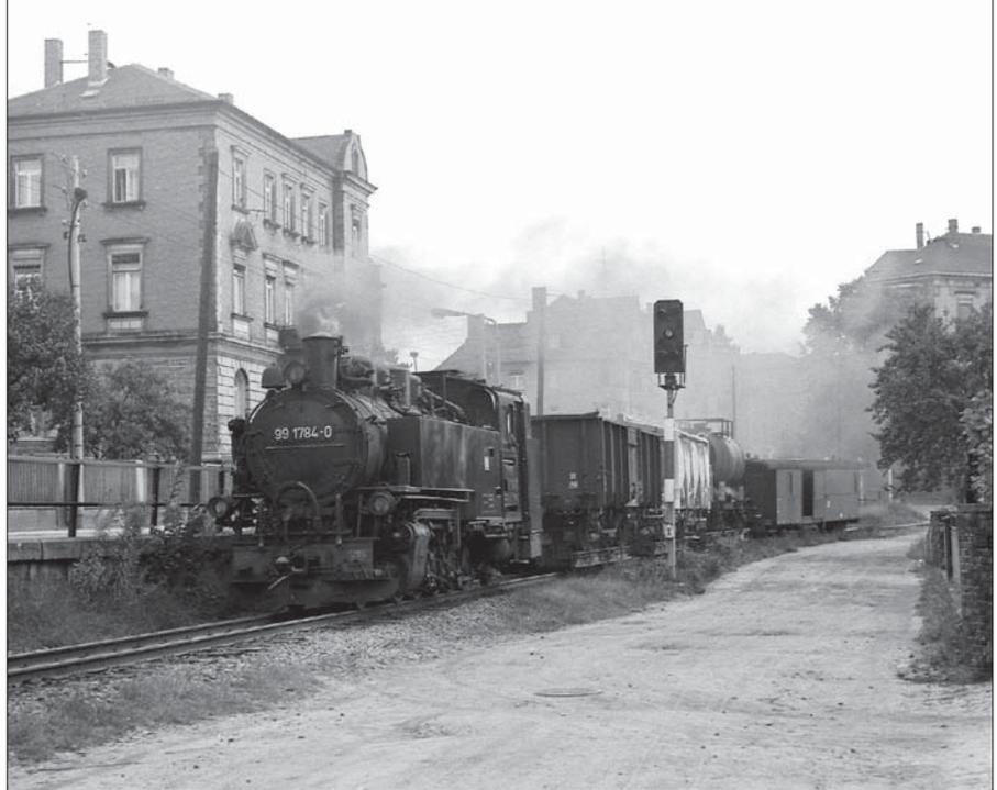
99 1784-0 am 17. September 1977 mit einem Rollbockzug in Radebeul. Das Einfahrsignal ist ein WSSB-Signal der Einheitsform mit niedrigem Betonmast und hat, wie bei Einfahrsignalen üblich, ein breites Mastschild. *Sammlung SC*
