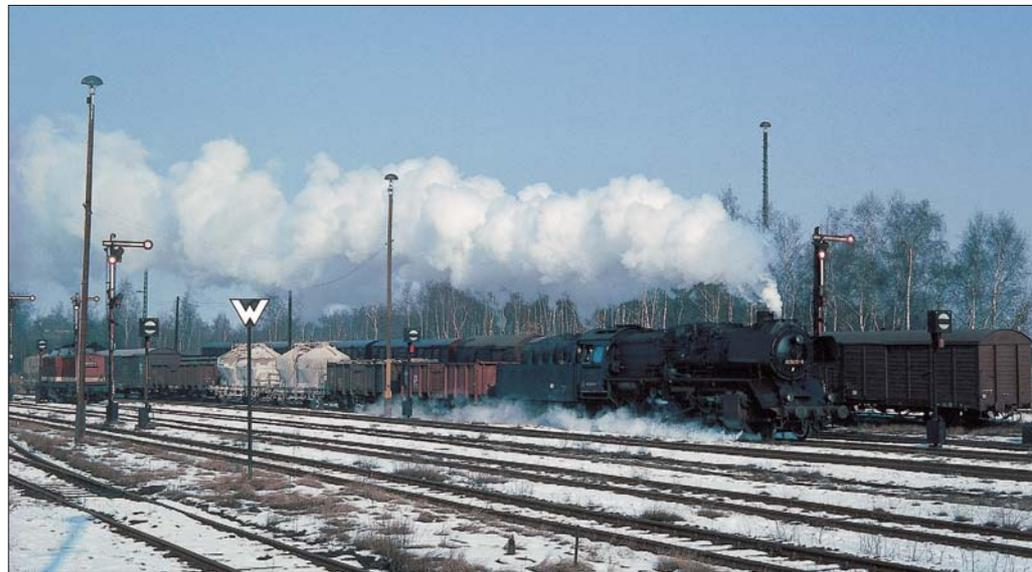
50 3672-8 vom Bw Glauchau verlässt am 23. Februar 1984 mit dem Ng 65319 den Bahnhof Oelsnitz. Im Vordergrund ein unbeleuchtetes weißes Wartezeichen mit einem Rohrmast. Die Hauptsignale sind, obwohl vor ihnen Sperrsignale zur Aufhebung der Gleissperrung für Rangierfahrten stehen, mit Rautentafeln ausgerüstet, da durch die Fahrtstellung der Sperrsignale kein Fahrauftrag erteilt wird. Foto Volker Fröhmer
