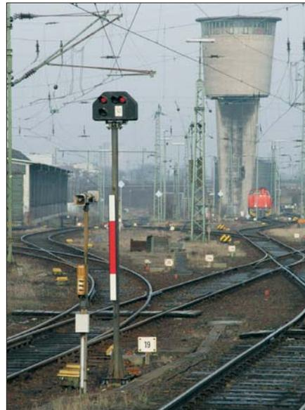
Hohes Sperrsignal mit dem 1958 von Siemens entwickelten Signalkopf im Januar 2006 im Bahnhof Hamburg-Altona
