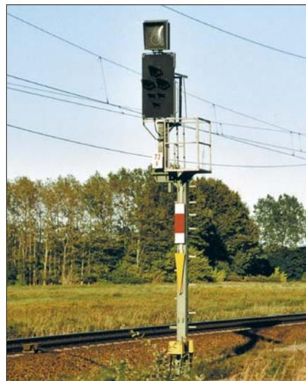
Ks-Mehrabschnittsignal mit Geschwindigkeitsanzeiger für 60 km/h als Einfahrsignal des Bf Martensdorf im September 2005
