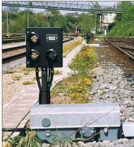
1999 wurden Lichtsignale für Weichen neu in das Signalbuch aufgenommen. Diese bei elektrisch ortsgestellten Weichen verwendeten Signale zeigen den eingestellten Fahrweg bei einfachen Weichen durch zwei Lichtpunkte an – Lübeck Hbf Mai 2004.
