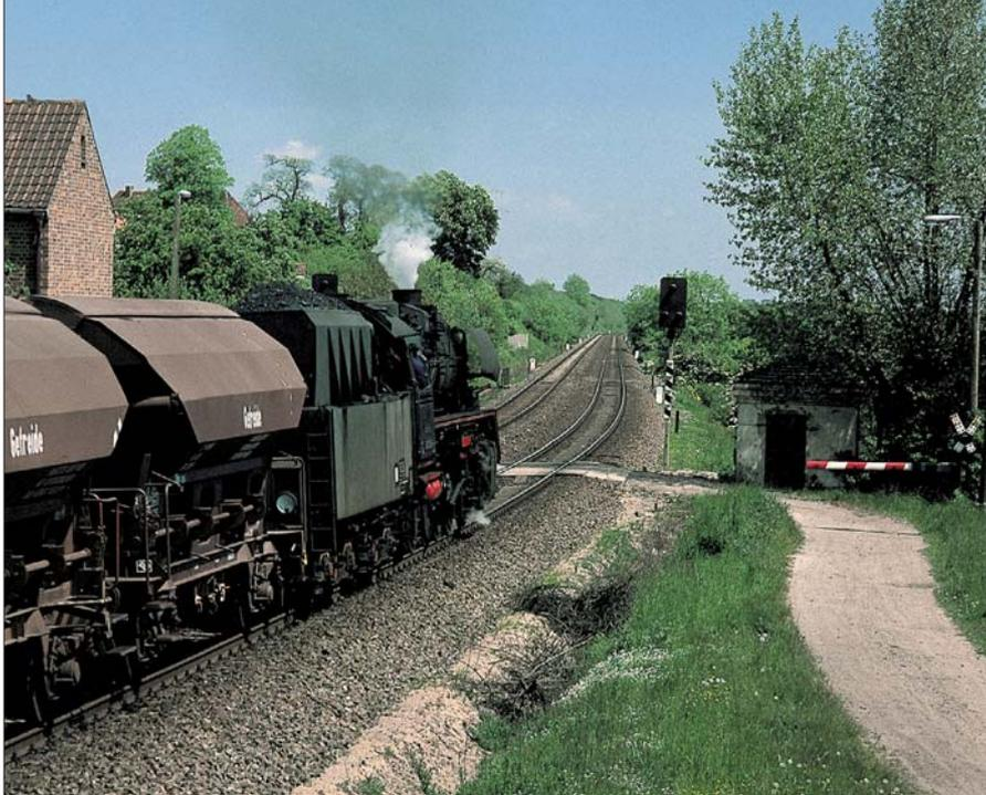
50 4009-2 am 27. Mai 1977 mit einem Dg auf der Fahrt von Bad Kleinen nach Güstrow. Hinter dem Bahnübergang steht ein Blinklicht-Überwachungssignal der von der DR 1971 eingeführten Form mit zusätzlichen gelben Lichtern unter dem weißen Licht, das anzeigt, dass der Wegübergang gesichert ist
