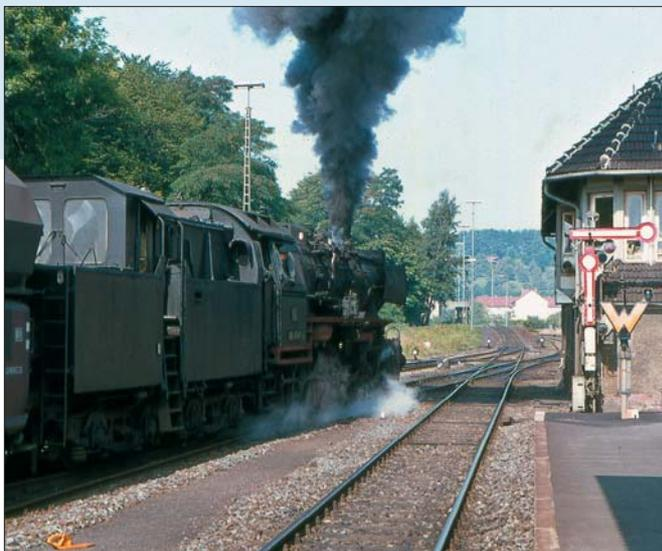
052 478-5 fährt mit einem Dg Richtung Northeim aus. Rechts im Bild das Fahrdienstleiterstellwerk „Hmf“ sowie das wegen des Bahnsteigdachs niedrige Ausfahrtsignal P4, im Hintergrund der Ablaufberg
