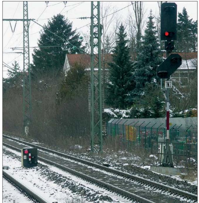
**Geschwindigkeits-signal für 80 km/h und Geschwindigkeitsankündesignal für 70 km/h am Fuß des Einfahrsignals des Bahnhofs Itzehoe im August 1991**
