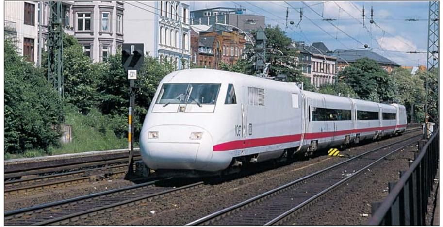
Da an den Sv-Signalen der Hamburger Gleichstrom-S-Bahn der weiße Pfeil bzw. Balken für den verkürzten Bremsweg ab 1972 für alle Signalbilder vorgeschrieben war, wurden die Signale – um nicht die Schaltung ändern zu müssen – z. T. mit entsprechenden Reflektorschildern ausgerüstet. Das Foto zeigt ein solches Signal zwischen dem Bahnhof Sternschanze und Hamburg-Dammtor im Juni 1988 mit dem ICE-Versuchszug. Drei Jahre später stand an der gleichen Stelle ein neues Signal (vgl. Band 2).
