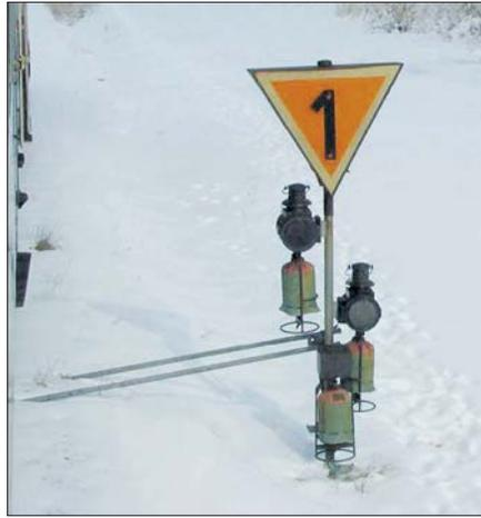
Zwei weitere Signale an der Strecke nach Frontenhausen: Eine Langsamfahrtafel, das 1935 neu eingeführte Signal Lf 1 und ...
