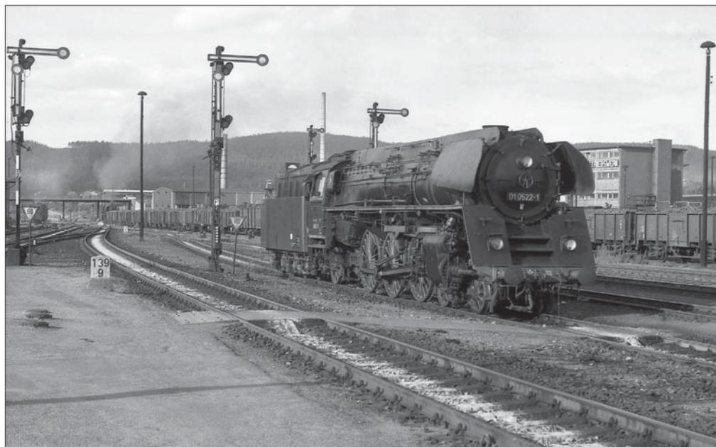
Bf Saalfeld am 16. September 1979. Vorn rollt 01 0522-1 ins Heimat-Bw. Im Hintergrund macht sich eine 44 mit einem Güterzug auf den Weg nach Unterwellenborn. Vor den Ausfahrtsignalen stehen Geschwindigkeitstafeln, die aus beiden Gleisen die Ausfahrt mit 60 km/h erlauben.
