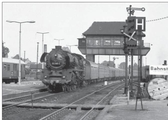
03 2180-2 kommt am 24. August 1974 mit dem E 544 aus Berlin in Stendal an. Zwischen dem Ausfahrtsignal und der H-Tafel im Vordergrund steht ein HI-Signal des neuen Gs II Dr-Stellwerks, das im Dezember 1974 in Betrieb ging.
