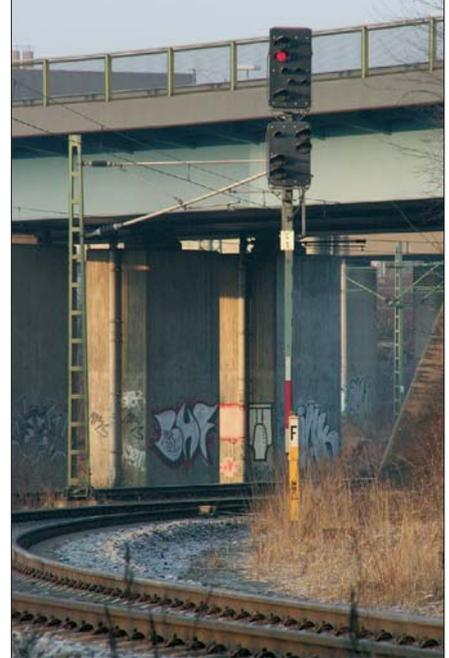
Einfahr- und Ausfahrvorsignal des Bahnhofs Hamburg-Altona am Abzweig Diebsteich im Januar 2006
