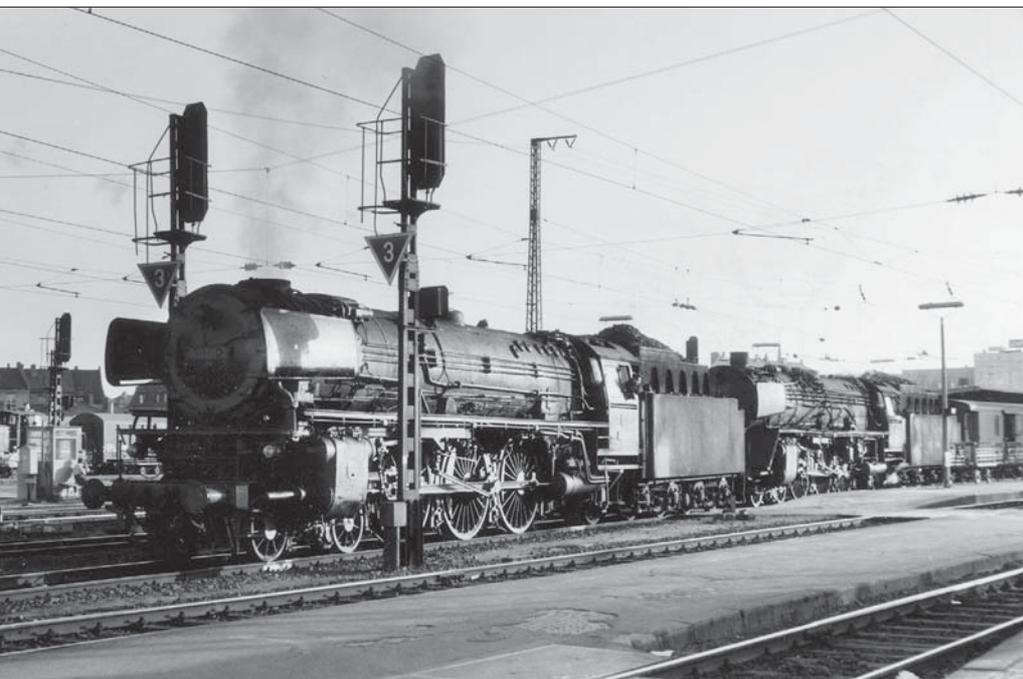
001 131-2 wartete mit einer Schwestermaschine vor dem D 147 nach Hof im April 1971 in Nürnberg Hbf auf den Abfahrtauftrag. Die Lichtsignale wurden 1945 aufgestellt und erst mit Inbetriebnahme des neuen Stellwerks im Jahr 1988 ersetzt. Da hinter den Ausfahrtsignalen am anderen Bahnsteigende kein ausreichender Durchrutschweg vorhanden ist, ist die Einfahrsgeschwindigkeit ab Bahnsteiganfang auf 30 km/h beschränkt. Foto Dr. Peter Kristl
