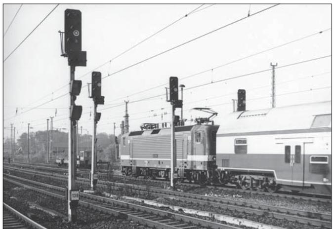
HI-Signale der Einheitsbauform im November 1991 in Potsdam Hbf. Die Signale an den durchgehenden Hauptgleisen sowie das Signal in Bildmitte besitzen Zusatzschirme für einen gelben Lichtstreifen und Zusatzanzeiger. Rechts ein wegen eines Bahnsteigdaches niedriges Signal.
