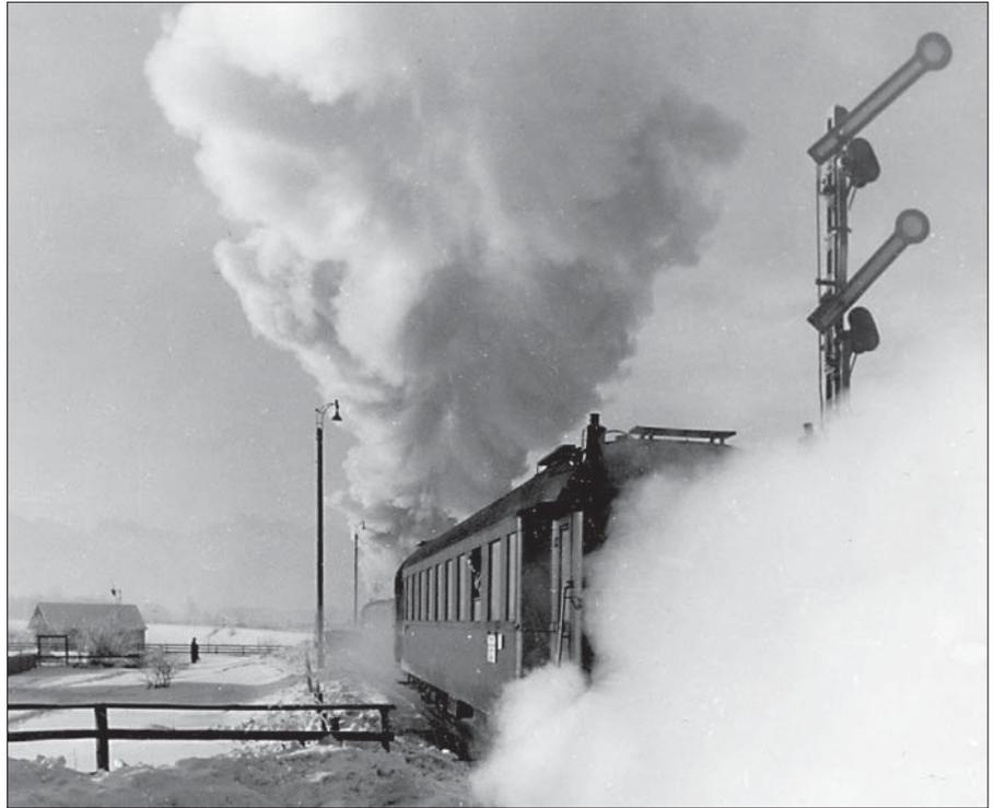
Illertissen im Februar 1956. Der am Schluss des Zuges laufende Wagen führt als Schlussignal zwei Oberwagenlaternen (von der die rechte wegen des aus der Heizleitung ausströmenden Dampfes kaum zu sehen ist). Foto Bustorff, Sammlung SC
