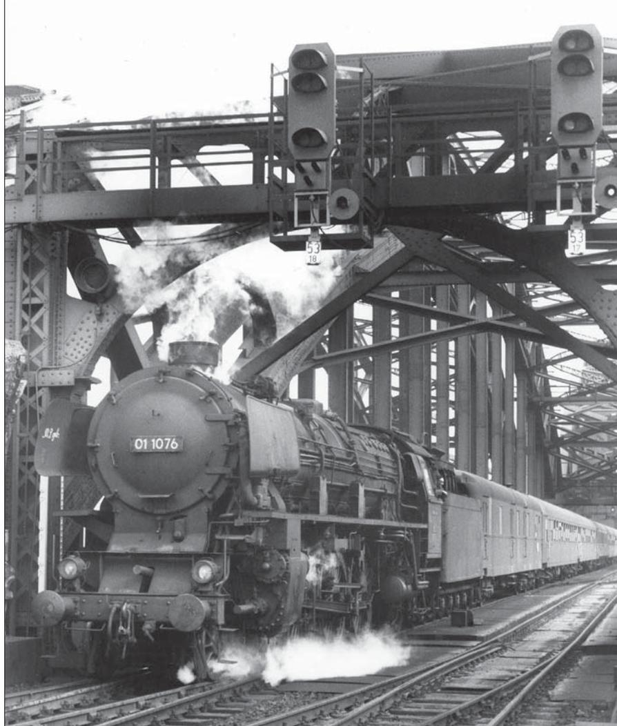
Als Großversuch wurden im Raum Köln 1951 Ma-Signale aufgestellt. Das Foto vom Oktober 1956 zeigt 01 1076 mit einem Schnellzug aus Hamburg auf der Hohenzollernbrücke sowie die beiden Ma-Blocksignale 53/17 und 53/18. Foto Ludwig Rotthowe
