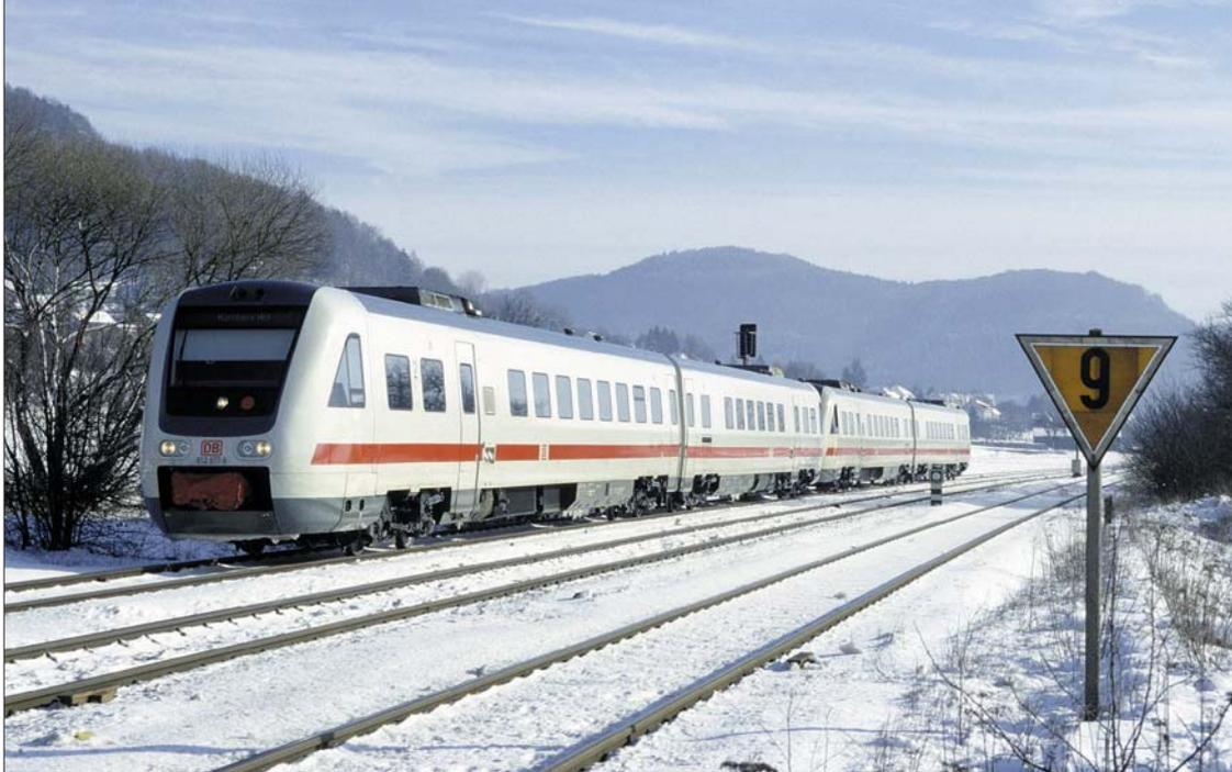
Bislang standen Geschwindigkeits-Ankündesignal und Geschwindigkeits-signale ausschließlich an Hauptbahnen. Bis zum 15. Dezember 2005 mussten die Signale nun auch auf Nebenbahnen nach den gleichen Kriterien aufgestellt werden. Das Bild zeigt ein Lf 6-Signal mit dem 612 977-9 als IC Dresden-München bei Hohenstadt. Foto DB AG, Weber
