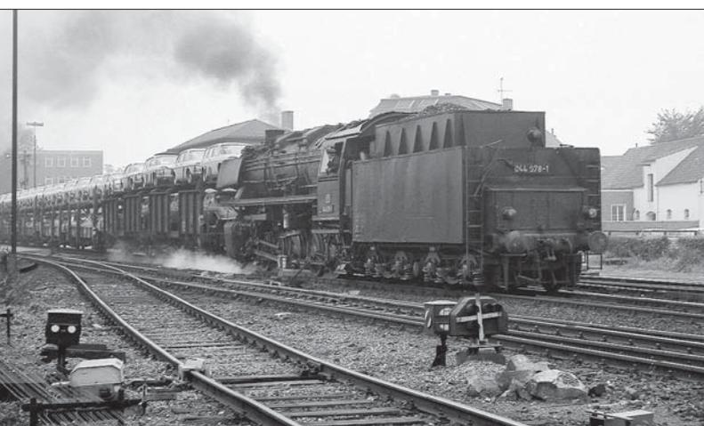
044 578-1 verlässt am 3. September 1971 mit einem VW-Zug nach Emden den Bahnhof Leer/Ostfriesland. Neben der Gleissperre im Bildvordergrund liegt der neue Antrieb, das Lichtsignal ist bereits aufgestellt. Das Sp Dr S60-Stellwerk ging zum Jahresende 1971 in Betrieb.
