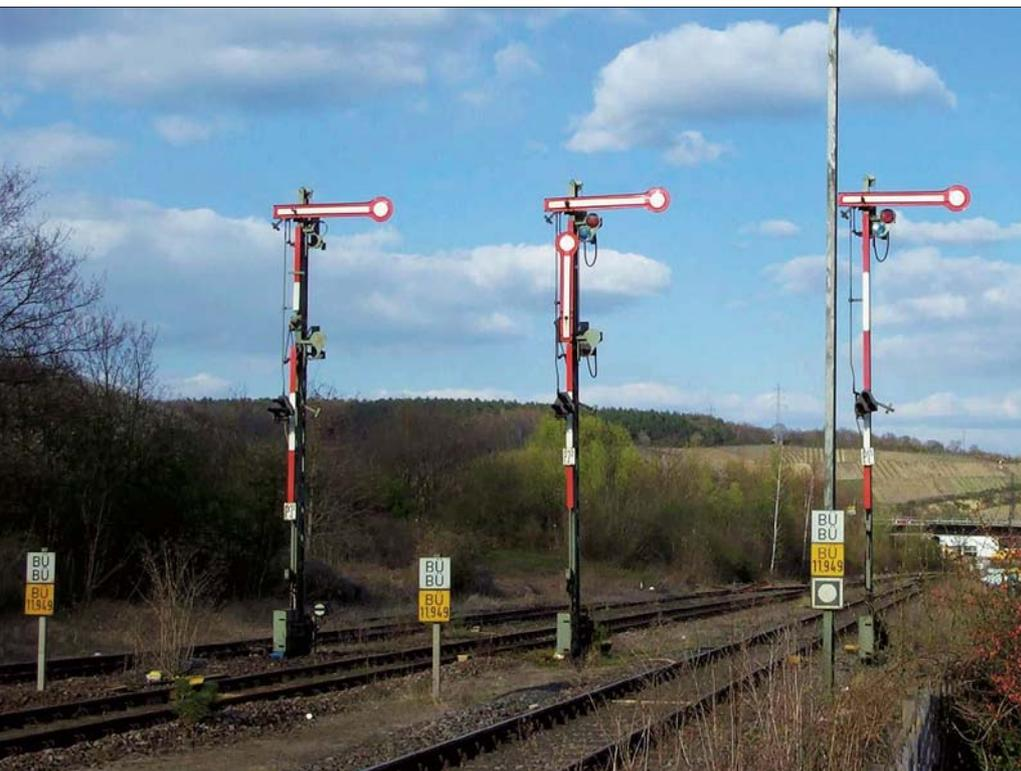
Bahnhof Ahrweiler im April 2003. Das linke Gleis ist außer Betrieb genommen, am Ausfahrtsignal sind der untere Flügel, die Laternen und die Blendengläser demontiert. Vor den Signalen stehen BÜ-Kennzeichentafeln für mehrere Bü und Bü-Ankündetafeln, am durchgehenden Hauptgleis (rechts) als Wiederholer gekennzeichnet. Foto Alexander Lindner
