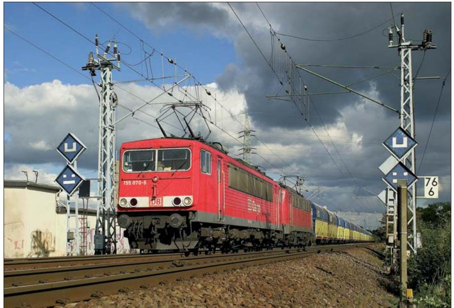
155 070-6 und 140 722-0 fahren mit einem Kohlependel am 30. September 2004 durch die Kuppelstelle Roßla. Rechts und links die 1971 von der DR eingeführten Schaltsignale für verkürzte Schutzstrecken. Foto Uwe Böhme
