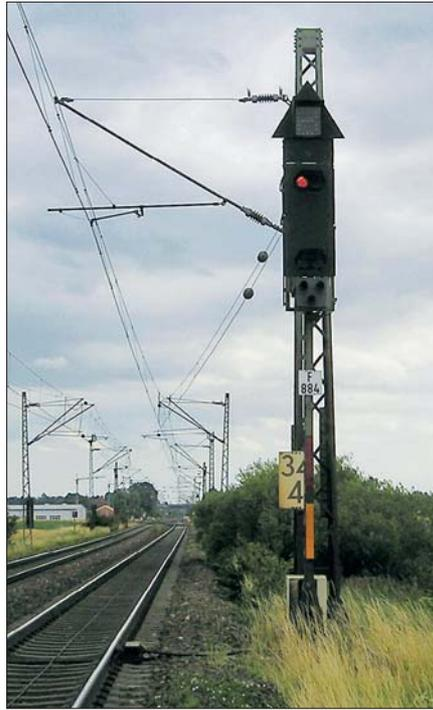
Einfahr- und Ausfahrsvorseignal (mit Geschwindigkeitsanzeiger und Vorsichtsignal) des Bahnhofs Mertingen im Juli 2004.
