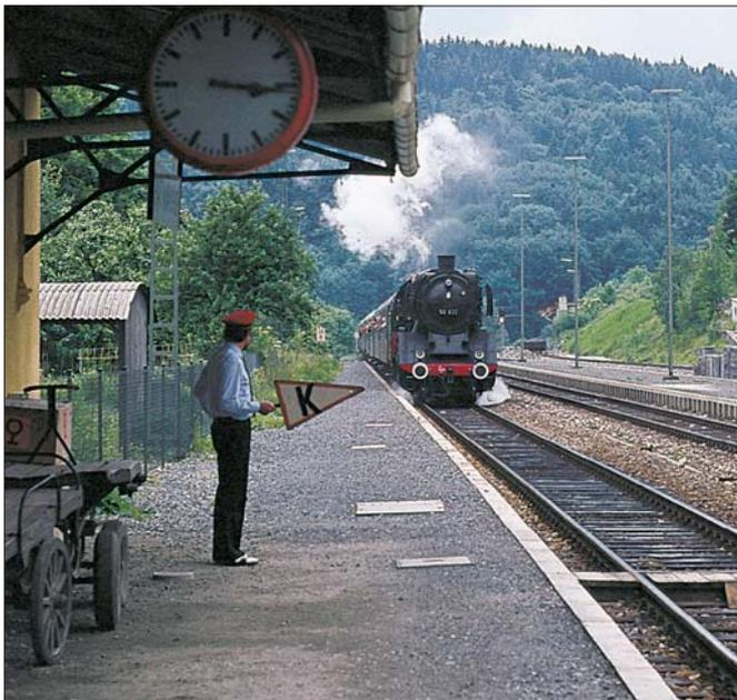
Mit Einführung der Beschleunigungs- und Verzögerungsanzeiger wurden auch K- und L-Scheibe den Zs-Signalen zugeschrieben. Hier zeigt der Fahrdienstleiter des Bahnhofs Hartmannshof dem Lokführer eines von 50 622 gezogenen Zuges im Juni 1985 die K-Scheibe.
