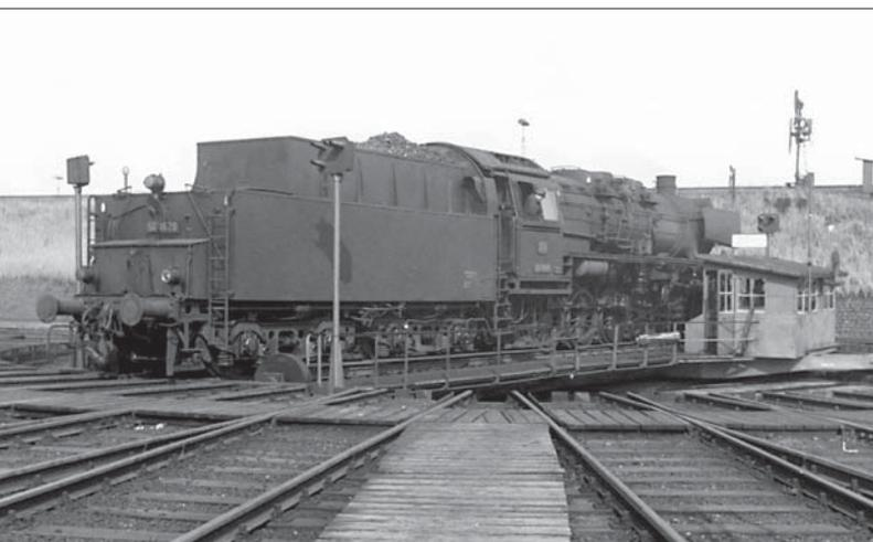
50 1620 am 26. September 1968 auf der Drehscheibe des Bw Hamburg-Rothenburgsort. Die Drehscheibe ist mit Lichtsperrsignalen der ersten Generation ausgerüstet.
