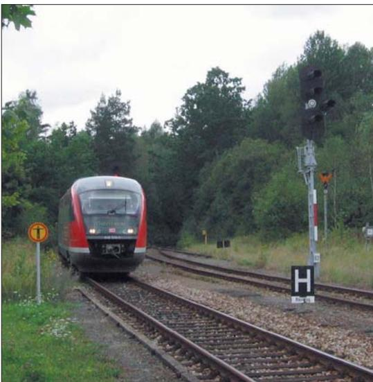
Links: 642 520-1 fährt auf der Fahrt nach Mehltheuer am 24. August 2004 in Pöllwitz ein. Rechts ein EZMG-Signal, allerdings mit einem Stahlmast der Einheitsform.
