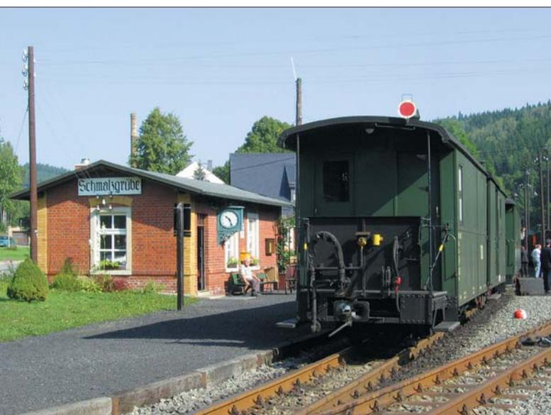
Zweimal eine runde, rot/weiße Scheibe, jedoch mit anderer Bedeutung: Links als Schlussignal eines Zuges – ehemals Signal 18 – am 04. September 2004 im Bf Schmalzgrube (Foto Niels Kunick), rechts an der Rauchkammertür von 82 017 als Falschfahrtsignal – ehemals Signal 17b – im Jahr 1952 im Bw Hamburg-Eidelstedt.
