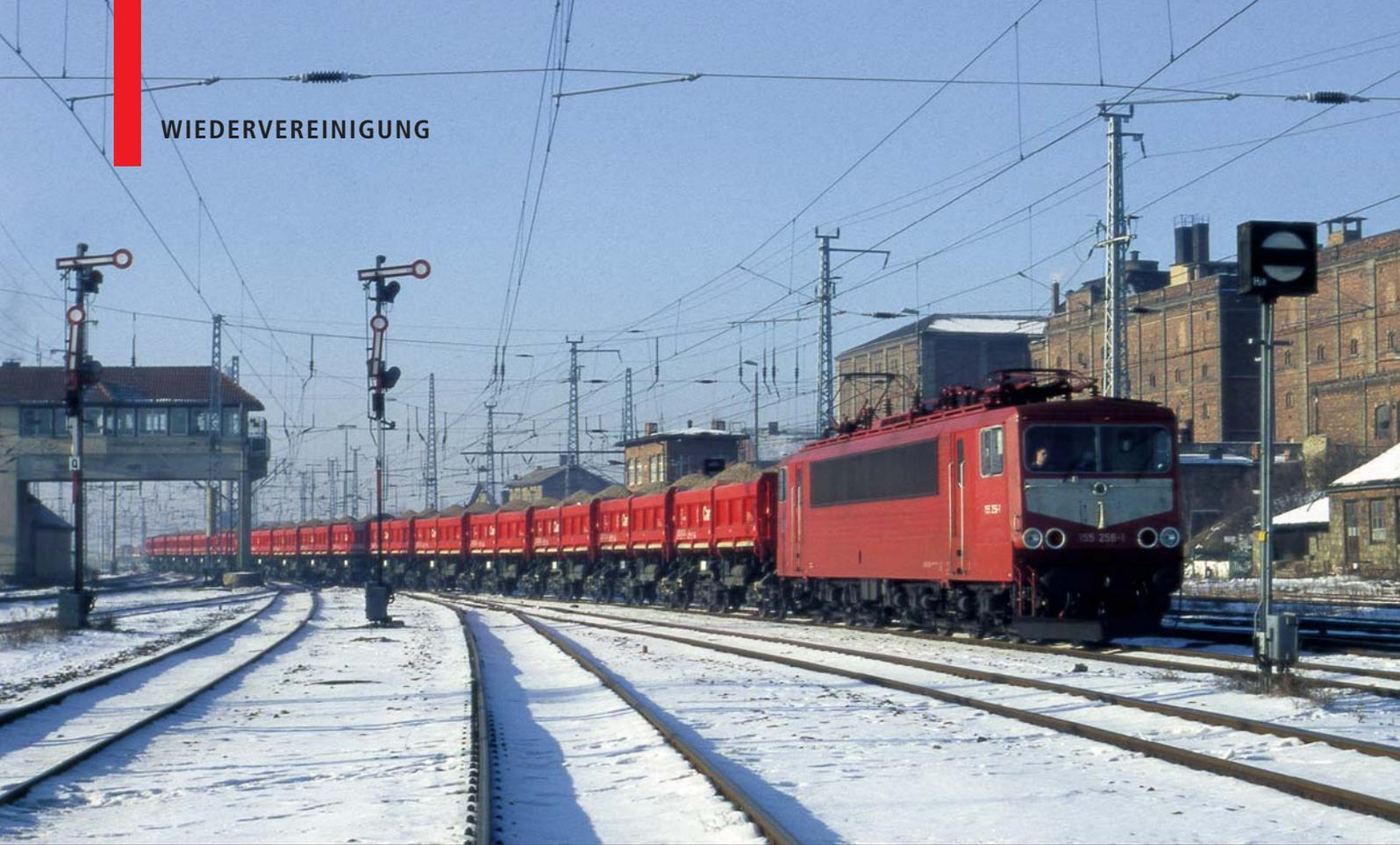
155 256-3 fährt mit einem aus Fans 128 gebildeten 2000 t schweren Ganzzug Kies für Berlin am 17. Januar 1997 in Sangerhausen ein. Für die Blankenheimer Rampe wird der Zug eine 143 Schiebelok bekommen. Die Signaltechnik ist noch die alte, jedoch wurden die Flügel der Formsignale im Zuge der Elektrifizierung gekürzt. Foto Uwe Böhme
