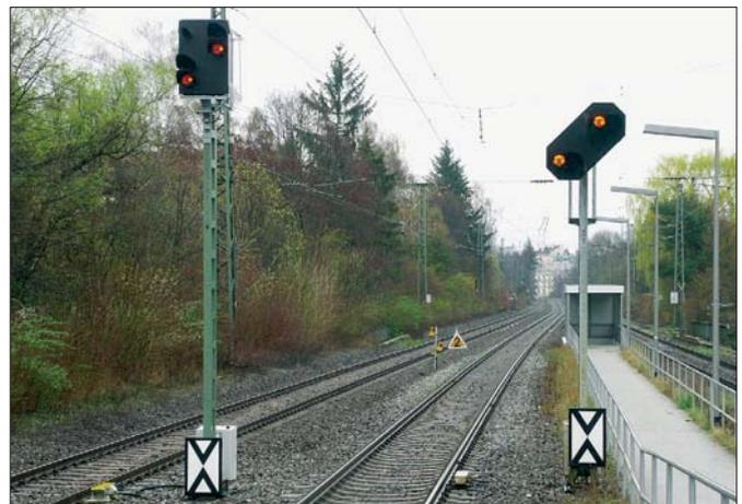
Kompaktsignale an Signalmasten und einem Signalausleger als Einfahrsignale des Bahnhofs Hamburg-Harburg im Juli 2004. Alle Signale besitzen Zusatzanzeiger, die beiden einzeln stehenden darüber hinaus Voranzeiger. Die Schaltkästen sind an separaten Pfosten in der Nähe der Signale angebracht.
