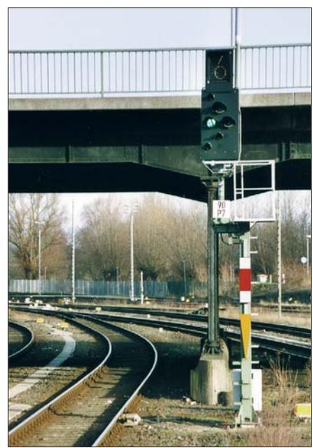
Ein Mehrabschnittssignal als Ausfahrtsignal in Lübeck Hbf im April 2004. Es zeigt an, dass aus dem Überholungsgleis mit 60 km/h ausgefahren werden darf und das nächste Signal „Fahrt“ zeigt.
