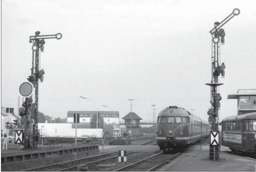
**Bf Elmshorn am 1. Mai 1982: Links fährt eine 612/613-Garnitur als Eilzug nach Kiel/Flensburg aus, rechts „Kuddl-Barmstedt“, der EBO-Triebwagen nach Barmstedt. Der Standort des links stehenden Ausfahrsignals ist mit einer Schachbretttafel gekennzeichnet. Foto Benno Wiesmüller**
