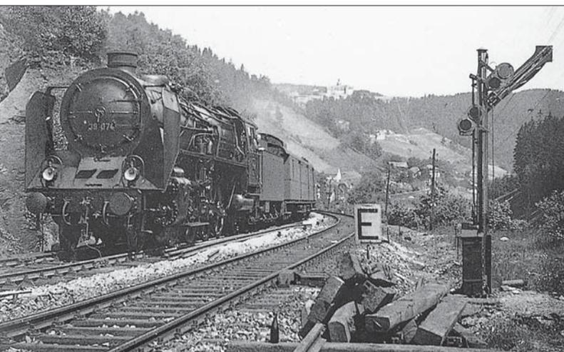
39 074 vom Bw Saalfeld passiert im Jahr 1936 mit dem E 170 nach München das Einfahrsvorsignal des Bahnhofs Lauenstein für die Gegenrichtung. Neben dem Signal die Endtafel einer wegen Gleisbauarbeiten vorübergehend eingerichteten Langsamfahrstelle.
