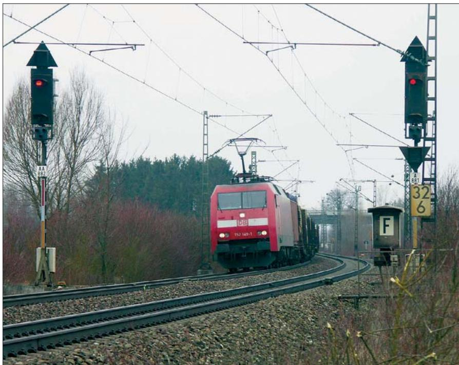
152 149-1 fährt mit einem Güterzug im März 2005 durch Mertingen. Die Einfahrsignale sind mit Geschwindigkeitsanzeigern und Vorsichtsignalen ausgerüstet, das Signal am rechten Gleis besitzt zusätzlich einen Geschwindigkeitsvoranzeiger. Foto Alexander Lindner
