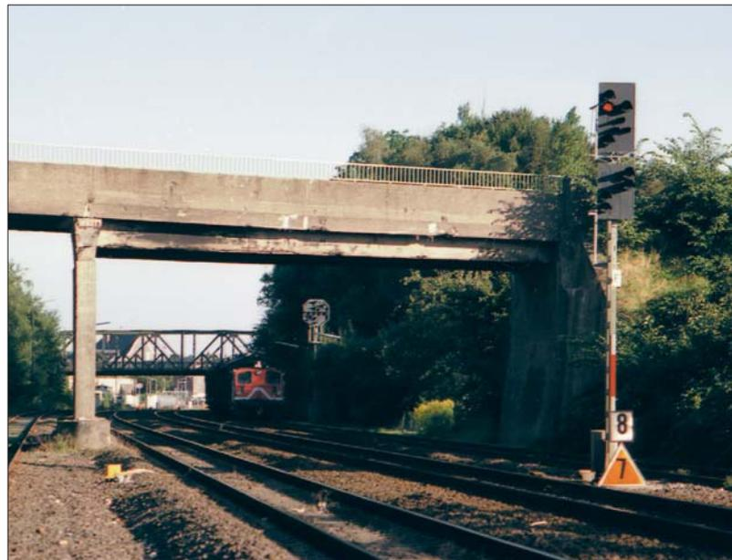
**151 004-9 mit einem Güterzug Würzburg-Nürnberg bei Burgfarnbach im Winter 2003. Neben der Lok ein Ausfahrtsignal mit Gleiswechselanzeiger und einem oberhalb des Signalschirms montierten Geschwindigkeits-signal für 140 km/h.**
