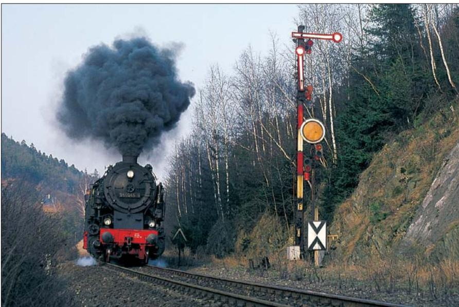
Klassische Kombination von Haupt- und Vorsignal der Einheitsbauform, am Einfahrsignal des Bf Unterloquitz zur Verbesserung der Signalsicht mit hohen Masten. Neben dem Signal 95 0045-5, die am Vortag von einer L5 aus dem RAW Meiningen gekommen ist, mit dem P 18007 Saalfeld-Sonneberg am 13. April 1979.
