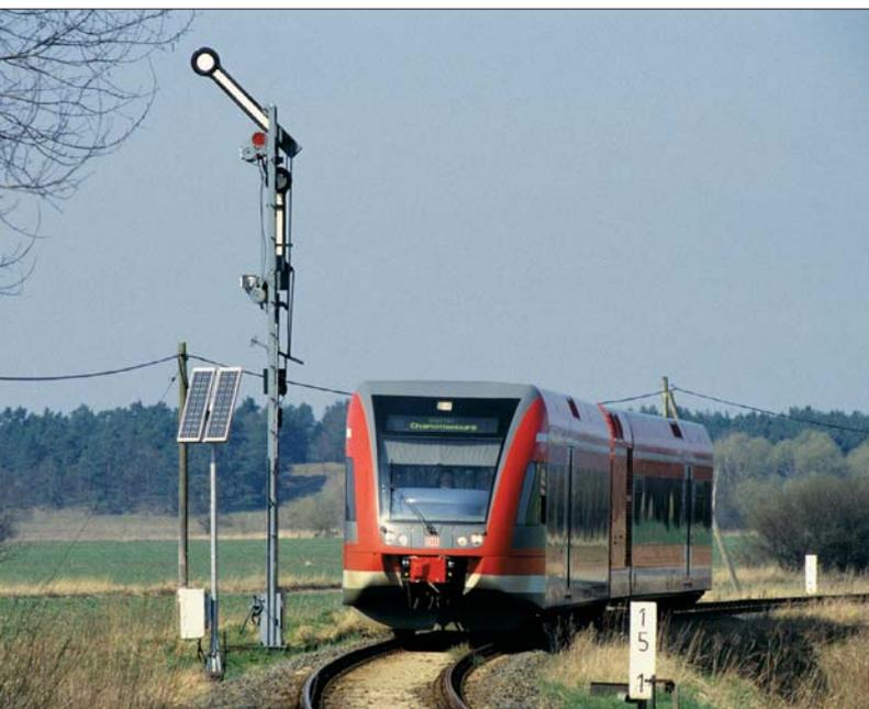
Ein Triebwagen der BR 646 fährt im Jahr 2002 als RE Rheinsberg-Berlin-Charlottenburg in den Bahnhof Herzberg (Mark) ein. Wie bei vielen Formsignalen der DB AG ist die Beleuchtung inzwischen von Propan auf Leuchtdioden umgestellt. Neben dem Signal die zur Stromversorgung dienenden Sonnenkollektoren. Foto DB AG, Weber
