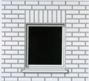
Senkrecht gestellte Ziegel als Verkleidung eines Betonsturzes; Verblendmauerwerk im Läuferverband
