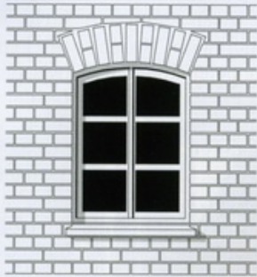
Segmentbogenfenster in Ziegelmauerwerk im Kreuzverband
