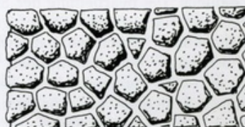
Zyklopenmauerwerk aus Basaltsäulen
