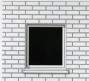
Durchgehendes Verblendmauerwerk vor einem Betonsturz; Steine über der Öffnung haben optisch keinen Halt!
