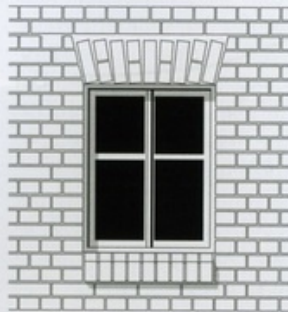
Scheitrechter Bogen; Fensterbank aus schräggestellten Klinkern
