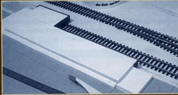
Mit Spachtelmasse können die Schrägen geformt werden. Sie sollten anschließend möglichst eben sein.
