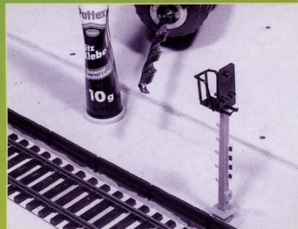
Wie beim Vorbild erhielt ein Signal das die Sicherung des Wegüberganges anzeigt seinen Platz direkt am Bahnsteig. Es wird vor dem Einschottern aufgestellt.
