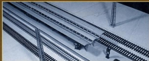
Die Masten der Quertragwerke stellt man an die äußeren zu überspannenden Gleise.
