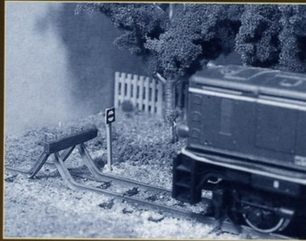
Jedes Gleisende besitzt einen mehr oder weniger aufwändigen Abschluss. Das hier gezeigte Prellbockmodell ist ein Weinert-Produkt und besteht aus Metall. Damit es zu keinem elektrischen Kurzschluss des Fahrstromkreises kommt, wird unmittelbar vor dem Prellbock eine Trennstelle in die Schienen eingebaut.
