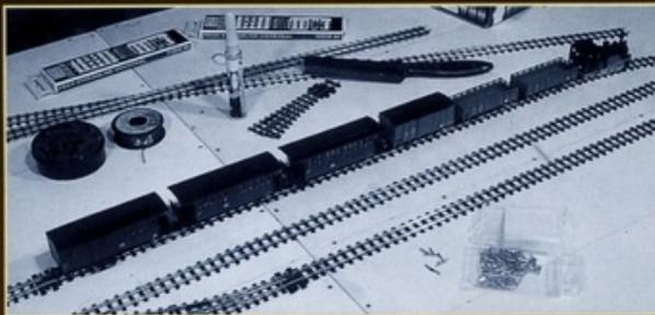
Vor dem Einschottern sollten alle Anschlussdrähte angelötet und durch kleine Bohrungen unter die Anlagen Grundplatte geführt werden.
