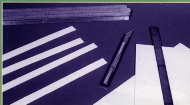
Die Betonteile entstehen aus mehreren Schichten Kunststoff, der in Streifen aufgebracht wird. Mit Skalpell und Stahllineal lassen sich die Streifen leicht zuschneiden.
