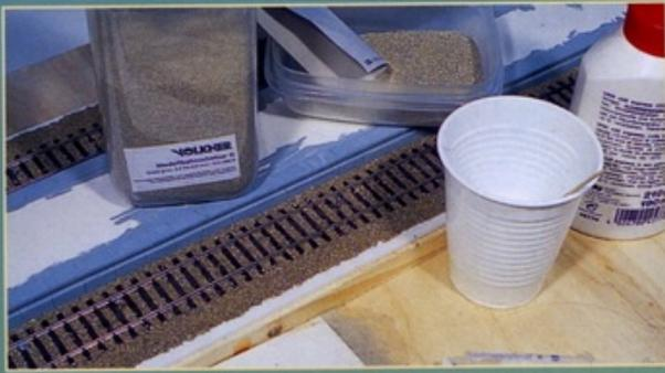
Ist der Bahnsteig fertig gestellt worden, können die Gleise verlegt und eingeschottert werden.
