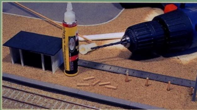
Dünne Holzstäbchen dienen als Zaunpfosten und werden senkrecht in entsprechende Bohrungen eingeklebt.
