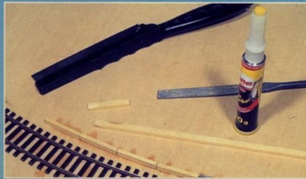
Die provisorische Verlängerung der Bahnsteigkante entstand aus Holzstücken, die neben das Gleis geklebt werden. Die Stücke sind mit einer Feinsäge aus Profilleisten zurechtgesägt.
