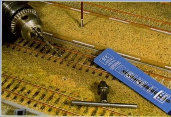
In Bohrungen passenden Durchmessers lassen sich die dünnen Lampenpfähle sicher im Anlagenuntergrund befestigen.
