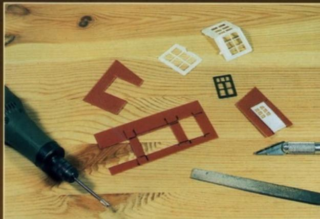
In Kunststoffplatten arbeitet man die Öffnungen für Fenster und Türen ein. Die Platten lassen sich bequem mit Seitenschneider oder Skalpell zuschneiden.
