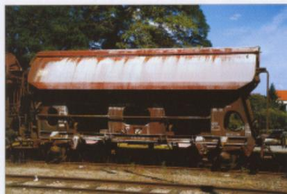
Original und Imitation: Nur ein geeignetes Vorbild verhilft zu einem realistisch aussehenden Modell wie der nach dem sogenannten Negativverfahren verschmutzte Tdgs von Roco. Der Farbauftrag wird dabei mit Lösungsmittel per Pinsel wieder entfernt. Der Pinsel muß zwischendurch immer wieder gut ausgestrichen werden.
