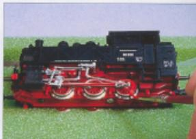
Einsatzgebiet für den Pinsel: die silbernen Radreifen und die Radnabe werden rot gefärbt. Oft schadet es auch nicht, das „Fahrwerkrot“ nachzubehalten, wenn es ab Werk zu orange ausgefallen ist.
