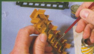
Aufmetzen der Inneneinrichtung: der Fußboden erhält einen Anstrich in Grau, die Sitze werden rotbraun.
