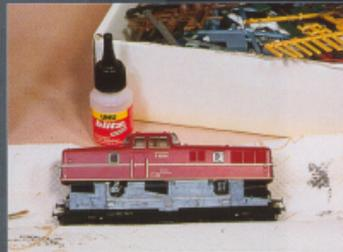
Abhilfe tut not: falsch eingefärbte Motorattrappe im Innern der Lok. Aus Spritzlingstellen läßt sich eine Motornachbildung schnitzen, die dann mit der richtigen Farbgebung versehen wird.
