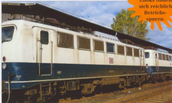
An 141 471 hat das ablaufende Regenwasser den auf dem Dach sitzenden Dreck heruntergespült und entlang der Lüfteröffnungen Spuren hinterlassen. Im Fahrgestellbereich herrschen Bremsstaubspuren vor. Solche Effekte ergeben sich gerade bei den blau-beigen Elloks der Epochen 4 und 5. Bei Elektrolokomotiven ist vor allem der Dachbereich stark verschmutzt, u.a. wegen des Oberleitungsabriebs (links).
