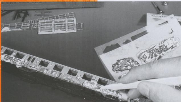
Auch der Spalt zwischen Wagenkasten und Längsträger muß wieder aufgetrennt werden, damit der Zusammenbau erfolgen kann.
