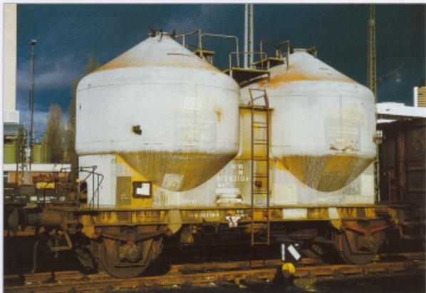
An diesem Kds 56 hat das Kalksteinmehl im Laufe der Zeit malerische Spuren hinterlassen. Gut erkennbar: die dunkleren Verlaufstreifen am unteren Siloteil, die sich an fast allen Wagen wiederfinden.
