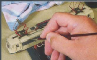
Die Laufroste der 151 hebt man mit verdünnter schwarzer Emailfarbe hervor. Regenwasserspuren am Lokgehäuse entstehen mit stark verdünnter schwarzer Emailfarbe. Wichtig: den Pinsel nach der Farbaufnahme noch einmal abstreifen!
