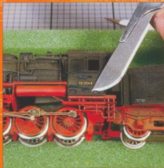
Erhabene Schilderreste mit einem scharfen, möglichst gebogenen Skalpell entfernen. Die Fläche muß anschließend völlig eben sein.
