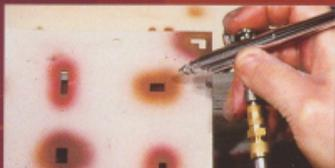
Anbringen von Ausbesserungsflicken auf G-Wagen mit Hilfe selbst gefertigter Spritzschablonen, die vor den Wagen gehalten werden.
