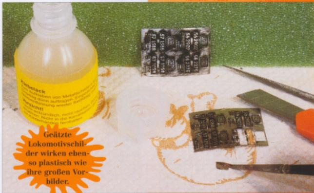
zu verwenden. Er läßt ein Ausrichten auch noch nach ein paar Minuten zu. Herausquellende Klebeüberschüsse kratzt man mit dem Schraubendreher vorsichtig weg oder rubbelt sie nach dem Trocknen ab. Abschließend muß das Schild vermutlich der Lok angepaßt und „nachgealtert“ werden. Hierfür eignet sich die Pinselalterung, aber auch ein sanftes Überlasieren mit der Spritzpistole. Abschließend wird mit Mattlack wieder der einheitliche Glanzgrad hergestellt.
