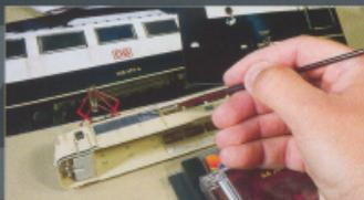
In die Ritzen der seitlichen Lüftungsgitter die Farbe hineinlaufen und in waagrecht Lage trocknen lassen.
