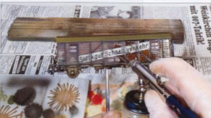
Den Abschluß bildet ein Mattlacküberzug, der einen einheitlichen Glanzgrad herstellt und den späteren Griffschutz gewährleistet.
