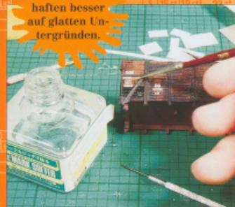
Bei Wagen mit Bretterwänden etwas mehr Weichmacher einsetzen, damit sich das Schiebbild den Fugen anpaßt.
