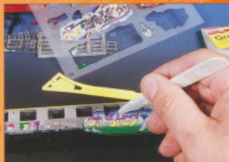
An Fenster und Längsträger überstehende Beschriftungsreste mit einem scharfen Bastelmesser oder Skalpell entlang der vorhandenen Konturen abschneiden.
