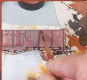
Entlang der Verstärkungsprofile, Holme etc. wird ein dunklerer Farbton aufgetragen.
