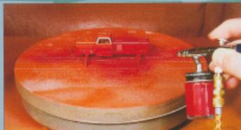
Dieser Lokomotivkasten ruht auf zwei Stützholzern. Sie verhindern die ungewollte „Farbreflexion“ des Untergrundes.
