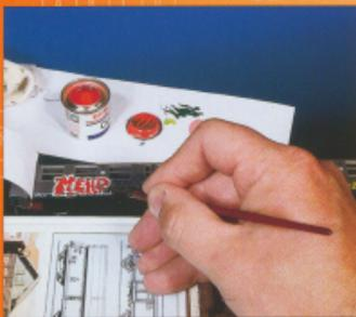
... und anschließend mit Kontrastfarben die Buchstabenfüllung aufmalen. Ein gleichstarkes Buch stützt die Hand.
