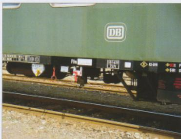
Die Farbgebung der Bremsstellhebel und Zugart-Umschalter verdient Aufmerksamkeit. Im Modell erfolgt die farbliche Hervorhebung mit einem feinen Pinsel oder einer Schreibfeder.
