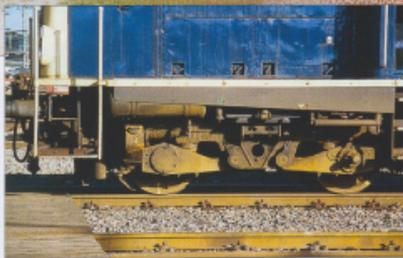
Die Ruß- und Abgasspuren an den Auspufföffnungen gelingen am besten mit der Spritzpistole und einem vorsichtig dosierten Farbauftrag.
