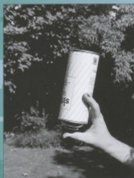
Nach dem Sprühvorgang Dose auf den Kopf stellen und so lange sprühen, bis die Farbreste im Ansaugschlauch und in der Düse herausgesprüht sind. So kann sich der Farbgang nicht zusetzen.
