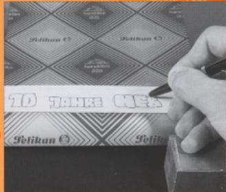
Seine Entwürfe paust man mittels Kohlepapier auf das Wagenmodell
