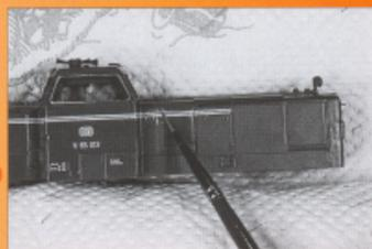
Die Restflüssigkeit (z.B. Weichmacher) in Längsrichtung mit einem trockenen Pinsel ausstreichen.
