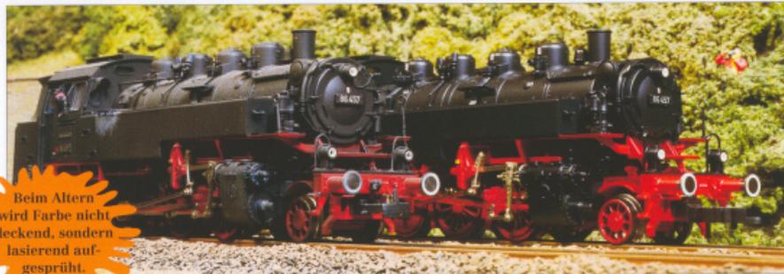
Beim Altern wird Farbe nicht deckend, sondern lasierend aufgesprüht.
