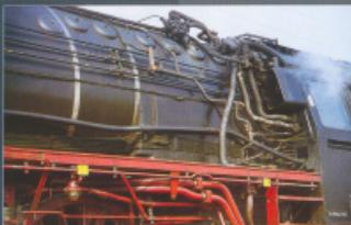
Leichte Ruß- und Bremsstaubspuren finden sich am Kessel, Rost und Spuren von Kesselstein an Leitungen und Waschlukken.
