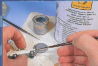
Ist Farbe danebengegangen, lassen sich Korrekturen mit einem feinen Pinsel und Reinigungsbenzin vornehmen, solange die Farbe noch nicht angetrocknet ist. Der Pinsel mit den anhaftenden Farbresten muß immer wieder ausgestrichen werden.
