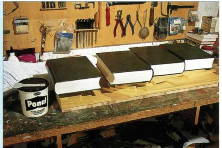
Besonders wenn auf ihnen Gleise verlegt werden, müssen die Hartschaumplatten sorgfältig verklebt werden. Die zu verklebenden Flächen sollten möglichst fest aufeinandergepreßt werden, etwa durch Auflegen von Büchern.
