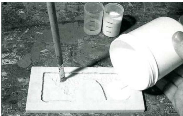
Für das Abmessen der Gießmasse und des Wassers eignen sich hervorragend transparente Film Dosen, die mit der gleichmäßigen Strichteilung versehen wurden. Das Pulver wird dann in das Wasser eingerührt, in die Form gegossen und...
