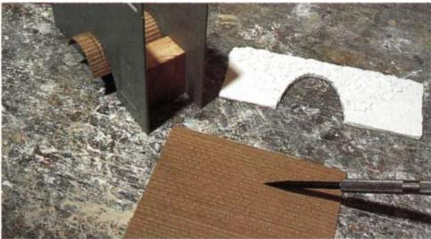
Das Gewölbe entsteht aus Kunststoff-Mauerplatten. Sie lassen sich leicht biegen, wenn man die Fugen mit einer Reißnadel anritz. Um dem Gewölbe auch genau die Form zu geben, werden zwei Kunststoffplatten mit dem Bogenausschnitt versehen und mit Distanzstücken (aus Holz) zusammengeklebt. Die gebogene Mauerplatte wird dann in die Rundung geklebt.
