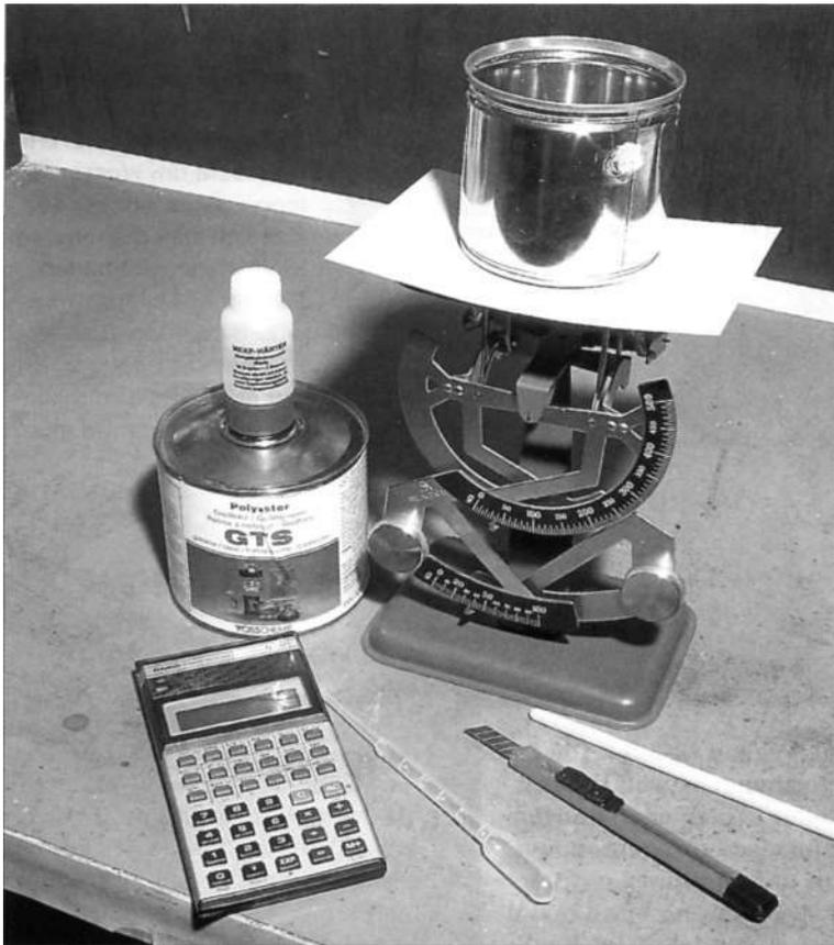
Zum Anmischen von Gießharz braucht man eine Waage, einen Mischbehälter, einen Taschenrechner zur Berechnung der Härtermenge und einen Rührstab.
