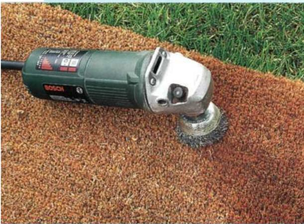
Mit einer Draht-Topfbürste, am besten an einen Winkelschleifer montiert, wird die Matte gebürstet. Sie wird dadurch lichter, und vor allem löst sich die Büschelstruktur der Fasern auf. Da sich eine Menge an Fasern beim Bürsten löst, sollte dieser Arbeitsgang in einem leicht zu säubern Raum oder gleich im Freien durchgeführt werden.
