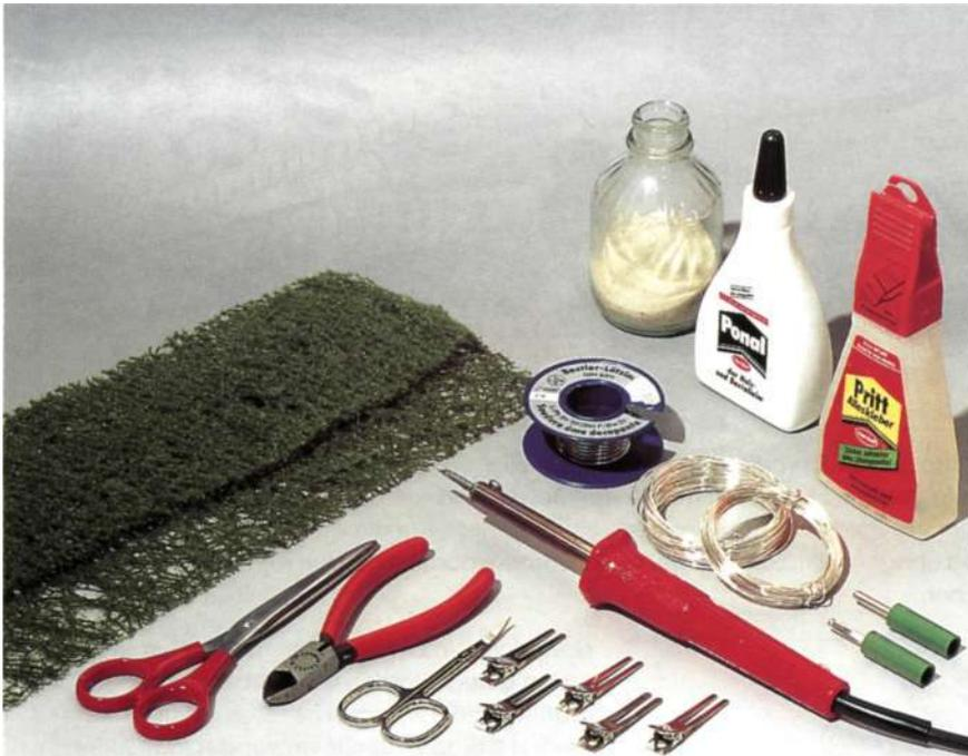
gründen entfernt werden müssen. An Werkzeugen benötigt man für die Stammherstellung außer einer Biegevorrichtung, auf die wir im folgenden noch eingehen werden, einen 40-Watt-LötKolben sowie einen Seitenschneider, eine scharfe Haushalts- oder Papierschere zum Begrünen, einige Haarklipse und noch eine weitere sinnvolle Montagehilfe.
