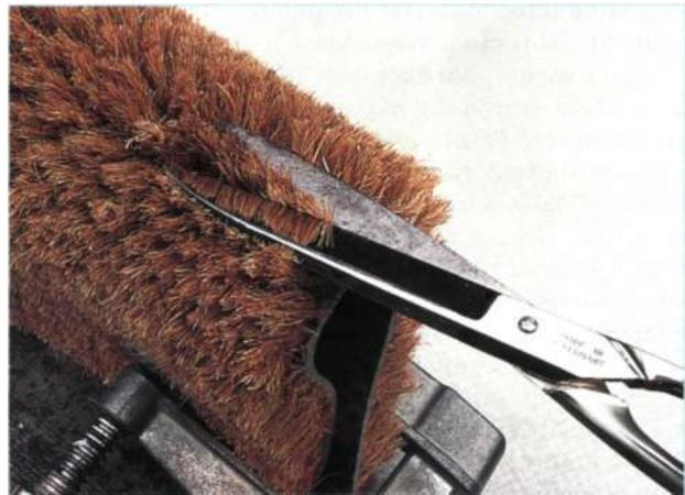
So läßt sich die Matte kürzer schneiden: biegen, daß sich die Fasern spreizen und radial abstehen, und Faserreihe für Faserreihe auf die gewünschte Länge beschneiden.
