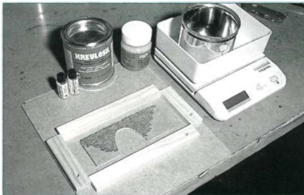
Wenn das Urmodell fertig ist, wird davon eine Form gegossen. Das Urmodell wird dazu mit der Rückseite nach unten auf einer Platte lösbar (!) befestigt und mit einer Umrahmung versehen. Die muß unbedingt dicht sein, denn das Silikon fließt durch die kleinsten Ritzen. Die Umrahmung sollte nicht zu niedrig sein, damit die Form später eine gewisse Steifigkeit hat.
