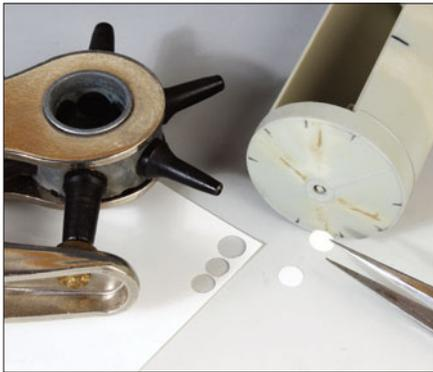
Die Abdeckung für die Spannschlösser der Isolierung besteht ebenfalls aus einem dünnen Polystyrolstück. Zum Ausstanzen der runden Scheiben mit 4,5 mm Durchmesser eignet sich eine Lochzange.
