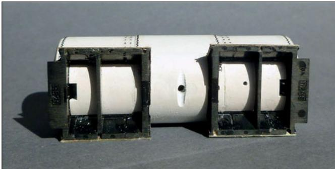
**Der Kessel ist zusammengesetzt, erste Nietreihen sind aufgebracht, die Sättel verklebt und der erhöhte Dom und die Ventilspindelhaube eingesteckt.**
