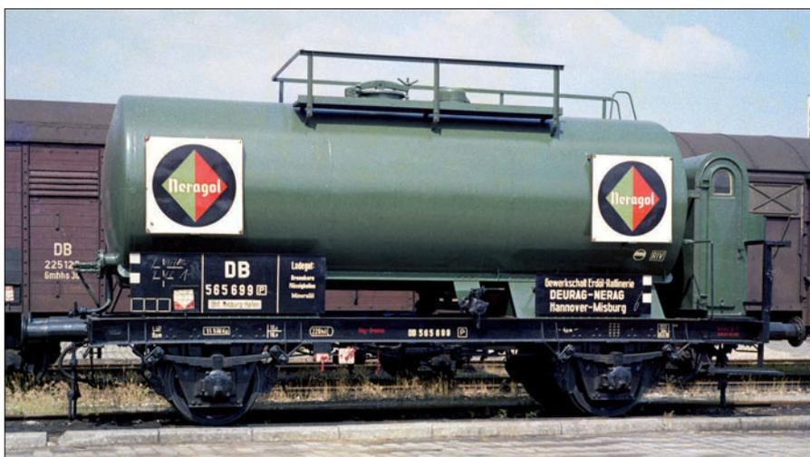
Der 1952 gebaute 22-m<sup>3</sup>-Kesselwagen 565 699 [P] der Gewerkschaft Deurag-Nerag wies gleich mehrere Besonderheiten auf: Zum einen gehörte er zu den vergleichsweise wenigen Wagen dieser Bauart mit stirnseitigem Aufstieg zur Bedienplattform und zum anderen war sein Bremserhaus in Behälterfarbe lackiert. Der Vergleich mit dem Foto in GW7/83 zeigt, dass die Wagen nicht einheitlich in RAL 6026 Opalgrün lackiert waren. Foto Fritz Willke
