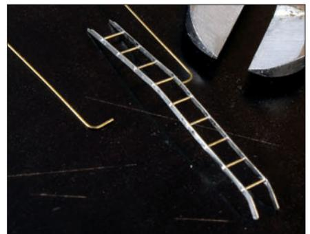
Die zur Bedienplattform führenden  $0,3$ -mm-Griffstangen werden nur am unteren Ende vorgebogen. Ihre endgültige Form erhalten sie erst nach der Verbindung von Leiter und Plattform.
