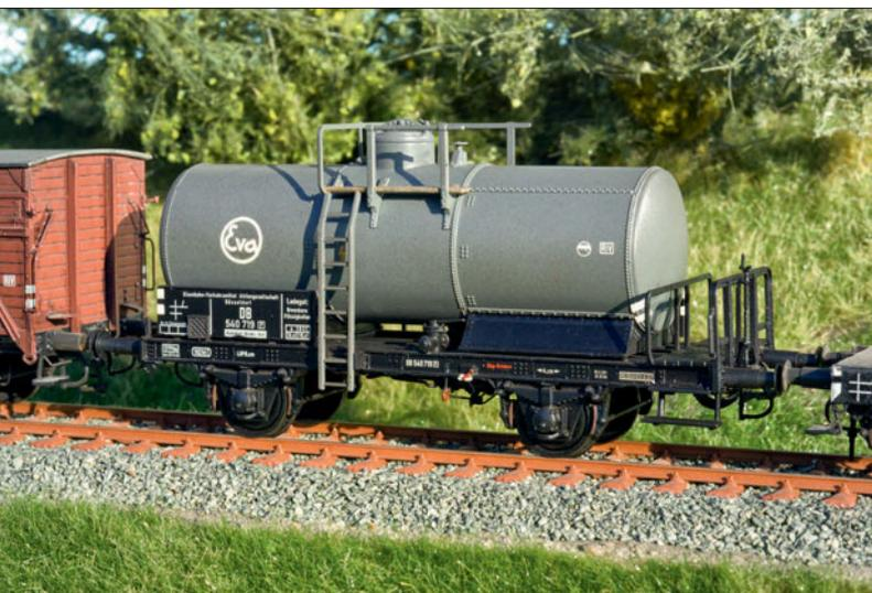
Der Verbandsbauart-Kesselwagen von Fleischmann bietet nahezu unendlich viele Möglichkeiten der Modifikation. Der Kessel des links gezeigten EVA-Wagens blieb unverändert; der Wagen hat jedoch u. a. eine neue Handbremskurbel, Federpuffer und Lösezüge an der Bremse bekommen. *Modellbau und Foto Joachim Reinhard*
