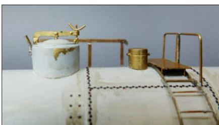
**Links die Details der Kesselausrüstung – Aufstiegstritt mit Geländer, Ventilspindelhaube, Dom mit Überwüfbugel und Knebelverschluss – aus verschiedenen Perspektiven.**
