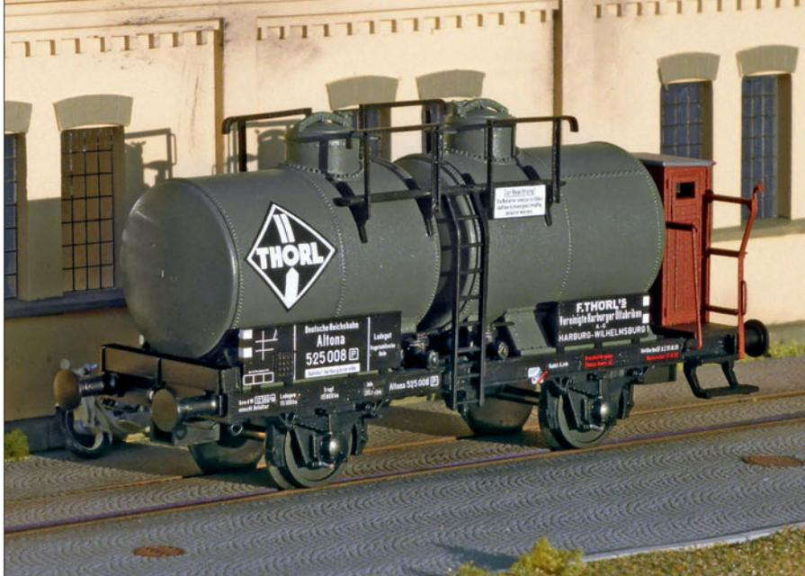
Fertig zum Einsatz: der Chargenwagen Altona 525 008 [P] der F. Thörl's Vereinigte Harburger Ölfabriken. Damit der Wagen beim Empfänger entladen werden kann, ist auf dem Kopfstück quer ein Schlauchkasten angeordnet.
