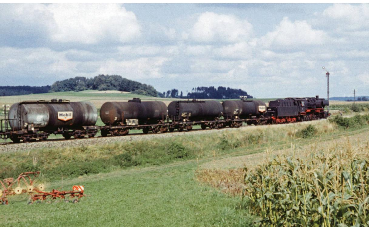
Als 50 2898 am 16.9.1968 mit dem Mobil Oil-Ganzzug durch Wattenweiler rollte, gehörten Zweiachser in solchen Zügen weitgehend der Vergangenheit an, nicht jedoch Altbau-Drehgestellwagen. Die ersten drei Wagen waren russischen Ursprungs und gehörten der Konti, der vierte war ein von der VTG an Mobil vermieteter 63-m<sup>3</sup>-Leichtbauwagen der Einheitsbauart.
