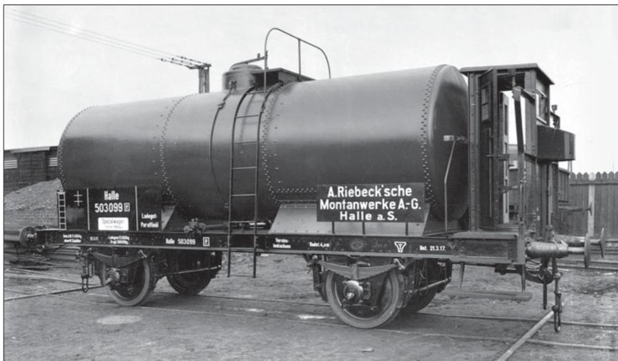
Bei dem am 21.3.17 an die A. Riebeck'schen Montanwerke A.-G. gelieferten Halle 503 099 [P] kann man hingegen ein Bremserhaus in Kesselfarbe ausschließen, da der Grauton an vergleichbaren Stellen gemessen dunkler ist. *Werkfotos Lindner, Slg. Holger Bläß*
