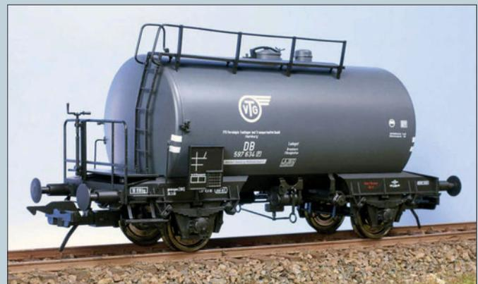
In Spur 1 gebührt dieser Platz dem Kesselwagen von KM 1 (das Foto zeigt noch das Handmuster), einem 24-m<sup>3</sup>-Leichtbaukesselwagen, hier als Wagen der Vorortbahn Wilhelmshaven. *Werkfoto KM 1*
