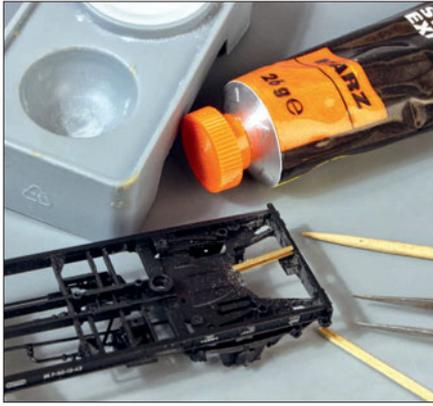
Die passend abgelängten Ms-U-Profile werden zum besseren Ausrichten mit Zweikomponentenkleber befestigt. Ihre Stege zeigen dabei immer nach außen.
