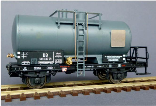
Noch einmal der modifizierte Liliput-Kesselwagen aus verschiedenen Blickwinkeln. Bis auf die Federpuffer und die Zettelkästen, die erst nach dem Lackieren montiert werden, sind bereits alle Zurüstteile angebracht, und das Geländer der Bedienbühne ist dünner.
