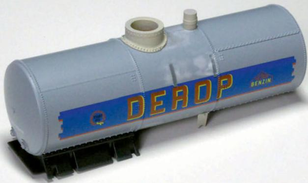
Der Kessel mit neuem Dom und neuer Ventilspindelhaube. Oberhalb des DEROP-Schriftzugs sind außerdem die Polystyrolstücke zum Verschluss der Befestigungslöcher der Bedienstege zu erkennen.
