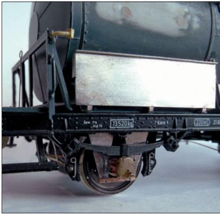
Zwei Fotos, die nicht nur zahlreiche Laufwerksdetails und Bauteile der Bremsanlage zeigen, sondern u. a. auch die geätzten Tafeln und Leitern von AW Lingen sowie Messingussteile für den Heizsstutzen und die Ablassventile von Christoph von Neumann.
