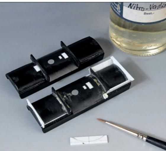
Links und rechts: Die neuen Sättel entstehen aus verschiedenen starken Polystyrolplättchen. Die umlaufenden Auflagebleche bestehen aus 0,25-mm-Polystyrolstreifen und werden an den schrägen Seiten auf der Oberseite mit Nietenbändern aus dem Ätzteilesatz 331 von AW Lingen ergänzt.
