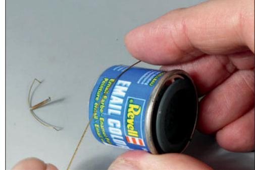
Beim Einlöten der vorgebogenen Griffstangen aus Messingdraht sorgt ein Plättchen aus 0,8 mm dickem Polystyrol für den richtigen Abstand.
