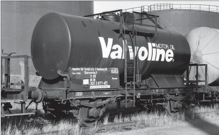
Der 22-m<sup>3</sup>-Kesselwagen 000 3 871 [P], 1983 auf dem Gelände der BP-Raffinerie in Hamburg-Neuhof fotografiert, hatte bereits eine neue schwarze Lackierung mit dem neuen Valvoline-Schriftzug. Foto Peter Driesch
