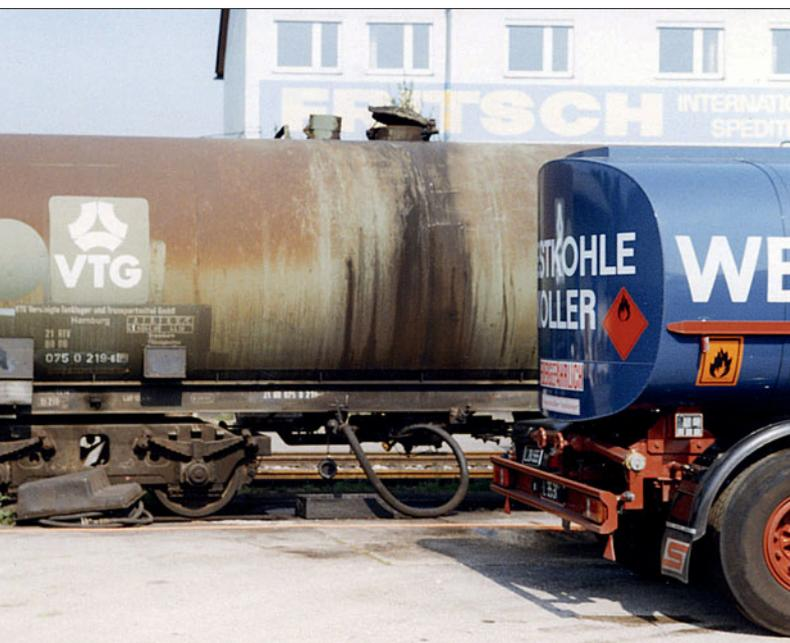
Links: Damit während Entleerung kein Unterdruck entsteht und den Kessel zusammenzieht, muss vor dem Entladen der Dom geöffnet werden.
