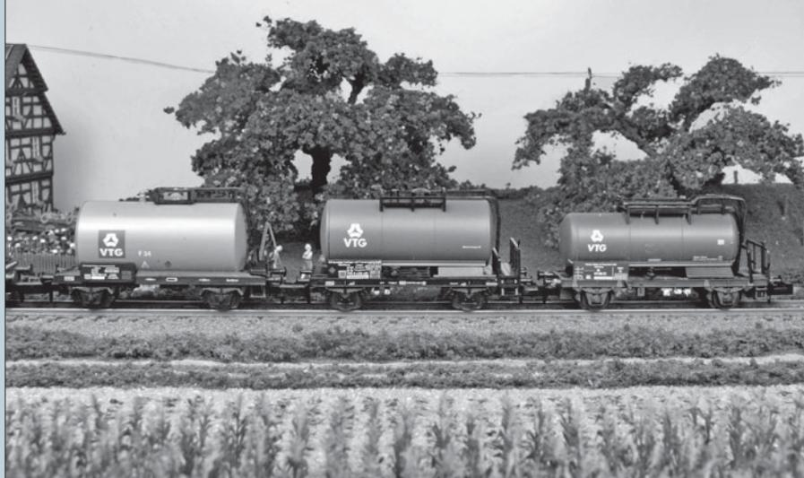
1:160-Kesselwagen nach modernen Vorbildern: Links das Arnold-Modell des von LHB gebauten 40-m<sup>3</sup>-Leichtbau-Kesselwagens, in Bildmitte der 30-m<sup>3</sup>-Kesselwagen von Trix und rechts ein Kesselwagenmodell von Roco, dessen Vorbild jedoch ein Chemiekesselwagen ist.
