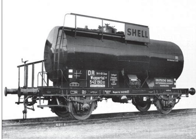
Der am 25.11.49 fertiggestellte Wuppertal 542 190 [P] der Deutschen Shell hatte den für Teerwagen typischen schwarzen Anstrich und noch am Laufsteg befestigte Shell-Tafeln. Foto Westwaggon, Slg HW
