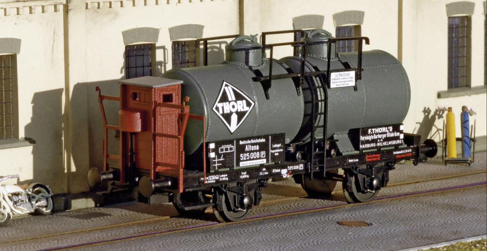
Selbstbau eines Chargenwagens auf Basis eines 19,2-m<sup>3</sup>-Kesselwagens
