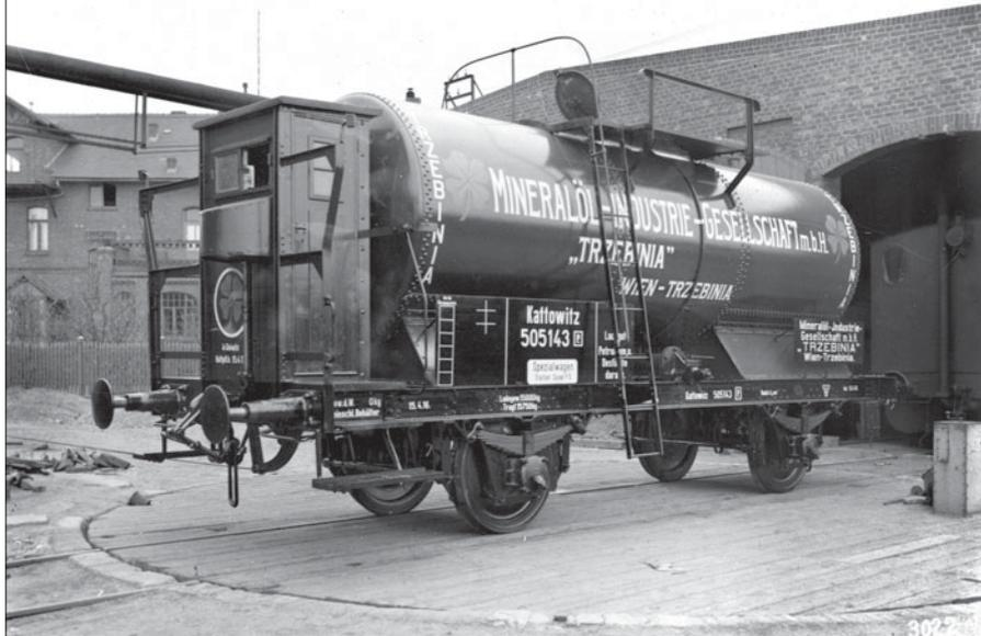
Der am 15.4.16 fertiggestellte Kattowitz 503 143 [P] der Mineralöl-Industrie-Gesellschaft „Trezebinia“ zum Transport von „Petroleum und Destillaten daraus“. Denkbar ist, dass der Kessel und das Bremserhaus dieselbe graue Farbe hatten, eindeutig belegen lässt es sich nicht. Die Anschriften waren vermutlich weiß; nur für das Kleeblatt wird man mit ziemlicher Sicherheit einen grünen Farbton annehmen können.
