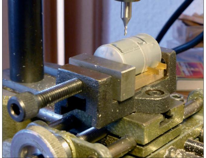
Arbeiten am Kessel: Oben der bereits wieder zusammengesetzte und in die Fräsmaschine eingespannte Kessel – vgl. Arbeitsschritt 3 in der links abgedruckten Zeichnung. Unten die Zeichnung für die Bearbeitung der Kesselsättel.
