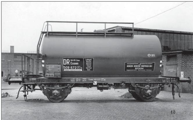
Der Essen 509 672 [P] stammte aus einer Lieferserie von 100 Leichtbauwagen der Einheitsbauart, die der BV 1943/44 erhielt. Nach dem Zweiten Weltkrieg wurde er am 27.1.48 bei Kaminski aufgearbeitet und erhielt am 22.5.50, ebenfalls bei Kaminski, eine Zwischenbremsuntersuchung. Das Foto zeigt ihn noch mit den typischen BV-Anschriften mit weiß umrandeten Flächen. Werkfoto Kaminski, Slg. HW
