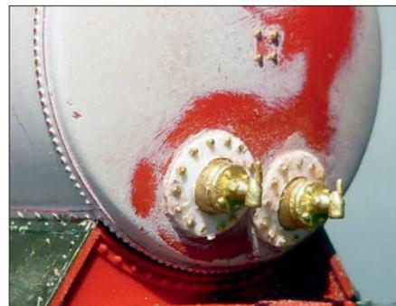
Schleifpapier erst mit der Körnung 600 und abschließend 1000er-Körnung unter fließendem Wasser. Tiefere Einkerbungen werden ggf. zuvor mit Stabilit Express aufgefüllt.
