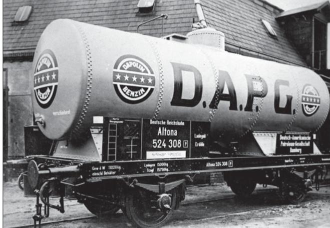
Das Bild des Alfona 524 308 [P] ist das älteste bekannte Foto, das einen D.A.P.G.-Kesselwagen mit Werbeaufschrift und dem 1927 eingeführten Dapolin-Logo zeigt. Slg. SC
