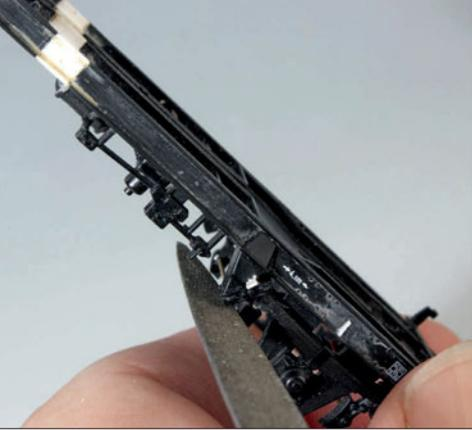
Zum Verwandeln der Doppelschaken in Einzelschaken verfüllt man die kleinen Zwischenräume zwischen Federbock und Schaken mit dünnen Polystyrolstreifen. Danach können die Federböcke mit Schleifleiste und Nadelfeile bearbeitet werden.
