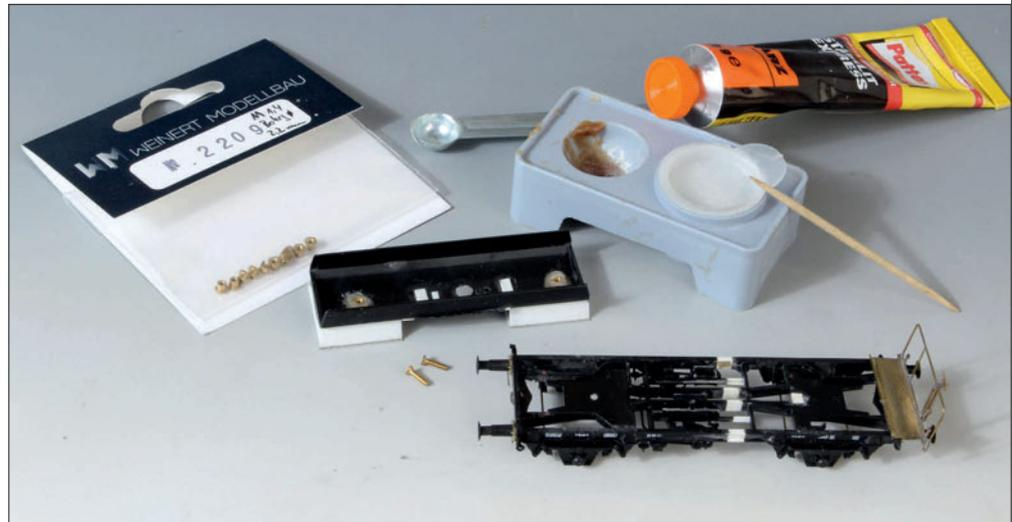
Gesamtlänge des Untergestells von 86,9 mm bleibt allerdings unverändert. Deshalb muss man es an der Bremserbühnenseite um den entsprechenden Betrag kürzen. Die mit Messingdrahtstücken verzapften Bauteile werden mit einem Zweikomponentenkleber verbunden.
