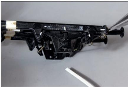
Die Verstärkungen über den Federbundanschlüssen und an den Kopfstücken bestehen aus kleinen dreieckigen Stückchen 0,25 mm starken Polystyrols. Links sind darüber hinaus noch einmal die eingeklebten Polystyrolstückchen zu erkennen, durch die der Achsstand um 3,5 mm verlängert wird.
