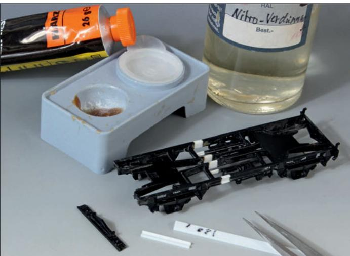
Nachdem das Untergestell mit Polystyrolstückchen um  $3,5$  mm verlängert ist, muss die Bremserbühnenseite um das gleiche Maß gekürzt werden, damit die Gesamtlänge des Untergestells unverändert  $86,9$  mm beträgt. Ein Zweikomponentenkleber (Stabilit-Express) hilft beim Verkleben der mit Messingdrahtstücken verzapften Bauteile. Die Polystyrolteile werden zusätzlich noch mit Nitroverdünnung bestrichen, sodass sie miteinander „verschweißen“.
