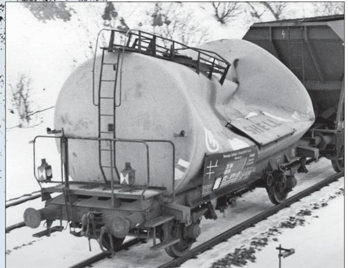
Damit ein Kesselwagen bei der Entleerung nicht durch Unterdruck zerstört wird, muss der Domdeckel zur Entleerung geöffnet werden. Was passiert, wenn dies nicht geschieht, zeigt der im Januar 1969 bei Altenbeken aufgenommene 072 4 378 [P] der VTG. Foto Slg. Joachim Claus
