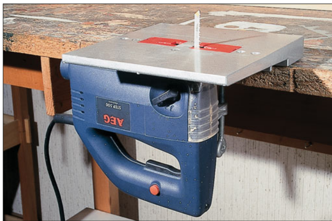
Ein Multitalent beim Anlagenbau ist die Stichsäge, vor allem in Verbindung mit einem kleinen Sägetisch.
