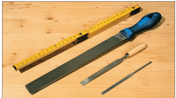
Feilen in verschiedenen Größen von der großen Schlosser- bzw. Mechanikerfeile bis zur kleinen Nadelfeile. Für uns sind die kleinen wichtiger.
