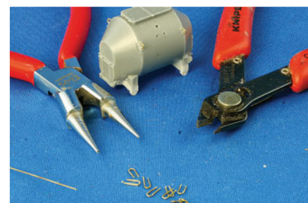
Die Behälter werden um Halteösen ergänzt.
