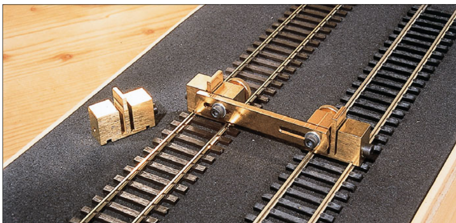
Gleistrennung mit einem watenfreien Seitenschneider: Die rechte Gleisseite soll verwendet werden, weshalb sie auf der flachen Seite der Schneide liegt.
