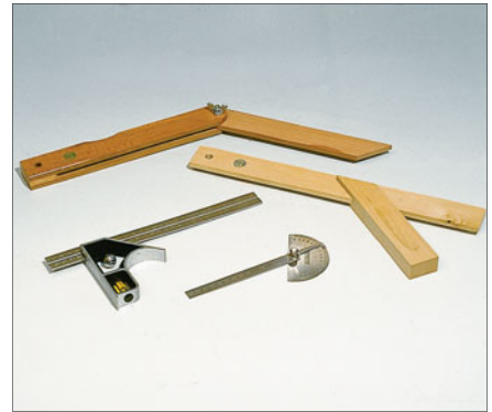
Winkelmessgeräte: einstellbare Schmiege (hinten), davor feste Gehrungswinkel aus Holz (rechts) und aus Metall (links), im Vordergrund ein einstellbarer Winkelmesser.
