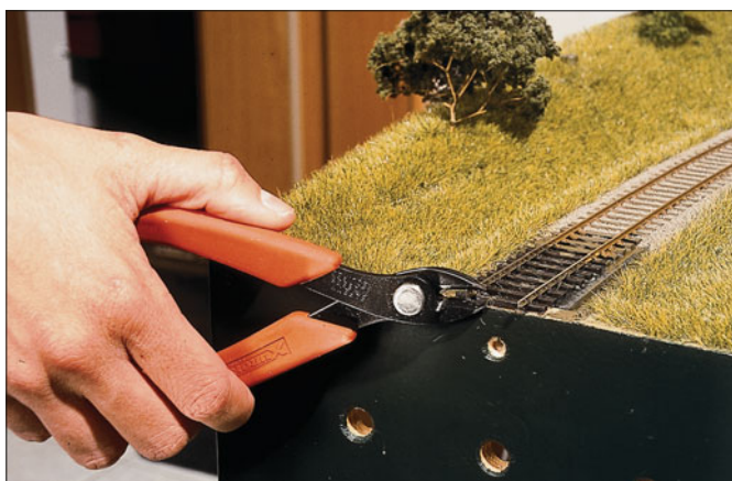
Gleistrennung mit einem watenfreien Seitenschneider: Die rechte Gleisseite soll verwendet werden, weshalb sie auf der flachen Seite der Schneide liegt.
