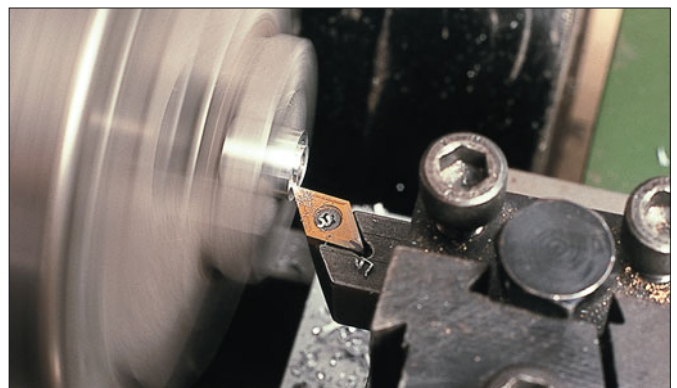
Das stirnseitige Bearbeiten nennt der Fachmann „Planen“ oder „Plandrehen“. Nach innen sollte der Vorschub immer langsamer werden, da mit dem Radius auch die Schnittgeschwindigkeit abnimmt.
