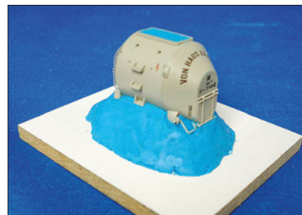
Eine Grundplatte aus Hartfaserplatte mit Knetgummisockel für die Behälter. Die Oberfläche der Knetmasse ist später die Trennkante zwischen Form Ober- und Unterteil.
