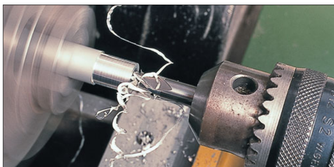
Eingesetzt werden ganz normale Spiralbohrer. Für Sacklöcher mit ebenem Grund können auch Fräser verwendet werden. Das Bohren erfolgt mit ganz wenig Vorschub.
