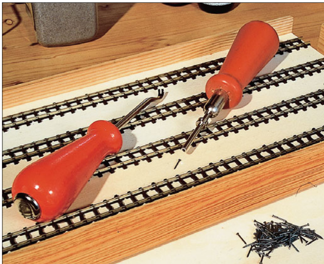
Links: Wer seine Gleise aufnagelt, wird „Nagelfix“ und Nagelheber von Peter Post sehr zu schätzen wissen.
