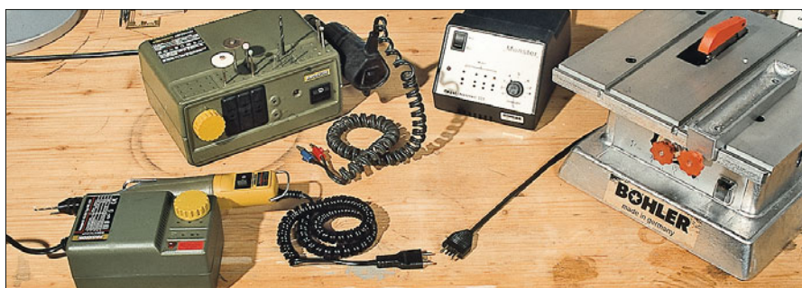
Links die Proxxon-Trafos NG2E und NG5E mit 2 bzw. 5 Ampere Ausgangsleistung, rechts daneben das Regelnetzgerät II „Monster“ mit 4 Ampere (Kaleas, früher Böhler). Im Vordergrund die zueinander kompatiblen Stecker beider Systeme, die zu anderen Systemen oder Netzgeräten auch mit 2,5-mm-Einzelsteckern gesteckt werden können. Der Mittelpin dient nur als Verpolschutz.
