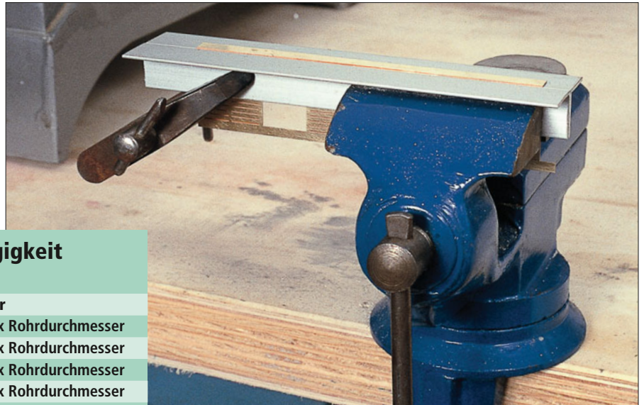
Biegevorrichtung aus Alu-Winkelprofil im Schraubstock
