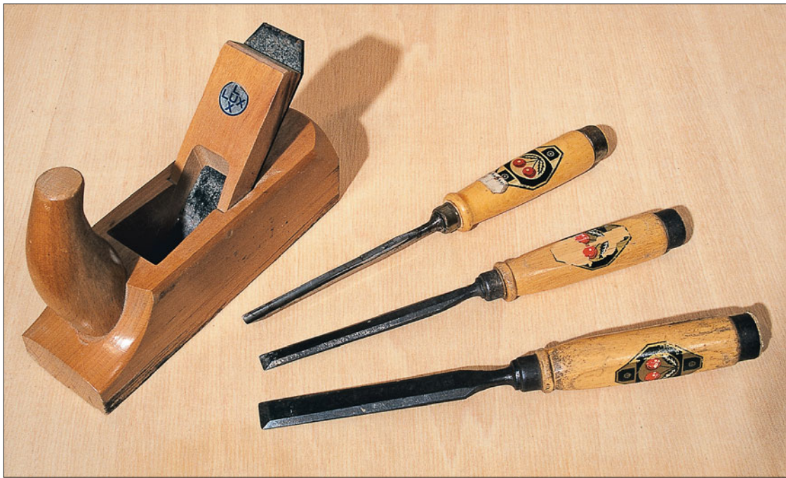
Geradezu klassische Werkzeuge zur Holzbearbeitung sind Hobel und Stechbeitel, die beide mit Klingen in verschiedenen Breiten angeboten werden.
