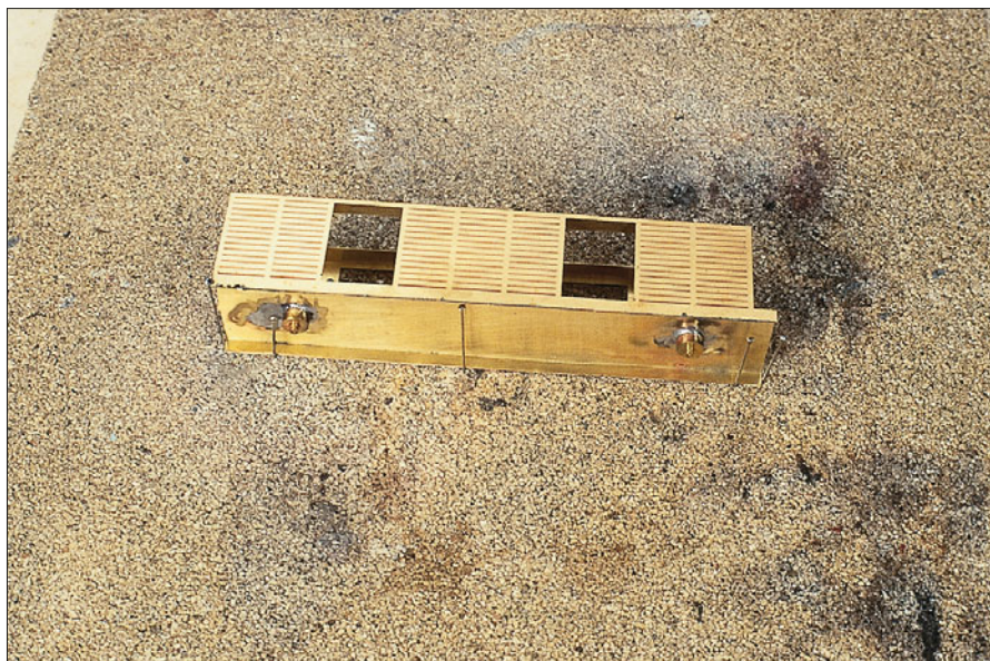
Löten sollte man auf einer Lötunterlage, diese ist für das Kolben- und Flammlöten geeignet.
