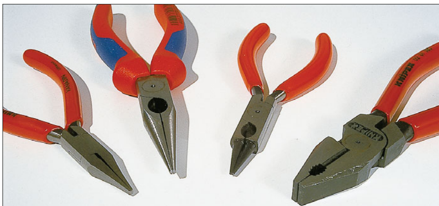
Flach- und Rundzangen (links) dienen ausschließlich fürs Halten, während Kombizange (rechts) und Flachrundzange mit Schneide (hinten links) auch noch integrierte Schneidbereiche haben. Diese Schneiden sind in der Regel weniger belastbar als die spezieller Seitenschneider, weshalb man sie nicht zum Trennen harter Materialien wie Stahl verwenden sollte.
