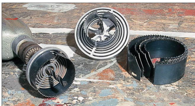
Ein Spezialist für kreisrunde Löcher ist die Lochsäge mit kreisrund gebogenen Sägeblättern. Eingespant wird die Lochsäge in eine Bohrmaschine.
