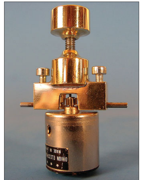
Rechts ein Abzieher auf einem Motorritzel, der Abstand zwischen Motorritzel und Lagerschild beträgt nur wenige Zehntelmillimeter.
