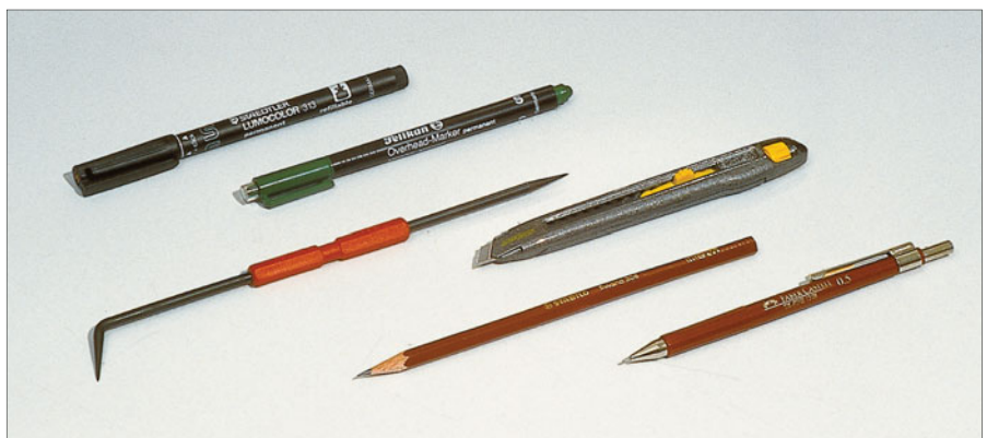
Unten: Nützliche Markierungsmittel sind Bleistifte für Holz und Kunststoff, Filzstifte (Folienstifte) für Metall und Kunststoff, Messer und Reißnadel für sehr genaue Anritzungen.
