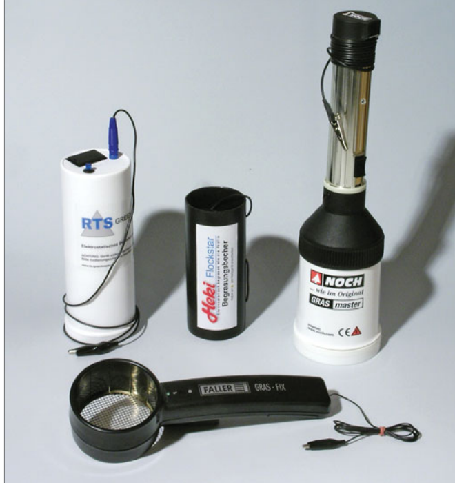
Übersicht über einige der besprochenen Begrasungsgeräte von RTS, Heki (Flockstar) und Noch (Grasmaster). Davor ein Applikator mit Kabel von Fallner.
