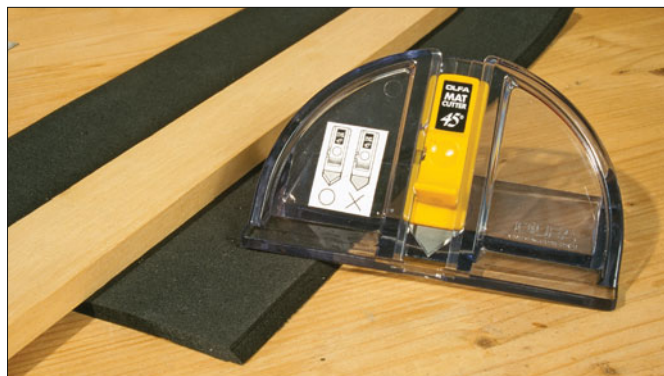
Der Winkelschneider von Olfa, der eigentlich für das Schneiden von Passepartouts gedacht ist, erzeugt auch hervorragend 45-Grad-Schnitte von Gleisbettungen.
