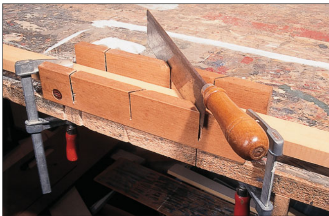
Für das Sägen von Holzleisten ist die Feinsäge ideal. Die Gehrungslade ermöglicht senkrechte Schnitte im 45- und 90-Grad-Winkel.
