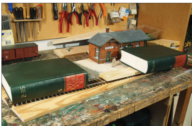
Bis zum Abbinden des Klebstoffs können Bücher ein probates Beschwerungs-mittel sein. So findet der gute alte Brockhaus selbst beim Gleisbau sinnvoll Anwendung.
