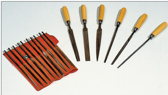
Verschiedene Feilenarten und -formen: darunter Flach-, Vierkant-, Halbrund-, Rund- und Dreikantfeilen
