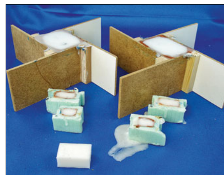
Die Trennkante wird mit einer Sperrschicht aus Farbe aufgepinselt. Ohne diese Trennschicht würde sich das Formunterteil unlösbar mit dem Oberteil verbinden.
