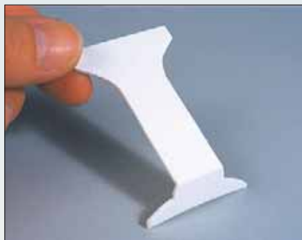
Zum Abziehen der Landstraße wurde ein gekröpfter Spachtel in der Breite der Straße aus 1 mm dickem Polystyrol angefertigt.
