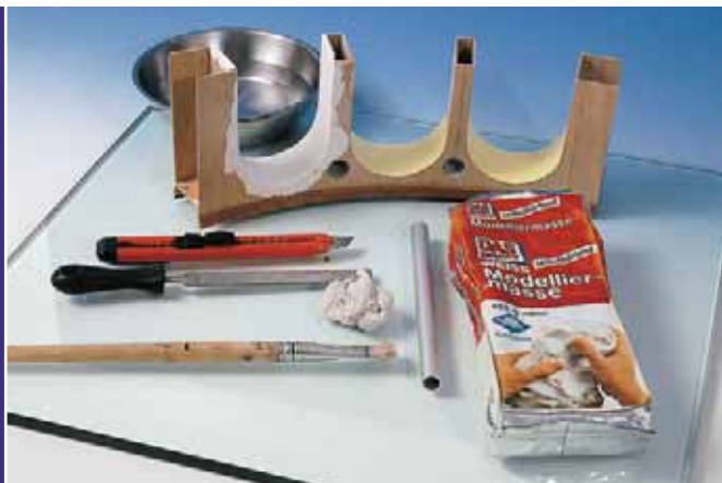
Das Mauerwerk gestaltet man idealerweise mit Modelliermasse, die dünn auf den Rohbau aufgetragen wird.
