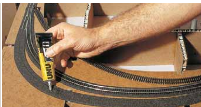
Auch die vorgebogenen Flexgleise werden mit Kontaktkleber fixiert. Dazu werden auf Bettung und Schwellenrost jeweils zwei gleichmäßige Stränge Kleber aufgetragen, welcher zunächst abtrocknen muss.
