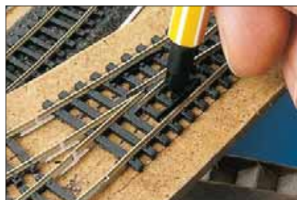
Neben dem Markieren der Gleisachse für das Aufkleben der Korkbettung sind auch die drei Isolierschienenverbinder zu erkennen.
