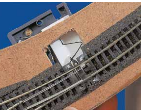
Blick durch das Trassenbrett auf den darunter befindlichen Antrieb mit Lage der Stellfeder
