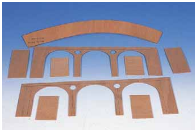
Die aus dünnem Sperrholz zugeschnittenen Teile für die Steinbogenbrücke. Der Aufriss erfolgte nach Zeichnung.
