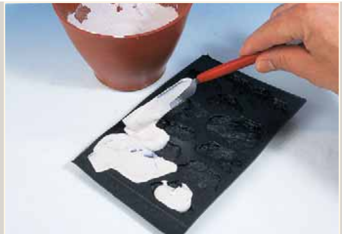
Der sämig angerührte Gips wird in die Form gefüllt. Zur Vermeidung von Luftblasen wird die Form abgeklopft.
