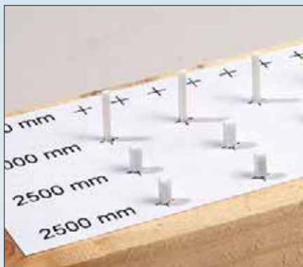
Da der Draht vor dem Einbau durch die Bauteile gezogen wird, werden sie auf einem Holzbrett aufgesteckt. Ein aufgeklebter Ausdruck der Pfostenabstände dient als Bohrschablone.
