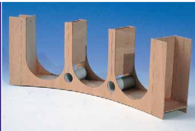
Die Zuschnitte lassen sich gut mit Uhu hart verkleben. Die eingesetzten Rohre (Kunststoffleerrohre) dienen auch der Stabilisierung.
