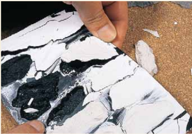
Nach dem Durchtrocknen werden die Felsen durch Verbiegen der Form herausgeholt.
