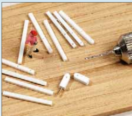
Auf einem Holzbrettchen werden die 0,4-mm-Löcher in die Polystyrol-Profile gebohrt, aus denen Zaunpfähle und Begrenzungssteine entstehen sollen. Durch die Bohrungen wird später Draht gezogen.
