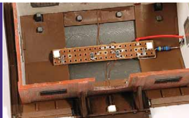
LEDs sorgen auch im Güterschuppen für Helligkeit. Eine Streifenrasterplatine im Dach dient als Verteiler.
