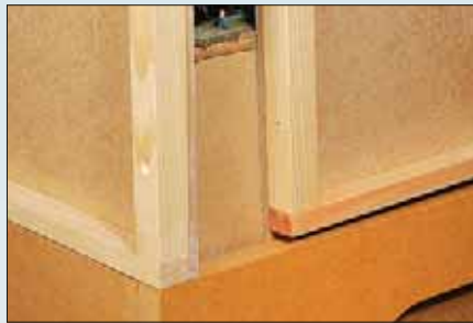
Die Kulissentteile werden zwischen Unterkasten und Anlagenrahmen fixiert und mit zwei Spaxschrauben verbunden.
