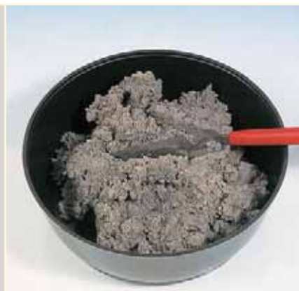
Das ockerfarbene Pulvergemisch ergibt eine graue, klebrige Modelliermasse.
