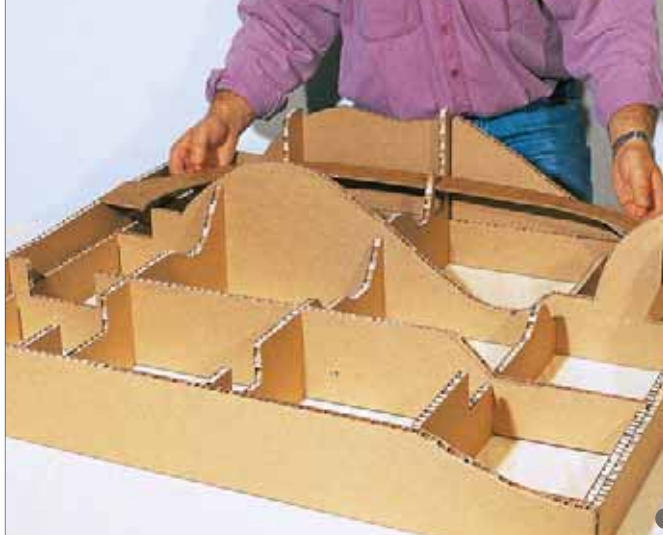
Leichter Anlagenbau mit Wabenkarton als Alternative zu Sperrholz und Tischlerplatte
