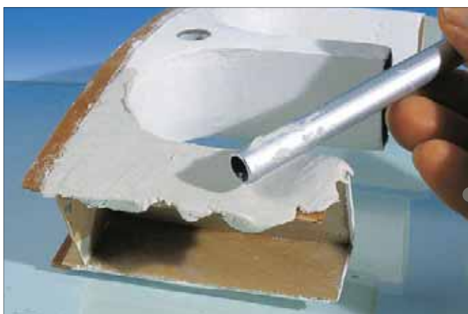
Individuelle Brücken aus dünnem Sperrholz und Modelliermasse
