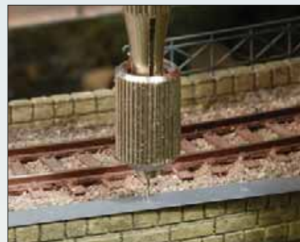
Mithilfe einer Schablone werden die Löcher für das Geländer (Messingätzteile von Weinert) gebohrt.
