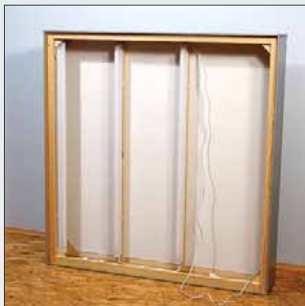
Die Kulissentteile werden zwischen Unterkasten und Anlagenrahmen fixiert und mit zwei Spaxschrauben verbunden.
