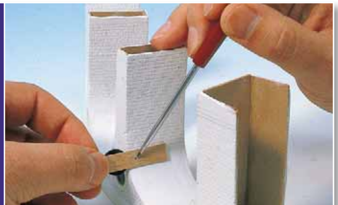
Zum Ritzen der Fugen der Rollschicht am Gewölberand dient wiederum eine einfache Schablone. Die Schablone wird mit der eingesteckten Reißnadel entlang der Außenkante geführt.
