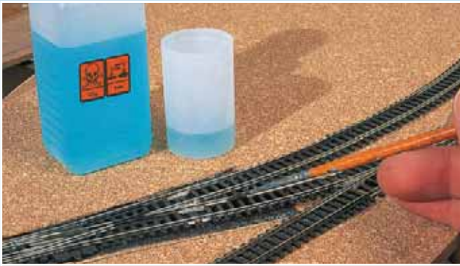
Damit die Rostfarbe auf den Schienenprofilflanken gut haftet, werden diese mit einem Brüniermittel eingestrichen.
