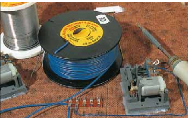
Anschluss eines Umschaltkontaktes für die Herzstückpolarisierung
