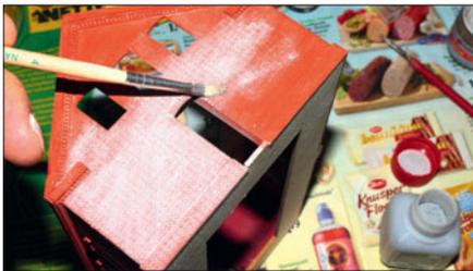
Die Oberfläche des gelaserten Bahnsteiges wurde nachträglich mit Trockenfarben behandelt. So verschwand der monochrome Farbton.
