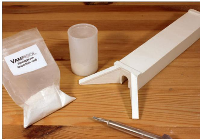
Vampisol bietet Architekturmodelle aus Gips an. Nach der Montage der Bauteile schließt man kleine Fugen an den Stoßkanten der Teile ebenfalls mit Gips, wozu ein kleiner Schraubendreher oder Spachtel sehr dienlich ist.
