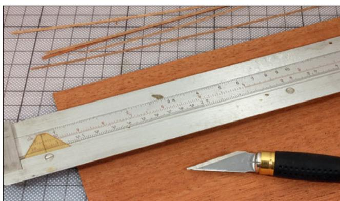
Furnierholz schneidet man mit einem scharfen Skalpell entlang der Maserung. Auf diese Weise erhält man sehr feine dünne Holzstreifen, die für viele filigrane Anwendungen im Modellbau verwendet werden können.
