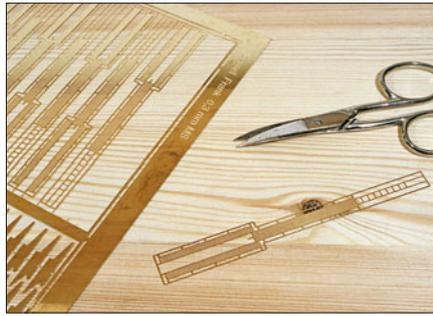
**Beispiel 2:** Aufstiegsleitern und Laufstege für Kesselwagen in TT wurden hier als Ätzteil zum Nachrüsten selbst hergestellt.
