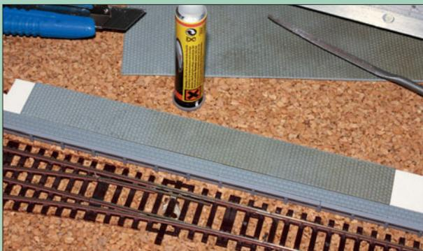
Der übrige Teil des Bahnsteigs erhielt eine andere Pflasteroberfläche, dazu kamen Kunststoffplatten von Kibri zum Einsatz. Aufgeklebt wurden die Kunststoffstreifen mit Sekundenkleber.
