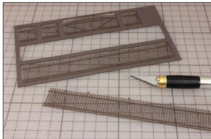
Aus Holz lassen sich sehr feine Zäune oder andere Bauteile lasern. Mit dem Skalpell trennt man sie aus dem Trägerbogen.
