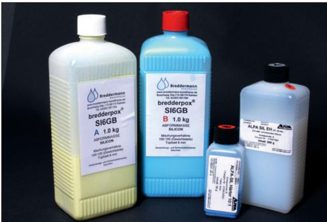
Silikonhaltige Abformmassen dienen zum Herstellen von Gießformen. Sie werden ebenfalls in zwei Komponenten geliefert, die nach dem Mischen mit dem Vernetzen beginnen.
