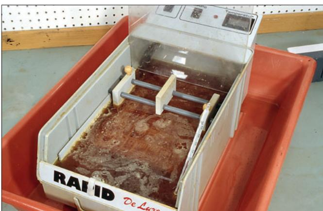
Im Ätzbad wird das nicht vom Ätzresist geschützte Material weggeätzt. Da von beiden Seiten eingewirkt wird, können Anätzungen oder Durchätzungen erfolgen.
