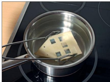
Auf der Herdplatte können die Bauteile mit Wasser erwärmt und dann gerichtet werden.
