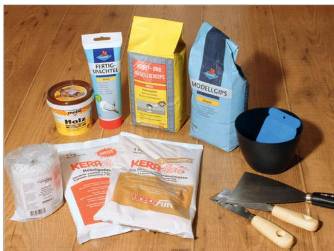
Gips ist ein vielseitiger Baustoff. Im Bereich Modellbahn wird er vor allem zur Anlagengestaltung eingesetzt. Als Gießmasse für Abgüsse von Formen lässt er sich ebenso verwenden wie zum Verspachteln. Gips gibts lose, in Tuben oder als Gipsbinden auf Gewebebasis.
