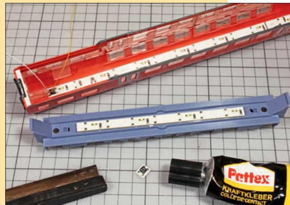
Mit normalem Alleskleber können auch Karton und Papier geklebt werden, ohne dass diese Materialien aufquellen. Mit Aceton lässt er sich zudem leicht verdünnen, um die Fließfähigkeit zu verbessern. Wird die Mischung auf eine kleine Spritze gezogen, ist über die feine Kanüle außerdem eine sehr gute Dosierung des Klebers möglich.
