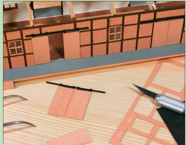
Die Ziegel für Ausfachungen werden mit einem kleinen Skalpell aus dem Trägerbogen geschnitten und der Reihe nach in die passenden Öffnungen zwischen den Fachwerksbalken geklebt.
