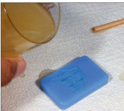
Mit Resin werden die Bauteile abgegossen. Überschüssiges Material streicht man oben ab.
