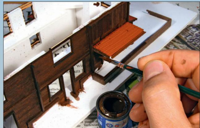
Mit Holzbeize wurde das Holz eingefärbt. In mehreren Arbeitsschritten wurde soviel Beize aufgetragen, bis das typische Dunkelbraun des Vorbilds entstand.
