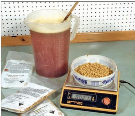
Die Säure mischt man mit Wasser an, in diesem Fall Eisen(III)-Chlorid. Hier sollte man mit Handschuhen und Mundschutz arbeiten. Die Flüssigkeit wird dann für den Ätzzvorgang in die Ätzküvette eingefüllt (rechts).
