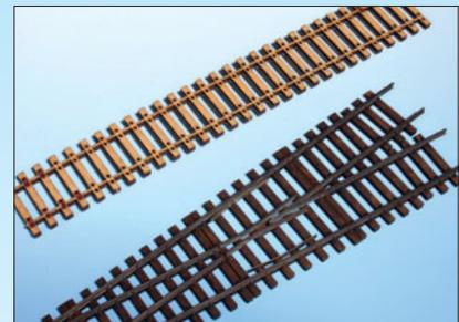
Im Vergleich das fabrikseitige helle Holz oben und eine komplett gebeizte und montierte Weiche unten.
