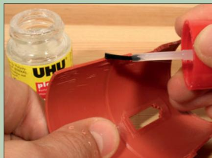
Insbesondere bei älteren Modellen, die oft bereits seit mehreren Jahrzehnten angeboten werden, findet man Gussgrate und Schwimmhäute, da die Spritzformen mittlerweile nicht mehr tauffrisch sind. Mit Feilen und einem Skalpell kann man diese Rückstände aber meist leicht entfernen (links). Zum Kleben sollte man Kunststoffkleber verwenden, der mit einem Pinsel fein dosiert aufgetragen werden kann (rechts).
