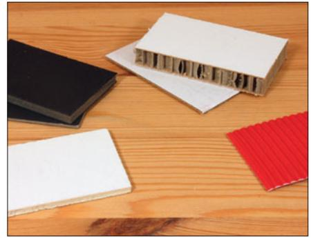
Insbesondere für den Modellbau sind Wellpappe, Wabenkarton oder Sandwich-Karton mit innenliegendem Schaumkern geeignet.
