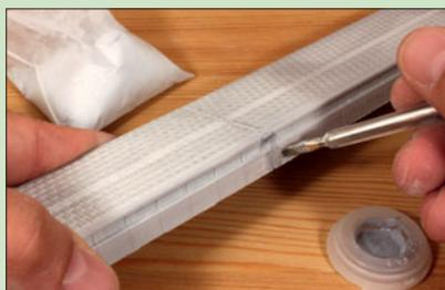
Die Spalten an den Stoßkanten werden mit dem Spezialgips verschlossen.
