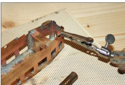
Eine „Dritte Hand“, die beim Löteten kleine Bauteile fixiert, eignet sich besonders für komplizierte Konstruktionen.
