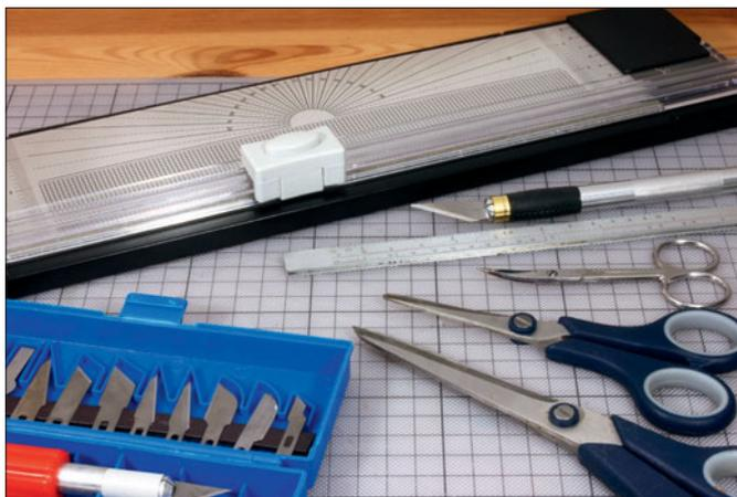
**Zum Schneiden von Papier und Karton sind mehrere Schemen, ein gutes Skalpell mit verschiedenen Klingen sowie ein Stahllineal als Anschlag unersetzlich. Auch eine Schneidemaschine für Papier kann äußerst hilfreich sein.**
