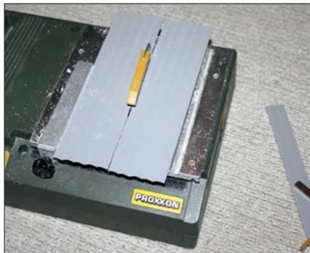
Stärkere Polystyrolplatten können dagegen mit einer Kreissäge geschnitten werden.
