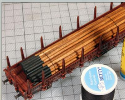
Die Holzmasten werden gesattelt übereinander auf einem Flachwagen verladen. Zum Festbinden auf dem Wagenboden eignet sich Zwirn oder dünner Draht, der durch Ösen oder kleine Löcher im Wagenboden gefädelt wird. Die Holzmasten dürfen dabei die Borde der Stirnwände nicht überragen.
