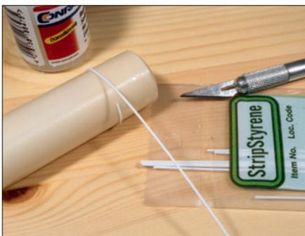
Zum Kleben verwendet man am besten herkömmlichen Kunststoffkleber, dieser sollte sparsam dosiert werden. Er löst den Kunststoff an, bei zuviel Kleber können Details und Oberfläche jedoch beschädigt werden.
