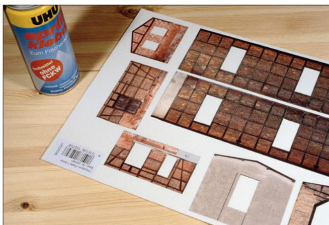
Vor dem Zusammenbau der Wände wurden die Klebeflächen der Kunststoffplatten im Winkel von 45 Grad angeschragt. Die Seitenflächen der ausgefrästen Fensteröffnungen erhielten einen Anstrich in der Farbe der Fachwerkbalken.
