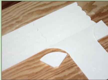
Die Bauteile werden so lange durch Schleifen bearbeitet, bis sie bündig zusammenpassen.
