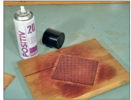
Mittels Beschichtungsmaterial aus der Spraydose können Bleche oder Leiterplatten auch selbst mit einem Lack versehen werden.
