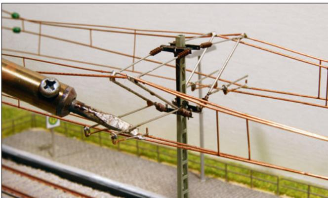
Viele Metallkonstruktionen wie Fahrleitungen müssen gelötet werden. Hier sollte man schnell löteten, da sich sonst benachbarte Lötunkte durch die Wärme wieder lösen können. Mit Alufolie oder Metallklammern kann man die Wärme abführen.
