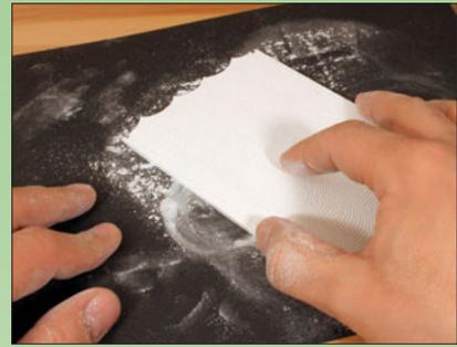
In der Höhe können die kompletten Bauteile auf Schleifpapier in kreisenden Bewegungen heruntergeschliffen werden.
