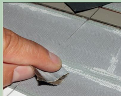
Überschüssige Spachtelmasse muss man vorsichtig mit Schleifpapier abschleifen – möglichst ohne die Oberfläche der Pflasterung zu beschädigen ...
