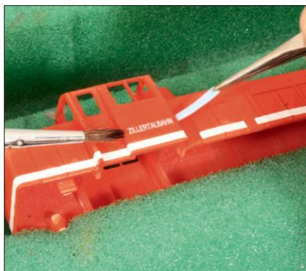
Die abgelösten Nassschiebebilder werden mit einem Pinsel im feuchten Zustand auf der Oberfläche positioniert.
