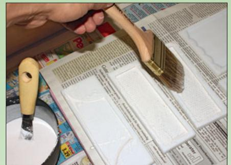
Mit einem Pinsel wird vorab etwas Gießmaterial in die Ecken eingebracht.
