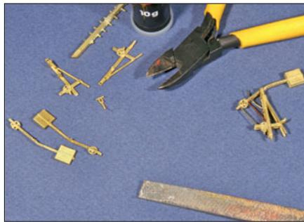
Messinggussbauteile trennt man mit einem Seitenschneider vom Gussbaum und glättet die Schnittkante mit einer feinen Feile.
