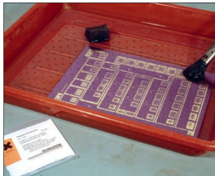
Die belichteten Oberflächen werden anschließend entwickelt. Die dann abgedeckten Flächen schützen vor der Ätzflüssigkeit.
