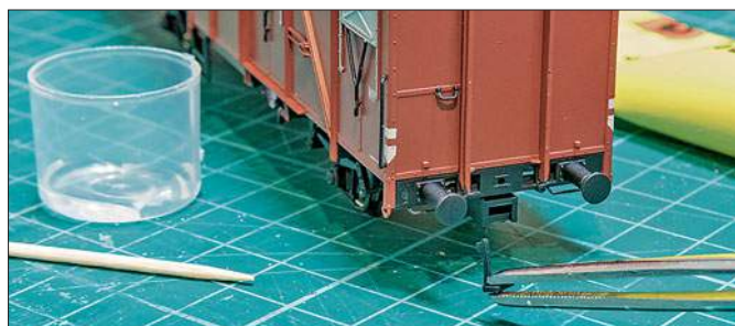
Zurüstteile sollten vor dem Bearbeiten des Wagens mit einem Tropfen Kleber (Alles- oder Sekundenkleber) gesichert werden.
