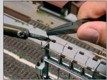
Oben: Die Querleitungen zu den Schaltern am zentralen Schaltposten werden mit Isolatoren bestückt und einzeln auf die Schalterkontakte gelötet. An den Enden sind die Isolatoren nicht zu vergessen. Hier wird dann die Speiseleitung angeschlossen, über die beim Vorbild die Stromversorgung erfolgt.
