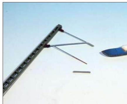
Will man an die Ausleger von Viessmann Fahrdrähte anlöten, müssen vorab die Kunststoff-Manschetten entfernt werden. Sie lassen sich mit einem Skalpell abschaben. Das Metall darunter sollte man anschließend anschleifen.
