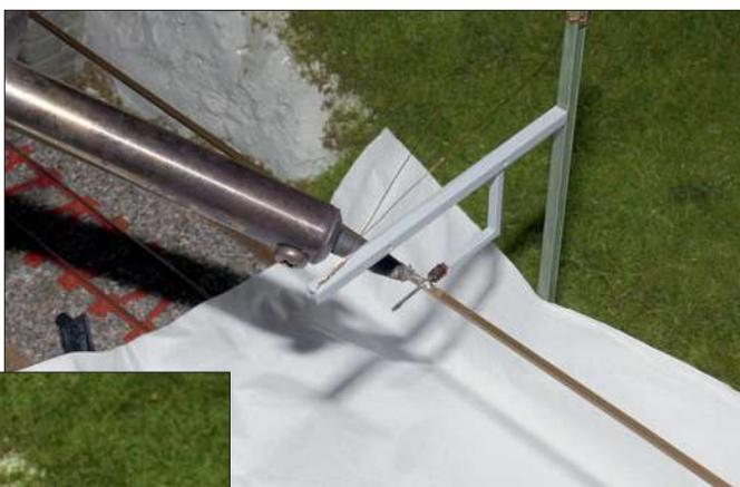
Zur Aufnahme der Abspannungen werden auf die Messingprofile kleine Drahtstücke gelötet. Man hält sie beim Löten mit einer feinen Zange fest und achtet auf eine rechtwinklige Position. Auch hier empfiehlt es sich, Draht und Messingprofil zuvor mit Lötzinn zu versehen.
