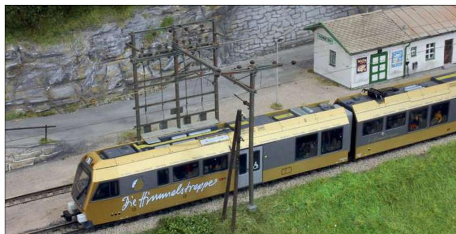
Einige ausländische Bahnen verfügen über zentrale Schaltposten wie hier die Mariazellerbahn: Das Gerüst trägt mehrere Schalter für Fahrleitungsbereiche und Masttransformatoren unweit des Schaltpostens.
