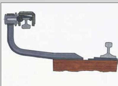
Die Zeichnung verdeutlicht die Befestigung einer Stromschiene auf der Schwelle mittels Halterung. Von oben ist eine Abdeckung der Stromschiene vorhanden. Halterung und Abdeckung sind geerdet.
