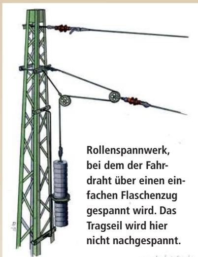
Rollenspannwerk, bei dem der Fahrdraht über einen einfachen Flaschenzug gespannt wird. Das Tragseil wird hier nicht nachgespannt.
