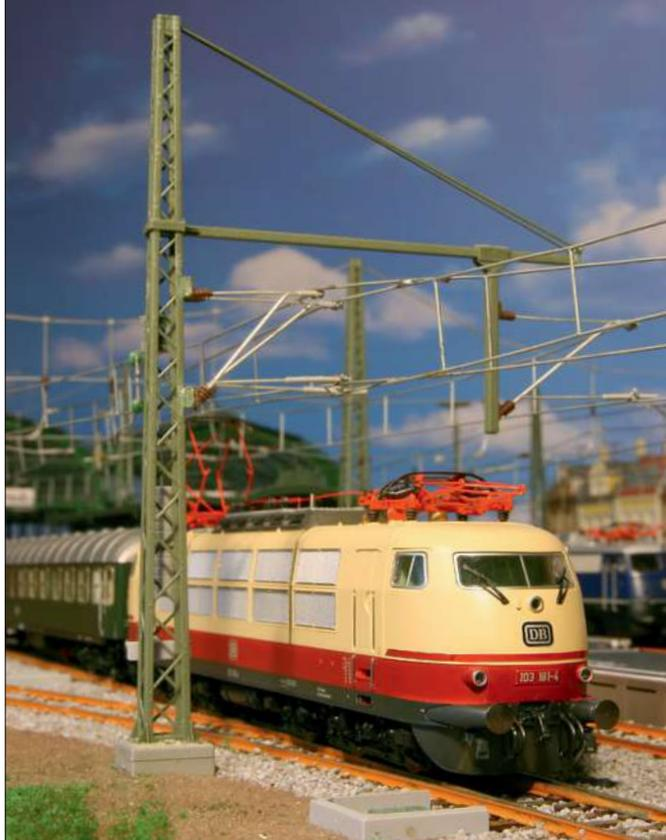
Dieser Turmmast von Viessmann hat einen Rohausleger, mit dem er mehrere Gleise überspannen kann. Da auf dem ersten Gleis am Mast eine Weiche liegt, muss hier ein Doppelausleger montiert werden, sodass zwei Fahrdrähte für die beiden Fahrwege der Weiche befestigt werden können. Sowohl Doppelausleger als auch Halterung entstanden im Eigenbau.
