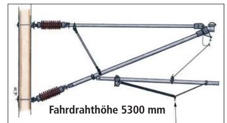
Mit steigenden Geschwindigkeiten werden die Konstruktionen der Ausleger aufwendiger. Oben ein Ausleger der Bauart 1928 der DRG ohne Seitenhalter für eher geringe Geschwindigkeiten. Darunter ein Ausleger für die Re 160 mit Seitenhalter. Ganz unten ein Ausleger für die Re 250/330 mit zusätzlicher Aussteifung.
