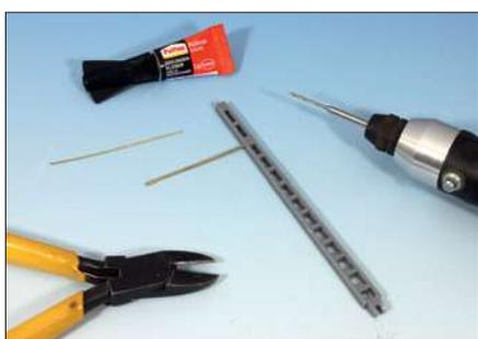
An einem Mast von Hobbex wurden die Ausleger entfernt. Der neue Ausleger für die Einfachfahrleitung entstand aus dünnem Draht, der in eine Bohrung eingeklebt wurde. Am oberen Ende bekam der Mast ein weiteres Loch, das zur Abspannung des Auslegers dient.
