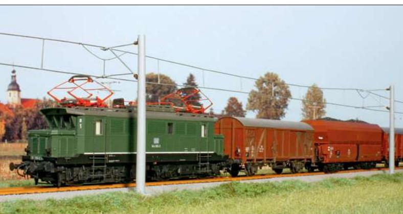
**Typisch Epoche II auf dem großen Bild oben mit Einheitsfahrleitung der DRG von 1928 von Sommerfeldt in H0. Die Stahlmasten wurden hier einbetoniert. Ab der Epoche III setzte man auch auf Fertigteilmasten aus Beton, die in ein Fundament gegossen wurden (links).**
