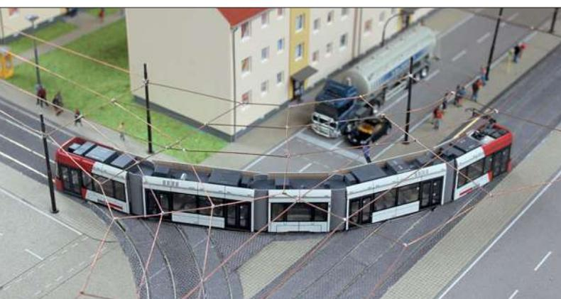
**Einfachfahrleitungen findet man oft bei innerstädtischen Straßenbahnen. An großen Kreuzungen oder Gleisverzweigungen kann man keine Masten neben die Gleise stellen. Hier werden dann Stahlseile über die Kreuzung gespannt, die die Fahrdrähte tragen.**
