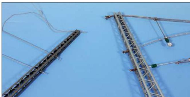
Bei den Quertragwerken von Viessmann knotet man die Tragseile aus Litzen fest, die Richtseile werden umgebogen und eingehängt. Bei Sommerfeldt dienen Hülsen als Anschlagpunkt der Seile am Mast.
