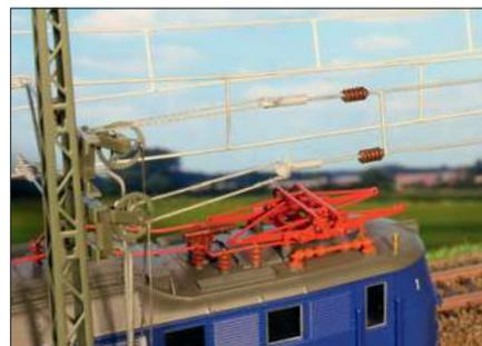
Im Bild ist das Spannwerk von Viessmann in TT zu sehen. Hier werden Fahrdrabt und Tragseil einzeln nachgespannt.
