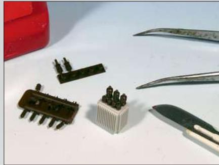
Einen Masttrafo bietet Sommerfeldt als Bausatz aus wenigen Bauteilen an (links). Der Trafo besteht aus Kunststoff und muss mit Isolatoren bestückt werden. Diese trennt man vom Spritzling, entgratet sie wenn erforderlich und klebt sie in die entsprechenden Löcher im Trafo (rechts). Eine Lackierung des grauen Trafos ist nicht zwingend erforderlich. Er kann mit den Befestigungswinkeln beliebig an Masten montiert werden.
