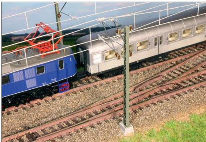
Das Detailfoto zeigt die Bespannung an einem Doppelausleger. Durch die Drahtstärken und die engen Radien im Modellbereich wird der Platz am Ausleger sehr dicht und die Drähte liegen hier sehr eng nebeneinander. Die Ausleger sollten nicht unter großer mechanischer Spannung stehen.
