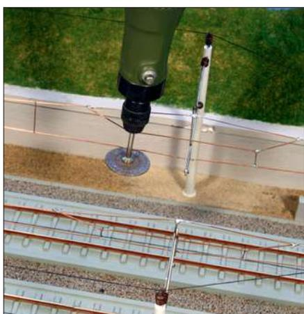
Mit einer kleinen Schleifscheibe lassen sich die Lötstellen von unten glätten.
