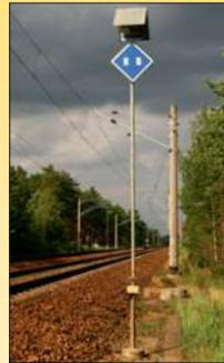
Schutzstrecken sind an einem Ausleger montiert und auf beiden Seiten durch entsprechende Signale gekennzeichnet.
