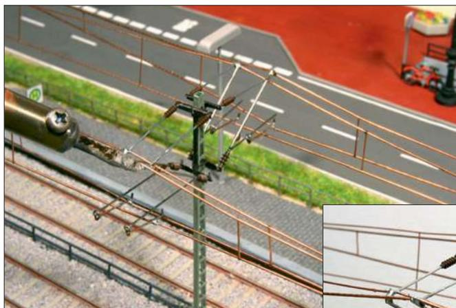
An diesen Mittelmast mit Doppelausleger werden Profi-Fahrdrähte von Sommerfeldt gelötet. Zuvor müssen alle Isolatoren und Seitenhalter montiert werden.
