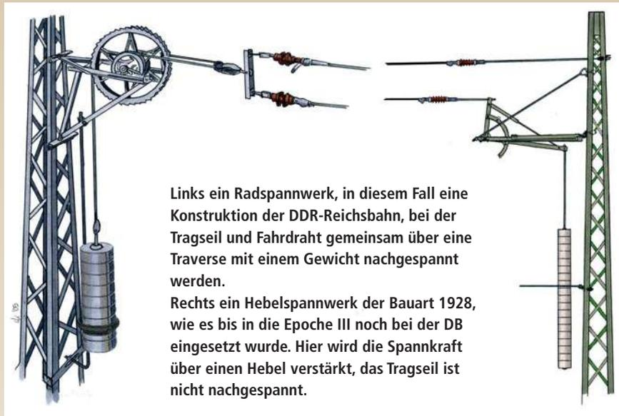
Links ein Radspannwerk, in diesem Fall eine Konstruktion der DDR-Reichsbahn, bei der Tragseil und Fahrdraht gemeinsam über eine Traverse mit einem Gewicht nachgespannt werden.
