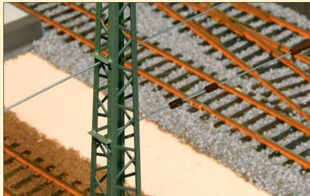
An den Viessmann-Masten können Quertragwerke für Kettenwerke, also Fahrdrähte mit Tragseil, nachgebildet werden. Zur Montage der Richtseile werden die Masten etwas zusammengeschoben.
