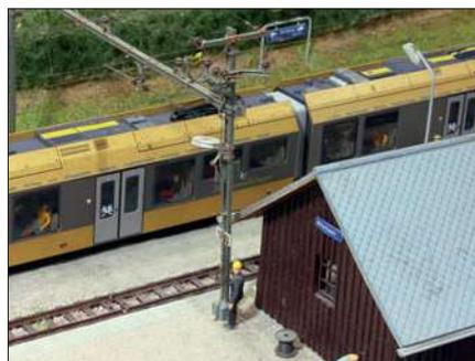
Um allen am Ladevorgang Beteiligten zu verdeutlichen, dass der Fahrdracht über dem Ladegleis stromlos ist, sind mit den Schaltern verbundene, bewegliche Signaltafeln am Mast angebracht. Sie klappen herunter, wenn das Gleis stromlos ist und verdeutlichen im Gegenfall mit einem sichtbaren Pfeil den spannungsführenden Zustand. Im Modell von Josef Kaufmann ist das Schild mit einem Stelldraht zu einem Servo-Antrieb unter der Anlage verbunden.
