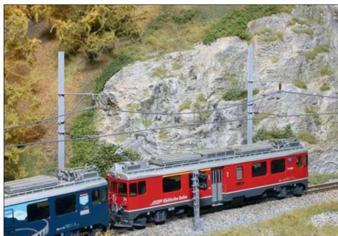
Hier musste der Fahrdraht unter einer Lawingalerie hindurchgeführt werden. Das Tragseil wurde unter Einbeziehung eines Isolators an der Decke der Galerie befestigt, während die Ausleger für den Fahrdraht an der Stützwand sitzen.
