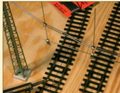
Das Quertragseil wurde doppelt geführt. Hier sind bereits die Hänger mit aufgeschobenen Isolatoren montiert. Zur Befestigung dienen kleine Blechwinkel, die man dann verlötet (unten).
