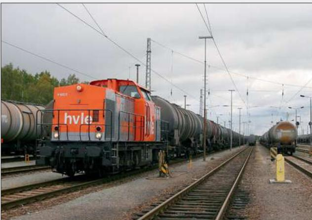
Im Werkbanhof Stendell sind über den Ein- und Ausfahrgleisen Einfachfahrleitungen verbaut. Sie hängen an Quertragwerken und sind an den Stützpunkten mit zusätzlichen Aufhängungen befestigt.
