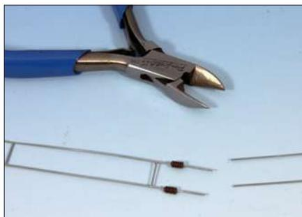
Zur authentischen Nachbildung der Abspannung fädelt man auf den getrennten Fahrdrabt Isolatoren auf.
