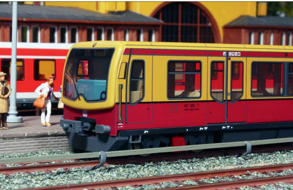
Die S-Bahnen in Berlin und Hamburg sowie U-Bahnen besitzen Stromschienen an der Seite, über die Stromabnehmer an den Drehgestellen den Strom abnehmen. Wer eine Strecke entsprechender Bahnen nachbaut, sollte auf die seitlichen Stromschienen nicht verzichten.
