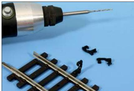
Die Kunststoffhalter der Stromschienen werden senkrecht stehend in kleine Bohrungen der Schwellen geklebt.
