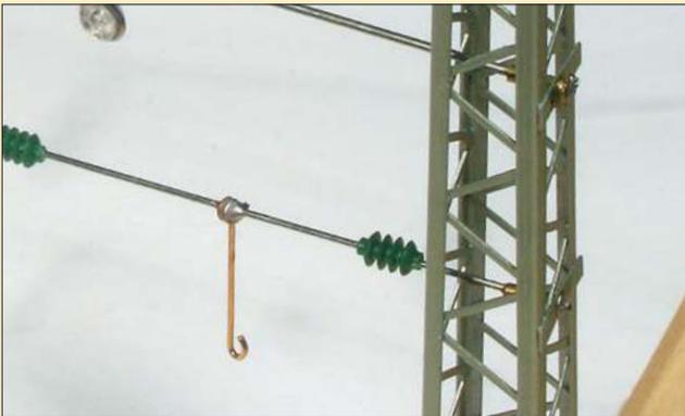
Die Richtseile sind mit Hohnieten an den Masten befestigt. Dazu werden die Hohnieten eingesteckt und die Drähte fixiert. Beim Einlöten werden sie etwas gespannt, damit die Richtseile anschließend nicht durchhängen. Die Masten dürfen dabei nicht nach innen gebogen werden.
