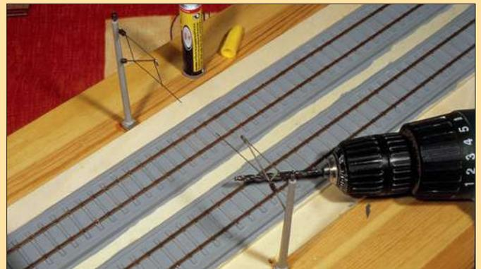
In die Mastpositionslehre von Viessmann kann man die je nach Bogenradius möglichen Fahrdrahtlängen einlegen und die Maststandorte bestimmen. Die Masten müssen soweit von der Gleisachse entfernt stehen, dass das Lichtraumprofil – im Bogen gegebenenfalls mit zusätzlichem Erweiterungsmaß – eingehalten wird.
