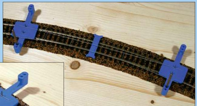
Viessmann bietet eine Montagelehre aus Kunststoff an, die auf die Gleise gestellt wird. So kann die Fahrdrahtposition ermittelt werden. Der Bereich des Fahrdraht-Zick-Zacks ist hierauf markiert.
