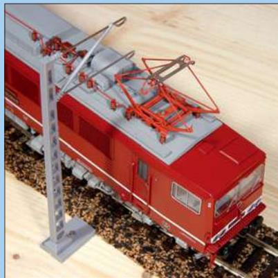
Zur Ausrichtung der Fahrleitung und zur Bestimmung der korrekten Lage der Ausleger können auch Modellfahrzeuge dienen – ihre Stromabnehmer geben die genaue Lage des Fahrdrahts vor.
