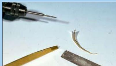
Zur Einfahrt in die Tunneloberleitung wird der Messingstreifen angeschrägt und mit einer Feile geglättet. Der Fahrdraht wird einfach in eine Bohrung eingehängt – dabei sollte ein „fließender“ Übergang entstehen.
