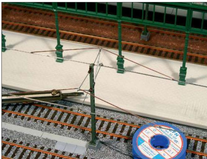
Auch bei Vollbahnen findet man Einfachfahrleitungen. In Bahnhofshallen oder an Nebengleisen genügen diese. Hier wurde an einem Fahrleitungsmast von Viessmann ein einfacher Fahrdraht aufgehängt. Der obere Auslegerarm trägt eine zusätzliche Abspannung zu beiden Seiten. Der Mast musste dazu nicht angepasst werden.
