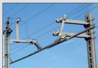
**Auf der Hubbrücke in Anklam wurde der Fahrdrabt im beweglichen Bereich in Stromschienen geführt.**
