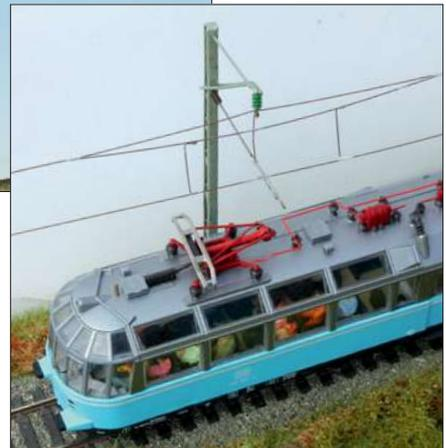
Das Selbstlöten von Fahrleitungen mit sehr dünnen Drähten ist die hohe Schule des Modellbaus. Belohnt wird man mit filigranen Modellen, die aber sehr leicht verbiegen können. Im Betrieb sollten die Stromabnehmer durch einen dünnen Draht in der Höhe begrenzt werden, sodass sie nicht am Fahrdraht anliegen.
