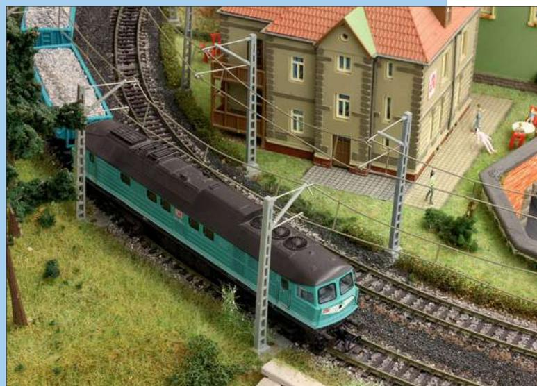
Die Viessmann-Tunneloberleitung besteht aus steckbaren Kunststoffmasten, die ein schmales Messingband als stabile Fahrleitung halten.
