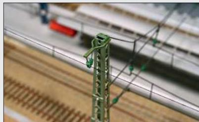
Rechts: Die steile Höllentalbahn führt zwei Speiseleitungen an den Masten mit, um den Stromverbrauch der Fahrzeuge sichern zu können; hier an einem Einheitsfahrleitungsmast der Bauart 1928.
