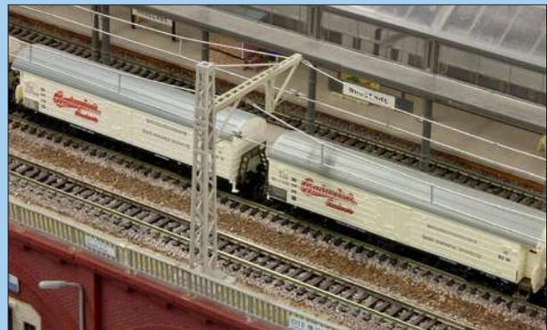
In dieser Kurve erkennt man gut die kurzen Ausleger an der Außenseite des Gleisbogens und die langen Ausleger an der Innenseite. Die Standfüße der Hobbex-Masten stehen hier direkt am Gleis.
