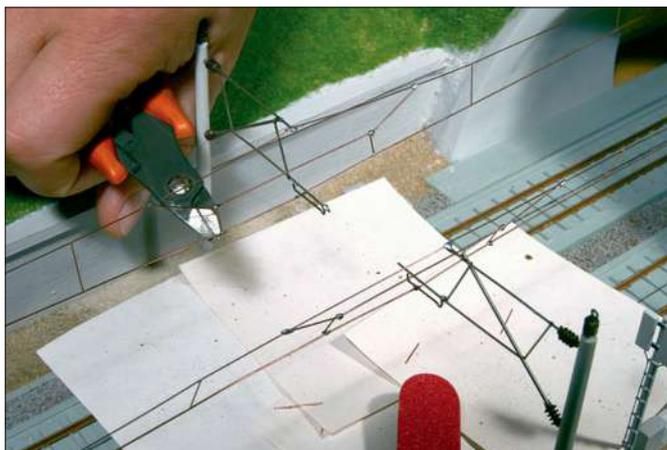
**Überstehende Drahtenden können mit einem Seitenschneider abgeknipt werden. Kurze Drahtenden sind nur schwer aus gestalteten Landschaften zu entfernen, sie sollten beim Abkneifen aufgefangen werden. Die Schnittfläche kann man anschließend beschleifen und glätten.**
