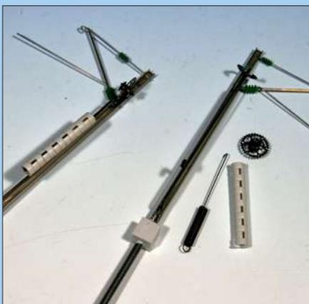
Eine Oberleitung wirkt erst authentisch, wenn sie mit vielen vorbildgerechten Details ausgestattet ist. Trenner, Mastschalter oder Spannwerke in den verschiedenen Bauformen sind von Sommerfeldt auch einzeln erhältlich und lassen sich nachträglich montieren. Hier wird ein funktionsfähiges Spannwerk an einen Stahlmast montiert.
