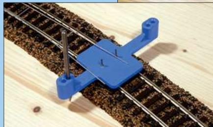
Mit einer Nadel wird die Mastposition markiert. Das Fahrdrahtspiel ist in Gleismitte durch Drahtstifte angedeutet.
