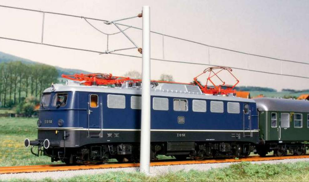
Für den Schnellverkehr der Epoche III wurden die Y-Beiseile zwischen Tragseil und Fahrdrabt eingeführt (oben). Die Fahrdräfte werden mit den Ösen auf den Rillenmanschetten der Ausleger platziert und mit einer Zange festgedrückt.
