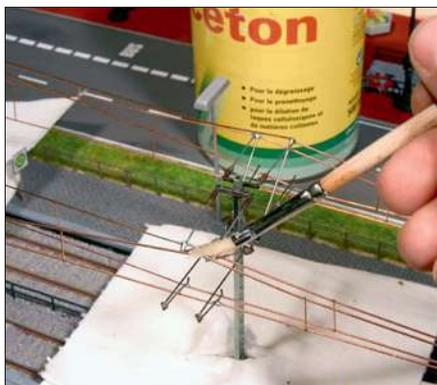
Überschüssiges Flussmittel kann zur Oxidation des Metalls führen. Hier sollte man nach dem Löten gründlich reinigen.
