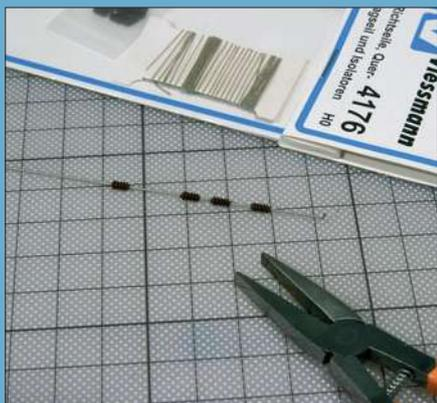
Auf die Richtseile fädelt man Isolatoren und biegt den Draht an einem Ende mit einem Überstand von 5 mm rechtwinkling um.
