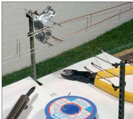
Um zu verhindern, dass sich benachbarte Lötstellen durch Wärme wieder lösen, kann man mit Alufolie die Wärme ableiten.
