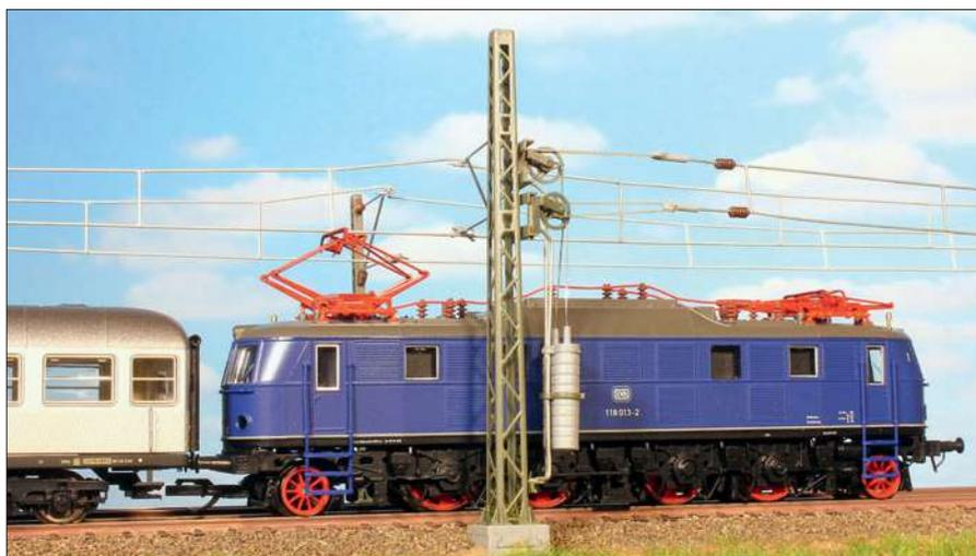
Die Szene zeigt, dass mit Materialien von Viessmann ansehnliche Fahrleitungen in der Baugröße TT nachgebildet werden können. Das Gleis auf der Bettung und die Masthöhe erlauben es, dass der Pantograph vorbildgerecht am Fahrdrabt anliegt.
