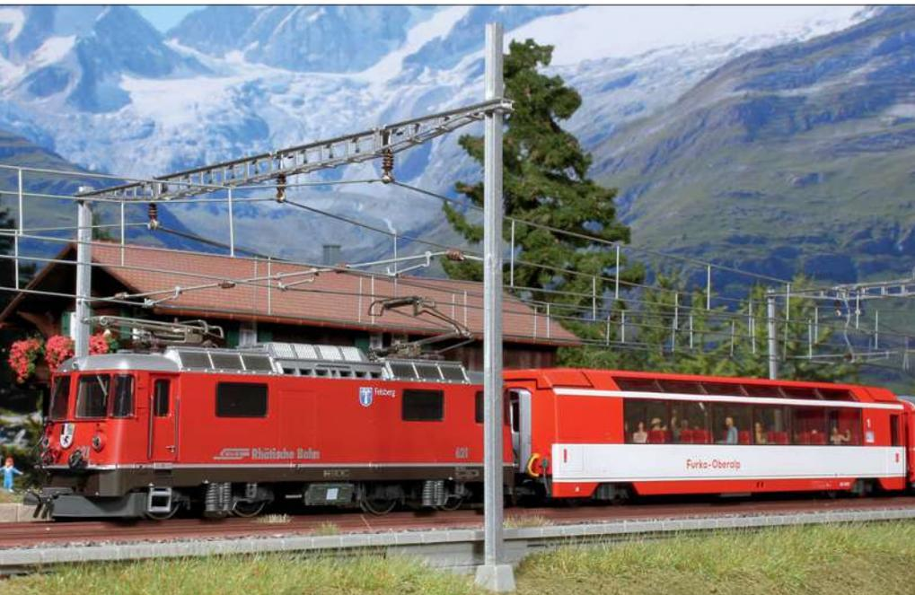
Links: Derartige Querjochs gelten als typisch für die Schweiz. An ihnen sind die Tragseile der Fahrleitungen befestigt. Zusätzlich zu den Tragseilen der Fahrdrähte wurde zwischen den Masten ein Richtseil gespannt, an dem die Seitenhalter für die Fahrdrähte montiert sind. Die Isolatoren dienen der Trennung der Fahrdrähte und Tragseile vom geerdeten Querjoch bzw. von den Masten.
