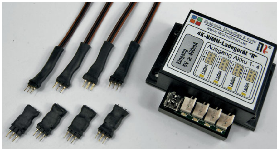
Vielseitig einsetzbar ist das Ladegerät ALC 8500 von ELV, das zahlreiche Einstellmöglichkeiten für die unterschiedlichsten Akkus aufweist und auch für LiPo-Akkus geeignet ist. Unten: An dem Dauerladegerät von Technikron lassen sich bis zu vier 2,4-V-Akkus aufladen; passende Stecker für die Car-System-Fahrzeuge gehören bereits dazu.
