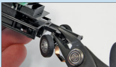
Am Faller-Chassis mussten zwei Auflagepunkte entfernt werden.
