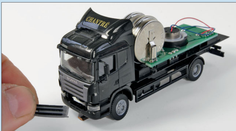
Fixiert wird das Führerhaus an dem Umbau-Chassis durch Anstecken des vorderen Stoßfängers und des oberen Kühlergrills. Der untere Kühlergrill dient nur der Optik.
