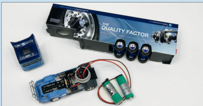
Die beiden probeweise angeschlossenen Akkus finden später im Auflieger ihren Platz. Gut zu sehen ist die große Bohrung zur Verbindung mit der Zugmaschine. Diese passt vom Durchmesser her zum Kunststoffkragen am Antriebsmotor.
