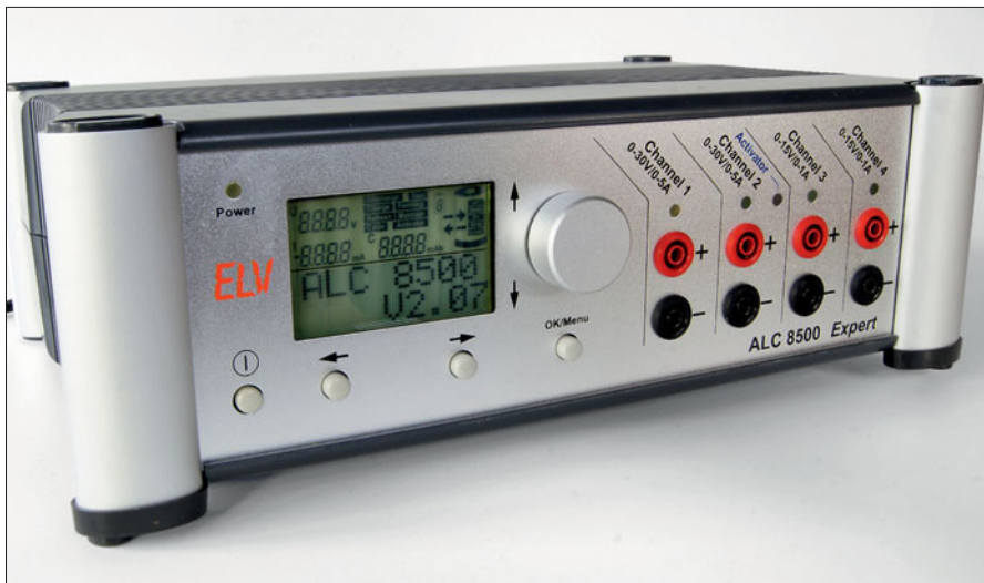
Vielseitig einsetzbar ist das Ladegerät ALC 8500 von ELV, das zahlreiche Einstellmöglichkeiten für die unterschiedlichsten Akkus aufweist und auch für LiPo-Akkus geeignet ist. Unten: An dem Dauerladegerät von Technikron lassen sich bis zu vier 2,4-V-Akkus aufladen; passende Stecker für die Car-System-Fahrzeuge gehören bereits dazu.
