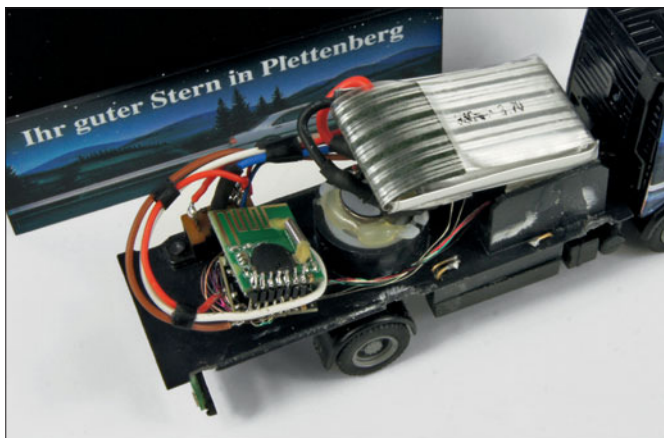
Der OpenCar-Decoder bildet mit dem huckepack montierten Sendemodul eine kompakte Einheit und liegt im hinteren Teil des LKWs.
