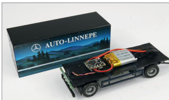
Für Anhänger gibt es einen eigenen Decoder, über den die Rückleuchten und die IR-LEDs für die Abstandsregelung angesteuert werden.
