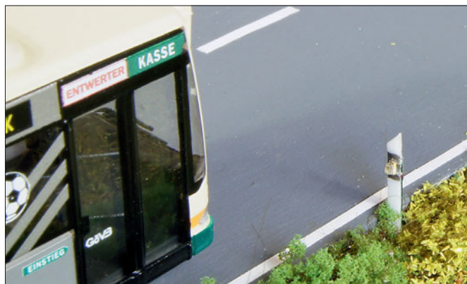
Die IR-Sendediode n sind so klein, dass sie sich fast unsichtbar an Leitpfosten am Straßenrand anbringen lassen.
