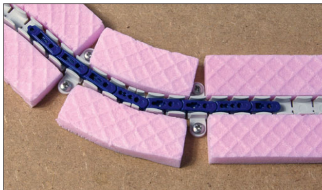
Unterflur fertig montierter Führungsabschnitt mit Kette: Die durchgängig hohe Flexibilität gestattet die Gestaltung enger Kurven.
