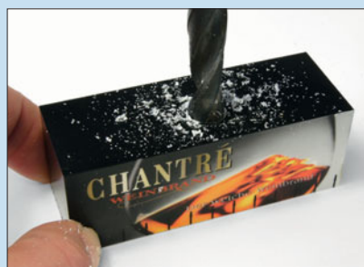
Mit einem 10-mm-Bohrer wird der Koffer geöffnet, danach werden eventuell fransige Kanten versäubert.
