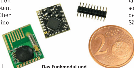
Das Funkmodul und der OpenCar-Decoder werden huckepack mit der Stifteleiste verbunden.
