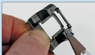
Die Radhäuser des Scania wurden gestutzt, um schleifende Räder zu vermeiden.
