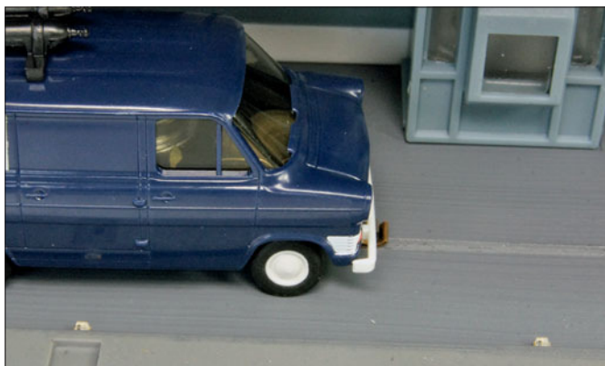
Für die Fahrzeugsteuerung vor Ort können die IR-Sendediode n z.B. in die „Bordsteinkanten“ eingebaut werden.
