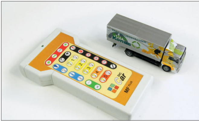
Mit dem Steuergerät MF Plus können DC-Car-Fahrzeuge gesteuert und auch IR-Übertragungen geprüft werden.
