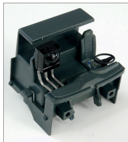
Auf dem Beifahrersitz montierter LCIR-Empfänger zur Fahrzeugsteuerung
