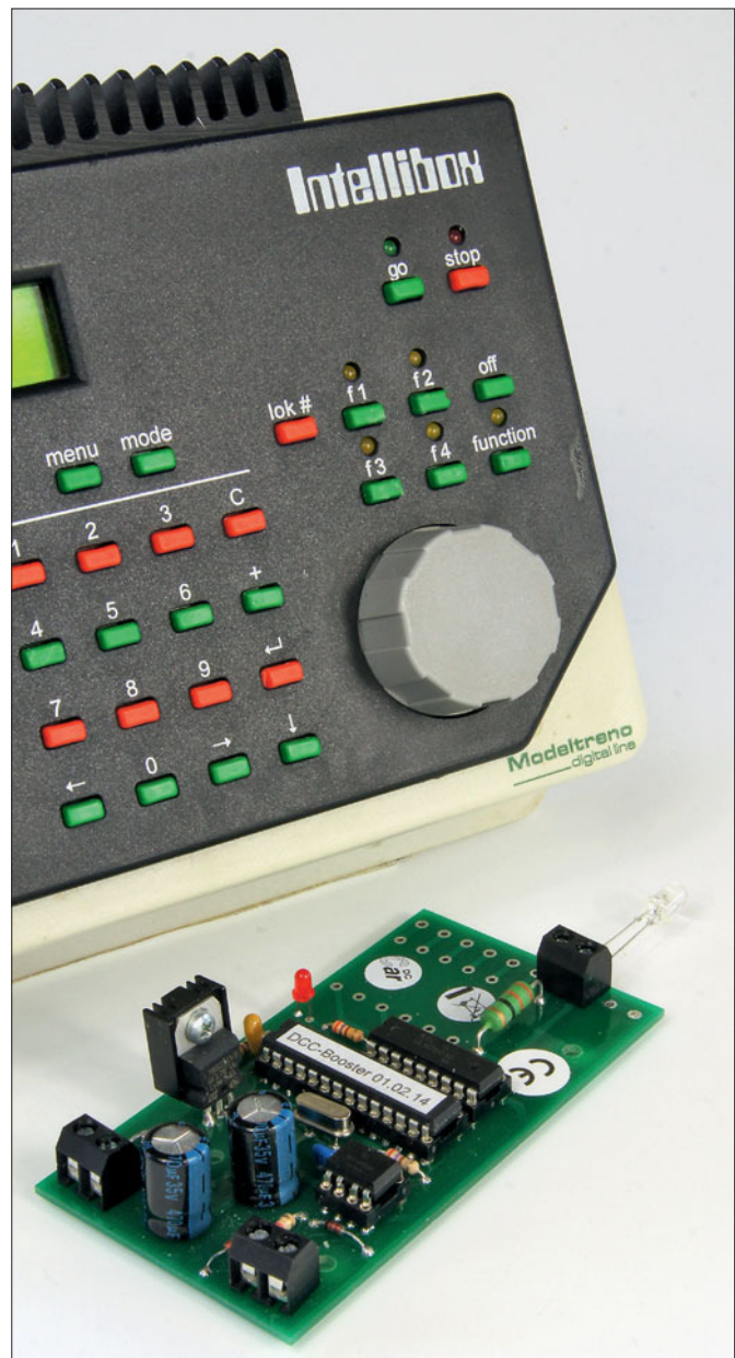
Das XT-Modul empfängt von IR-Sendedioden am Fahrzeug Informationen und kann eine Vielzahl von Aktionen auslösen.
