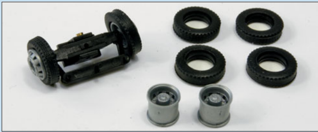
Auch die Gummireifen der Lenk- und Antriebsachse sollten für einen sicheren Fahrbetrieb von Zeit zu Zeit ausgetauscht werden.
