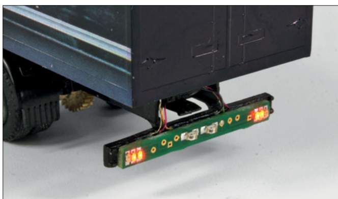
Der hintere Leuchenträger trägt neben den LEDs der Fahrzeugbeleuchtung auch zwei Infrarot-LEDs für die Abstandsregelung.
