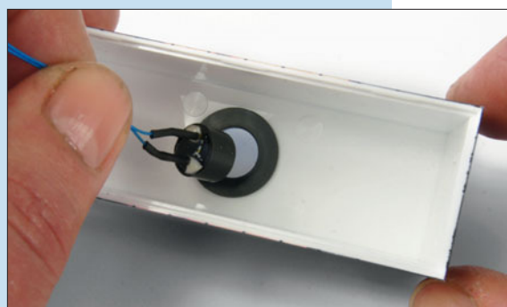
... die Ultraschallkapsel nach dem Aushärten des Klebstoffs eingesteckt.
