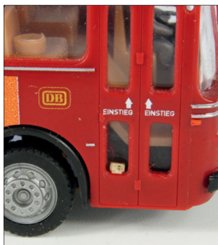
Seitlich montierte IR-Sendediode zur Verkehrssteuerung mit dem XT-Modul
