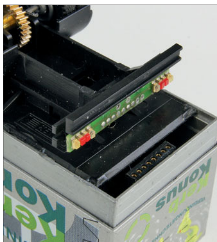
Lampenträger und Lade- bzw. Programmierbuchse unter einem LKW mit Kofferaufbau
