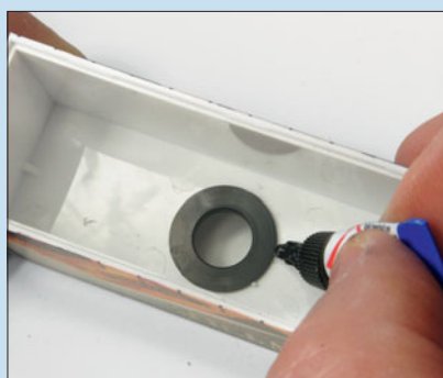
Der Positionierungsring wird in den Aufbau eingeklebt und ...
