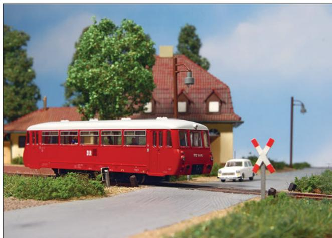
An Neben- oder Schmalspurstrecken und Straßen mit geringem Verkehrsaufkommen genügen Bahnübergänge ohne technische Sicherung. Solche Übergänge waren auf der Straßenseite mit Warnkreuz und Baken und auf der Gleisseite durch Pfeiftafeln gesichert. Die Sicht auf den Bahnübergang muss durch alle Verkehrsteilnehmer gewährleistet sein – wie, bestimmt das Sichtdreieck nach Bahnübergangsvorschrift.
