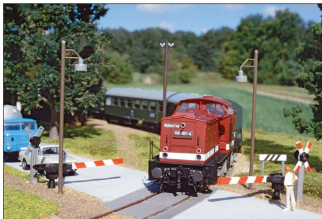
Bei der Ost-Reichsbahn baute man vielerorts ebenfalls zugbediente Bahnübergänge mit Blinklichtanlage und bei Bedarf auch Halbschranken. Hier errichtete man gleisseitig ebenfalls Überwachungssignale. So konnte eine Störung erkannt und der Zug rechtzeitig abgebremst werden.
