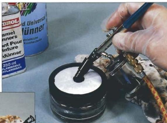
Professionell: die Reinigungsstation von ModelMaster. Die Einsprühöffnung umschließt die Düsenkappe der meisten Pistolen recht dicht.
