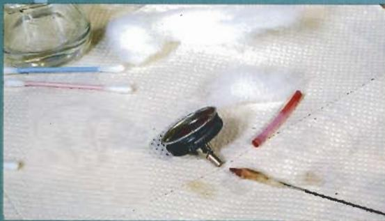
Die Pistole im zerlegtem Zustand. Das Luftventilgehäuse (unten) braucht bei der Reinigung nicht abgeschraubt zu werden.
