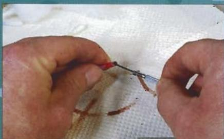
Häufige Fehlerquelle: Verstopfungen des Farbanaugrohres. Die Klinge eines kleinen Schraubendrehers löst die Verkrustungen.
