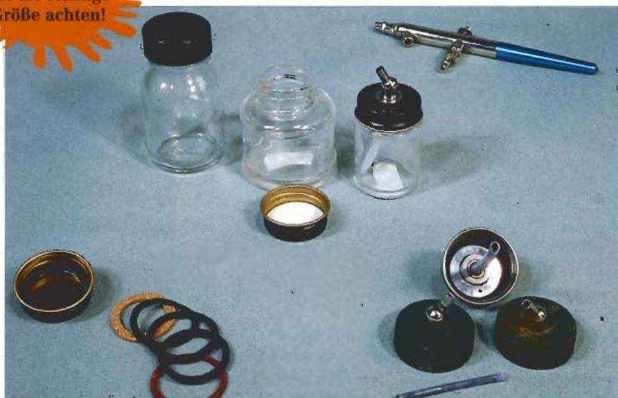
Als Zubehör gibt es unterschiedlich große Farbgläser. In die Deckel gehören intakte Dichtungen. Topfanpassungstücke (im Vordergrund) sollten grundsätzlich aus Metall bestehen. Solche aus Kunststoff bekommen beim Auf- und Abdrehen schnell Risse und werden undicht.
