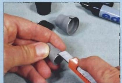
Die Napfe sind zweiteilig ausgeführt. Farbe kommt nur in die Pistole, wenn beide Öffnungen übereinander liegen. Es empfiehlt sich, die passende Stelle mit einer Einkerbung zu markieren.
