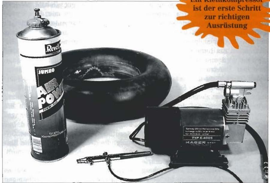
Druckluftlieferanten für die ersten Spritzversuche: Flasche, Autoreifen oder ein kleiner Membrankompressor.
