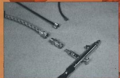
Erleichterung bringen sogenannte Schnellkupplungen, bei denen die Airbrush bajonettenartig aufgedrückt und abgezogen wird. Der Hochdruckschlauch vorne kommt zum Einsatz, wenn mit Kompressoren und höherem Druck gearbeitet wird.
