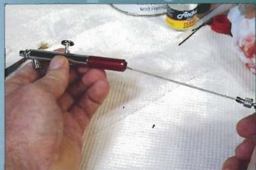
Zunächst wird durch Lösen der rückwärtigen Feststellschraube die verschmutzte Nadel entnommen ...
