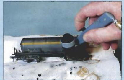
Dank der universellen Ansteck- und Verschwenkbarkeit des Farbnapfes kann auch aus extremen Richtungen gespritzt werden, z.B. fast vertikal.
