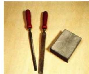
Feilen in unterschiedlichen Formen und Schleifschwamm dienen der Nachbearbeitung von Sägeschnitten.
