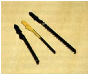
Eine kleine Auswahl von Stichsägeblättern. Für unsere Zwecke sind die mittleren Ausführungen und feingezackte für Metall am geeignetsten.
