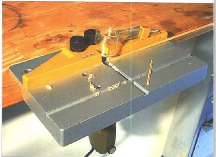
Das Fräsen von Profilen (und nicht nur das) ermöglicht der Frästisch Proxxon FT300, der an die Vorderseite einer Werkbank angeschraubt wird.
