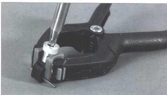
So gehts: Die Kraftklemme hält, mit dem Fräser und der Führung kann Platz ausgefräst werden.
