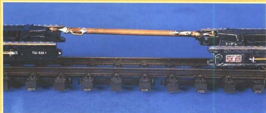
Rollwagen gekuppelt mit langen Eigenbau-Kuppelstangen
