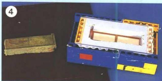
④ Der LEGO-Kasten wird nach dem Aushärten des Silikons abgenommen, hier blieb die Knete an der Grundplatte haften.
