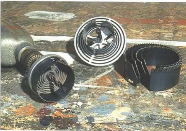
Ein Spezialist für kreisrunde Löcher ist die Lochsäge mit kreisrund gebogenen Sägeblättern. Eingespannt wird die Lochsäge in eine Bohrmaschine.
