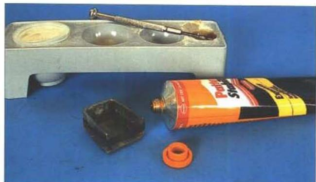
Für besonders haltbare Verklebungen, beispielsweise an Lokgehäusen, ist Zweikomponentenkleber eine gute Alternative zum Löten.
