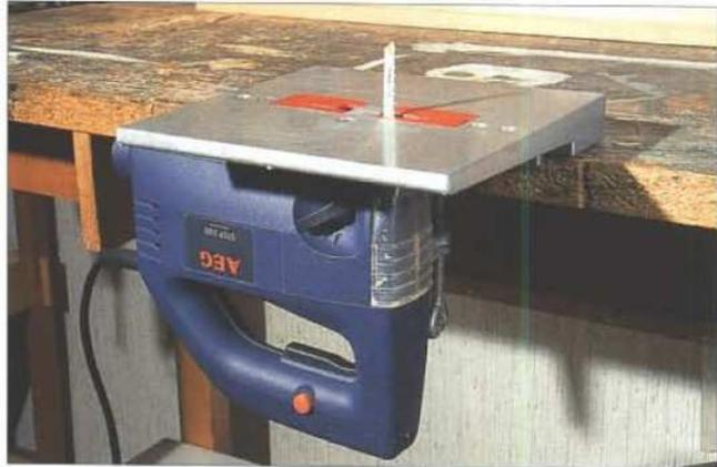
Ein Multitalent beim Anlagenbau ist die Stichsäge, vor allem in Verbindung mit einem kleinen Sägetisch.
