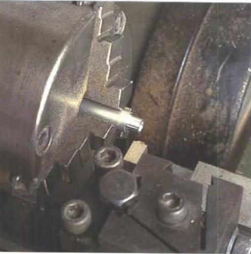
Zum Abdrehen von Rädern wird der RP-25-Formstahl eingespannt, im Dreibackenfutter ist bereits das Klemmstück gespannt.
