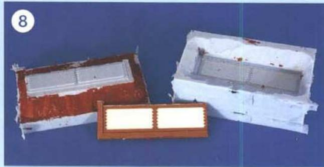
⑧ Die Form ist fertig, das Urmodell kann entnommen werden, die Farbreste der Trennschicht kleben jetzt am Formoberteil.
