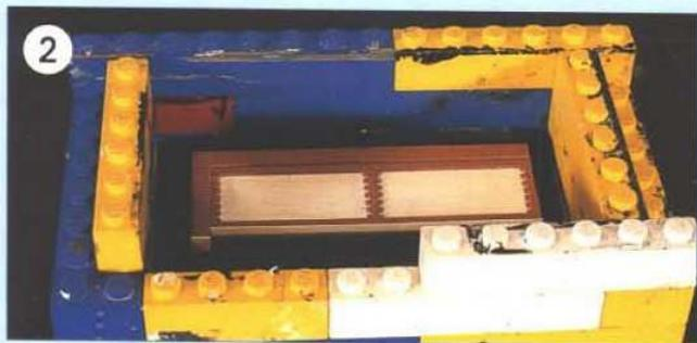
② Der Formkasten entsteht aus LEGO-Steinen.
