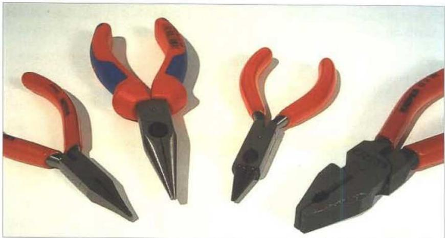
Die Flach- und die Rundzange (links) dienen ausschließlich fürs Greifen und Halten, während die Kombizange (rechts) und die Flachrundzange mit Schneide auch noch Schneiden zum Trennen von Drähten haben. Diese Schneiden sind in der Regel weniger belastbar als jene spezieller Seitenschneider, weshalb man sie nicht zum Trennen harter Materialien wie Stahl verwenden sollte.
