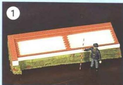
① Das Urmodell, eine Gartenmauer aus Polystyrolteilen, wird in Knetmasse auf ebener Platte befestigt. Der Übergang von der Knete zum Urmodell ist die Trennlinie von Formober- und -unterteil.
