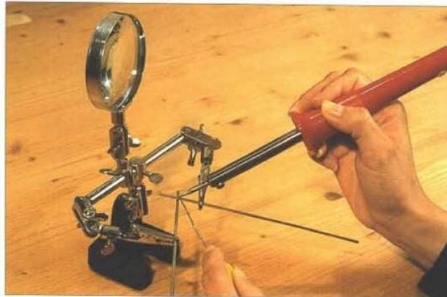
Die „Dritte Hand“ löst Halteprobleme. Hier sind gleichzeitig zwei Werkstücke zu positionieren sowie Lötzinn und LötKolben zu halten.
