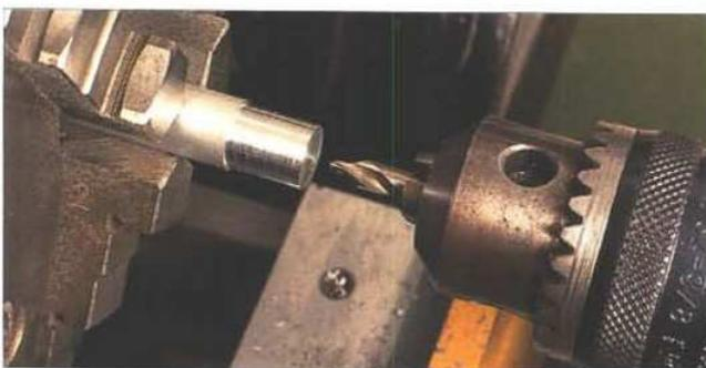
Der eingespannte Zentrierbohrer bohrt nur den Einstich für den Bohrer.
