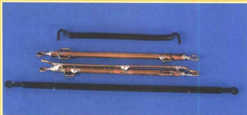
Die Kuppelstangen stammen von Bemo-Rollböcken (schwarz), aus einfachen Drähten mit Haken oder sind aus MS-Rohr und Draht selbst gebaut.
