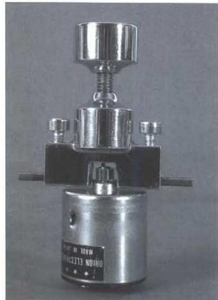
spannt, die empfindlichen Kunststoffradsterne werden nicht mit der Kräfte beim Abdrehen der Räder beaufschlagt und bleiben somit unbeschädigt.
