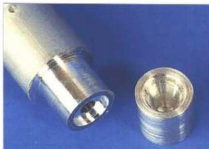
Die Spannvorrichtung fürs Räderabdrehen: links der Mitnehmer, rechts das Druckstück.
