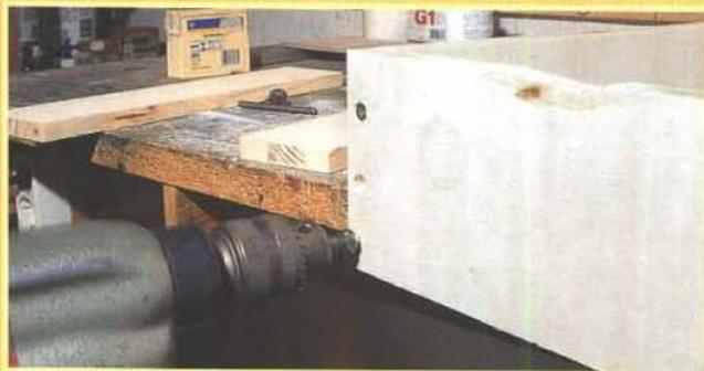
Mit einem Senker, einem HSS-Fräser, werden die Bohrlöcher ange-senkt, so dass der Senkkopf der Holzschraube nicht aus der Oberfläche hervorsteht.
