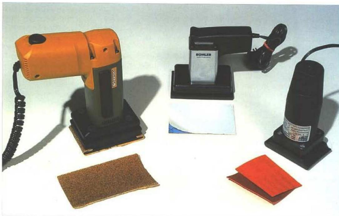
Flächen schleift man mit dem Schwingschleifer leichter als mit dem Schleifklotz. Der Proxxon-Schleifer SR 12 (links) läuft ruhiger als das Mini-Mot-Modell (rechts). Überdies lassen sich die Schleifblätter für den Proxxon dank der Klemmvorrichtung selbst zurechtschneiden, während man wegen der Klettbefestigung bei Mini-Mot auf Schleifblätter dieses Herstellers angewiesen ist. Die Böhler-Maschine (Mitte) arbeitet mit selbst klebendem Schleifpapier.
