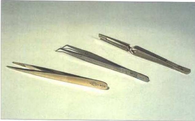
Pinzettenformen: normale Spitzpinzette, Spitzpinzette mit abgewinkelten Spitzen zum Erreichen von verwinkelten Stellen und schließlich Festhaltepinzette mit überkreuzten Schenkeln (als Wärmeableitpinzette mit verstärkten Spitzen um mehr Wärme aufzunehmen).
