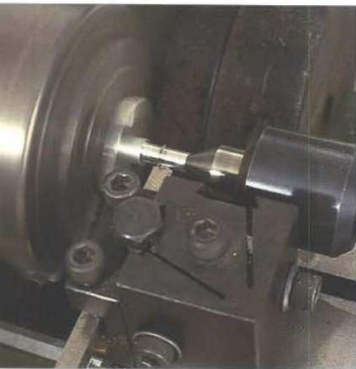
Mit dem Formdrehstahl wird der Spurkranz erst an der Lauffläche, dann an der Radrückseite abgedreht.
