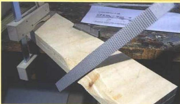
Die beiden nicht genormten Zwischenprofile werden entsprechend dem Geländeverlauf an der Oberseite abgeschrägt, was am besten mit einer Raspel vorstatten geht.
