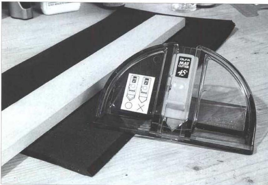
Der Winkelschneider von Olfa, der eigentlich für das Schneiden von Passepartouts gedacht ist, erzeugt auch hervorragend 45-Grad-Schnitte von Gleisbettungen.
