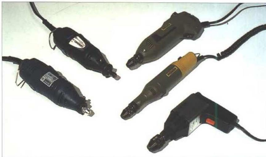
**Bohrmaschinen-Parade:** Ganz rechts die Böhler 320105 mit dem markant-kantigen Gehäuse, dahinter von Proxxon die Micromot 40 für 12 Volt und die FBS 230E für 220 Volt; links daneben die Dremel Multi 285 und davor der „Universal-Handfräser“ von Westfalia, dessen Ähnlichkeit zum Dremel-Gerät unübersehbar ist. Durch das andere Mundstück passen allerdings nicht alle Dremel-Zubehörteile.
