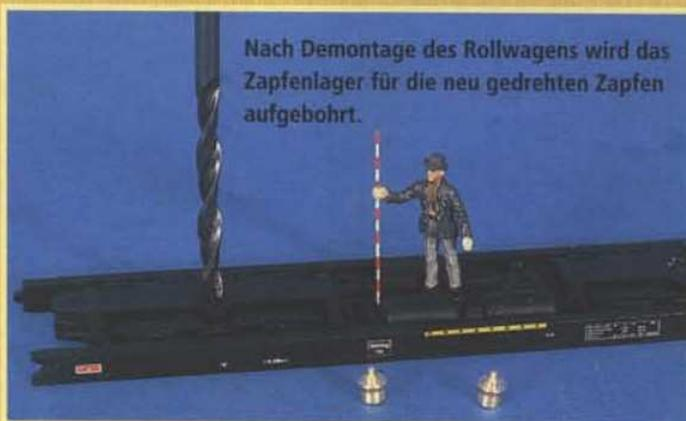
Nach Demontage des Rollwagens wird das Zapfenlager für die neu gedrehten Zapfen aufgebohrt.
