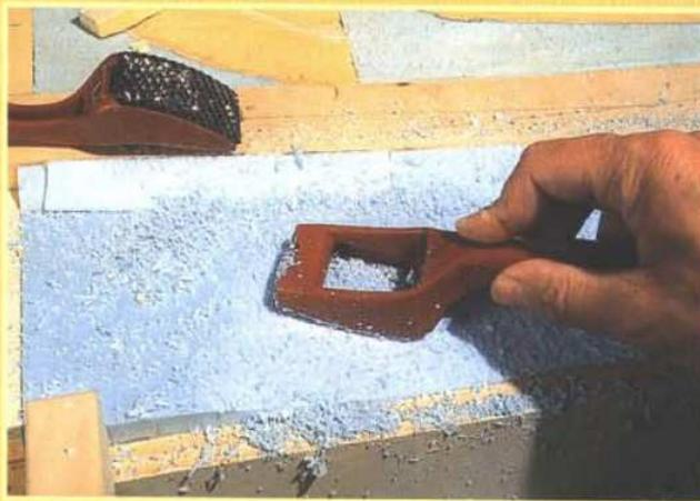
Das Herausarbeiten der Geländeoberfläche erfolgt mit diesem praktischen Raspelhobel, dessen Klinsen auswechselbar sind.
