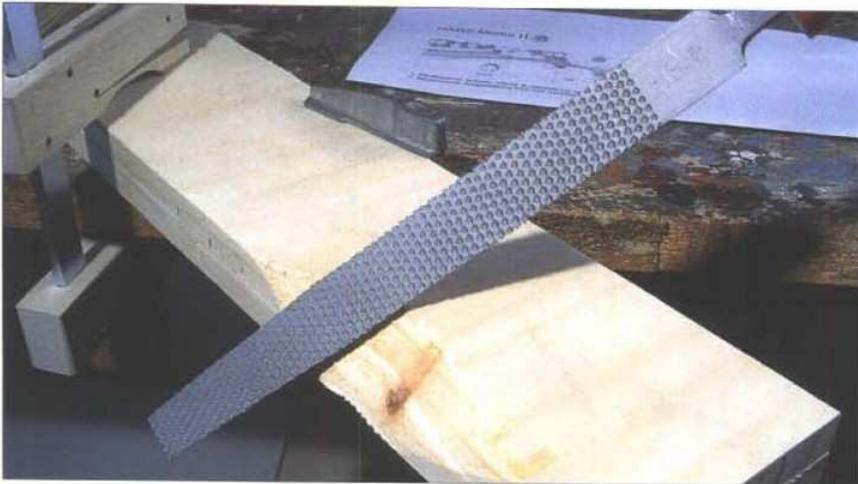
Ein sehr flexibles Werkzeug ist die Raspel. Mit ihr lässt sich Holz frei bearbeiten um beispielsweise Vertiefungen oder Rundungen einzuarbeiten.
