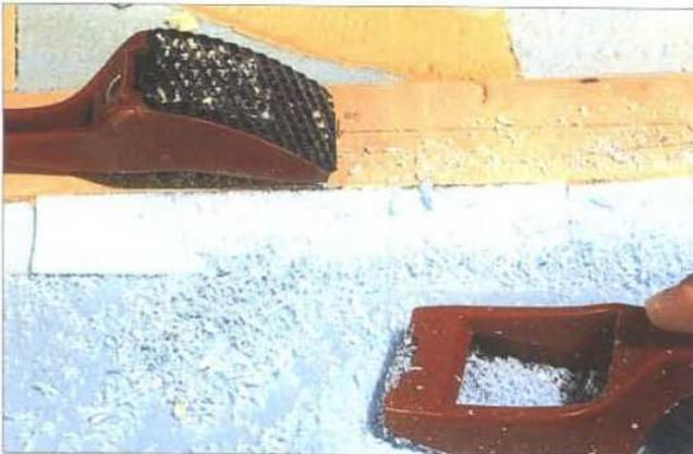
Eine andere Ausführung von Raspel eignet sich hervorragend für das flächenhafte Bearbeiten von Styrodurflächen, beispielsweise im Landschaftsbau.
