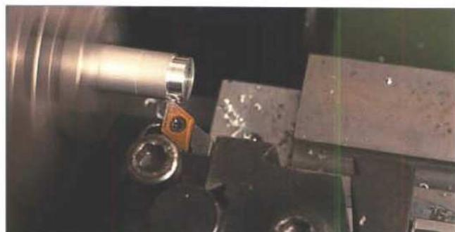
Die Welle wird im Radius um 0,5 mm abgedreht (längsgedreht), der Durchmesser also 1 mm kleiner.
