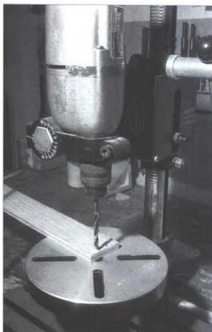
An den so markierten Stellen werden die Löcher mithilfe eines Bohrständers senkrecht gebohrt. Wichtig hierbei ist das Einstellen des Tiefenanschlages.
