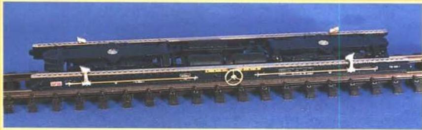
Die mittig sitzenden Drahthalter werden mit den Drähten verlötet und die überstehenden Drähte hinten abgekniffen. Mit montiertem Handrad und aufgelegten Keilen präsentiert sich ein schon deutlich gewandelter Rollwagen.
