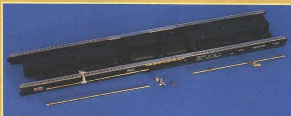
Nachdem seitlich die Bohrschablone angelegt und die Löcher für die Drathalter gebohrt wurden, werden die Vorlegekeile auf die Drähte gefädelt und die Drathalter in die Löcher
