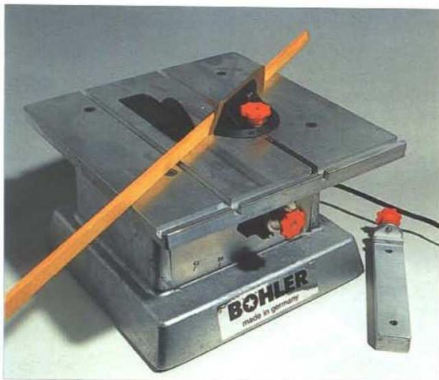
Bei der Tischkreissäge von Böhler lässt sich das Sägeblatt nicht nur in der Höhe verstellen, sondern auch seitlich neigen. Ein Anschluss für eine Schleifscheibe ist an der rechten Seite vorhanden, was die Maschine vielseitig verwendbar macht.
