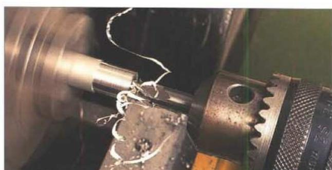
Eingesetzt werden ganz normale Spiralbohrer. Für Sacklöcher mit ebenem Grund können auch Fräser verwendet werden. Das Bohren erfolgt mit ganz wenig Vorschub.
