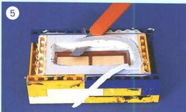
⑤ Mit dem Bastelmesser werden nun die Formschrägen hergestellt, das Urmodell verbleibt dabei in der Form. Überschüssiges Silikon wird vom Urmodell entfernt.
