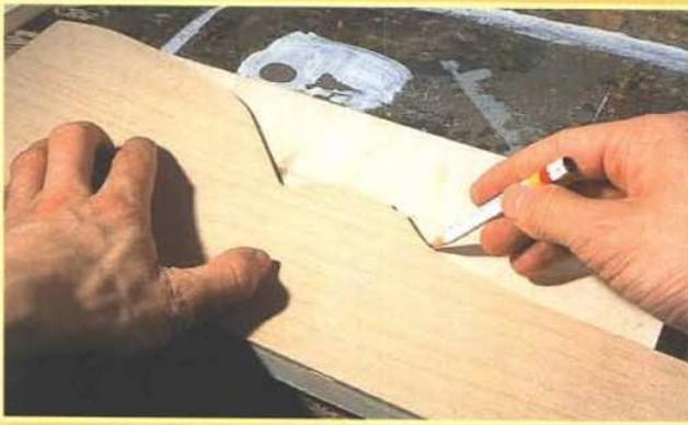
Übertragen des Profils von der Profillehre auf das Kopfprofilbrett mit dem Bleistift. Für einige Normen gibt es auch vorgefertigte Kopfprofile.
