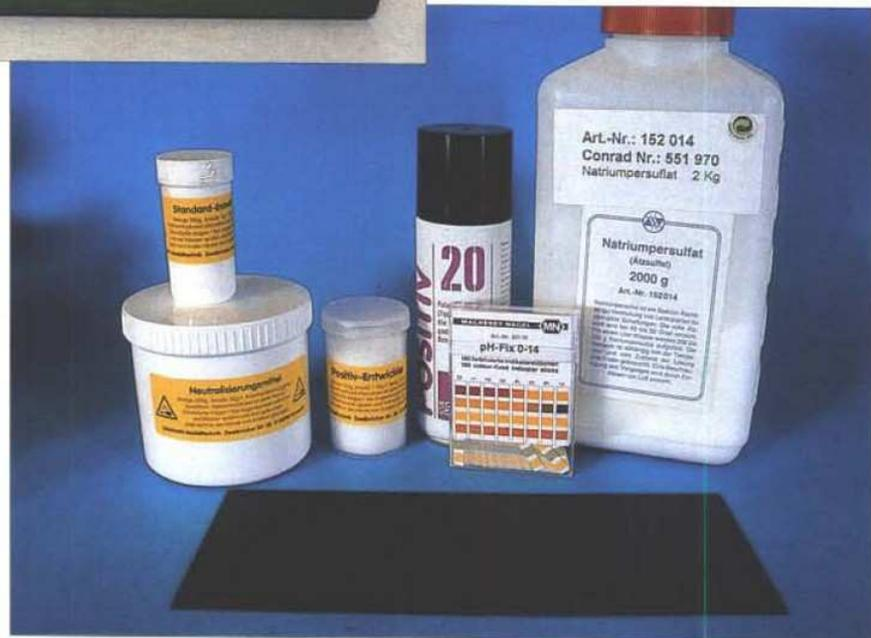
Oberfläche entfernt. Weil die Unterseite schneller ätzt als die Oberseite, müssen beidseitig belichtete Bleche ständig gewendet werden. Nach einigen Minuten sollten deutliche Anätzungen zu sehen sein. Die gesamte Ätzzeit hängt von der Blechdicke, der Konzentration des Ätzbades, der Temperatur und dem Zustand des Bades ab. Sie kann sich bis zu einer halben Stunde hinziehen.
