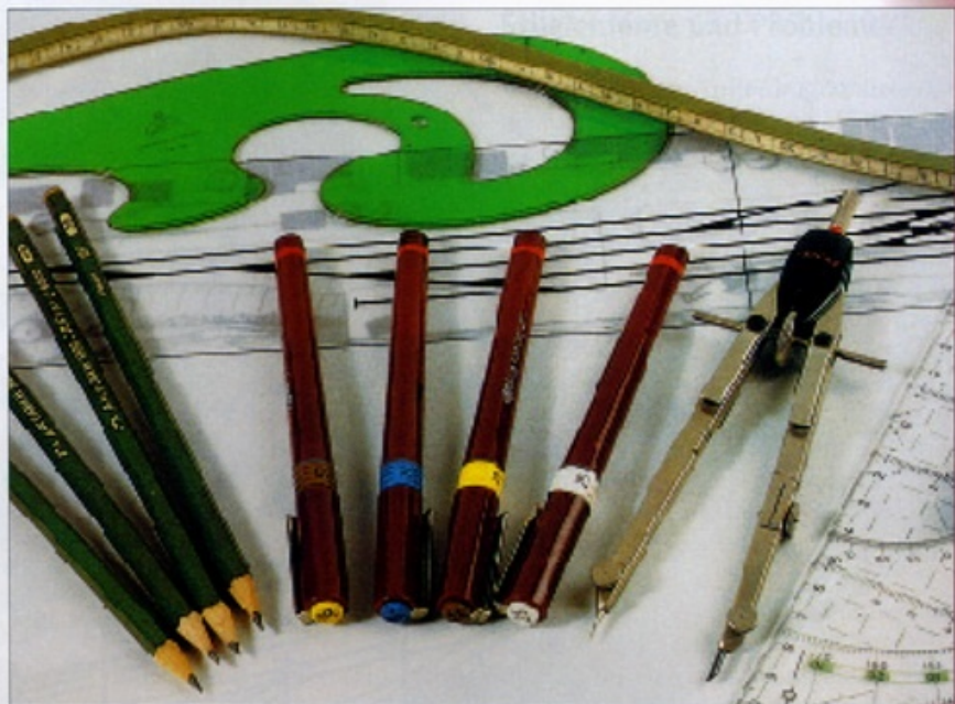
Die wichtigsten Utensilien für Gleisplanzeichner: Bleistifte in verschiedenen Stärken, Tusche-füller in diversen Stärken, ein Zirkel, Geodreieck, Kurvenlineal, ein biegsames Lineal. Soll die Zeichnung am Ende noch farbig ausgelegt werden, dann kommen noch die entsprechenden Farbstifte hinzu. Fotos: Lutz Kuhl
