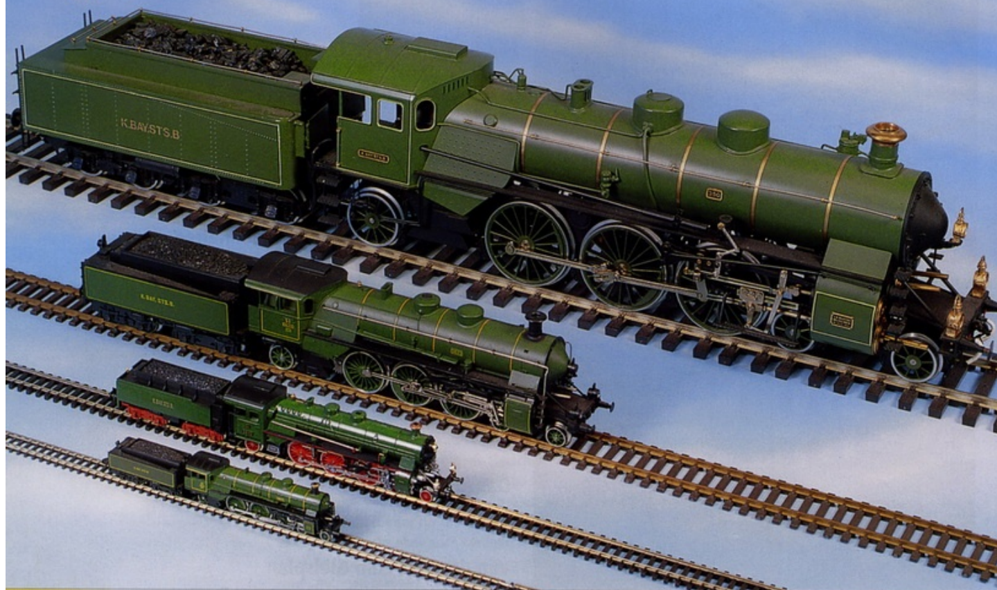
Ein Dampfloktyp in vier verschiedenen Modellmaßstäben und somit vier verschiedenen Abmessungen: die bayerische S 3/6 in den Baugrößen Z, N, H0 und O (von unten nach oben), also zwischen 220facher und 45facher Verkleinerung. Foto: MIBA-Verlag
