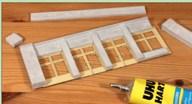
Die Kartonbauteile wurden vor der Montage mit Plakafarben lackiert. Die Montage erfolgte mit Alleskleber, der so dosiert aufgetragen wurde, dass er nicht an den Rändern herausquillt.
