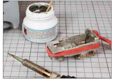
Die Bauteile der Dampflok sind vor dem Löten mit einem Gummiband fixiert.
