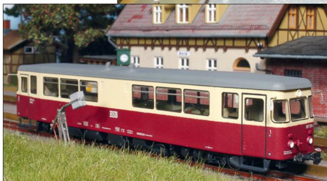
Die brünierten Fensterrahmen wirken ohne Grundierung und Farbschicht filigran und konnten von innen direkt eingeklebt werden, da keine Farbschicht die Oberfläche verdeckte.
