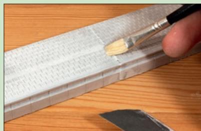
Nach dem Schleifen entfernt man Schleifstaub aus den Ritzen der Steinimitate.
