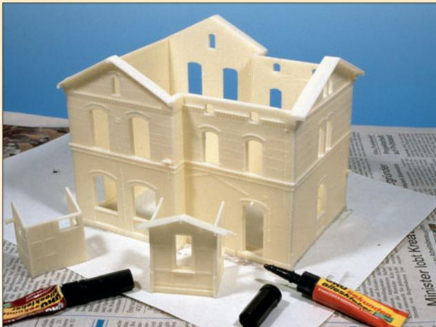
Mit dünnflüssigem Sekundenkleber können die Bauteile verklebt werden. Hierbei sollte nicht zu viel Klebstoff verwendet werden, um ein seitliches Ausquellen zu vermeiden.
