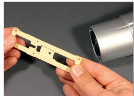
Die erwärmten Bauteile werden mit leichtem Druck mehrmals leicht gerichtet.
