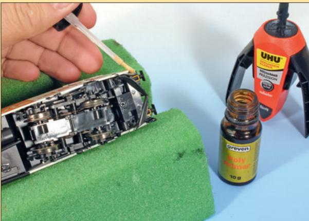
Sekundenkleber kleben weder Polyethylen (PE) noch Polypropylen (PP). In diesem Fall müssen spezielle Aktivatoren eingesetzt werden; sie beeinflussen den Kleber und die Klebeflächen, sodass Verklebungen mit Sekundenkleber möglich werden.
