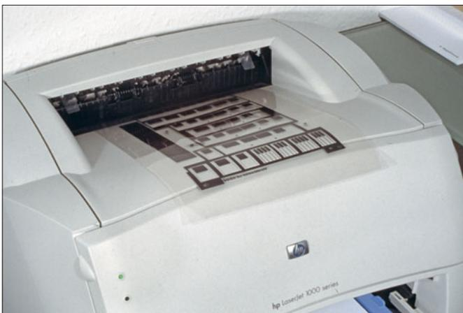
Für die Belichtungsvorlagen erhält man spezielle Folien, die man auch zu Hause mit einem Laserdrucker bedrucken kann.
