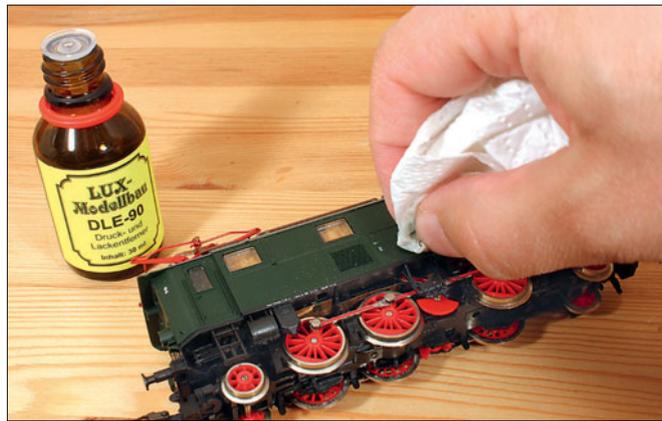
Mit schwachen Lösungsmitteln können Beschriftungen entfernt werden. Beim Beseitigen von Beschriftungen wird aber zwangsläufig auch die Farbschicht darunter angelöst, sodass mit entsprechender Vorsicht hantiert werden sollte. Ein Tuch eignet sich zum Wischen.
