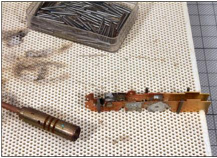
Das Fahrwerk dieser Dampflok wird winklig ausgerichtet und mit einem Brenner verlötet.
