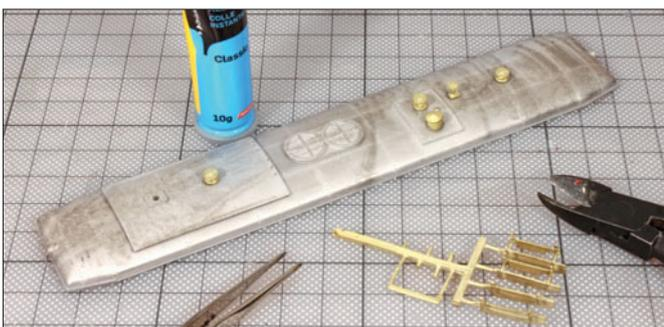
Kleine Bauteile, die nur eingesetzt werden und nicht viel halten müssen, verklebt man mit einem kleinen Tropfen Sekundenkleber.
