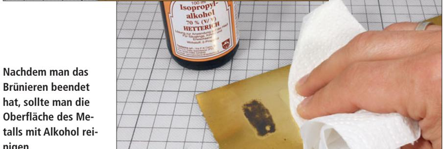
Nachdem man das Brüneren beendet hat, sollte man die Oberfläche des Metalls mit Alkohol reinigen.
