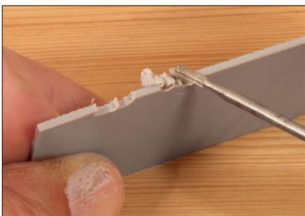
Durch die beim Fräsen entstehende Wärme schmilzt Kunststoff oft sehr schnell und verklebt dabei die Fräs- oder Bohrwerkzeuge.
