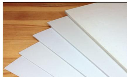
Platten aus Polystyrol mit einer glatten Oberfläche sind in vielen Stärken und Abmessungen als günstiges Baumaterial erhältlich. Streifen und Profile von Evergreen und Plastruct eignen sich hervorragend für die Detaillierung und sind leicht zu bearbeiten.
