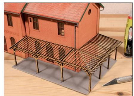
Filigrane Bahnteigdächer entstehen auch aus gelasertem Sperrholz, mit den typischen dunklen Schnittkanten des Lasers.
