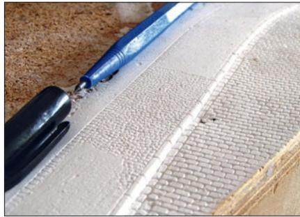
Mit einer Anreißnadel kann man Steinreihen und -fugen in den Gips ritzen (oben). Durch etwas Trockenfarbe, die in die Ritzen eingebracht wird, lässt sich die Wirkung provisorisch prüfen und bei Bedarf nacharbeiten.
