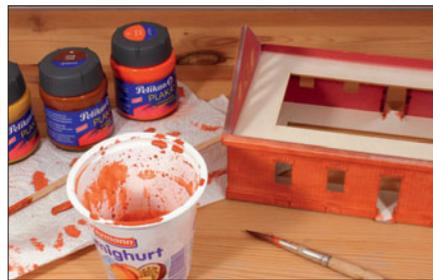
Vor einem kompletten Anstrich der Kartonplatten sollten die Oberflächen mit lösemittelhaltiger Farbe grundiert werden; dies festigt die Fasern des Papiers (links oben).
