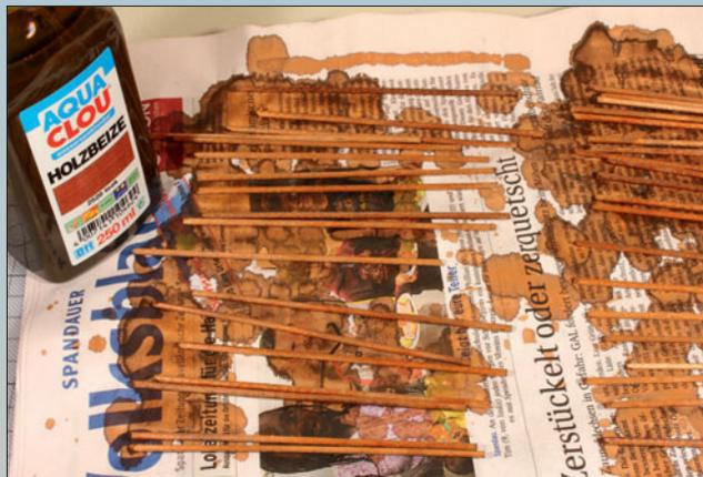
Mit Holzbeize erhalten die hellen Schaschlikspieße eine dunkle Färbung, die der Holzprägung beim Vorbild entspricht. Eine dunklere Färbung wird erzielt, indem die Beize mehrmals aufgetragen wird. Dies sollte gleichmäßig von allen Seiten erfolgen.
