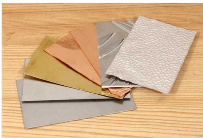
Bleche erhält man im Modellbausektor in den unterschiedlichen Metallarten und in unterschiedlichen Materialstärken. Auch sind Bleche erhältlich, deren Oberfläche durch nachträgliche Bearbeitung (Walzen, Prägen, Ätzen) strukturiert wurde.
