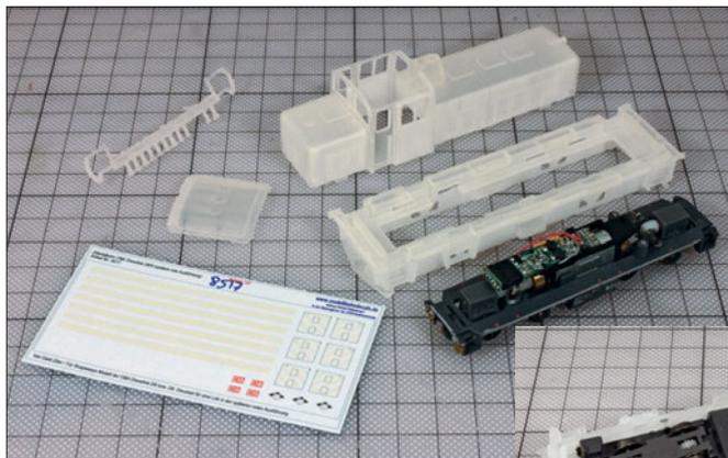
3D-Modelle jüngerer Datums bestehen bereits aus mehreren Bauteilen und werden auf konkrete Fahrwerke konstruiert. Hier eine H0e-Lok, die ein Piko-Fahrwerk benötigt.
