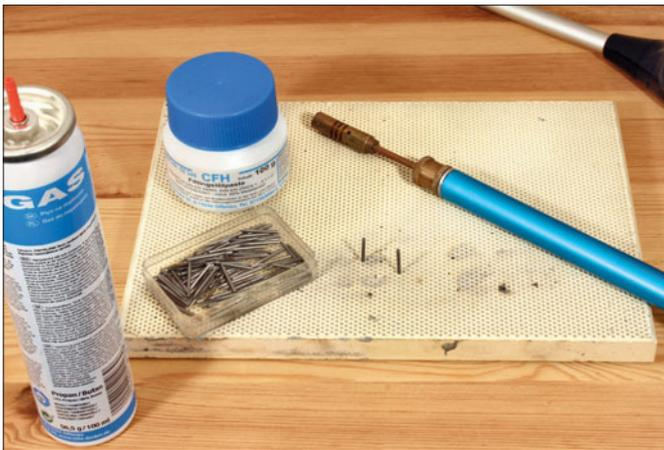
Bauteile aus Buntmetall können verlötet werden. Hierzu eignen sich kleine Gasbrenner. Auf einer Lötunterlage aus Keramik kann man sicher löteten. Lochplatten eignen sich zum Fixieren von Bauteilen durch Stahlstifte. Lötpasten aus Zinn und Flussmittel sind ideal zum Löteten mit Flamme.
