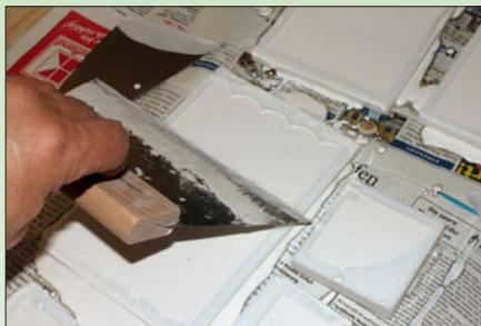
Kurz nach dem Bestreichen der Formen mit einem Pinsel wird die Gießmasse zügig, doch vorsichtig eingefüllt, damit wenig Blasen entstehen. Um für alle Abgüsse die gleiche Höhe zu erhalten, werden die Formen mit einem breiten Spachtel bestrichen und überstehendes Material entfernt. Dies sollte auf einer Unterlage erfolgen.
