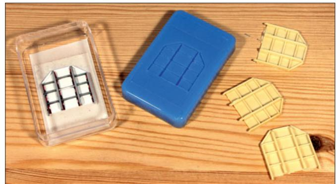
Gießkasten mit dem Urmodell, Kautschukform und abgegossene Bauteile im Überblick
