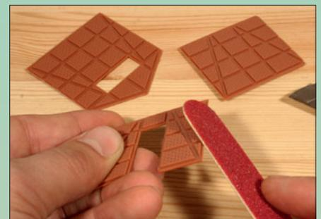
Für eine passgenaue Montage müssen die Klebeflächen gegebenenfalls von Graten und überschüssigem Material befreit werden.
