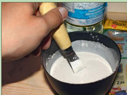
... und anschließend gut verrührt, bis eine leicht fließfähige Masse entsteht.
