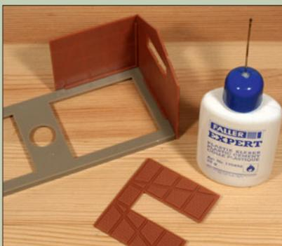
Für das Verkleben der Wände im rechten Winkel sollten die beiliegenden Grundplatten verwendet werden. Beim Zusammenfügen ist außen am Modell hervorquellender Kleber zu vermeiden.
