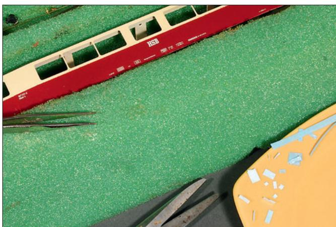
Filigrane Beschriftungen mit kaum sichtbarer Trägerfolie erhält man durch Nassschiebebilder. Diese werden ausgeschnitten und auf die Modelloberflächen gesetzt. Weichmacher macht danach die Folie geschmeidig, sodass sie mit Wattestäbchen festgedrückt werden kann.
