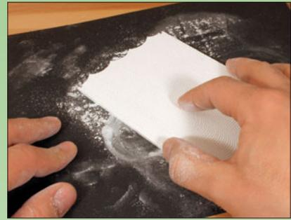
In der Höhe können die kompletten Bauteile auf Schleifpapier in kreisenden Bewegungen heruntergeschliffen werden.
