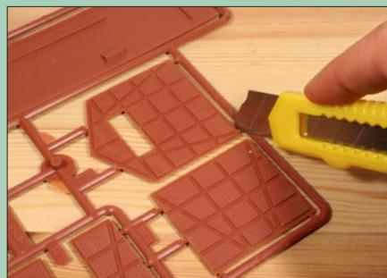
Die Bauteile sollte man mit einem scharfen Messer vom Spritzling schneiden, damit die Oberflächen nicht beschädigt werden.
