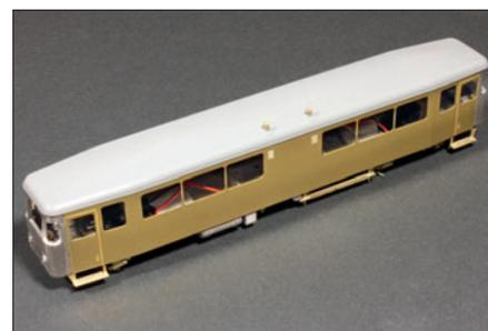
Bei den Bausätzen werden Weißmetallbauteile mit geätzten oder gegossenen Messingteilen kombiniert. Das Dach ist in diesem Beispiel ein Kunststoffspritzteil.
