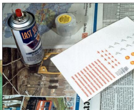
Die selbst erstellten Beschriftungen werden ausgeschnitten und auf die Oberfläche des Modells aufgebracht.
