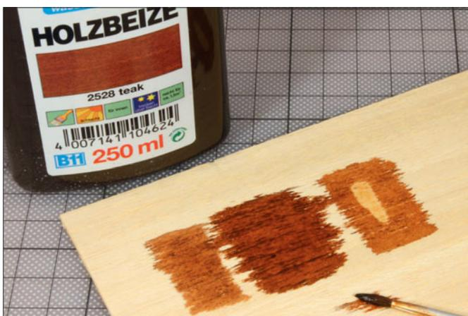
Helles Holz kann mit Beize eingefärbt werden; auf diese Weise können auch andere Holzarten imitiert werden. Die Maserung bleibt bei Holzbeize deutlich sichtbar.
