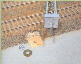
Die Sommerfeldt-Turmmasten werden auf sehr solide Weise mit Muttern und Unterlegscheibe (unterhalb der Trassenplatte!) gesichert.
