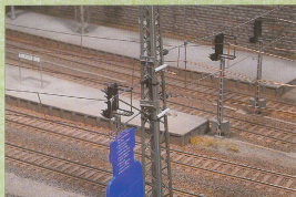
Einige Turmmasten mussten allseitig mit derartigen Profilen bewehrt werden. Der im Foto sichtbare Mast sollte aufgrund der Segmenttrennung einen herausnehmbaren Fahrdrabt, ein Querfeld sowie einen Seitenhalter aufnehmen.
