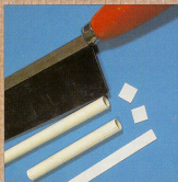
Die Anfertigung der Säulen war etwas mühselig und nicht ganz ungefährlich für die Finger; mit einer Leistensäge wurden die Fugen längsseitig eingeritzt.
