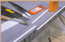
Seitlich fanden noch Versorgungsrohre der Elberfelder Stadtwerke ihren Platz. Ist alles gut abgedeckt, kann der Airbrush-Auftrag erfolgen.
