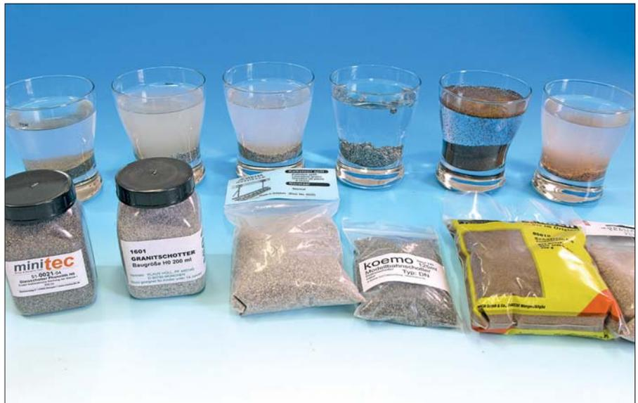
Der „Wassertest“ (Aufnahme unmittelbar nach dem Hineingeben des Schotters) offenbart die Schwächen: Trübung = zu hohe Staubanteile; was oben schwimmt, ist kaum echtes Material und schwimmt auch beim Schottern auf. Sieger meines Tests: Koemo und Minitec.
