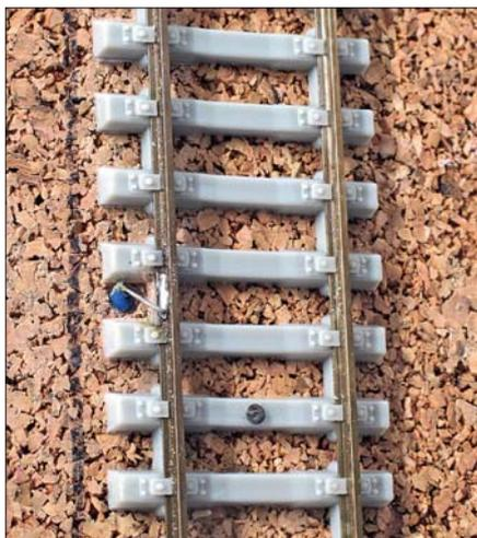
Auch die Art des Flexgleises beeinflusst die Verlegung: Das Peco-Gleis (links unten, rechts oben) verharnt dank seiner starren Brücken eher in seiner Lage, während das Schwellenband des Tillig-Gleises im schlimmsten Fall zu Y-Schwellen mutiert ...
