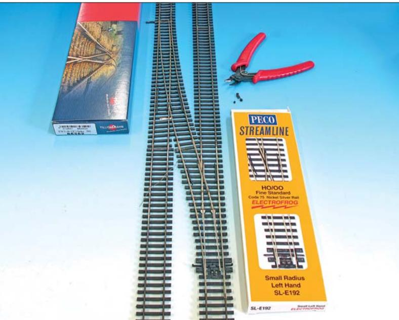
Die EW3 von Tillig (9° Herzstückwinkel, 12° Weichenwinkel) kombiniert mit einer „kleinen“ Weiche von Peco (SL-E 192, 12°, 610 mm (!) Radius) ergab einen schlüssigen Übergang, letztlich wegen des gleichen Winkels, wenn auch die Abzweigradien unterschiedlich waren.
