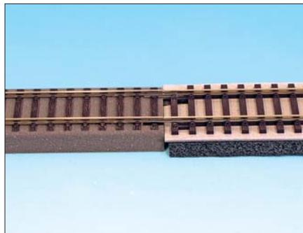
Beim Übergang von Bettungsgleis auf solches ohne Schotterbettung muss mit Unterlagen passender Dicke für einen Ausgleich gesorgt werden.
