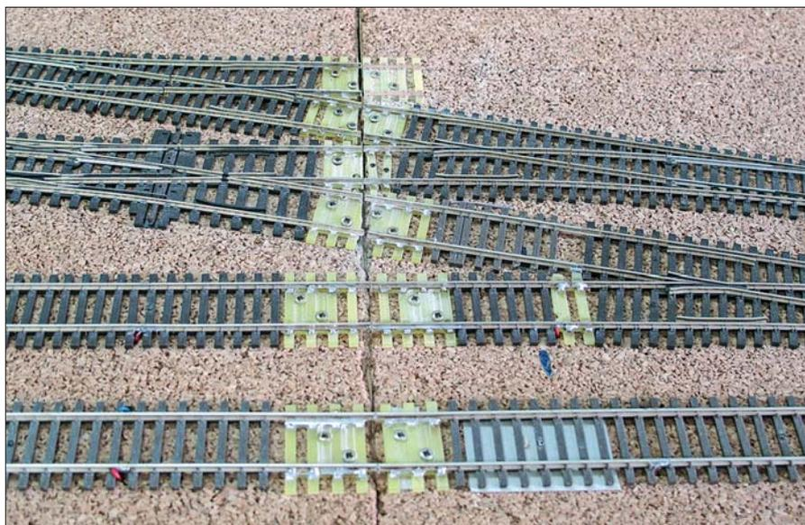
Auch ohne durchgehendes Gleis lassen sich mit den Pertinaxplättchen die gegenüberliegenden Gleise exakt ausrichten, da man durch das Löten einen genauen Übergang erreichen kann. Auch mit den Schrauben kann noch nachjustiert werden (Höhe). Dellen im Kork kann man planschleifen (sofern sie nach oben ragen) oder mit Pappstreifen unterfüttern (wenn sie nach unten hängen).
