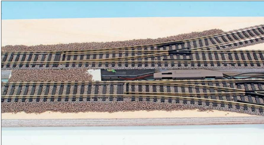
Das nicht anvisierte Gleis bleibt stromlos. Eine dort abgestellte Lokomotive kann daher im Analogbetrieb bei entsprechender Weichenstellung ohne zusätzliche Verkabelung und Schalter stromlos abgestellt werden.
