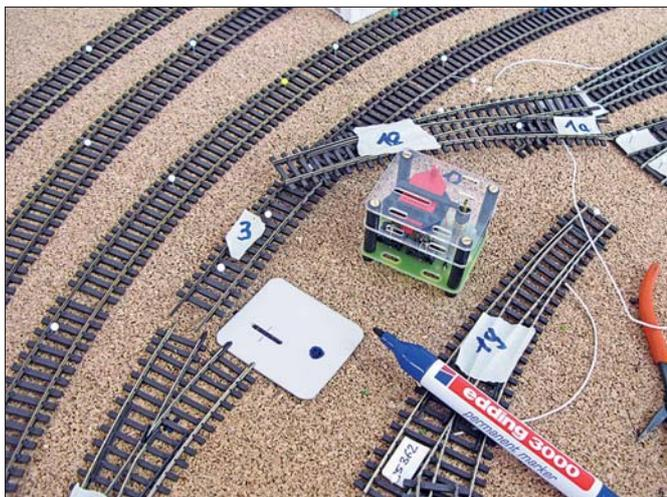
Bei Einbau mancher Weichenantriebe kann die Verwendung einer entsprechenden Bohrschablone angebracht sein. Hier muss ein zusätzliches Loch für die drehbare Weichenlaterne gebohrt werden.
