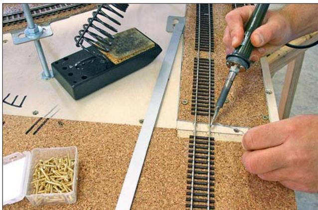
Die einfachere und sicherere Methode, seine Schienenprofile an Segment- oder Modulübergängen zu fixieren, ist das Auflöten auf Messingschrauben. Die Höhenjustierung erfolgt dann aber nur über den Grad des Eindrehens der Schraube und ggf. über die Menge des Lötzinnes, die zur Lückenüberbrückung notwendig ist.
