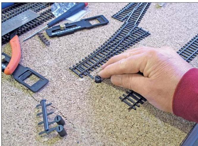
Bei den Hoffmann-Weichenantrieben liegen Hülsen mit einem Langloch bei, die man in das Bohrloch der Stellschwelle einsetzen kann. Das Langloch lässt einen ausreichenden Stellweg des Stelldrahtes zu, im Übrigen wird das ansonsten recht große Loch verschlossen.
