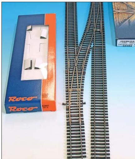
Die Kombination einer Tillig-EW3 (# 85353, Länge 284 mm) mit einer Roco-Weiche (# 42441, Länge 230 mm, Abzweigradius 873,5 mm, Abzweigwinkel 15°) ergab wegen der unterschiedlichen Weichenwinkel keine parallele Gleisführung. Abhilfe: bei gleich bleibendem Herzstückwinkel müsste entweder der Weichenwinkel der Roco-Weiche durch Einkürzen des Schwellenbandes verringert oder ...
