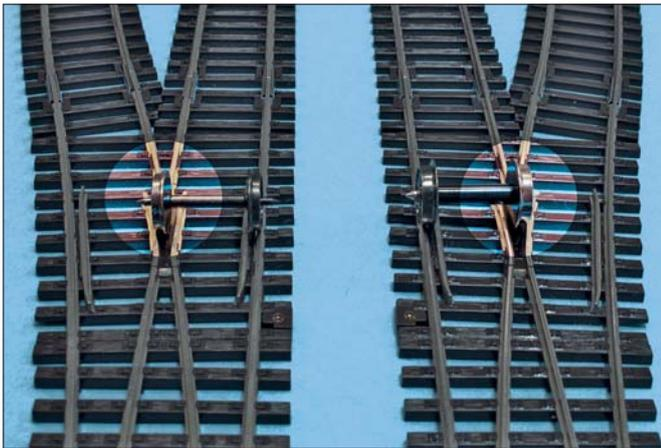
Der RP-25-Radsatz mit seinen niedrigen Spurkränzen fällt in die Herzstücklücke (links), während der Roco-Radsatz mit seinem höheren Spurkranz diese ohne Rumpeln durchfährt (rechts), weil er beim Darüberrollen auf dem erhöhten Innenteil aufläuft.
