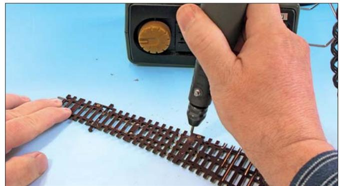
Für den sicheren Digitalbetrieb ist es wichtig, dass an den Zungen- und Backenschienen immer die gleiche Polarität besteht. Bei manchen Weichen muss man dies durch Trennen von Kontaktbrücken und Einlöten neuer Drähte beheben.
