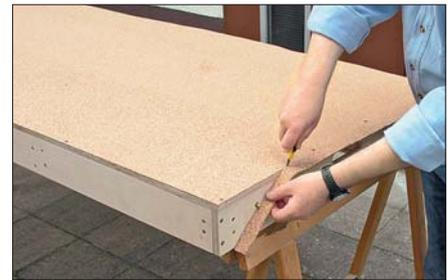
Beide Klebstoffe verreibt man auf dem Korkstreifen, um ein Herausquellen zu verhindern. Bis zum Abbinden des Weißleims muss der erste Teil des Bettungstreifens in seiner Lage festgehalten und leicht beschwert werden. Nach einer halben Stunde kann der Gegenstreifen nach der gleichen Methode befestigt werden. Er muss gut an dem Erstband anliegen. Ein abschließendes leichtes Abschleifen der Oberfläche mit Schmirgelleinen kann auf keinen Fall schaden.
