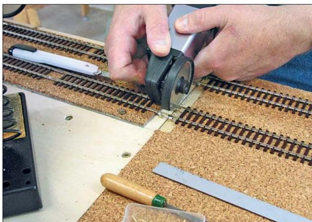
Gerade auch im Kurvenbereich ist diese Art der Übergänge sehr zu empfehlen. Hier wurde schon mit den kupferkaschierten Pertinaxstücken gearbeitet. Rechts im Bild auch noch zu sehen, wie die Parallelgleisausrichtung der einzelnen Gleise vorgenommen wurde (einstellbare Lehre von Rivarossi).
