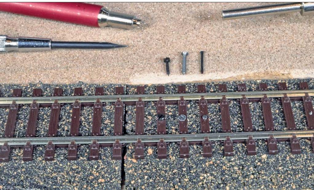
Man kann das Gleis sowohl nageln als auch schrauben. Letztere Methode eignet sich besonders an Stellen, wo die Höhenlage exakt justiert werden muss oder ein besonders guter Halt erforderlich ist (Gleis- oder Anlagenende, Übergänge). Schrauben ist etwas aufwendiger und teurer und auch mehr zu sehen, als ein kleiner Schienen Nagel.
