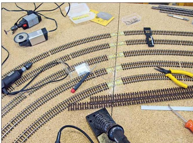
Alle Übergänge sind verlötet, die Flucht (vor allem auch der Höhe nach) und die inneren Gleisabstände mit der Lehre überprüft, sodass es nun ans Trennen gehen kann. Im Überblick ist der durch Einfügen eines Pappstreifens vergrößerte Holzabstand gut zu erkennen.
