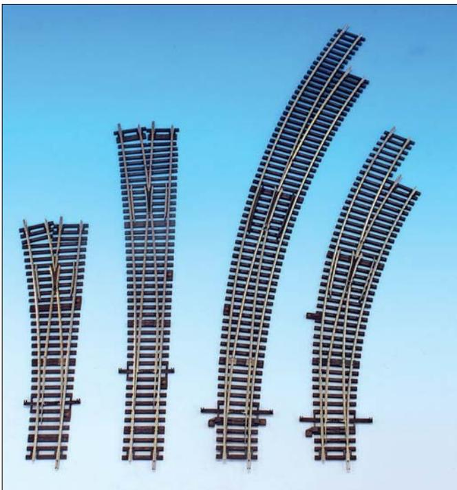
Die großzügigen Weichen des RocoLine-Gleises lassen schlanke Weichenverbindungen zu. Neben einer „normalen“ 15°-Weiche hebt sich die 10°-Weiche (mit einer Länge von 34,5 cm) hervor. Die Bogenweichen gibt es als R2/R3-Ausführungen (nicht abgebildet) und als R5/R6 schon für die größeren Radien (rechts). Für großzügige Bahnhofseinfahrten im Bogen eignen sich die großen Bogenweichen R9/R10 mit einem Radius des Stamm- und des Abzweiggleises von 826,4 cm.
