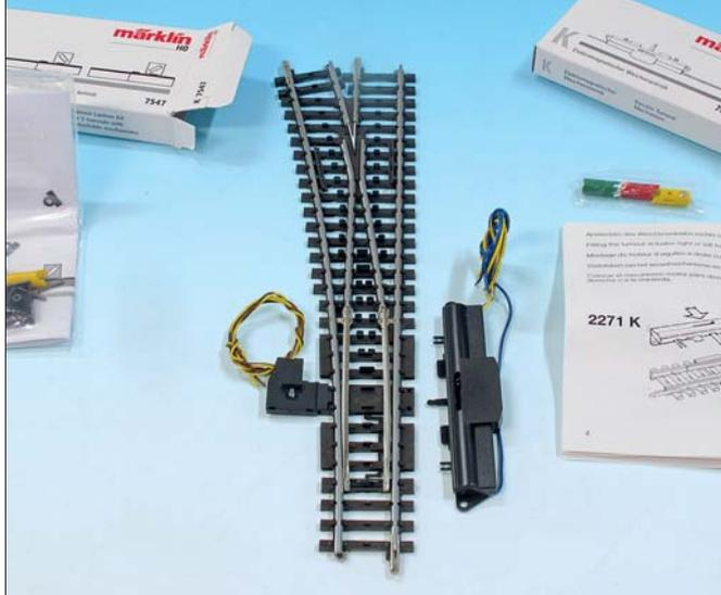
**Weichenantriebe beim K-Gleis: Der Handantrieb mit dem umlegbaren Kippschalter kann abgezogen und ein Elektroantrieb angesteckt werden. Auf der gegenüberliegenden Seite hat noch eine drehbare Weichenlaterne Platz.**
