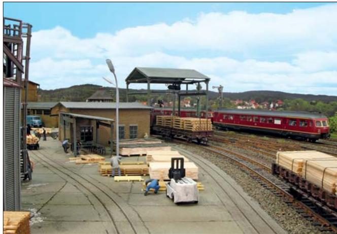
Schwellen aus Holz mussten haltbar gemacht werden. Zunächst wurden sie gehobelt und gebohrt, dann imprägniert und mit den Rippenplatten versehen (Modell des Imprägnierwerkes der Rütgers AG auf der H0-Anlage der HEB-Hobbyeisenbahner).
