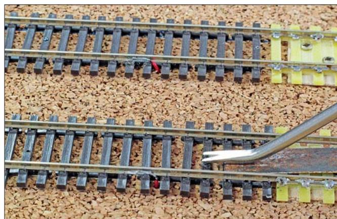
Gerät ein Nagel beim Einschlagen allzu krumm oder muss wegen Korrektur des Gleises wieder herausgezogen werden, gelingt dies mit einem Nagelheber von Post-Werkzeuge und einer Druckunterlage (Spatel) problemlos.
