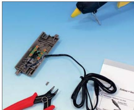
Die Stromeinspeisung kann in jedes beliebige Gleisstück eingesetzt und festgeschraubt werden. Die Fixierung sollte zusätzlich mit Heißkleber erfolgen.
