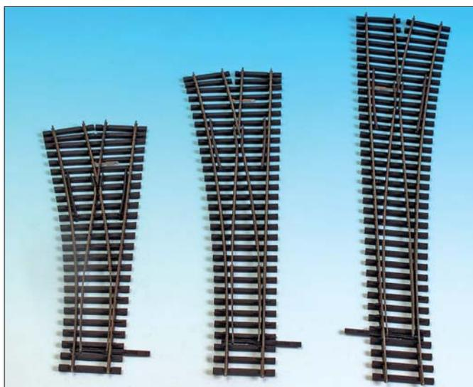
Das unter den Weichen befindliche Flexstegband ermöglicht es, die Weiche in bestimmten Grenzen zu biegen. So kann aus einer geraden Weiche eine ganz leichte Bogenweiche werden, ideal für nicht ganz konforme Weichenstraßen. Unten eine EW3 älterer Bauart.
