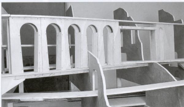
Eine zweite Standprobe der fertigen Gerüstteile. Nur wenig „Nachschliff“ ist erforderlich, damit der Spant durch den mittleren Pfeiler passt.
