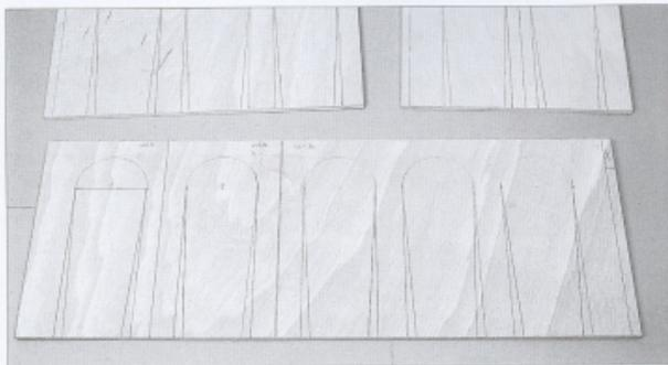
Die ermittelte Anordnung wird auf das Sperrholz übertragen. Man erkennt die Schrägen der Pfeiler, die als Anläufe bezeichnet werden.
