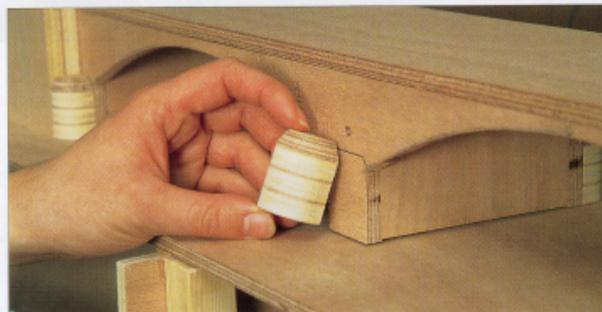
Aus geschliffenen Holzstücken entstehen die Pfeilervorbauten. An einem Tellerschleifergerät (Proxxon) können sie problemlos hergestellt werden. Ganz links kann man einen Teil des Pfeilervorbaus und die Verbreiterung des Widerlagers durch zwei Holzplatten erkennen.
