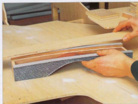
Nach der kompletten Styrodur-Montage einschließlich Farbgebung erhält die Brücke zusätzlich Gehege in Form von dünnen Leisten, die um eine Millimeter auskragen.
