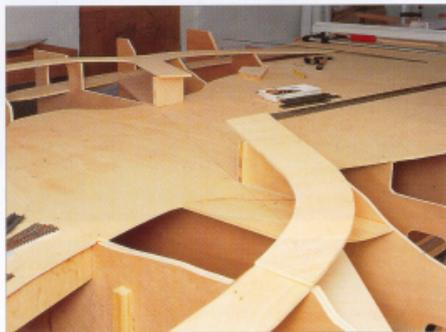
Diese Brücke soll das Bahnhofsvorfeld überqueren. Die Zufahrtsrampen werden provisorisch ausgelegt. Die vorn erkennbare Tischlerleiste dient der Stabilität.
