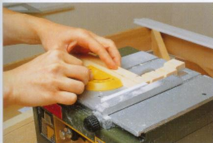
An der Tischkreissäge werden trapezförmig vorgearbeitete Holzleisten in kleine Stücke gesägt und ...
