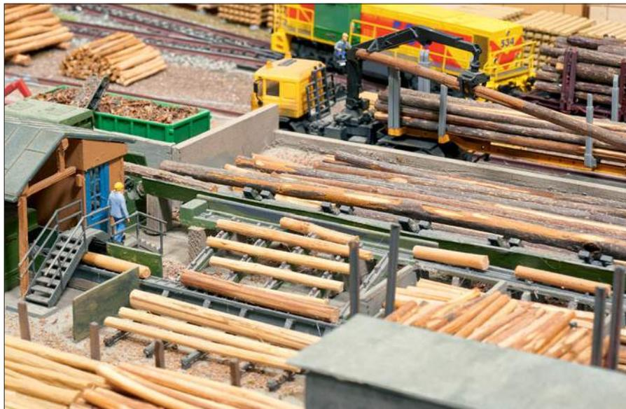
Die entrindeten und auf Länge gesägten Stücke werden automatisch sortiert und dem weiteren Arbeitsprozess zugeführt.
