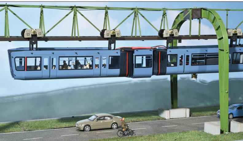
Der Wagenkasten des Triebwagens besteht aus geätztem Neusilberblech, das bei der Bausatz-Variante bereits lackiert und entsprechend vorgebogen ist. Zur Montage müssen die Bauteile nur zusammengesteckt werden.
