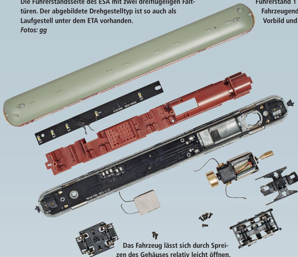
Das Fahrzeug lässt sich durch Spreizen des Gehäuses relativ leicht öffnen.
