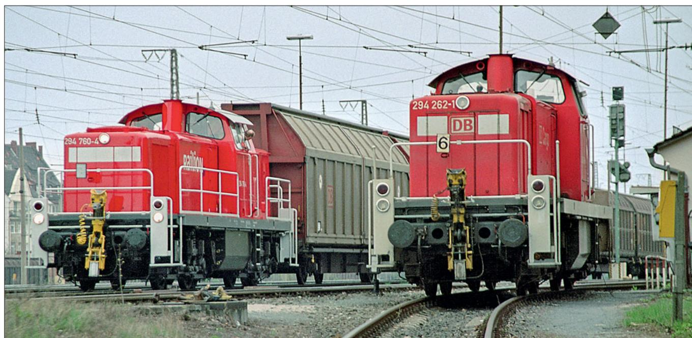
Zwei Maschinen aus der letzten Lieferserie in vorletzter und letzter Modernisierungsstufe. Während die 294 760 bereits einen modernen MTU-Motor und Umlaufgitter erhalten hat, stand der 294 262 dieser Umbau Mitte 2005 noch bevor. Foto: *Gideon Grimmel*
