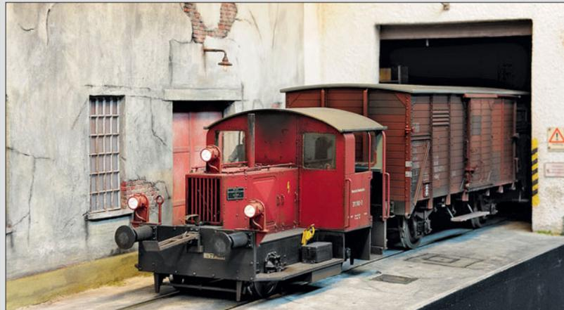
Die fernbedienbare Automatikkupplung an der Kö I erlaubt das Rangieren, ohne dass man händisch eingreifen muss.
