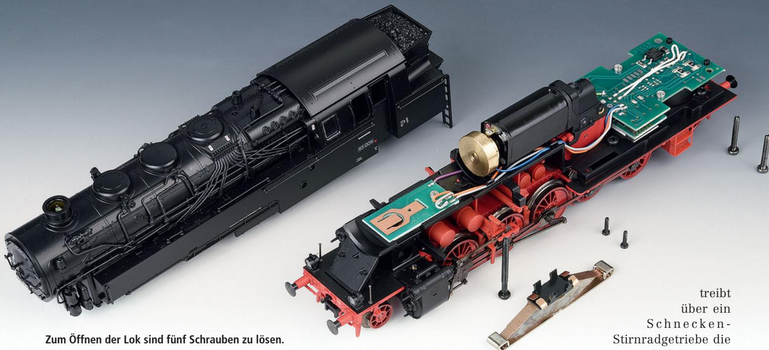
Zum Öffnen der Lok sind fünf Schrauben zu lösen.
