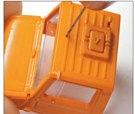
Für die Stirnlampe und den Warnbalken werden noch Löcher in das Dach gebohrt.
