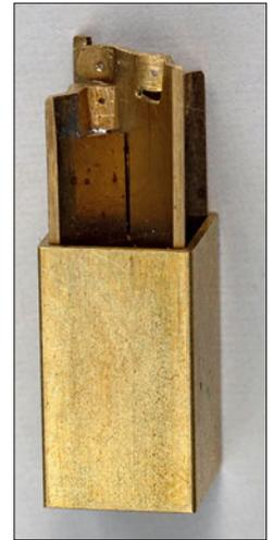
Die beiden Schieberbleche laufen in einem Vierkant-Hohlprofil. In die um 45° ausgestellten Nasen werden die Stelldrähte eingesetzt. Rechts die Bauteile im zusammengesetzten Zustand.
