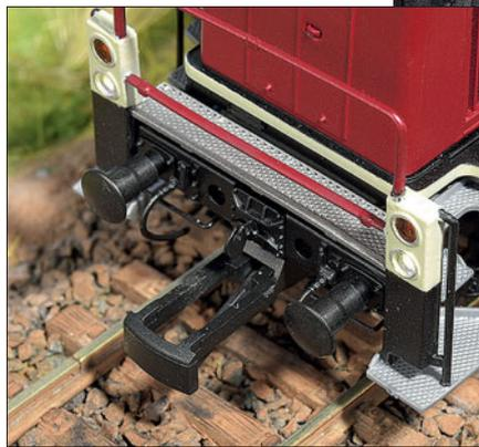
Links: Das Absenken des Kupplungshakens – im Vergleich zu voluminösen Hubmagneten die technisch und optisch wesentlich bessere Lösung – erfolgt lautlos über kleine Stellmo-toren. Allein schon deshalb macht das Ran-gieren mit der Lok besondere Freude! Unten: Das Lüfterrad wird über einen eigen-ten kleinen Motor in Rotation versetzt. Die-ser Effekt ist unter dem hochfein geätzten Abdeckgitter bestens zu erkennen.
