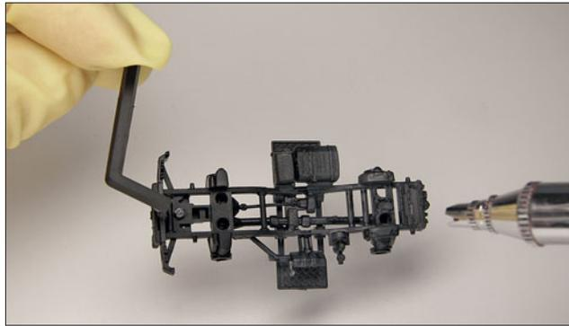
Das Fahrwerk des Unimog-Bausatzes wird in Dunkelgrau lackiert. Prinzipiell kann das mit einem Pinsel erfolgen, gleichmäßiger geht es jedoch mit der Airbrush-Pistole. Dabei wird die Farbe in mehreren dünnen Schichten aus verschiedenen Richtungen aufgetragen.
