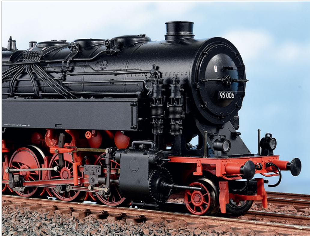
tioniert sind, wirken die Kreuzköpfe seltsam flach: Die Löcher auf Höhe der Gleitbahn sind nur angedeutet und das Schmiergefäß kaum erhaben.
