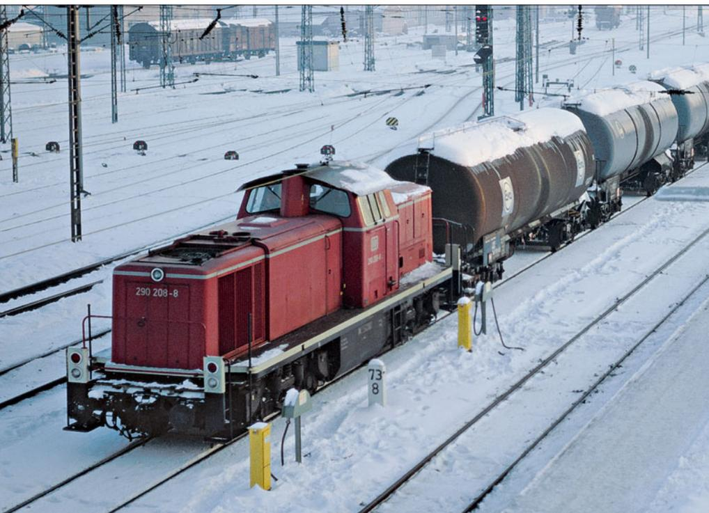
Praxis wegen der daraus resultierenden unterschiedlichen äußeren Erscheinungsbilder: Die Anlagen der Firma Behr aus Stuttgart verfügen über zwei hydrostatisch angetriebene Lüfterräder; sie wurden in die Loks 290 001 - 010, 013 - 048, 059 - 100 und 161 - 190 eingebaut. Eine Kühleranlage von Voith aus Heidenheim, mit einem über eine regelbare Flüssigkeitskupplung mechanisch angetriebenen Lüfterrad, wurde in 290 011 - 012, 049 - 058, 101 - 160, 191 - 214 und 217 - 307 eingebaut.
