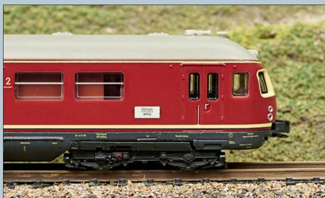
Die Führerstandsseite des ESA mit zwei dreiflügeligen Faltschleusen. Der abgebildete Drehgestelltyp ist so auch als Laufgestell unter dem ETA vorhanden.
