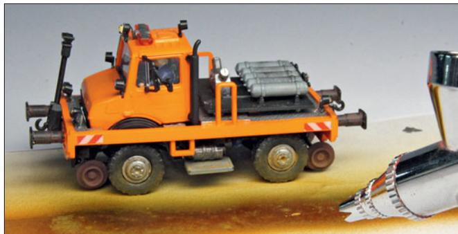
Das fast letzte Finish erfolgt mit der Spritzpistole. Dabei wird die Farbe nicht direkt, sondern durch die Unterlage abgelenkt in den Fahrwerksbereich gesprüht.
