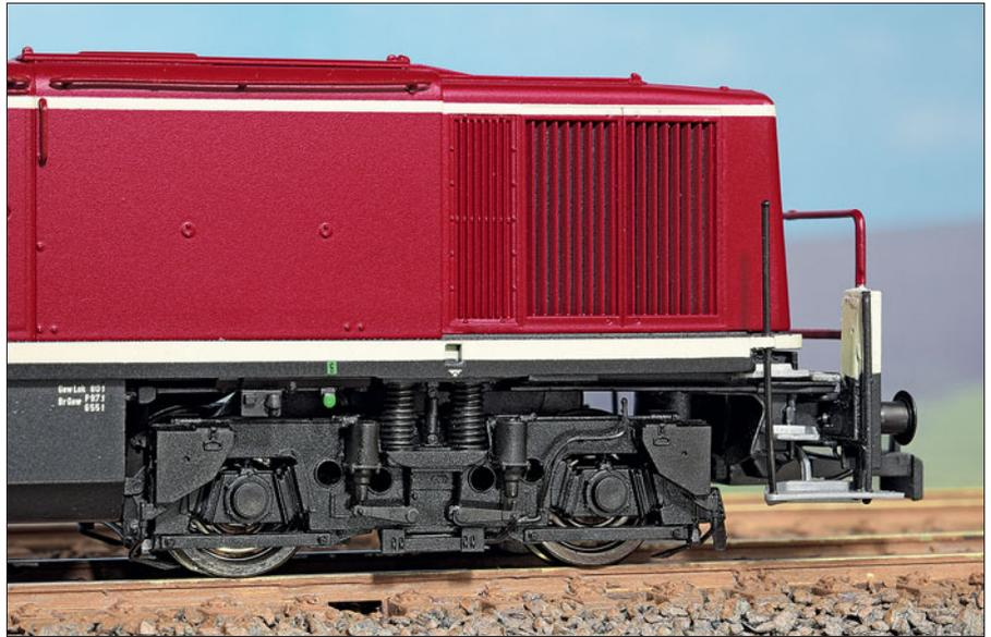
Die seitlichen Lüfter sind filigran durchbrochen und die Drehgestelle bieten von freistehenden Bremszylindern bis hin zu exakten Schraubenfedern und ange-setzten Geberleitungen alle Details.
