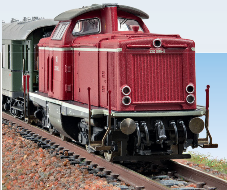
Die Drehgestellblende unter dem kurzen Vorbau zeigt sich ohne zusätzliche Ausrüstung; beachtenswert die Wartungskappen im Vorbau.
