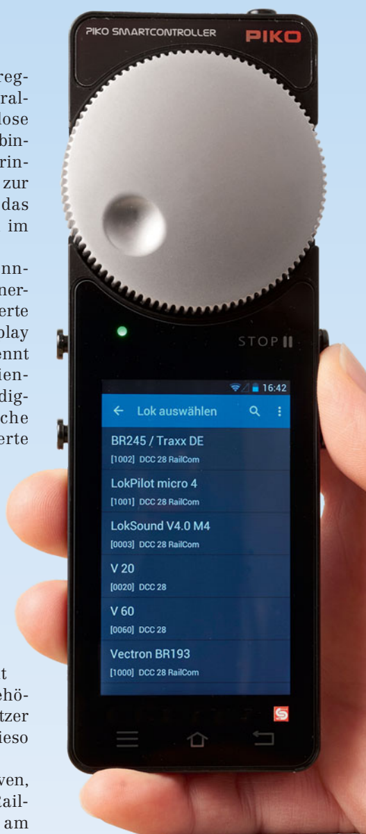
Loks mit RailComPlus-Decoder melden sich selbst an, andere sind manuell anzumelden.
