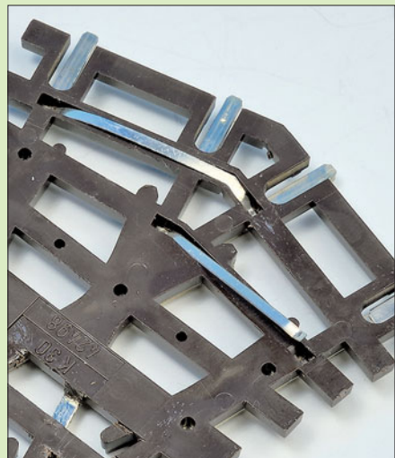
Ohne jegliche mechanische Beanspruchung hat sich eine Strombrücke gelöst.
