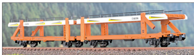
N: Der Autotransporter der Gattung Laaeks basiert auf einem Minitrix-Fahrwerk.
