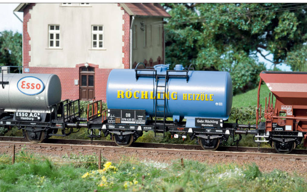
Eine der wenigen vorbildnahen Beschriftungsvarianten des Nachkriegs-Kesselwagens von Fleischmann ist der Wagen von Röchling. Das insbesondere in Anbetracht seines Alters sehr gut detaillierte Modell lässt sich durch den Ausbau der Kurzkupplungskinematik und Ergänzung der Bremsanlage optisch erheblich aufwerten. Die Bilder zeigen oben den fertigen Wagen, unten das modifizierte Untergestell.
