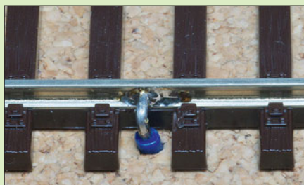
Muss man nachträglich ein Gleis mit einem Gleisanschluss versehen, kann man das wie im Bild am Beispiel des Roco-Code-83-Gleises gezeigt, ausführen. Das verzinnte Kabelende wird von unten durchgeführt, das Ende abgewinkelt und auf den vorverzinnten Schienenfuß gelötet.
