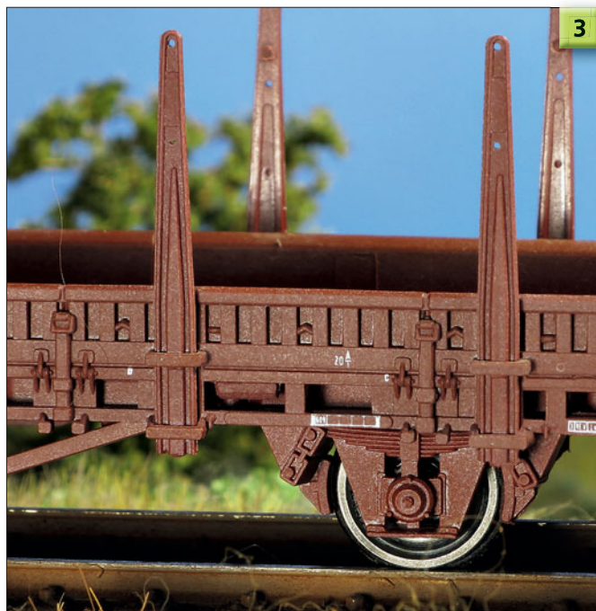
Bild 3: Das Foto zeigt bei gleicher Beleuchtung den Zustand nach dem Grundieren, dazu wurde mit zwei Teilen Wasser verdünnter Mattlack von Lascaux (Art.-Nr. 2061) mit der Airbrush aufgetragen. Über Nacht ruhte der Wagen zum Trocknen. Ergebnis: Der Glanz ist stark reduziert und die Optik hat dadurch enorm gewonnen. Was das Ziel „Mattierung“ betrifft, könnte man das ohne Weiteres so lassen und auf die folgenden Bearbeitungsschritte verzichten. Die Rungen im Hintergrund sind noch nicht komplett bearbeitet.
