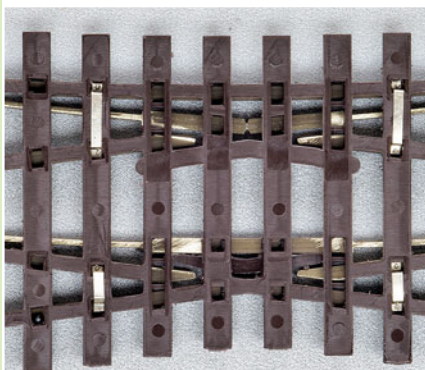
Der mittlere Teil eine Tillig-Elite-EKW von unten mit den werksseitigen Strombrücken.
