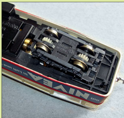
Das neue Antriebsgestell von unten, rechts ist auch der versetzte Schienenräumer zu sehen.
