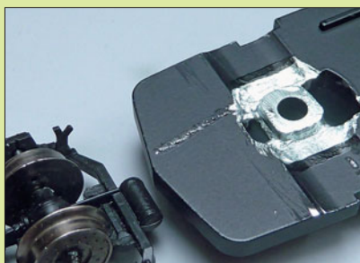
Das Gehäuse nach dem Ausfräsen für den engeren Abstand der Räder ist bereits mit 2-K-Kleber verspachtelt.
