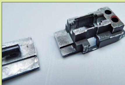
Nach dem Ausbau des Getriebes wird zunächst der hintere Teil des Roco-Rahmens abgesägt.
