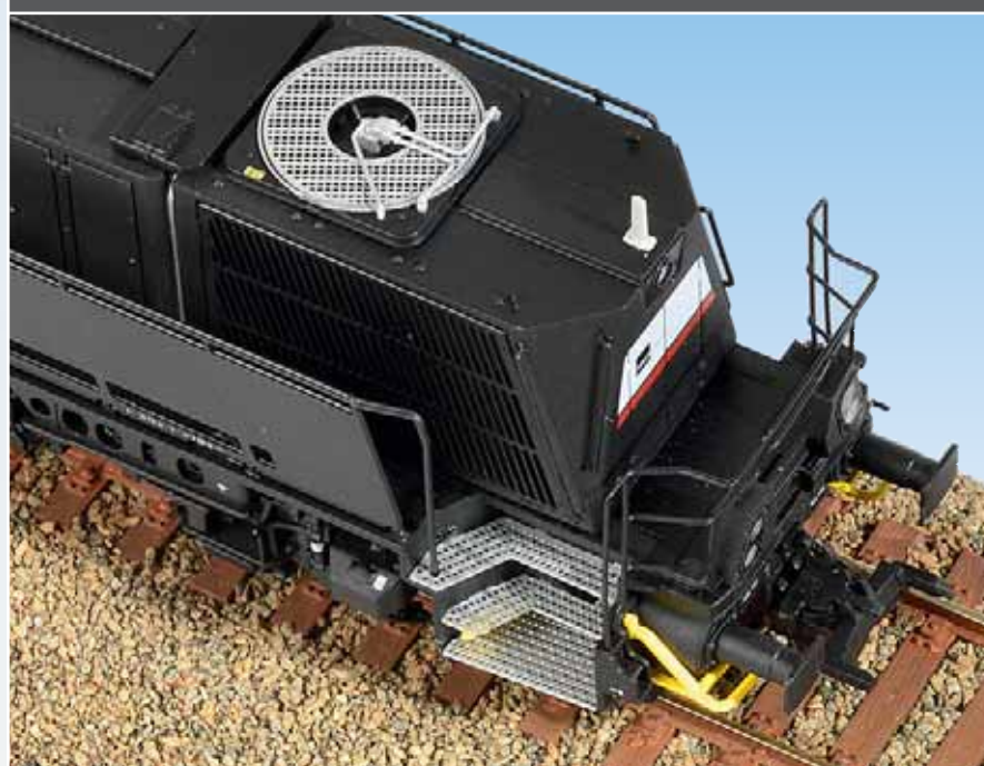
Durchbrochen gestaltet zeigen sich Rangierertritte und das Lüftergitter. Letzteres sitzt bei einigen Maschinen auch um 180° gedreht auf dem Vorbau.
