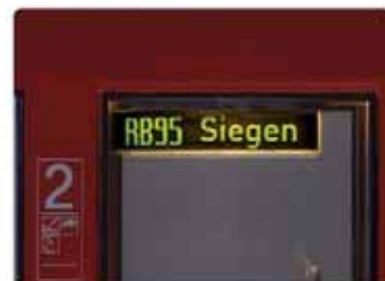
Beleuchtete Zuglaufschilder, auch seitlich
