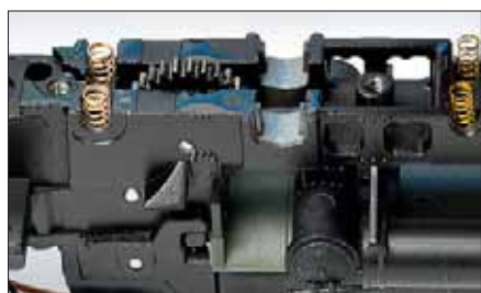
Das Getriebe ist optimal im Aschkasten versteckt. So bleibt der Barrenrahmen frei.
