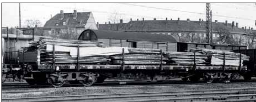
Der (SSml) SSIm 384 1052 der DR, aufgenommen im März 1967 in Leipzig, war noch weitgehend im Originalzustand. Nur einige Bänderinge hatte man durch Ösen ersetzt und die kürzeren Rungen hat vermutlich ein anderer Wagen beigeleitet. Foto: Joachim Claus
