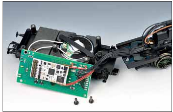
Im Tender liegt die Hauptplatine, die auch die 21-polige Schnittstelle bereitstellt. Unter der Platine ist Platz für den Lautsprecher. Fotos: dh
