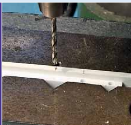
Die Sacklöcher für die Schienenprofile wurden mit einer Standbohrmaschine gebohrt.
