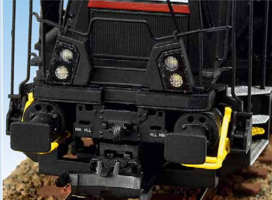
Beachtenswert sind die vorbildgerecht gestalteten Gläser für die normale Lokbeleuchtung und die Fernscheinwerfer (oben). Gut zu erkennen ist auch der Hebel der Rangierkupplung, der die Kupplungsbügel über die Doppelhaken hebt.
