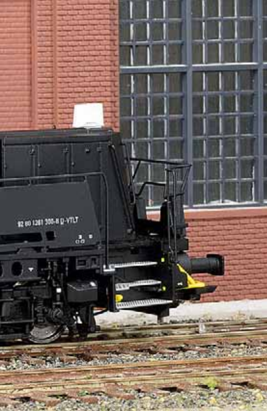
Beachtenswert sind die vorbildgerecht gestalteten Gläser für die normale Lokbeleuchtung und die Fernscheinwerfer (oben). Gut zu erkennen ist auch der Hebel der Rangierkupplung, der die Kupplungsbügel über die Doppelhaken hebt.
