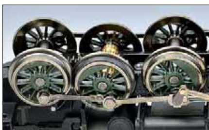
Die Kuppelstange ist geteilt und macht so alle Vertikalbewegungen der Radsätze mit.
