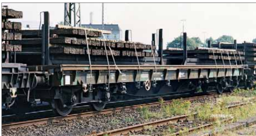
Nach der Rekonstruktion erinnert nur noch wenig an die Ausgangsbauart: Die stärkeren Außenlangträger und die Niesky-Drehgestelle ließen eher einen Neubauwagen vermuten. Weitere Veränderungen erfuhren die Wagen durch den Umbau zum Jochtransportwagen: Nun kamen Ladegestelle und Transportschienen hinzu. Der von Kirow erworbene und an die DB zurückvermietete Sps 466 471 9 035, aufgenommen im August 1998 im Gbf Hamburg-Altona, hatte darüber hinaus erst kürzlich Spanngurte zur Ladungssicherung erhalten. Foto: SC
