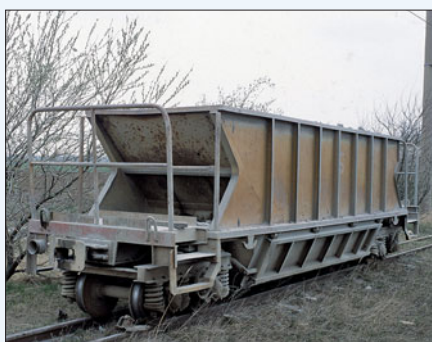
Die Wagen gehören der Gattung Fal an und können schlagartig entladen werden.
