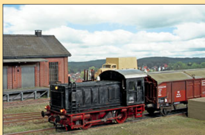
Die V 36 wurde wie die V 20 als Wehrmachtslok entwickelt. Sie ist stärker als die kleinere Schwester und hat drei Achsen. Sie wurde zwischen 1937 und 1950 gebaut und war in der DDR sogar bis 1985 eingesetzt.
