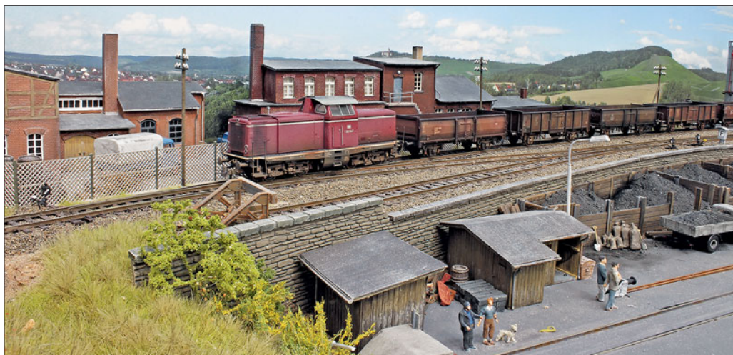
Beim Gleisanschluss „Rosthafen“ sind sowohl die Einfahrweiche als auch die Weiche des Schutzgleises ortsgestellt und liegen normalerweise in der Grundstellung. Für die nächste Weiche im Gleisanschluss ganz rechts ist dies nicht erforderlich.
