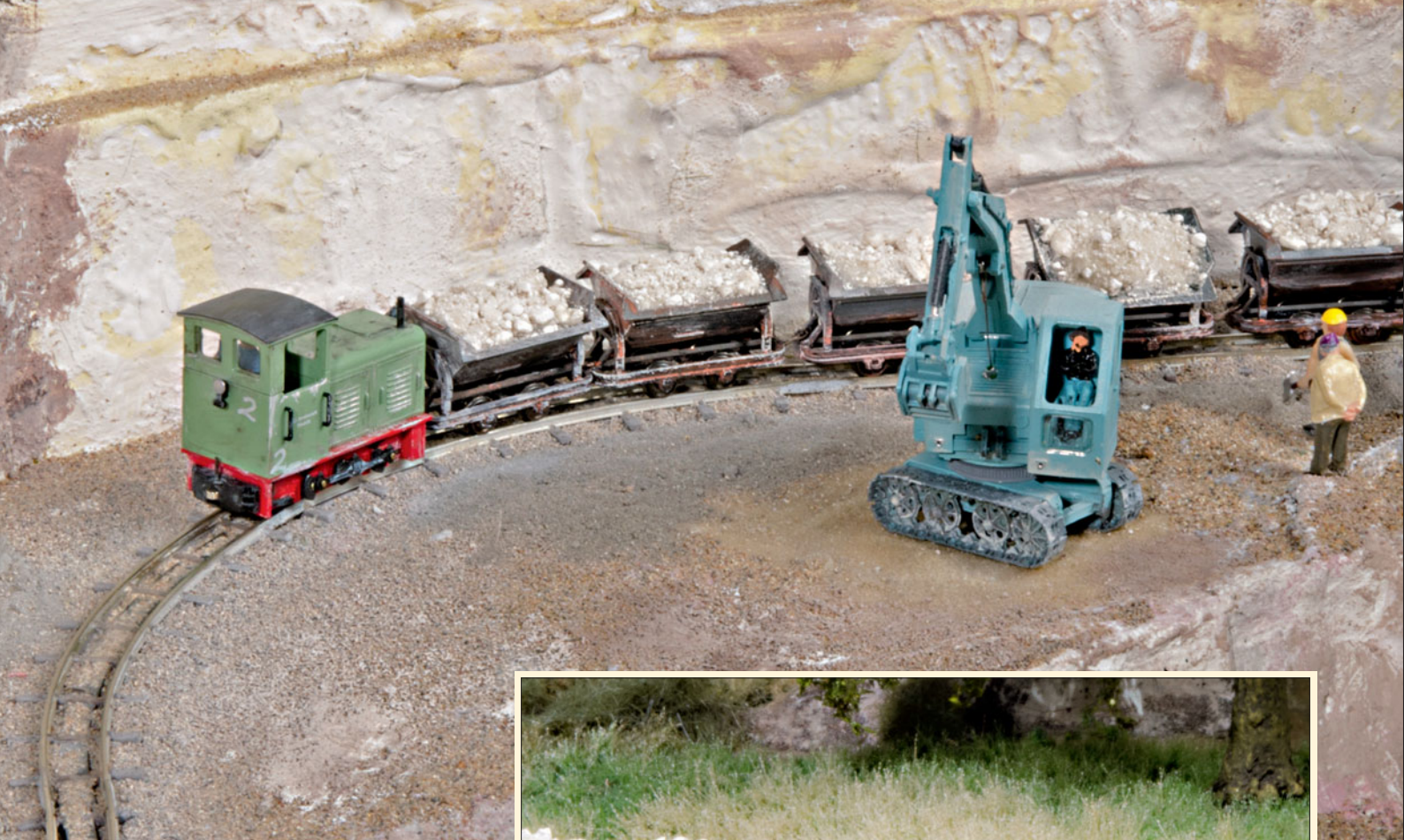
Oben: Der Bagger UB 20 (von Icar) erhielt nachträglich einen Getriebemotor und einen Servoantrieb, sodass er sein Oberteil drehen und den Ausleger heben und senken kann.
