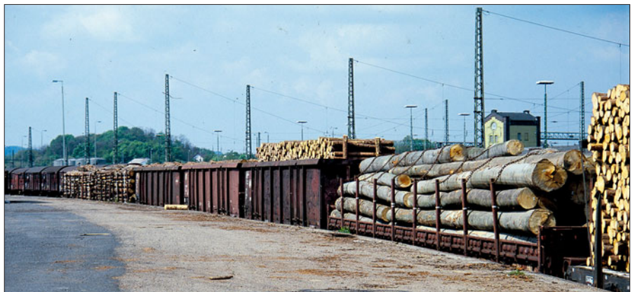
Am Freiladegleis konnte das Umladen in Lkws oder Fuhrwerke direkt erfolgen. Die Ladestraße wies selbst in kleineren Bahnhöfen oft eine beträchtliche Länge auf; hier in Limburg wurde beispielsweise Holz auf den verschiedensten Wagentypen verladen.
