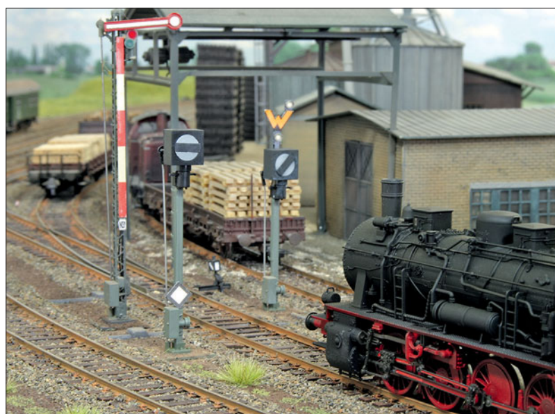
Der Beispielbahnhof mit Druckstellenstellwerk und Lichtsignalen: Da Rangierfahrten immer unter Fahrstraßensicherung stattfinden, steht an jedem möglichen Beginn ein Gleisperrsignal.
