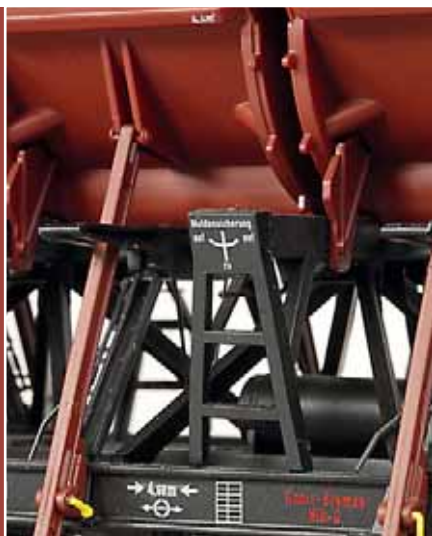
Nachgebildet ist auch der Hebel für die Muldensicherung (linke und rechte Mulde).
