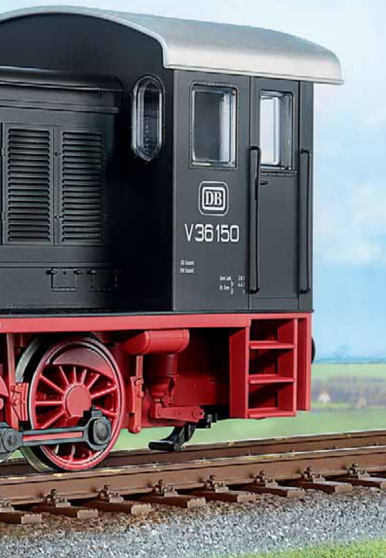
Die Rückfront der V 36 bietet ebenfalls zahlreiche Details: Lampen, Nietreihen und eine Tür.
