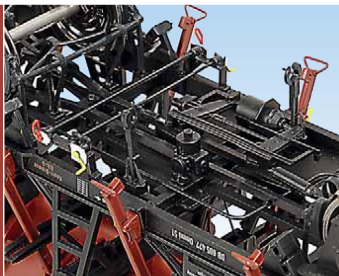
Detailreich präsentiert sich der Unterboden mit der Bremsanlage und den beiden Gleiszangen.
