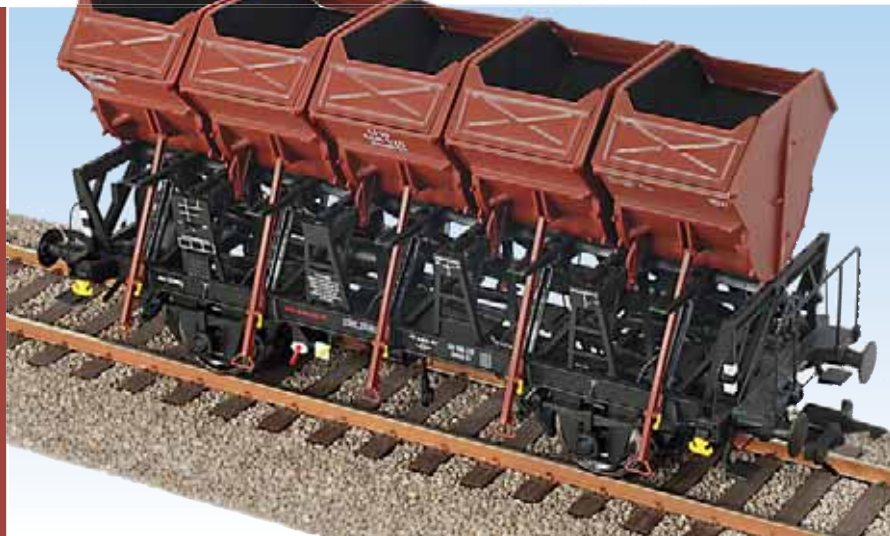
Der Blick in den Rahmen und das Muldentraggerüst offenbart neben dem Luftbehälter und der Handbremsanlage auch die Schutzbleche für die Bremsanlage.
