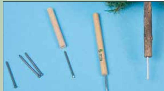
Wer jedoch eine Drehbank sein Eigen nennt, kann bei der Gelegenheit die natürliche, leicht konisch verlaufende Wuchsform des Stamms herstellen. Im Bild links sind einige der fertig bearbeiteten „Stammhülsen“ zu sehen. Auch auf der Unterseite erhalten die Stämme Bohrungen zur Aufnahme der Montagestifte, für die einfach beidseitig angespitzte Nägel verwendet werden können.
