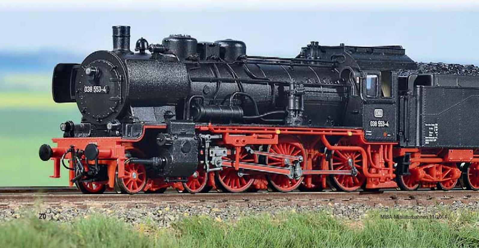
das aus Kunststoff gefertigte Gestänge, das zudem detailreich graviert ist. An Treib- und Kuppelrädern lassen sich sogar Schwimmhäute zwischen den Speichen an den Kurbelzapfen ausmachen. Die beidseitig angebrachten Indusimagneten sind Zeugnis der Epoche IV.
