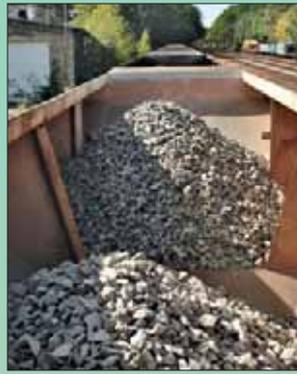
Je nach Wagentyp und Ladegut unterscheidet sich der Füllstand in Selbstentladewagen deutlich. Vierachsige Fac-Wagen (links) sind bei Splitt nahezu voll beladen, während zweiachsige Fcs-Wagen bei Granitschotter halb leer bleiben müssen (rechts).
