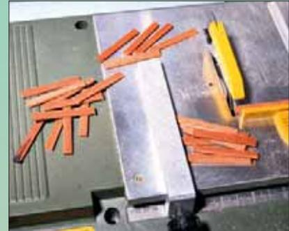
Auf einer Tischkreissäge werden identisch lange Holzleisten zugeschnitten, aus denen die Wände der Boxen für das Schüttgut entstehen. Für die Stützen wurden dagegen passende H-Profile aus Messing verwendet.
