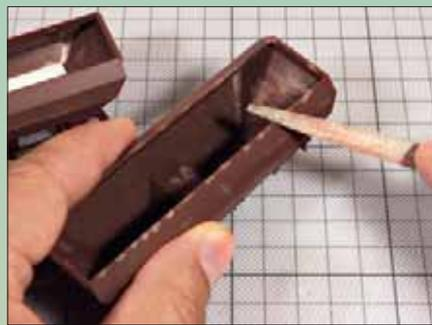
Bei den hier verwendeten Wagen von Roco mussten zunächst die Laderäume frei gelegt werden. Beulen als typische Ladespuren wurden mit kleinen Feilen eingearbeitet.
