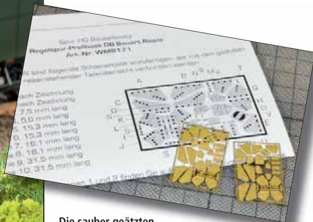
Die sauber geätzten kleinen Messingbleche enthalten alle Knotenbleche für den Bau von jeweils einem Prellbock der Bauart Rawie. Die zusätzlich erforderlichen Schienenprofile müssen indes selbst abgelängt und zugefeilt werden. Aus der ausführlichen Bauanleitung gehen die genauen Maße hervor; hier heißt es unbedingt, mit der nötigen Sorgfalt ans Werk zu gehen ...
