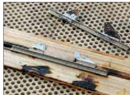
feinen Lötspitze, viel Geduld und reichlich Lötwasser kommt man durchaus zum Ziel! Das Ganze freihand zu löten, macht jedoch bei den teilweise winzigen Bauteilen keinen Sinn. Deshalb habe ich mir aus 1 mm starken Holzleisten einige einfache Lötlehren geschnitten, in denen die Schienenprofile mit Stecknadeln auf einem Holzbrettchen sicher fixiert werden konnten.
