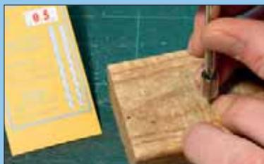
Der Stahldraht für den Pfosten wird mit einem kleinen Tropfen Sekundenkleber am Rollenhalter fixiert.
