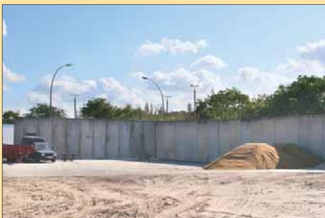
Durch Betonwände aus Stützen grenzt man in Bauhöfen Bereiche ab, in denen unterschiedliche Schüttgüter gelagert werden können, ohne dass es untereinander zu einer Verunreinigung kommt.
