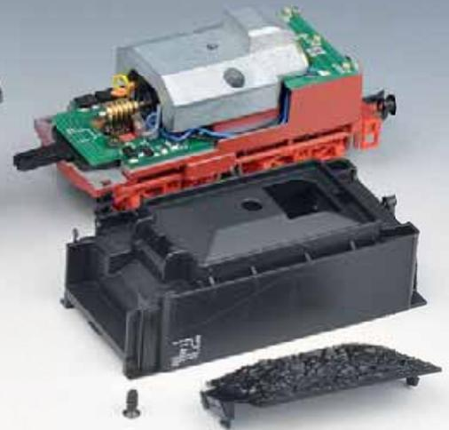
Die Trägerplatine der Schnittstelle ist an der Rauchkammertür arretiert. Zum Einbau eines Decoders ist sie vorsichtig herauszuziehen.
