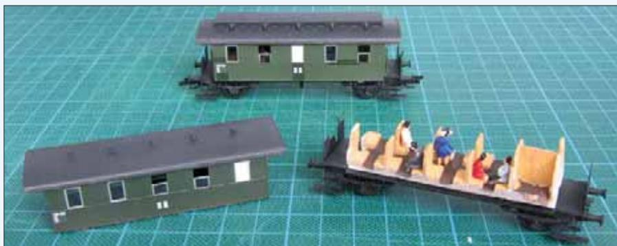
Drei unterschiedliche Stadien des Umbaus von TT-Industriemodellen. Für den Wagenkasten mit Flachdach (links) fanden Ätzplatinen der Firma „Digitalzentrale“ Verwendung.
