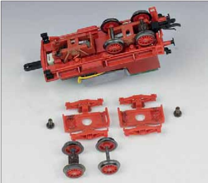
Der Antrieb erfolgt auf die beiden äußeren und mit Haftreifen versehenen Achsen. Die inneren Achsen sind deutlich erkennbar höhenvariabel gelagert. Alle Achsen dienen zur Stromaufnahme.
