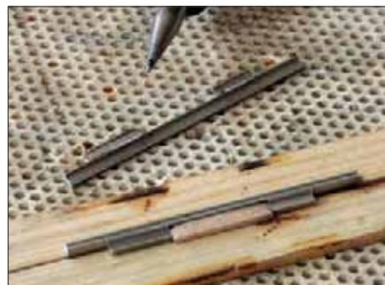
Die ersten Bauschritte: Einklemmt zwischen zwei Holzleisten lassen sich die Profilstücke für die beiden seitlichen Befestigungsschienen sicher zusammenlöten. Eine weitere kleine Holzleiste sorgt für den korrekten Abstand der beiden kurzen Schienenstücke, außerdem können die Schienenprofile zusätzlich noch mit Stecknadeln fixiert werden.
