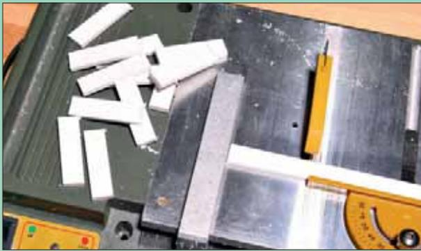
Die Beton-Winkelstützen lassen sich im Modell aus drei Millimeter dicken Kunststoffplatten nachbilden, die in Streifen geschnitten werden.
