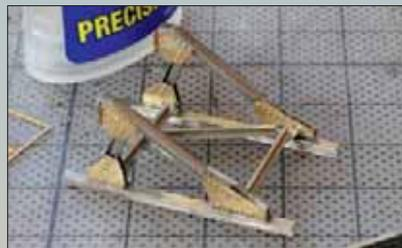
Nach dem Löten muss der Prellbock gründlich mit Aceton gereinigt und mit einem Glashaarradierer versäubert werden. Die außenliegenden Knotenbleche wurden mit Sekundenkleber aufgeklebt.
