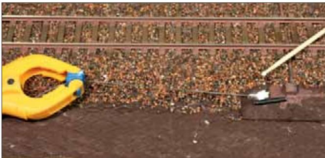
„Startpunkt“ gegenüber der Blockstelle ist das kurze Kanalstück, das sich zum Schutz vor der Ablenkung befindet. Je nach Untergrund kann der Nagel wie hier bei den verwendeten Dämmstoffplatten einfach mit den Fingern in den Untergrund gedrückt werden. Die Rollenhalter werden entlang des Leitungsverlaufs platziert. Die korrekte Höhe der Seilzüge und Pfosten lässt sich dabei mit einem auf die Schienen gelegten Holzleistchen leicht überprüfen.
