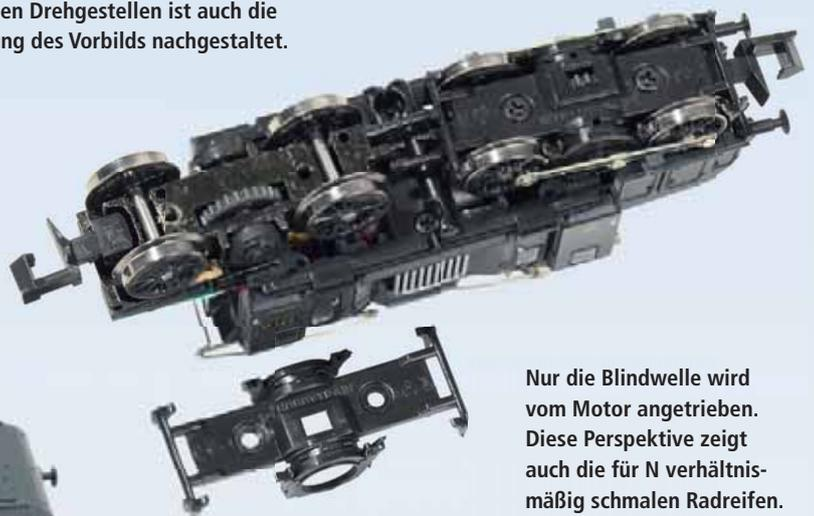
Nur die Blindwelle wird vom Motor angetrieben. Diese Perspektive zeigt auch die für N verhältnismäßig schmalen Radreifen.
