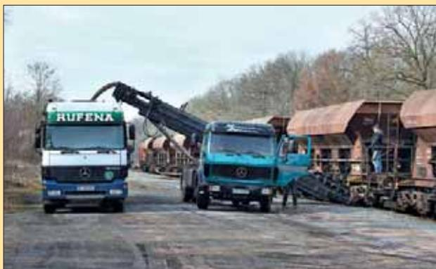
Schotter oder Kies wird in Wagen mit mittlerer Schwerkraftentladung gefahren und hier mit einem speziellen Förderband-Lkw entladen. Das Ladegut wird auf Halden oder in Lkws verladen.
