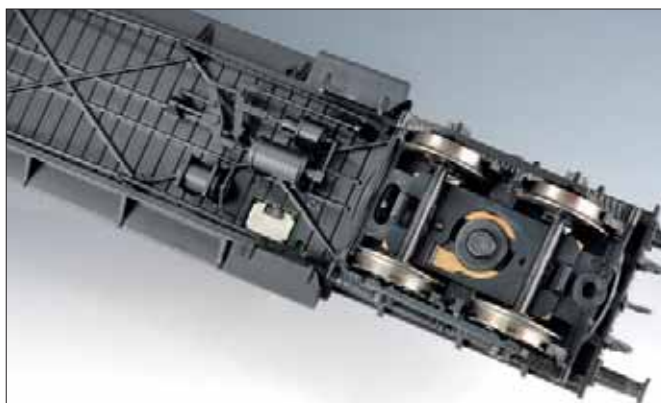
Links: Im Vorbau des b-Wagens sind Schnittstelle und Lautsprecherhalterung untergebracht. Liliput empfiehlt als Sounddecoder den ESU-Decoder Art.-Nr. 54487 (Sound des ETA 176). Denkbar ist aber auch der ESU-Decoder 55415 mit dem noch etwas stärker „heulenden“ Antrieb des ETA 150. Zur Lautsprecherhalterung passt der ESU-Lautsprecher 50331.
