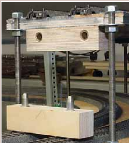
In Multiplex-Buchensperrholz eingelassene Passbuchsen stellen mit Bolzen die Verbindung zwischen Wendelwagen und der in der Höhe flexiblen Modultrasse her.
