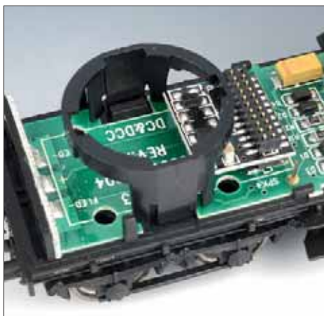
Die elektrische Verbindung unter den Fahrzeugen ist achtpolig. Buchsen- und Stiftheisen garantieren die stets seitensrichtige Zusammenstellung der Triebwagengarnitur.
