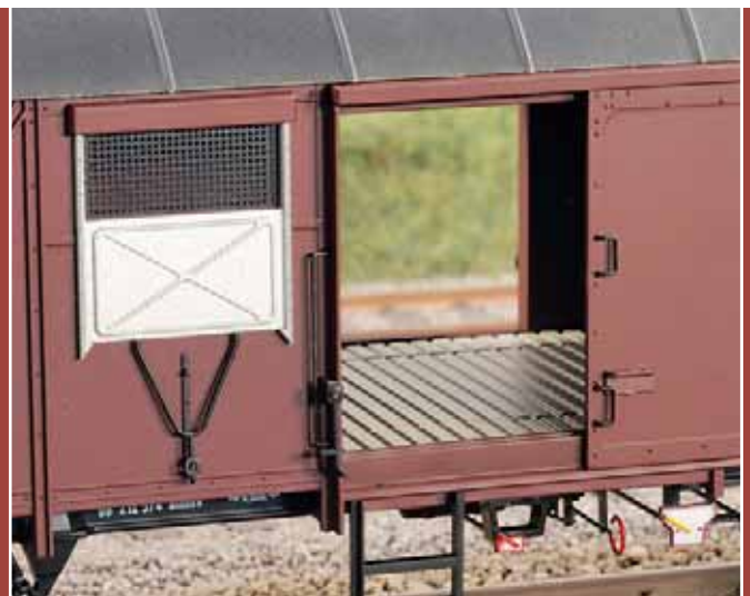
Blick in den Laderaum mit dem Bretterboden. Die Schieber der Lüftungsklappen lassen sich in zwei Positionen einrasten.
