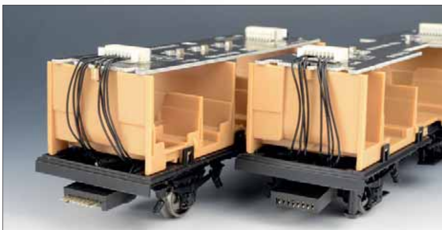
Die elektrische Verbindung unter den Fahrzeugen ist achtpolig. Buchsen- und Stiftheisen garantieren die stets seitensrichtige Zusammenstellung der Triebwagengarnitur.
