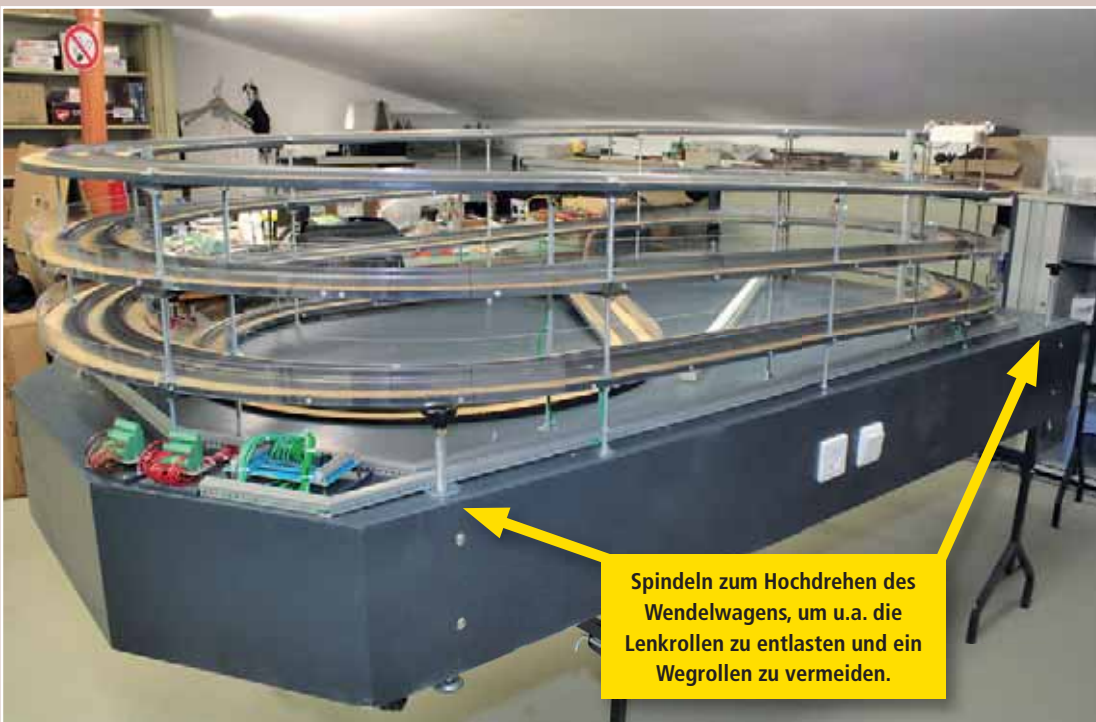
Der Basiskasten des Wendelwagens besteht aus 19-mm-Tischlerplatte. Die in den Ecken platzierten Konstruktionsholzzuschnitte tragen die Lenkrollen.
