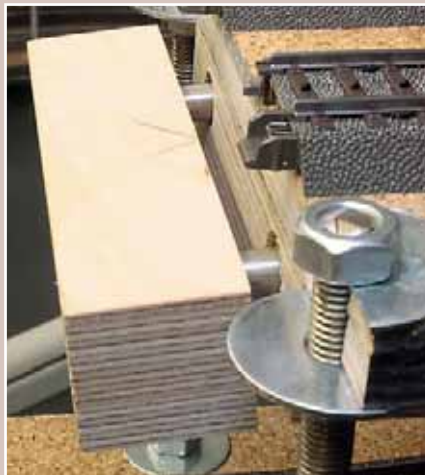
In Multiplex-Buchensperrholz eingelassene Passbuchsen stellen mit Bolzen die Verbindung zwischen Wendelwagen und der in der Höhe flexiblen Modultrasse her.
