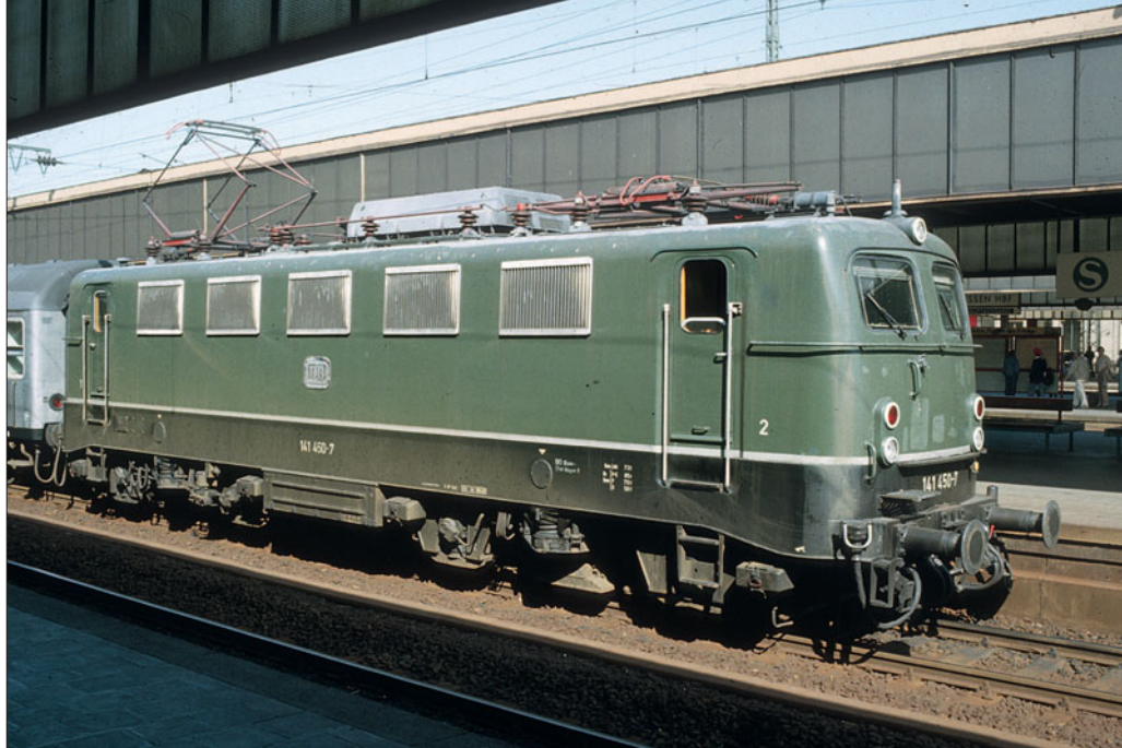
141 450-7 zählt zu den fünf 141 mit Netzbremse, erkennbar am großen Blechaufbau auf dem Dach. Darunter befanden sich die Erregerwiderstände. Die Lok konnte also beim (häufigen) Bremsen Energie in den Fahrdrat zurückspeisen. Die Lok stand am 15.8.1983 in Essen Hbf zur Abfahrt bereit.
