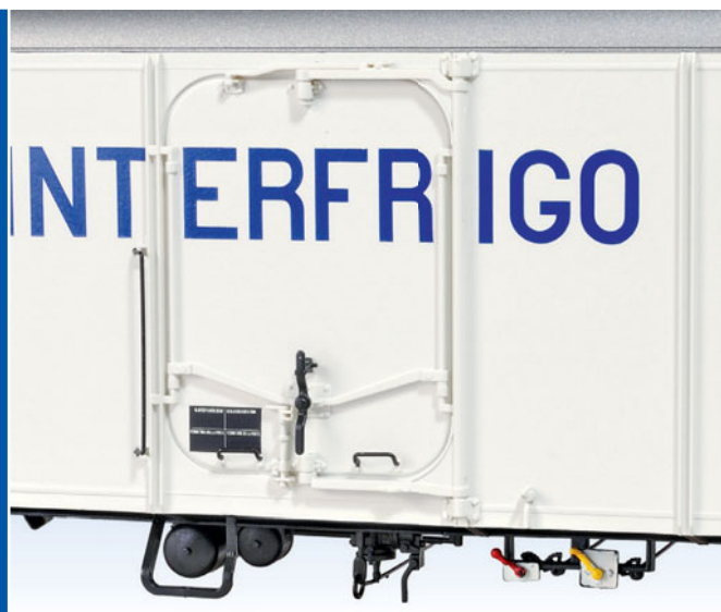
Hinter dem Trittbügel lugen die Luftbehälter hervor. Rechts davon die Lösevorrichtung und daneben die Bremsumsteller.
