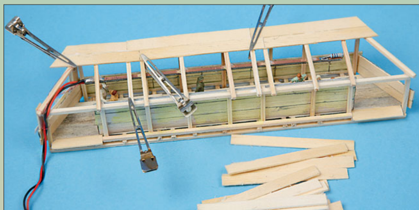
Nun wird Brett für Brett das Dach zusammengesetzt. Die Abbildung zeigt eine Eindeckversion bei minimalem Materialverschnitt. Die Dachhaut entsteht aus Sandpapierstreifen.
