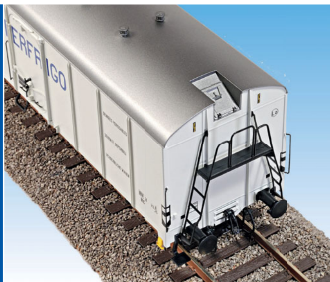
Bühne und Rangierertritte sind flexible Kunststoffteile und zeigen Details wie Befestigungsschrauben und Gitterstrukturen.
