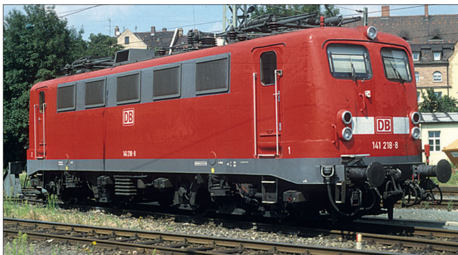
Unten: Im Bw Nürnberg Hbf stand 141 218-8 am 26.7.1998. Die Lok hatte etwa ein halbes Jahr zuvor die verkehrsrote Lackierung im AW Opladen erhalten. Auch die Griffstange an der Front und das breite Trittbrett sind zu diesem Zeitpunkt einem Einzelgriff und einem kurzen Tritt gewichen. Fotos: bz
