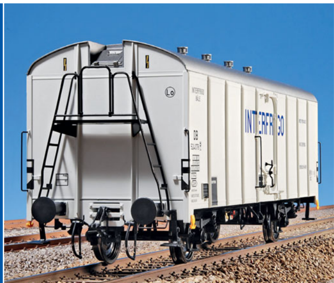
Stirnseite mit eingesteckter Schraubenkupplung und montierten Bremsschläuchen – auch für den Kurzkupplungsbetrieb ansteckbar.
