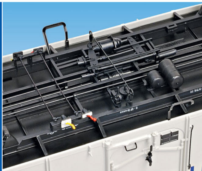
Bremsanlage mit detailreich dargestellten Bremsstellern, Luftbehältern, Stellstangen, Lösezug und dergleichen.
