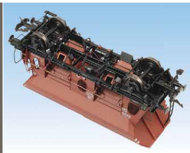
Ein Blick unter den Wagen offenbart die detailreiche Bremsanlage und die Mechanik der beweglichen Rutschenverlängerung.
