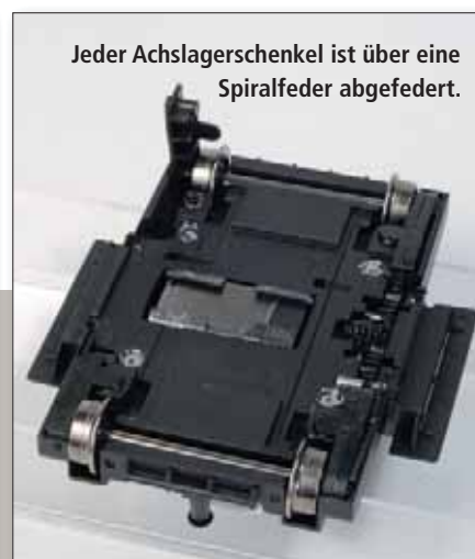
Jeder Achslagerschenkel ist über eine Spiralfeder abgefedert. Über eine Zahnradkette im Schenkel des Achslagers erfolgt der Antrieb. Fotos: gp
