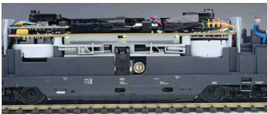
Trotz des großen Gehäusevolumens mussten die zahlreichen Komponenten mit Bedacht verteilt werden. Für einen Maschinenraumdurchblick war dennoch Platz. Fotos: MK
