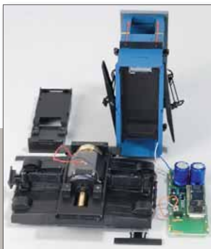
Motor und Elektronik benötigen nur den Platz unterm Führerstand.
