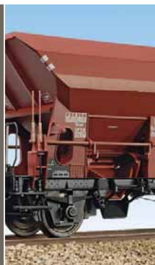
Die Mechanik der Rundschieber funktioniert leichtgängig, sodass sich über die Hebel die Schieber problemlos öffnen lassen.
