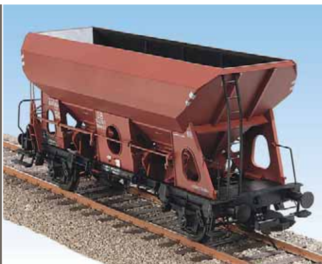
Auf der der Bühne abgewandten Seite beherrscht die durchgehende Leiter die Ansicht. Die Blattfedern zeigen einen unbeladenen Wagen.
