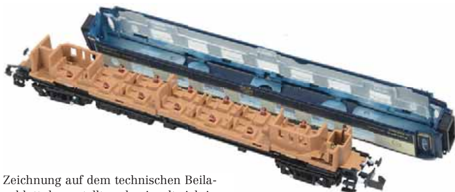
Der Speisewagen des Orient-Express ist mit beleuchteten Tischlampen ausgestattet. Die Gehäuse lassen sich gut abhebeln, um Reisende zu platzieren.
