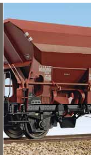
Die Mechanik der Rundschieber funktioniert leichtgängig, sodass sich über die Hebel die Schieber problemlos öffnen lassen.
