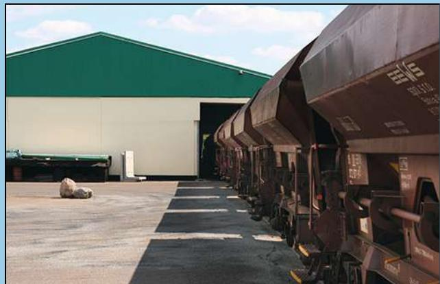
Der feuchtigkeitsempfindliche Dünger wird in Tds- oder Tads-Wagen mit Klappdeckeln gefahren und in einer großen Lagerhalle, durch die ein Gleis führt, entladen.
