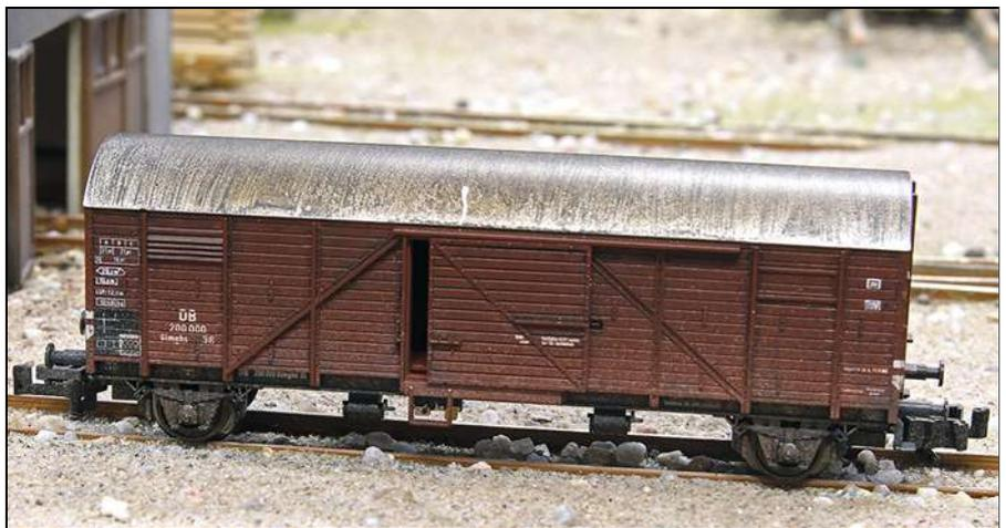
Der Glm(g)hs 36, ein früherer Leipzig, wurde für den Getreideverkehr zwischen Frankreich und Süddeutschland mit Schüttklappen ausgerüstet. Hier erfolgte die Befüllung durch die oberen, seitlichen Luken. Derzeit gibt es nur ein N-Modell von diesem Wagen.
