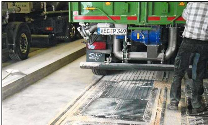
Da die Gleise eingepflastert sind, kann die Entladung sowohl von Schienen als auch Straßenfahrzeugen erfolgen. Moderne Lkws entladen über kleine Heckklappen durch Ankippen der Mulden direkt in den Tiefbunker. *Fotos: Guido Viertel*
