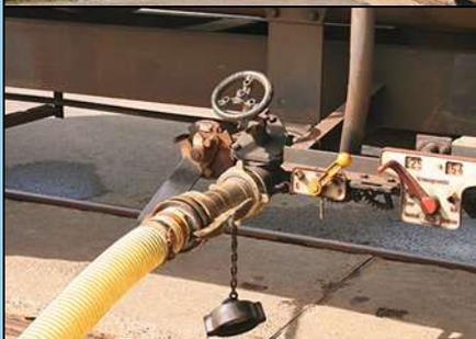
Mittels einer einfachen Schlauchverbindung werden die Kesselwagen am Zapfventil entladen (links).
