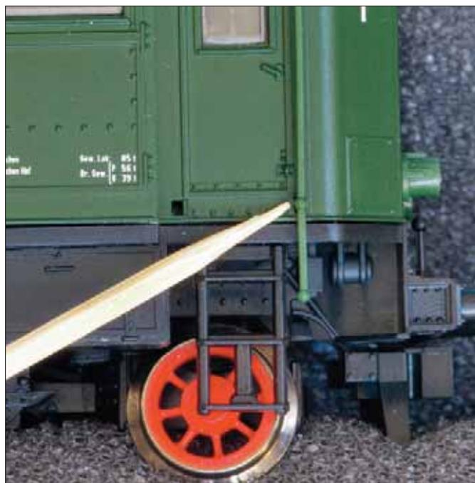
Den schon etwas älteren dreiachsigen Umbauwagen von Roco lagen die Griffstangen zur Selbstmontage bei. Der Hinweis zum Kleben enthielt freilich keine näheren Informationen; die Griffstangen sollen stumpf auf den Wagenkasten geklebt werden.
