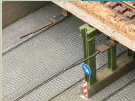
Die Abspannfederchen für den Fahrdraht werden einfach in kleine Haken aus Messingdraht eingehängt – so der Plan ... Die Schienen werden unter dem Trassenbrett angeklebt. Danach waren die Haken aber leider nur noch mit sehr viel Fummelerei zu erreichen ...
