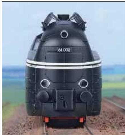
An der Front lässt sich die Scharfenbergkupplung gegen die vorstehende Abdeckung tauschen, was eigentlich nur für die Ursprungsausführung als beige-violette Lok des Henschel-Wegmann-Zuges korrekt ist.
