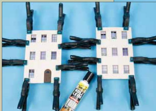
Beim Verkleben der Fenster- und Fassadenflächen ist ein Fixieren der Flächen mit Klammern (von denen man eigentlich nie genug haben kann ...) bis zum Abbinden des Klebers ange raten.
