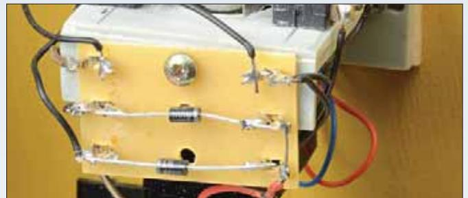
Anschlussplatine mit den beiden erforderlichen Dioden für die Richtungssteuerung.
