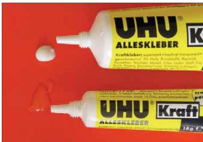
Nach dem Austritt aus der Tube ist der farbliche Unterschied der beiden Klebstoffe erkennbar. Wenn beim Lösungsmittelfreien Kleber (oben) das Abbinden einsetzt, ändert sich die Farbe von milchig weiß auf transparent.
