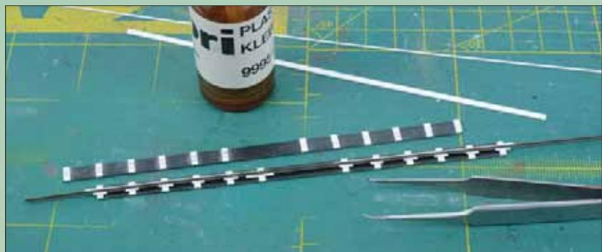
Für die Fahrleitungsschienen in der Unterführung wurde ein Code-40-Schienenprofil mit 1,4 mm Höhe von Micro Engineering verwendet (erhältlich über Walters). Die Befestigungsplatte besteht aus 0,5 mm starkem Polystyrol, die „Kleineisen“ aus 0,5 und 1,5 mm breiten Evergreen-Streifchen.
