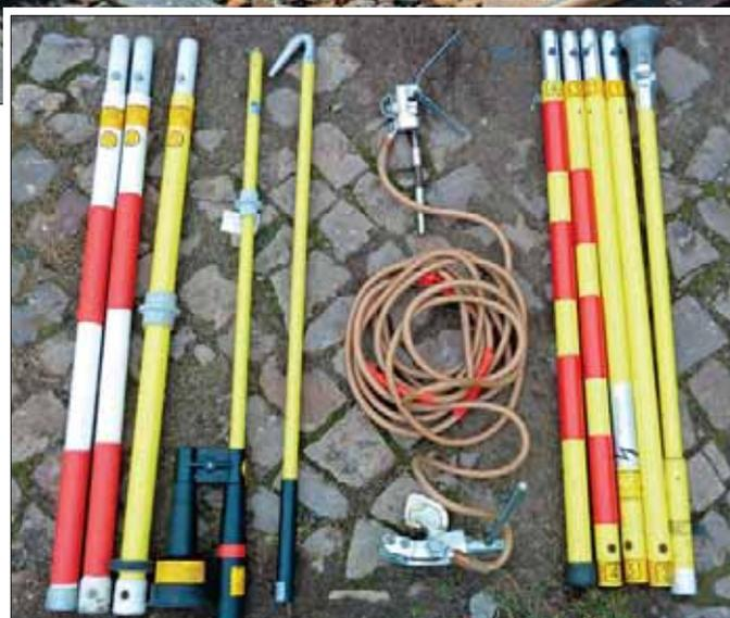
Die Einzelteile des Spannungsprüfers (links) und der Erdungsstange (rechts), in der Mitte das Erdungsseil mit den beiden Erdungsklemmen.
