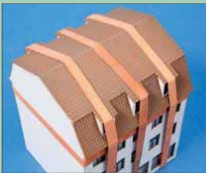
Beim Verkleben des Dachs muss auf den bündigen Sitz der Dachflächen vor allem an den einzelnen Gauben geachtet werden. Hier sind die Gummiringe wieder unverzichtbar.
