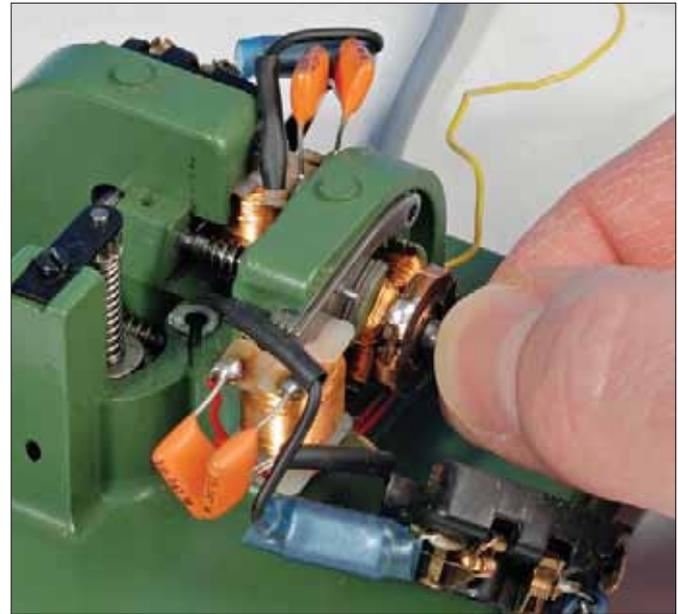
Nach Abschrauben des Motorschildes lässt sich der Anker herausziehen. Wegen des verklebten Wellenlagers geht das etwas schwer.
