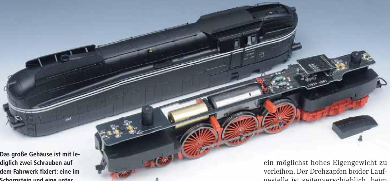
Das große Gehäuse ist mit lediglich zwei Schrauben auf dem Fahrwerk fixiert: eine im Schornstein und eine unter der Kohlenkastenklappe.
