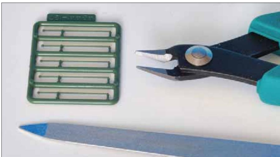
Zum Abtrennen der Zurüstteile vom Spritzling wie hier den Griffstangen der BR 132 ist der messerscharfe watefreie Seitenschneider von Faller bestens geeignet. In manchen Fällen ist außerdem das Entgraten mit einer feinen Feile erforderlich.
