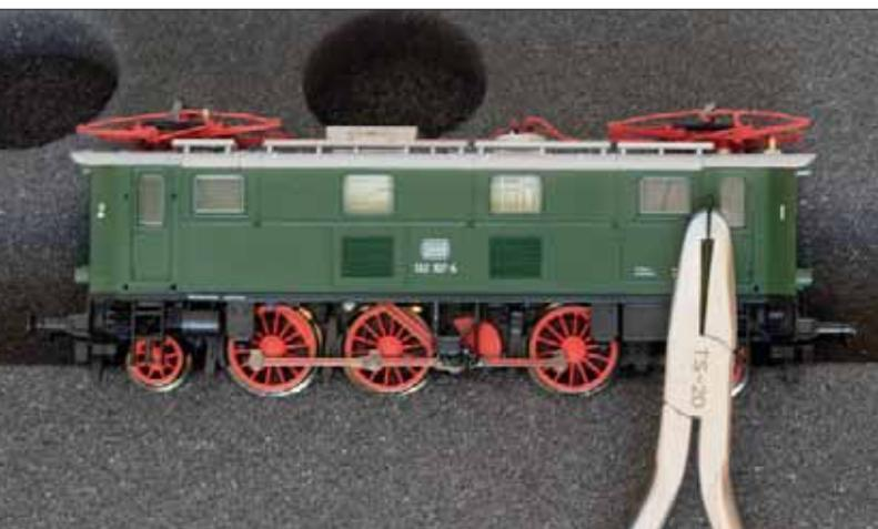
Zum Positionieren von seitlich anzubringenden Zurüstteilen, wie etwa den Griffstangen, ist eine Lokliege aus Schaumstoff mit einseitiger Abschrägung vorteilhaft. Bereits bei einer geringfügigen Überdosierung quillt der Kleber aus der Aussparung. Mit einem spitzen Zahnstocher kann er aber leicht wieder entfernt werden.
