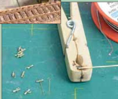
Rechts: Die Fahrdrabtabhänger entstanden aus feinen Messingröhrchen mit 0,7 mm Durchmesser von Knupfer, an die ein passend abgebogenes 0,3-mm-Drähtchen gelötet wurde. Eine Wäscheklammer diente dabei als praktisches Hilfsmittel beim Löten, damit man sich nicht die Finger verbrennt ...
