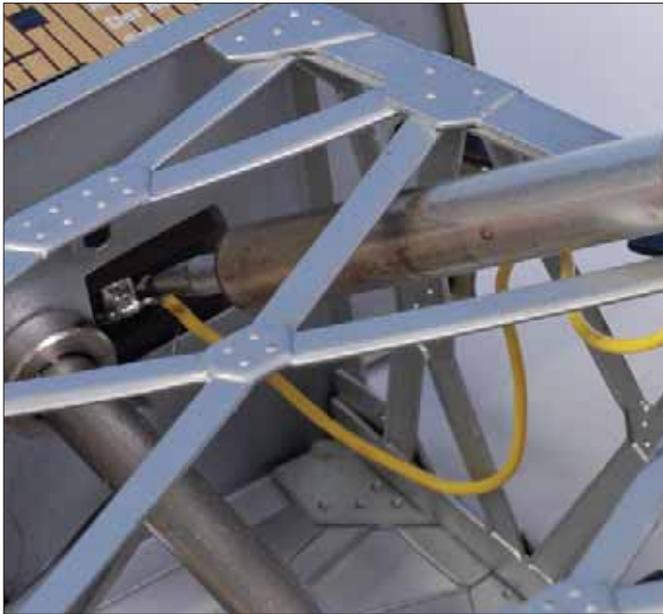
Um den Kran von der Grundplatte lösen zu können, muss das Kabel für den Hubmagnet des Krans abgelötet werden. *Fotos: Gerhard Peter*
