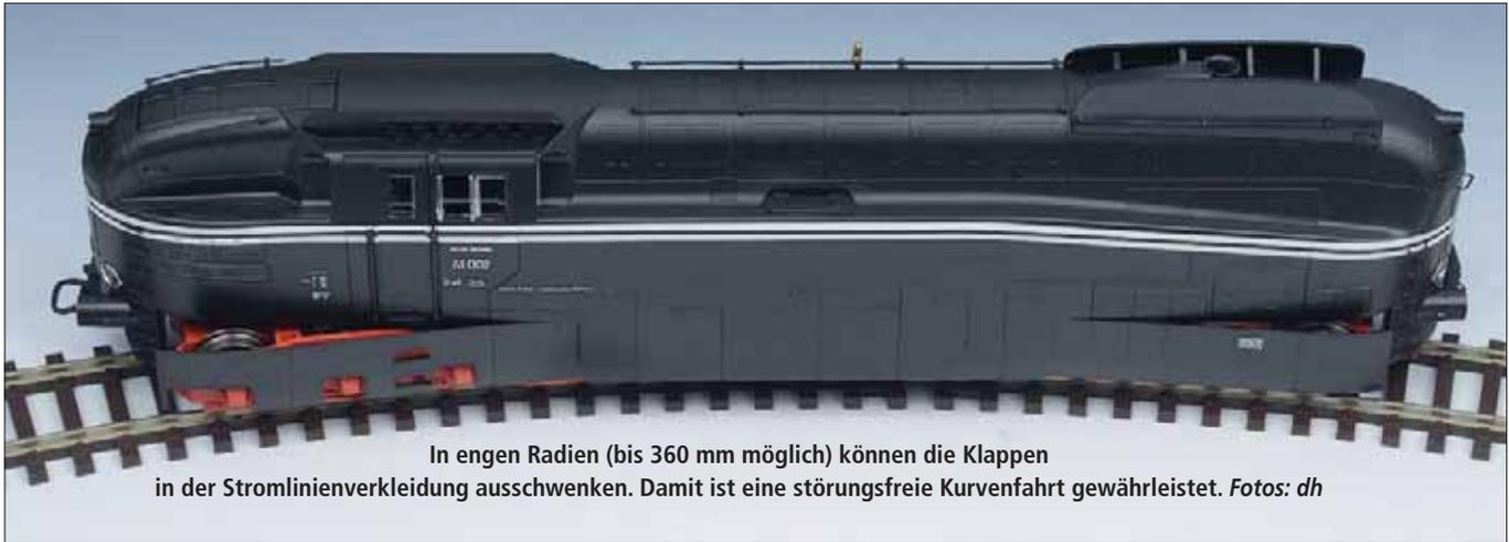
In engen Radien (bis 360 mm möglich) können die Klappen in der Stromlinienverkleidung ausschwenken. Damit ist eine störungsfreie Kurvenfahrt gewährleistet. Fotos: dh
