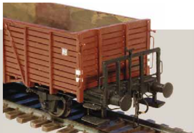
Auch den Roco-Om 21 gab es mit Bremserhaus, das aber bei diesem Wagen entfernt wurde. Dafür musste das Bühnengeländer neu gebaut und die Stirnwand ergänzt werden.
