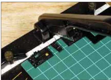
Bei den Roco-Wagen sollte man die Puffer abschneiden, dabei jedoch die Pufferplatten stehen lassen. In die Pufferplatten inklusive Pufferbohlen werden dann 1-mm-Löcher gebohrt und die neuen Puffer eingeklebt. Fotos: Ulf Mahrt
