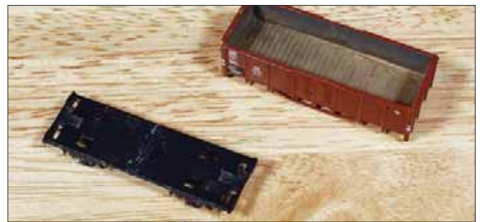
Bei den Roco-Wagen sollte man die Puffer abschneiden, dabei jedoch die Pufferplatten stehen lassen. In die Pufferplatten inklusive Pufferbohlen werden dann 1-mm-Löcher gebohrt und die neuen Puffer eingeklebt. Fotos: Ulf Mahrt
