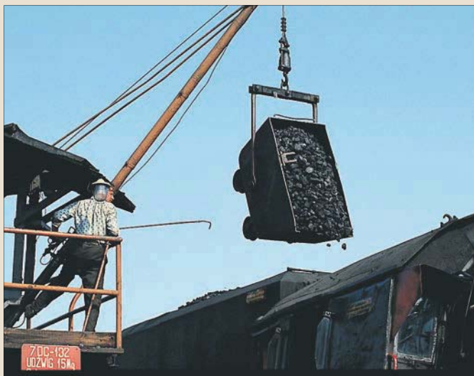
Rechts: Die Bekohlungsanlage des Bw Nürnberg Rangierbahnhof (1973) versorgte Güterzugloks und war mit Taschen-Schütthanlagen und Portalkran ausgestattet. Foto: Harald Ott
