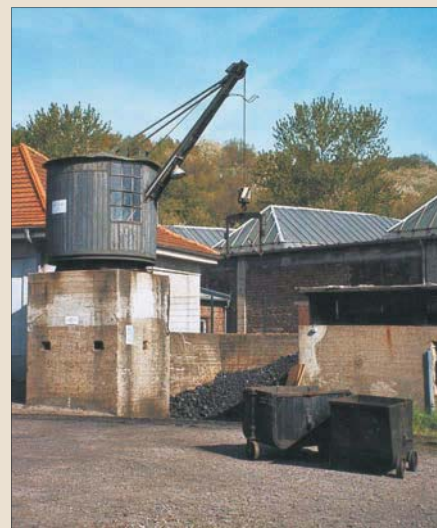
Zum Bekohlen wurden häufig Kohlenkräne mit Hunten eingesetzt. Für die Kohlenlader war Schwerstarbeit angesagt – oft nicht ungefährlich. Links ein Kohlenlader in Wolsztyn, rechts ein Kran mit Hunten in Bochum-Dahlhausen. Foto links: Peter Federmann Foto rechts: Ulrich Rockelmann
