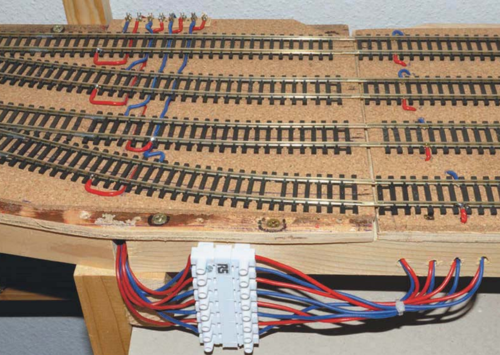
Die Weichen zum Schattenbahnhof bilden ein demontierbares Segment; dadurch lässt sich die Weichenstraße bequem am Werkstisch bearbeiten. Die Steckverbindung dient dem Fahrstrom.
