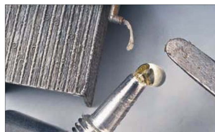
... und anschließend Klebstoff, z.B. Uhu Hart, auf den Kunststoffstreifen gestrichen.
