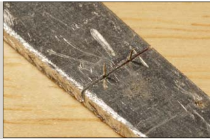
Der Griff wird in einen definiert tiefen Säge-schnitt eines Metallflachprofils eingesteckt.
