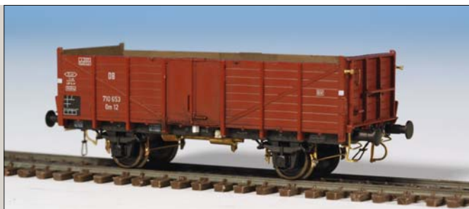
Dieser Om 12 erhielt eine Bremsanlage. Die Bremsklötze von Kuswa wurden noch mit 0,3-mm-Draht verbunden.
