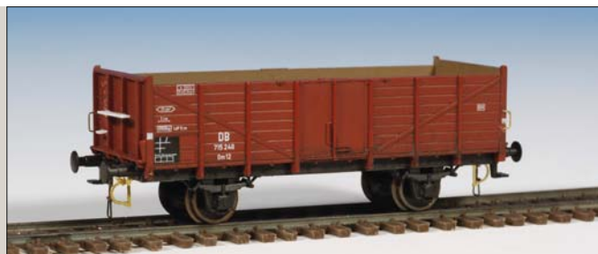
Hier ist der Om 12 mit fiNescale-Rädern ausgestattet sowie mit Schraubenkupplung und Tritten an der Stirnwand aufgewertet.
