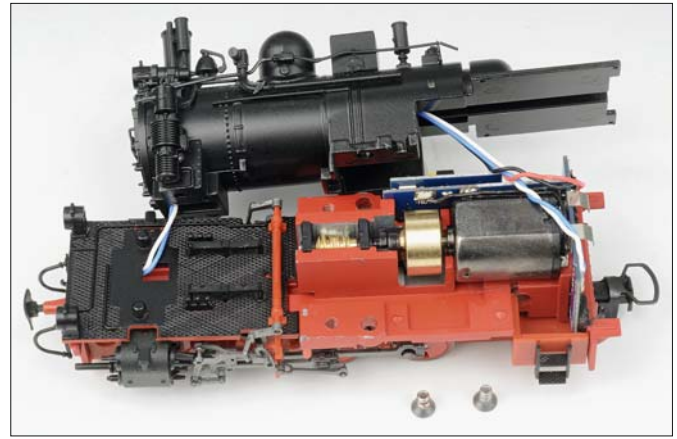
Der Motor verfügt über ein „Schwungmässchen“; das Antriebsmoment wird per Schnecke grundsätzlich auf die mittlere Achse weitergegeben.
