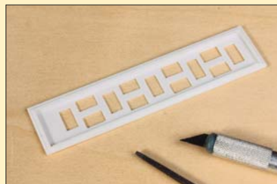
Die Fensteröffnungen im Dach wurden mit einem Skalpell herausgearbeitet.
