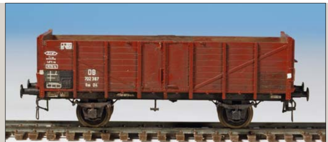
Mit seinen der Originalkupplung angenäherten Magnetfeldkupplungen und den niedrigen Spurkränzen wirkt der Om 04 überzeugend.
