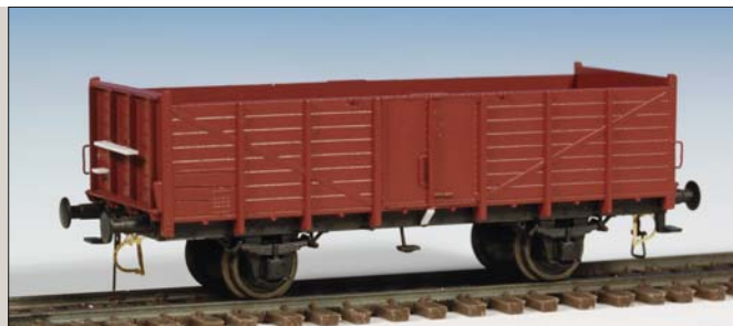
Wesentliche Änderungen für einen Om 04: Tritt und Strebe unter der Tür sowie Tritte an der Stirnseite.
