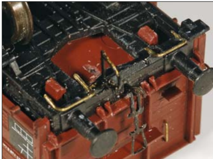
Die vorbereiteten Griffe werden unter die Pufferbohle geklebt.
