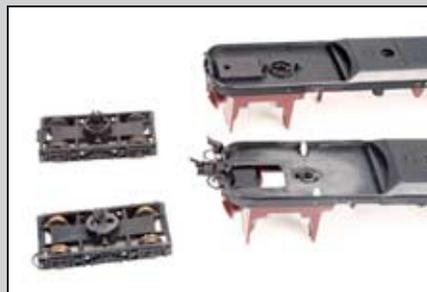
Für die Kurzkupplungskulisse wird eine Öffnung in den Boden geschnitten. Weil der Drehgestellzapfen nun keinen seitlichen Halt mehr hat, übernehmen zwei Wankstützen an der Rahmenseite die Auflage.
