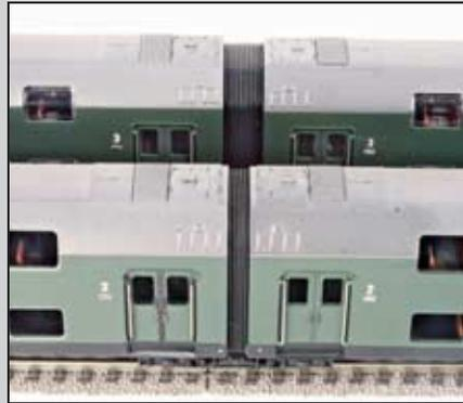
Durch die Verkürzung der Wagenverbindung wird die Länge der Einheit maßstäblich.
