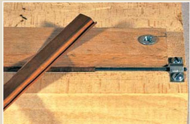
strahlendraht gewickelt. Der Kupferfolienstreifen sollte nur so breit sein und so unter dem Holz fixiert werden, dass er sich nur halb um den Federstahlendraht wickeln lässt.
