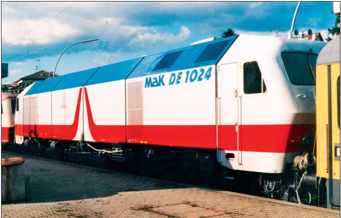
beiden dreiaxigen Drehgestelle haben einseitige Radsatzlenker und eine innenliegende Kraftanlenkung über Stangen. Die Primär- und Sekundärfederung erfolgt über Flexicoil-Schraubenfedern. Die Fahr- und Traktionssteuerung „Micas-S“ entstand in Zusammenarbeit mit ABB, die ja das Drehstromantriebssystem mit den legendären DE 2500 entwickelt hat.
