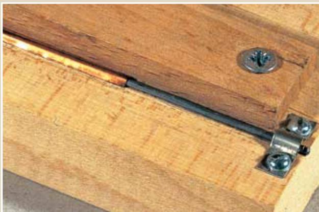
Für die Anfertigung von Regenrinnen entstand die abgebildete Lehre. Ein schmaler Streifen des Kupferfolie wird unter der seitlichen Holzleiste eingeklemmt und anschließend um den Feder-
