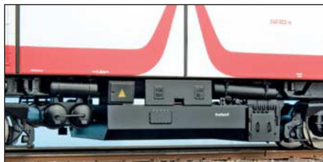
Für den Einsatz auf großen Gleisradien können an den Drehgestellen die „abgesägten“ Sandkästen gegen solche mit korrekter Höhe ausgetauscht werden.
