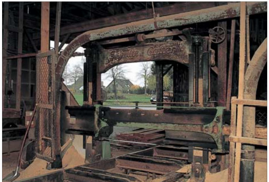
Horizontalsäge mit seitlichem Antrieb. Das Sägeblatt wird über gekoppelte Spindeln in der Höhe eingestellt.
