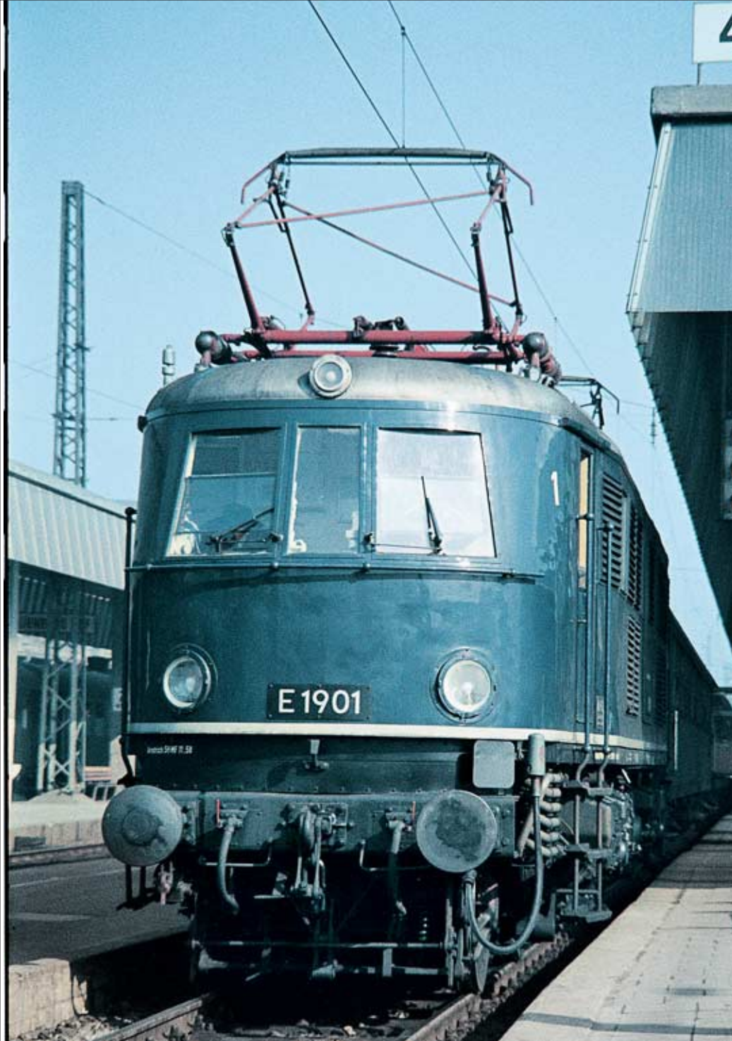
E 19 01 steht am 27.2.1959 abfahrbereit in Nürnberg Hbf in ihrem typischen Outfit für die Zeit zwischen 1958 und 1964: Blaues Farbleid mit weißer Zierlinie, silbernes Dach und SBS 39. Die nicht mehr verwendete Zugnummerntafel ist noch vorhanden. Foto: Dr. Rolf Brüning
