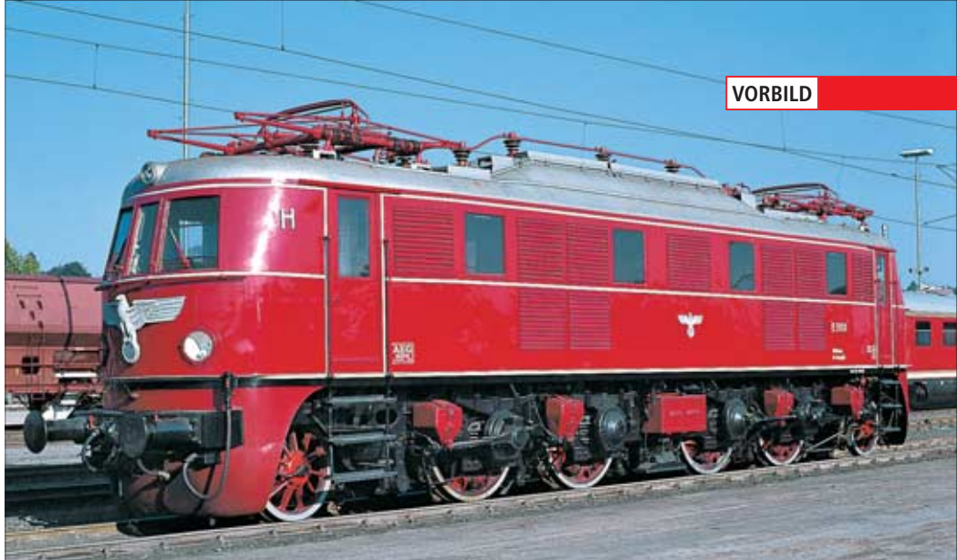
Zurückversetzt in den Ablieferungszustand präsentierte sich E 19 01 auf der großen Fahrzeugschau in Bochum-Dahlhausen am 3.10.1985. Allerdings mit geringen Abweichungen: SBS 39 statt HISE 6, etwas zu großes Hoheitszeichen an der Front und der Batteriekasten ist rot statt schwarz. Foto: MK
