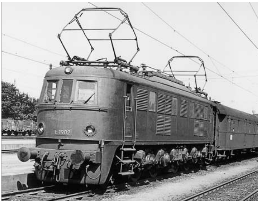
Zurückversetzt in den Ablieferungszustand präsentierte sich E 19 01 auf der großen Fahrzeugschau in Bochum-Dahlhausen am 3.10.1985. Allerdings mit geringen Abweichungen: SBS 39 statt HISE 6, etwas zu großes Hoheitszeichen an der Front und der Batteriekasten ist rot statt schwarz. Foto: MK
