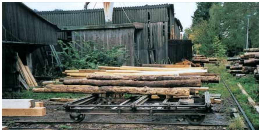
Die einzuschneidenden Stämme werden von Transportketten vom Querförderer auf den niedrigeren Gatterwagen befördert.
