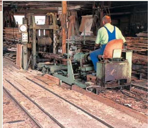
Spaltkeile hinter den Transportwalzen sorgen für die Führung des Schnittguts.
