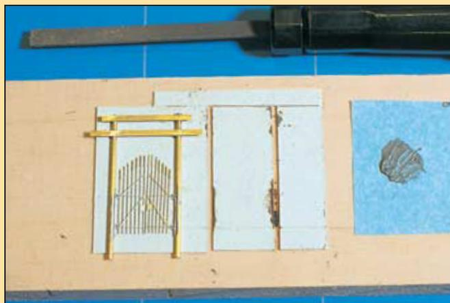
Das Tor erhält ein Portal aus 1,5-mm-Messingrohren. Oben sind diese mit zwei Messingstreifen (als Träger für das Schild „Biergarten“) verbunden. Die Torflügel haben funktionelle Angeln aus dem Ätzblech.
