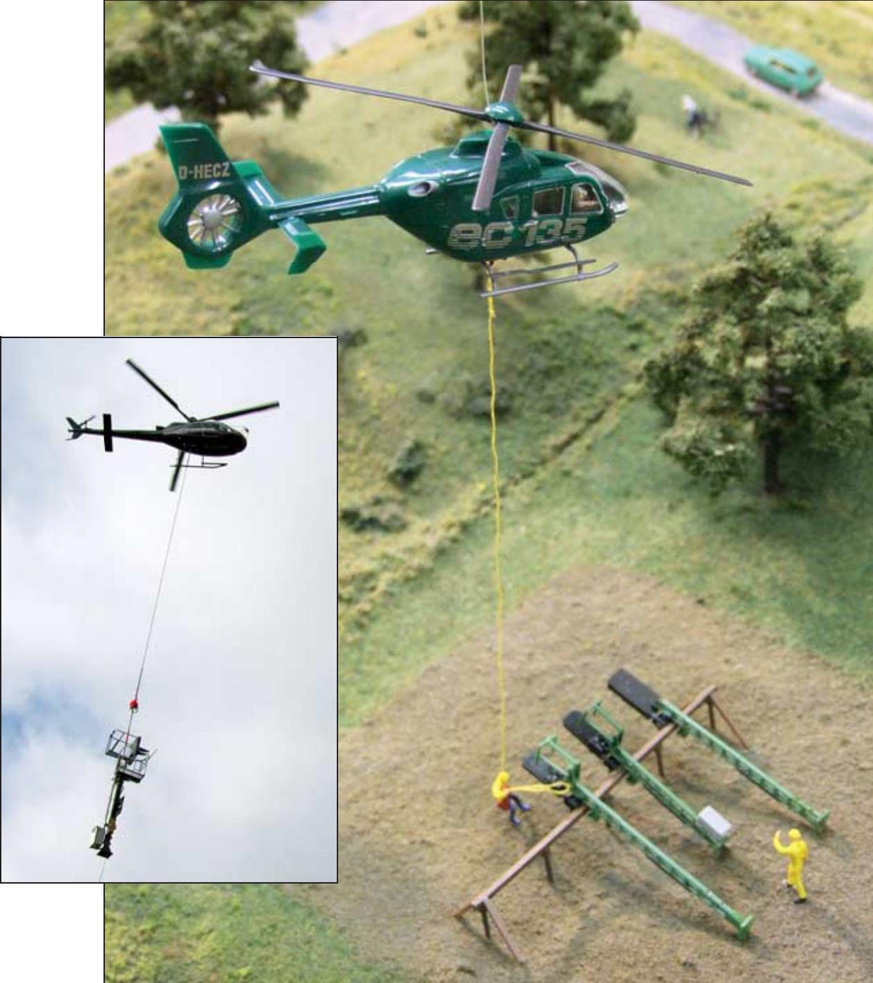
Modelldarstellung der Signalmontage mittels Hubschrauber: Vorsichtig und nicht ohne fliegerisches Können hält der Pilot seine Maschine in der Stand-schwebe, damit der routinierte Spezialist auf dem Lagerplatz auf dem Lagerplatz ein weiteres Signal am Trage-seil einklinken kann. Der zweite Mann des Boden-personals ist für die Re-gie zuständig und steht über Funk so-wie per Zeichensprache mit allen Betei-ligten in Verbindung.
