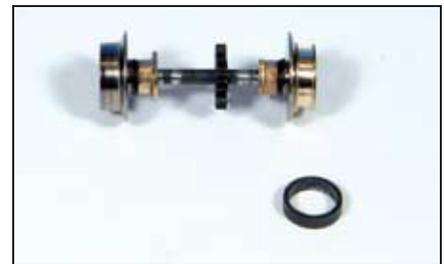
Eine Stromaufnahme an nur einem Punkt auf der rechten Seite ist recht kritisch. Abhilfe schafft hier ein weicher Zusatzschleifer, der sich weitgehend unter der seitlichen Trittstufe versteckt. Damit ist die Stromabnahme wieder so gut wie vor dem Umbau.
