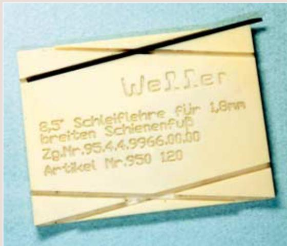
Links: Die Herzstückwinkel habe ich mithilfe der Weller-Schleiflehre aus Polyurethan freihand geschruppt, vor dem Bauch quasi, Feile immer schön parallel zur Kante. Eigentlich gehört die Schablone auf einen Bohrstander gespannt, um die Schienestücke einem schnelllaufenden Bohrschleifer zuzuführen.
