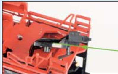
Zum Kürzen der Deichsel wird der elektrische Teil der Lok-Tender-Kupplung (Stecker) vom mechanischen Teil entlang der Linie getrennt. Dabei ist mit der Trennscheibe sehr vorsichtig umzugehen.
