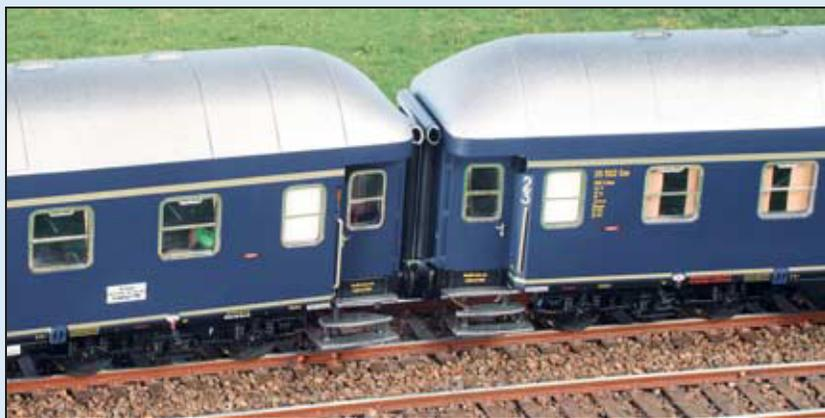
Den Trix-Modellen fehlen die Versteifungsrippen zwischen den Obergeschossfenstern. 0,3 mm breite Metallstreifen schaffen hier Abhilfe.
