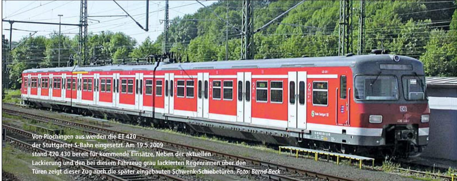
Von Plochingen aus werden die ET 420 der Stuttgarter S-Bahn eingesetzt. Am 19.5.2009 stand 420 430 bereit für kommende Einsätze. Neben der aktuellen Lackierung und den bei diesem Fahrzeug grau lackierten Regenrinnen über den Türen zeigt dieser Zug auch die später eingebauten Schwenk-Schiebetüren. Foto: Bernd Beck
