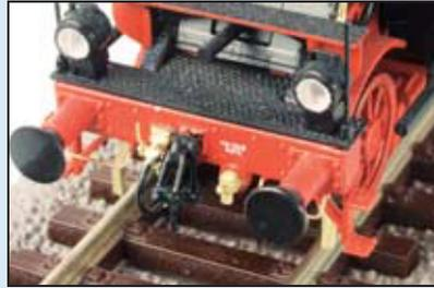
Der vordere Pufferträger wurde mit Messinggussdetails verfeinert: Die Original-Kupplungsattrappe hat jetzt zierliche Haltebügel, der Absperrhahn des Bremschlauches einen freistehenden Hebel, ebenso die Anschlüsse der Dampfheizkupplung. Unterhalb der Puffer wurden Rangierertritte aus 0,3-mm-Draht und die Schienenräumer an den Rahmen gesetzt.
