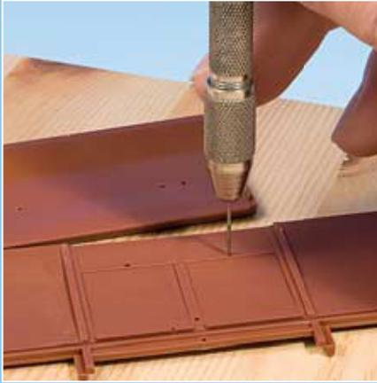
Für einige Zurüstteile müssen vor dem Zusammenkleben Löcher mit einem 0,9-mm-Bohrer in die Wände gebohrt werden. Diese sind von der Innenseite angedeutet. Mit einem Stiftenklöbchen lassen sich die Löcher gut aufbohren. Fotos: gp
