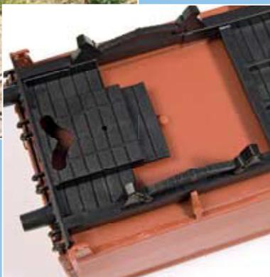
Links: Der Wagen ist zwar mit einer Kurzkupplung ausgestattet, jedoch ist diese in der Höhe nicht ganz mit der Lenz-Kupplung kompatibel. Um Betriebsstörungen zu vermeiden, sollte man entweder die KK-Kinematik aus Messing von Jürgen Moog oder die gezeigte aus Kunststoff einsetzen.
