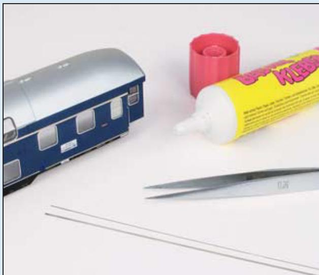
Mit 0,5 mm und 1,0 mm breiten Neusilberstreifen lassen sich Zierleisten in der richtigen Breite und mit der richtigen Wirkung darstellen. Bastelkleber hat den Vorteil, dass er sich, sollte er an den Kanten der Leisten hervorstechen, rückstandsfrei mit einem Zahnstocher entfernen lässt.
