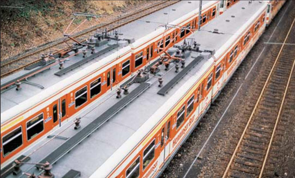
der Wagenkasten des Mittelwagens aus einer Aluminium-Schweißkonstruktion, während die Endwagen als Stahlleichtbau ausgeführt wurden. Ab 420 131 wurden auch die Endwagen aus Aluminium gefertigt.
