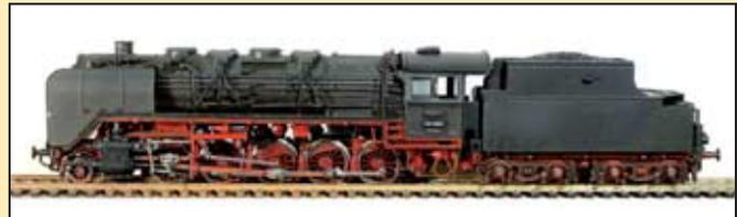
In der Epoche II und der frühen Epoche III waren die Maschinen der BR 44 nicht selten ganz ohne Leitbleche unterwegs. Das Gehäuse des hier gezeigten T 32 von 1926 mit verändertem Kohlenkastenaufbau stammt von dem Fleischmann-Modell der BR 22.
