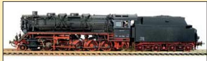
Epoche-IIIb-Version dieser Baureihe mit Witte-Blechen, Scheibenvorlaufgrad als Relikt aus der ÜK-Zeit und einem geschweißten Tender der Bauart T 34. Der mittlere Teil der Frontschürze wurde dem Modell vorbildgemäß entfernt.
