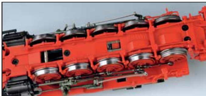
Der Motor gibt seine Kraft über ein Getriebe mit Messingschnecke und Kunststoffzahnradern nahezu lautlos auf die Achsen. Angetrieben sind die vierte und fünfte Achse, was gegenüber einer einzeln angetriebenen Achse eventuelles Ruckeln vermeidet. Die hintere Achse trägt die beiden Haftreifen. Fotos: MK
