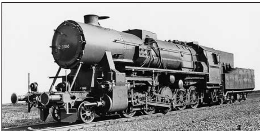
52 360 der Reichsbahn der DDR, ausgerüstet mit einstufigem Mischvorwärmer, entstammt der von Borsig 1943 gelieferten Serie 52 350-363. Bei der DR wurden diese generalüberholten Maschinen, die ihre ursprüngliche Nummer behielten, als Baureihe 52 GR (Generalreparatur) bezeichnet. Leider sind Aufnahmeort und -datum der abgebildeten Maschine nicht bekannt. Foto: Helmut Oesterling/Archiv Michael Meinhold
