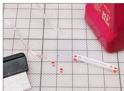
Die Lichtleiter werden vorne vier Millimeter abgeschnitten und anschließend eingeklebt.
