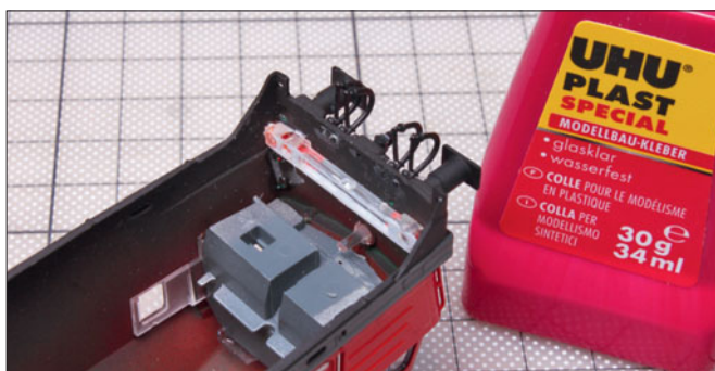
Um für die LED-Platine Platz zu schaffen, muss die Inneneinrichtung befeilt werden.
